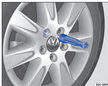
Fig. 218 Cambiar una rueda: desenroscar los tornillos de rueda con el mango del destornillador.
