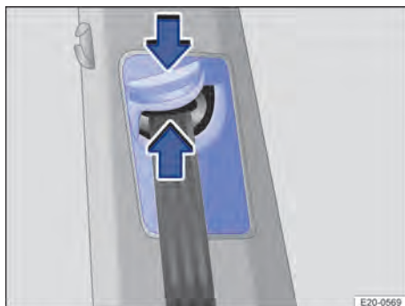
Fig. 38 Junto a los asientos delanteros: regulador de la altura del cinturón.
