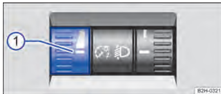
Fig. 85 Junto al volante: regulador de la iluminación de los instrumentos y los mandos.
