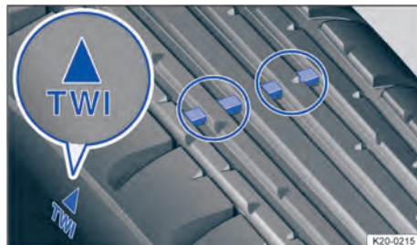
Fig. 198 Perfil del neumático: indicadores de desgaste.
