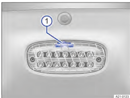
Fig. 87 Encima de la compuerta de carga: mando de la luz del techo rígido.
