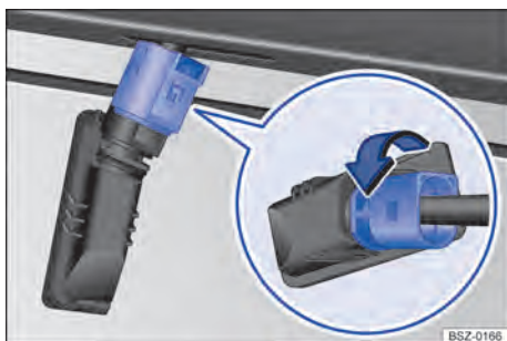
Fig. 165 Luz de matrícula: desmontaje del portalámparas.
