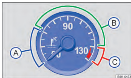
Fig. 14 Indicador de temperatura del líquido refrigerante del motor en el cuadro de instrumentos analógico (representación gráfica).
