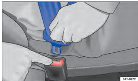
Fig. 31 Soltar la lengüeta del cierre del cinturón.
