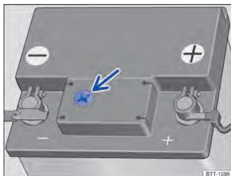
Fig. 192 Mirilla en la parte superior de la batería de 12 voltios (representación esquemática).
