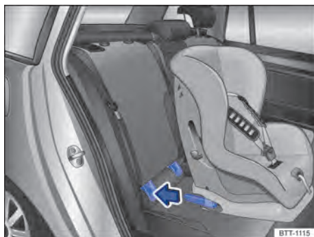
Fig. 50 Representación gráfica: montar asiento para niños con ISOFIX con los brazos de apoyo.
