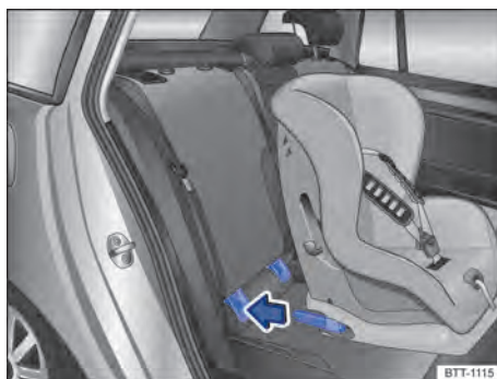
Fig. 52 Representación gráfica: montar asiento para niños con ISOFIX con los brazos de apoyo.
