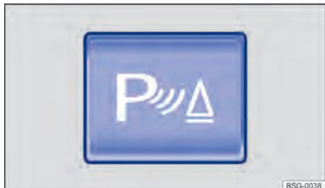
Fig. 118 En la consola central: tecla para conectar y desconectar la ayuda de aparcamiento (en función del equipamiento).
