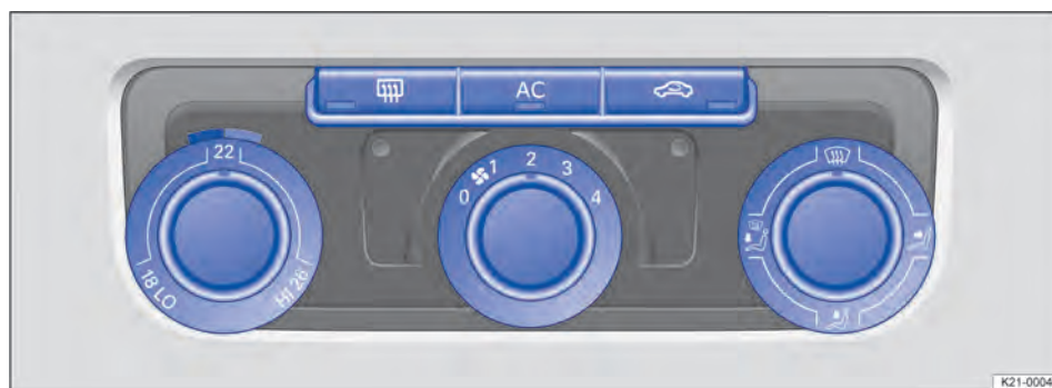
Fig. 95 En el tablero de instrumentos: mandos del Climatic.
