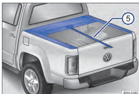
Fig. 63 Capota marítima de la zona de carga: cinta tensora
