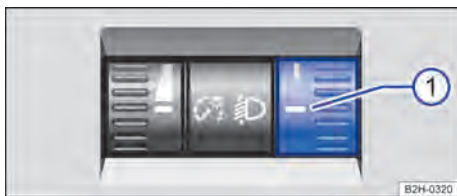
Fig. 84 Junto al volante: regulador del alcance de las luces ①.
