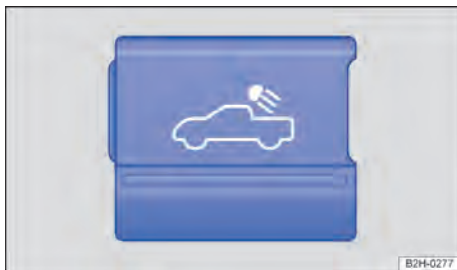
Fig. 86 En la consola central: tecla de la luz de la superficie de carga.
