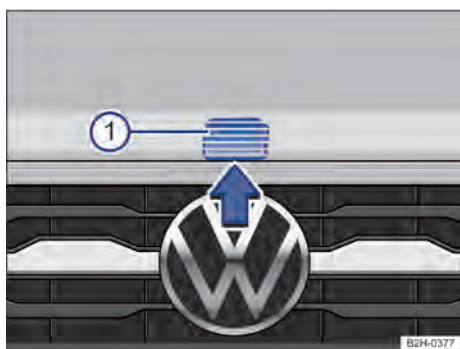
Fig. 180 Arriba de la parrilla del radiador: palanca de accionamiento para el capó delantero.
