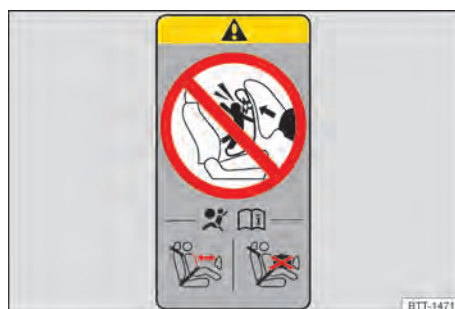
Fig. 48 Representación esquemática: etiqueta adhesiva relativa al airbag en el pilar B.
