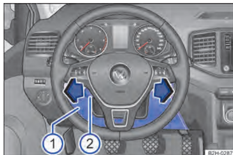
Fig. 169 En el lado del conductor, vehículos con el volante a la izquierda: caja de fusibles detrás del guanrecido del tablero de instrumentos.
