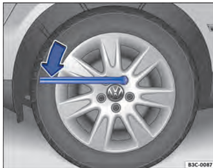
Fig. 201 Cambiar una rueda: aflojar los tornillos.
