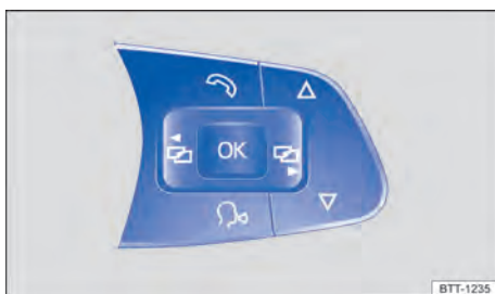
Fig. 11 En el volante multifunción: teclas para utilizar los menús del cuadro de instrumentos.
