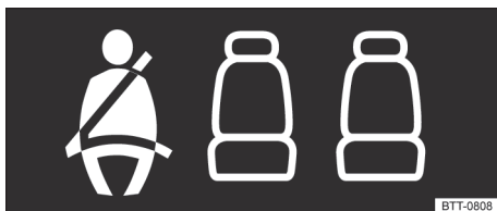
Fig. 29 Indicador del estado de los cinturones de seguridad para los asientos traseros en la pantalla del cuadro de instrumentos.
