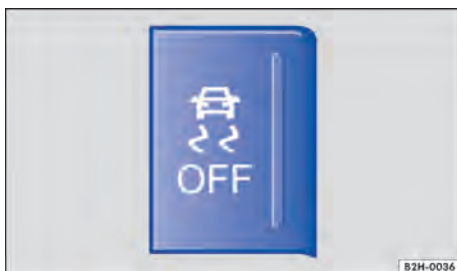
Fig. 122 En la consola central: tecla para desconectar y conectar manualmente el ASR.
