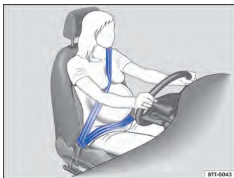
Fig. 37 Colocación correcta de la banda del cinturón en las mujeres embarazadas.
