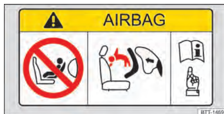
Fig. 47 Representación esquemática: etiqueta adhesiva relativa al airbag en el parasol.
