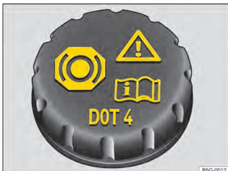
Fig. 191 En el vano motor: tapa del depósito del líquido de frenos.
