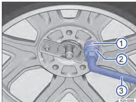
Fig. 205 Desmontar el dispositivo antirrobo.
