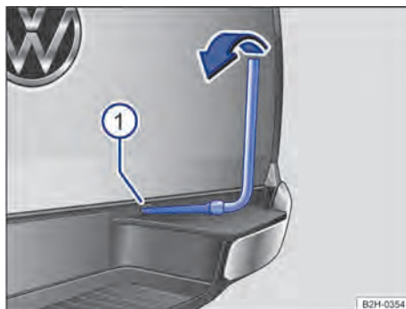
Fig. 204 Controlar el cable de elevación con el cabrestante.
