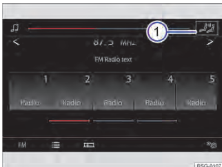
Fig. 127 Visualización en la pantalla de la consola central: botón de función para abrir la amplificación digital de la voz.
