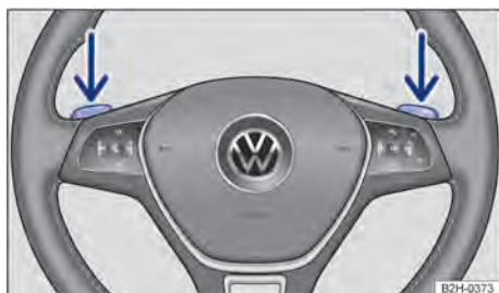
Fig. 104 Volante con conmutadores basculantes del Tiptronic.
