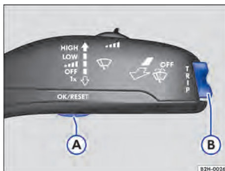
Fig. 12 En la palanca del limpiacristales: teclas para manejar los menús.
