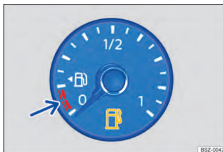
Fig. 13 Indicador del nivel de combustible en el cuadro de instrumentos analógico (representación gráfica). <
