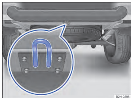
Fig. 175 Abajo del paragolpes: argolla de remolque en vehículos sin dispositivo de remolque de fábrica.
