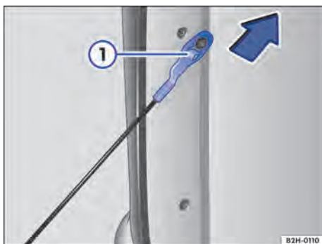
Fig. 61 Desenganchar el cable de sujeción de la compuerta de carga.
