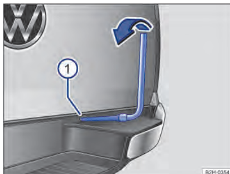
Fig. 210 Colocar la rueda de repuesto sobre el cabrestante.
