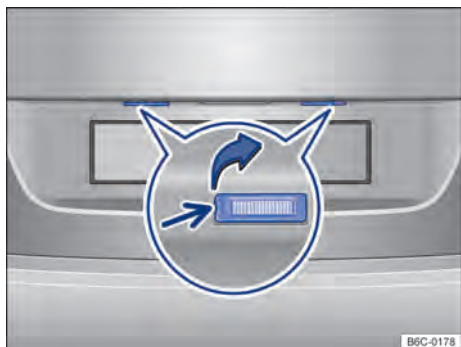
Fig. 136 En el capó del maletero: luz de matrícula.
