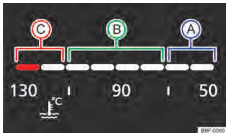
Fig. 15 Indicador de temperatura del líquido refrigerante del motor en el cuadro de instrumentos digital (variante 2): (A) área fría; (B) área normal; (C) área de advertencia.
