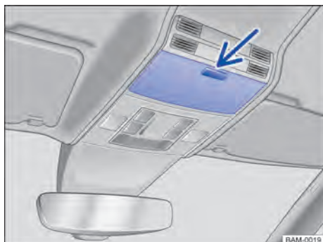
Fig. 103 En la consola del techo: estuche para gafas.
