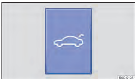
Fig. 60 En la consola central: tecla de desbloqueo del capó del maletero.
