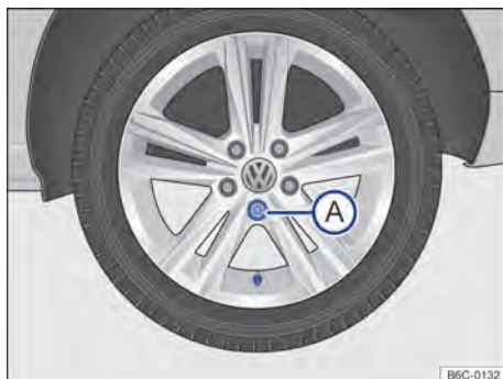
Fig. 169 Retire el tapacubos integral.
