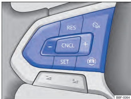
Fig. 96 Lado izquierdo del volante multifunción: teclas para comandar el GRA.
