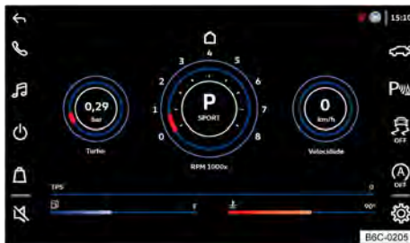
Fig. 17 En la pantalla de la radio: monitor de datos del vehículo.
