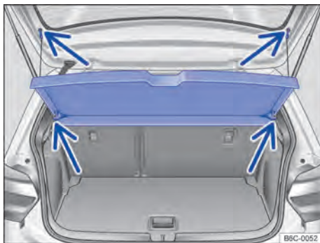
Fig. 119 En el maletero: desmontar y montar la bandeja trasera.
