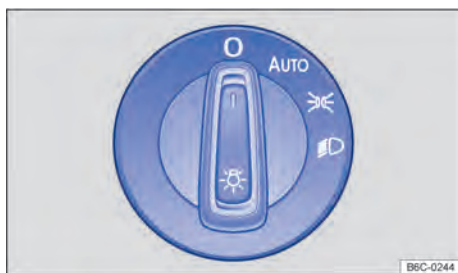
Fig. 69 Al lado del volante: interruptor de luces (una variante).
