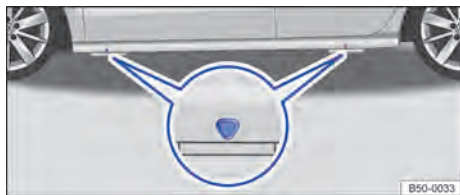
Fig. 167 Puntos de apoyo del gato.
