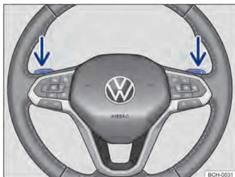
Fig. 94 Volante con selectores basculantes de Tiptronic.
