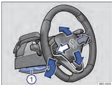
Fig. 62 Debajo y a la izquierda del volante junto con el revestimiento de la columna de dirección: palanca de ajuste de la posición del volante.
