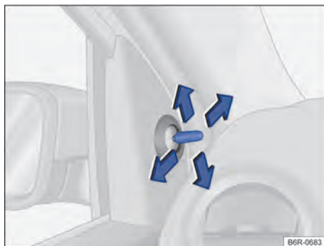
Fig. 79 En las puertas delanteras: mando de ajuste de los espejos retrovisores exteriores mecánicos.
