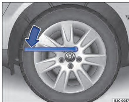
Fig. 166 Cambio de rueda: aflojar los tornillos de la rueda.
