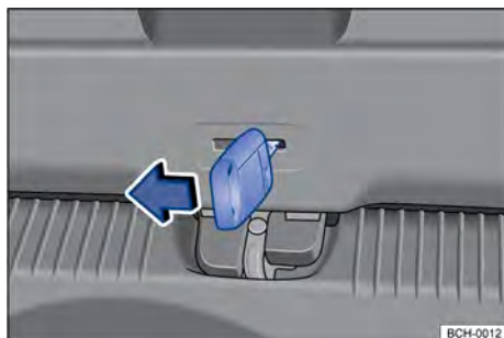
Fig. 61 En el maletero: desbloquear el capó del maletero.
