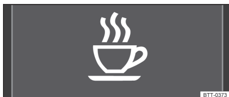
Fig. 16 En la pantalla del cuadro de instrumentos: símbolo del sistema de detección del cansancio.
