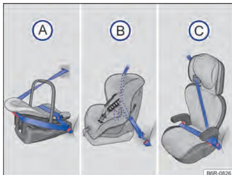
Fig. 41 Las ilustraciones A, B e C muestran la fijación del sistema de retención para niños solo con el cinturón de seguridad del vehículo.
