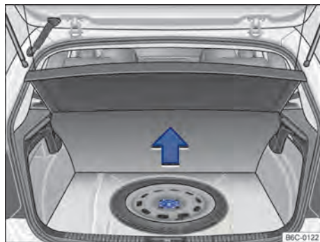
Fig. 127 En el maletero, por debajo del revestimiento del piso: rueda de emergencia y herramientas de a bordo.
