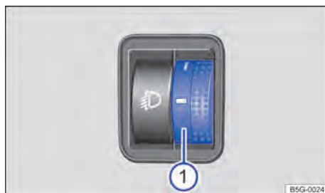
Fig. 72 Al lado del volante: regulador de alcance de las luces ①.
