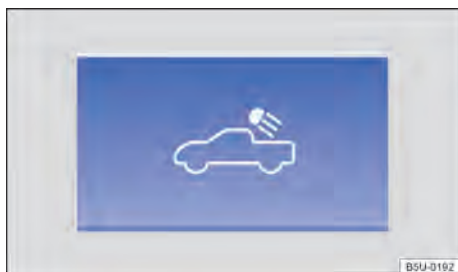
Fig. 66 En la consola central: tecla de iluminación del compartimento de carga.
