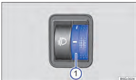
Fig. 64 Al lado del volante: ajustador de alcance de faros ①
