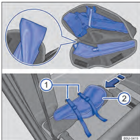
Fig. 126 Atrás del respaldo del asiento del pasajero: ① cintas de sujeción de fijación de la bolsa de herramientas de a bordo y ② bolsa de las herramientas de a bordo.
