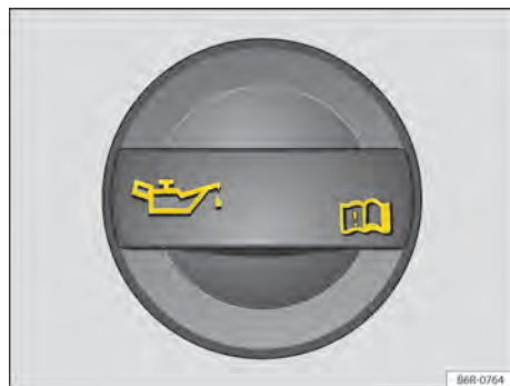
Fig. 155 En el compartimento del motor: tapón de la boca de llenado del aceite del motor.
