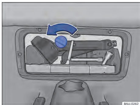
Fig. 129 Palanca de fijación de caja de herramientas de a bordo.
