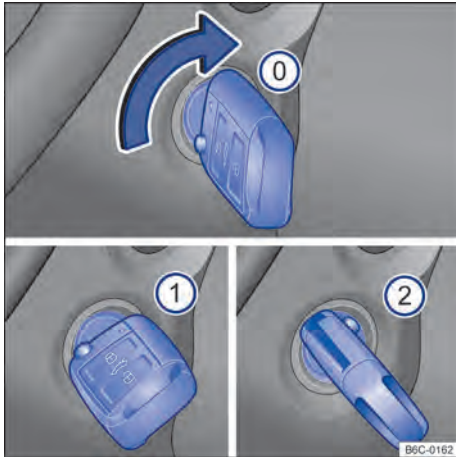
Fig. 82 Al lado del volante de la dirección, a la derecha: posiciones de la llave del vehículo en la cerradura de encendido.
