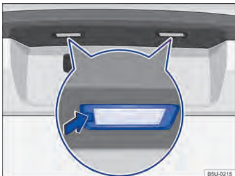
Fig. 139 En el paragolpes trasero: desmontar la luz de la placa de licencia.
