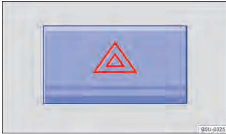
Fig. 37 En la parte superior de la consola central: interruptor de las luces de advertencia.
