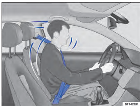
Fig. 26 Conductor protegido por el cinturón de seguridad correctamente colocado en una maniobra de frenado súbito.
