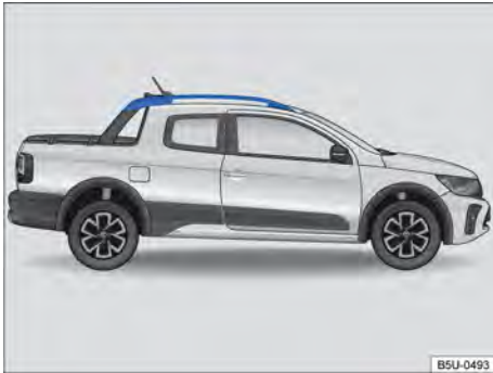
Fig. 123 Soportes longitudinales del maleteros de techo (ambos lados).
