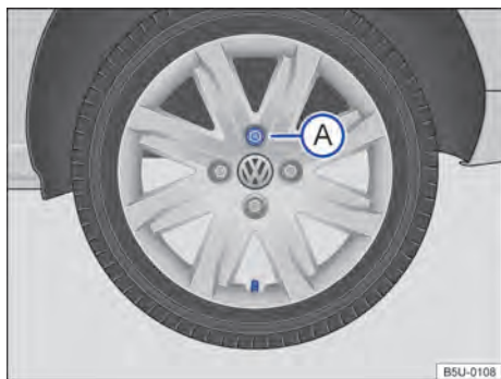
Fig. 172 Cambio de rueda: secuencia de desmontaje de los tornillos de la rueda.
