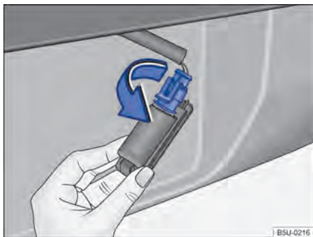
Fig. 140 Luz de la placa de licencia: retirar el porta-lámparas.
