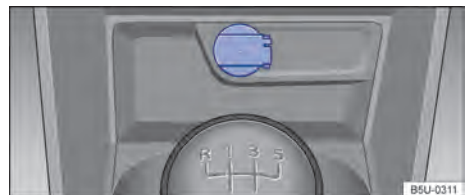
Fig. 106 En la consola central delantera: toma de corriente de 12 V.
