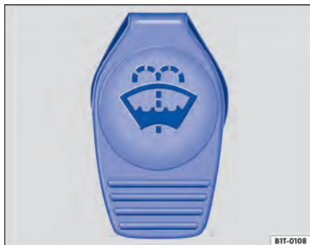
Fig. 153 En el compartimento del motor: tapa del tanque de agua de los lavaparabrisas.
