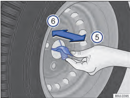
Fig. 165 En la rueda de emergencia: retirar el cable de la rueda de emergencia.
