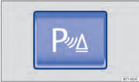
Fig. 89 En la parte superior de la consola central: pulsador para activar y desactivar el control de distancia de aparcamiento (Park Pilot).
