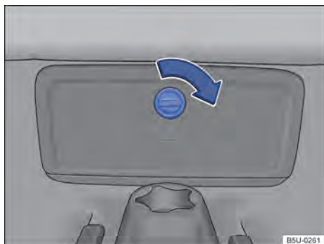
Fig. 128 En el piso del asiento trasero: acceso a la caja de fijación de las herramientas de a bordo.
