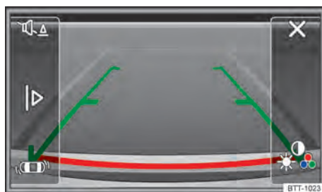
Fig. 91 Exhibición en display de la radio o del sistema de navegación: cámara de marcha atrás encendida (representación esquemática).
