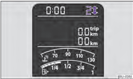
Fig. 79 En el panel de instrumentos: indicador de cambio de marcha (variante 1).
