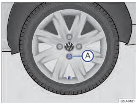
Fig. 168 Retirar la super llanta.
