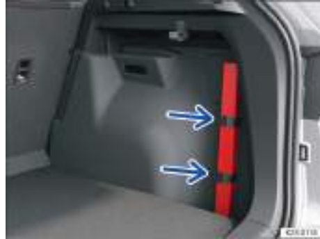
Fig. 41 En el lado derecho del maletero: soporte del triángulo de preseñalización.
