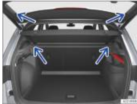
Fig. 132 En el maletero: desmontar y montar la cubierta (representación esquemática).
