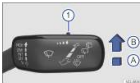
Fig. 79 En el lado derecho de la columna de dirección: palanca del limpiacristales.
