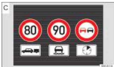
Fig. 22 En la pantalla del cuadro de instrumentos digital: indicaciones del sistema de detección de señales de tráfico con panel complementario (representación esquemática).
