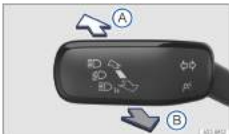
Fig. 74 En el lado izquierdo de la columna de dirección: palanca de los intermitentes y de la luz de carretera.
