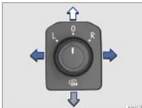
Fig. 82 En la puerta del conductor: mando giratorio de los retrovisores exteriores.
