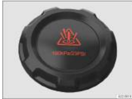
Fig. 175 En el vano delantero: tapa del depósito de expansión del líquido refrigerante (representación esquemática).
