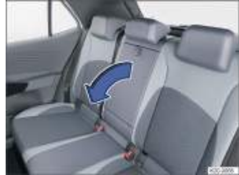
Fig. 71 En el respaldo de la plaza central del asiento: reposabrazos central trasero abatible.
