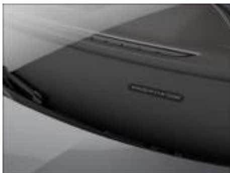
Fig. 200 En el parabrisas: número de identificación del vehículo.
