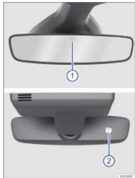
Fig. 80 En el parabrisas: retrovisor interior antideslumbrante automático.
