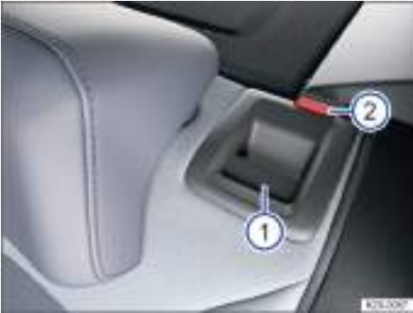
Fig. 64 En el respaldo del asiento trasero: tecla de desbloqueo.
