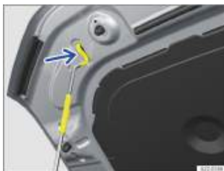
Fig. 168 En el capó delantero: alojamiento de la varilla de sujeción del capó (representación esquemática).
