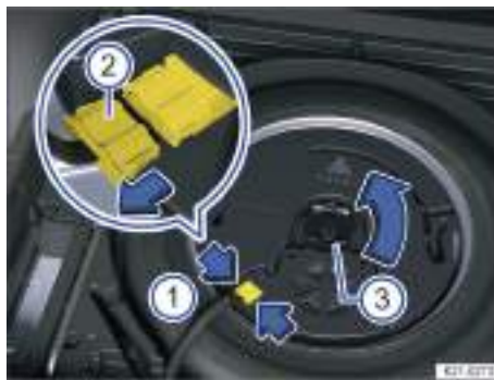
Fig. 185 En el maletero: desmontar el subwoofer (variante 1).
