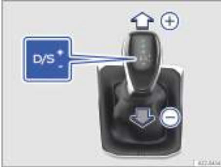
Fig. 92 En la consola central: palanca selectora en la posición Tiptronic.
