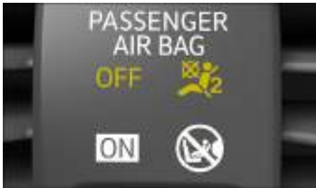
Fig. 33 En la consola central: testigo de control de la desactivación del airbag frontal del acompañante (en función del país).
