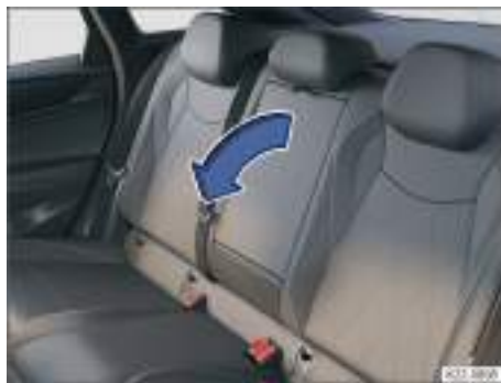
Fig. 125 En el respaldo de la plaza central del asiento: reposabrazos central trasero abatible (representación esquemática).
