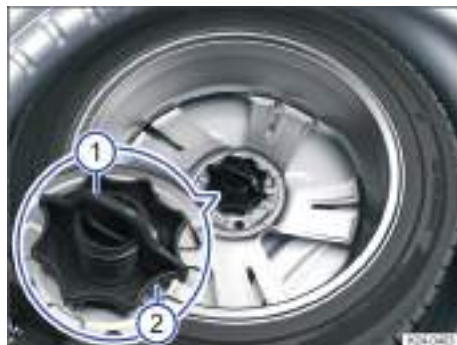
Fig. 187 Debajo del piso del maletero: ruedecilla para fijar la rueda de repuesto.
