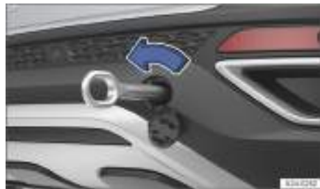
Fig. 164 En el lado derecho del paragolpes trasero: enroscar la argolla de remolque.
