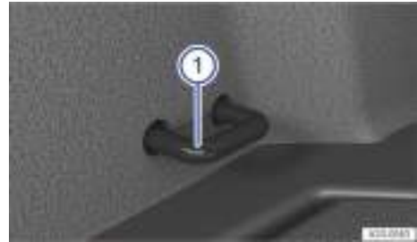
Fig. 134 En el maletero: argollas de amarre (representación esquemática).
