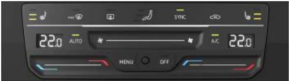
Fig. 85 En la parte superior de la consola central: panel de mandos del Climatronic.
