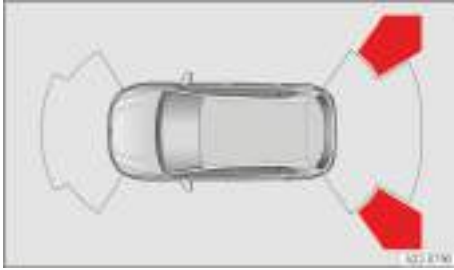
Fig. 123 Sistema de infotainment: visualización del asistente de salida del aparcamiento con sensores traseiros y delanteros (en función del equipamiento).
