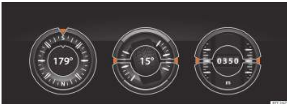
Fig. 94 En el sistema de infotainment: indicador Offroad.
