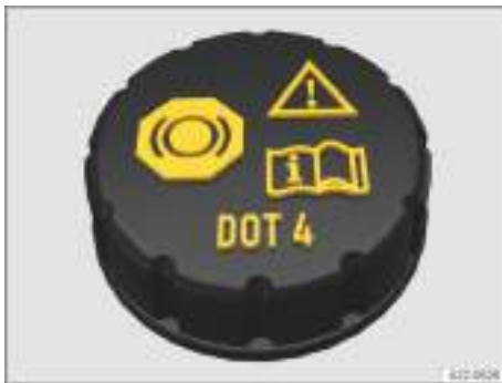
Fig. 177 En el vano delantero: tapa del depósito del líquido de frenos.
