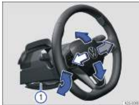
< Fig. 59 Debajo del volante, en el guarnido de la columna de dirección: palanca para el ajuste manual de la posición del volante (representación esquemática).
