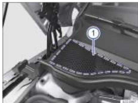
Fig. 197 Entre el vano delantero y el parabrisas: caja de aguas (representación esquemática).
