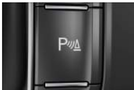
Fig. 114 En la consola central: tecla de la ayuda de aparcamiento (en función del equipamiento).
