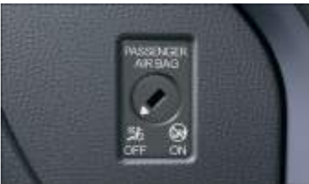
Fig. 31 En el tablero de instrumentos, en el lado del acompañante: conmutador de llave para desactivar y activar el airbag frontal del acompañante.
