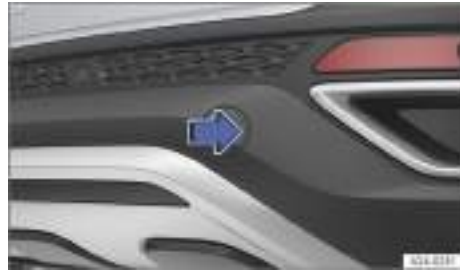
Fig. 163 En el lado derecho del paragolpes trasero: retirar la tapa.
