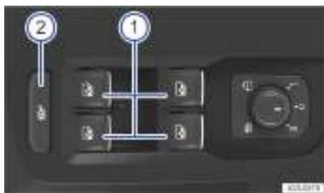
Fig. 57 En la puerta del conductor: teclas de los elevallunas.
