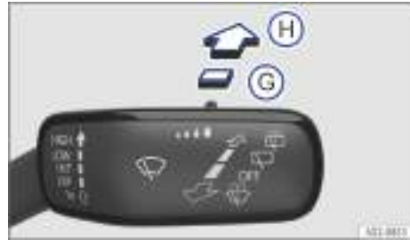
Fig. 78 En el lado derecho de la columna de dirección: manejo del limpiacristales.
