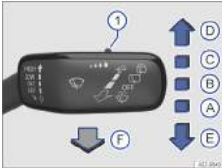
Fig. 77 En el lado derecho de la columna de dirección: manejo del limpiaparabrisas.
