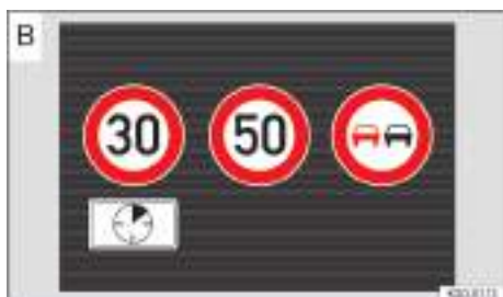
Fig. 21 En la pantalla del cuadro de instrumentos digital: indicaciones del sistema de detección de señales de tráfico con panel complementario (representación esquemática).
