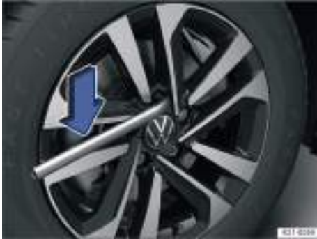
Fig. 189 Aflojar los tornillos de rueda.
