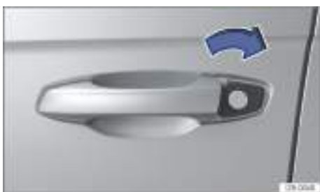
Fig. 51 Manilla de la puerta del conductor: realizar un cierre de emergencia.
