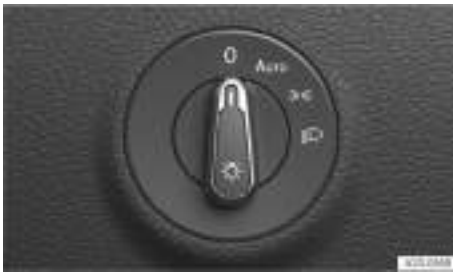
Fig. 73 Junto al volante: mando de las luces.
