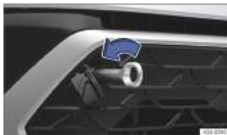
Fig. 162 En el lado derecho del paragolpes delantero: enroscar la argolla de remolque.
