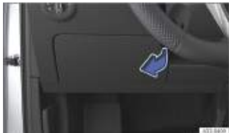
Fig. 154 En el tablero de instrumentos del lado del conductor: tapa de la caja de fusibles (representación esquemática).
