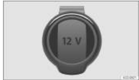
Fig. 127 En el portaobjetos de la parte delantera de la consola central: toma de corriente de 12 voltios con tapa plegable (representación esquemática).
