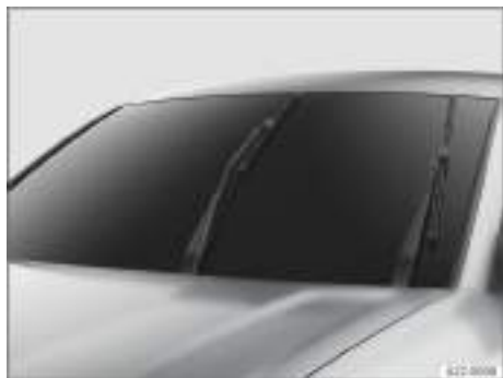
Fig. 148 Parabrisas: limpiacristales en la posición de servicio (representación esquemática).
