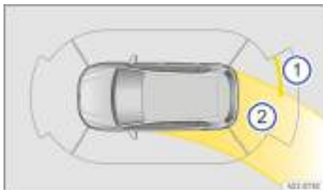
Fig. 116 Sistema de infotainment: visualización de la ayuda de aparcamiento (en función del equipamiento).
