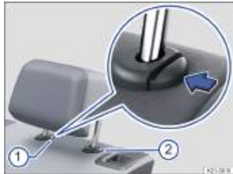
Fig. 68 Desmontaje de los apoyacabezas traseros (representación esquemática).
