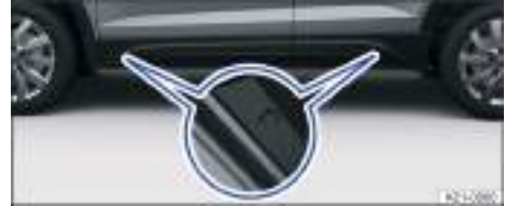
Fig. 190 En el larguero inferior: marcas para los puntos de alojamiento del gato.
