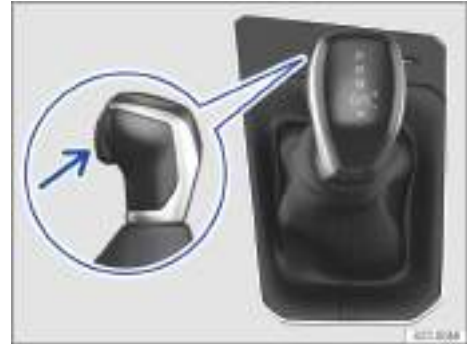
Fig. 91 En la consola central: palanca selectora del cambio automático (representación esquemática).
