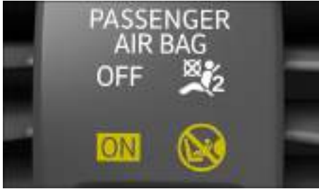
Fig. 32 En la consola central: testigo de control de la activación del airbag frontal del acompañante (en función del país).
