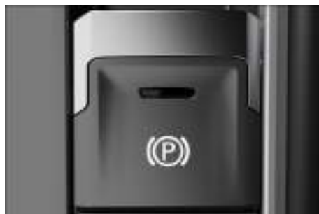
Fig. 113 En la consola central: tecla del freno de estacionamiento electrónico.
