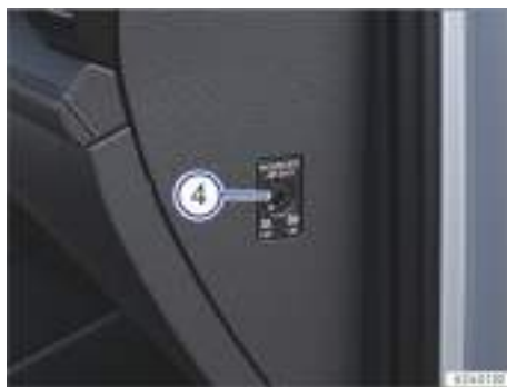
Fig. 8 Con la puerta del acompañante abierta: conmutador de llave en el tablero de instrumentos.
