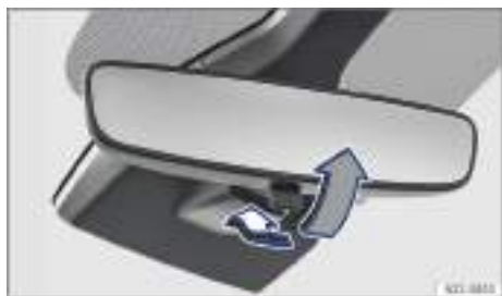
Fig. 81 En el parabrisas: retrovisor interior antideslumbrante manual.
