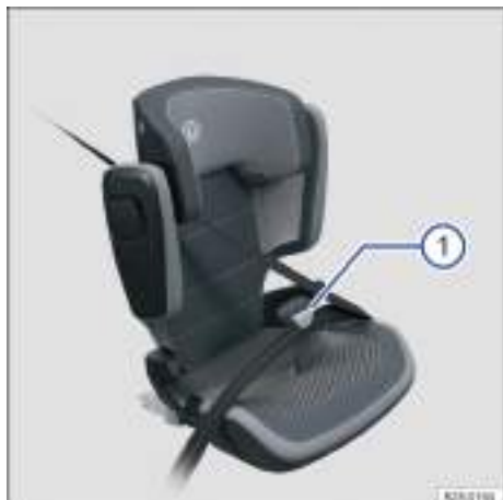
Fig. 35 Asiento para niños con guía adicional del cinturón (representación esquemática).
