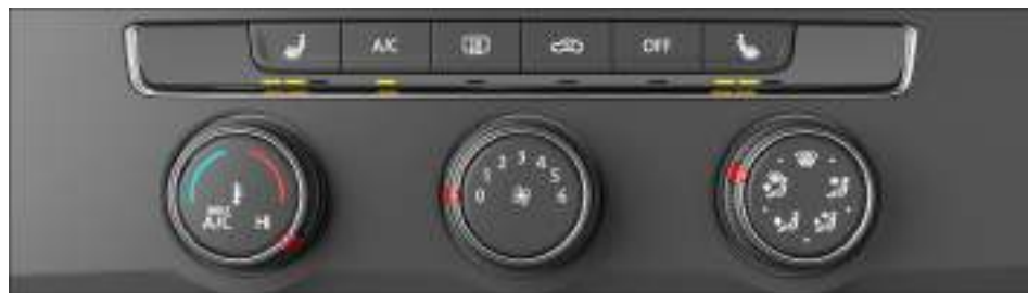
Fig. 86 En la parte superior de la consola central: panel de mandos del climatizador manual.
