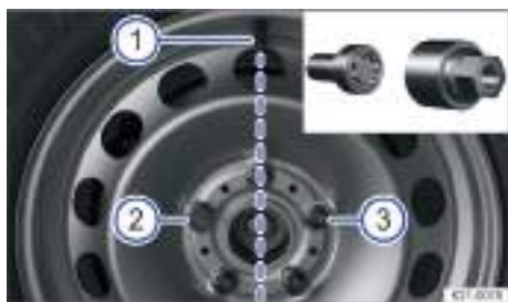
Fig. 194 Posición correcta del tornillo de rueda anti-robbo.
