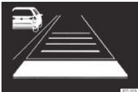
Fig. 105 En la pantalla del cuadro de instrumentos: vehículo detectado que circula más lentamente que el propio por el carril izquierdo (representación esquemática).
