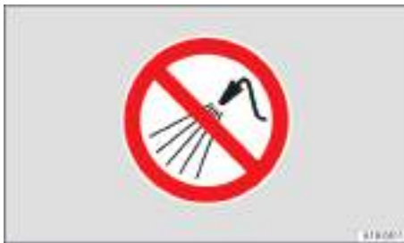
Fig. 196 En el vano delantero: no utilizar ningún equipo de limpieza de alta presión.
