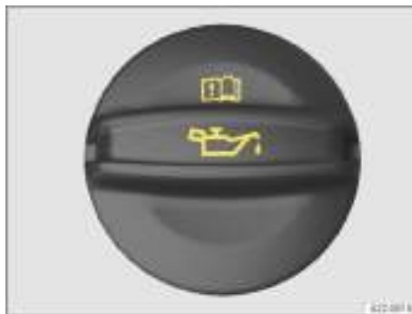
Fig. 173 En el vano delantero: tapa de la boca de llenado del aceite del motor (representación esquemática).
