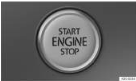
Fig. 88 En la parte inferior de la consola central: pulsador de encendido y arranque.
