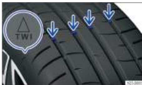
Fig. 184 En las acanaladuras del perfil: indicadores de desgaste.
