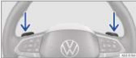
Fig. 93 Detrás del volante: levas de cambio para el Tiptronic (representación esquemática).
