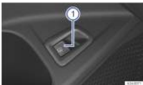
Fig. 144 En la puerta del conductor: tecla de desbloqueo de la tapa del depósito de combustible (representación esquemática).
