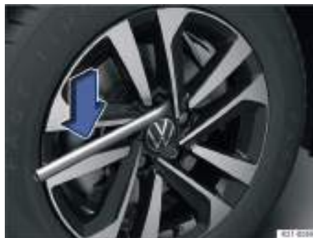
Fig. 193 Desenroscar los tornillos de rueda con la llave de rueda.
