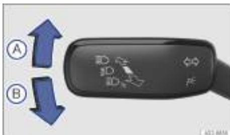
Fig. 76 En el lado izquierdo de la columna de dirección: palanca de los intermitentes y de la luz de carretera.
