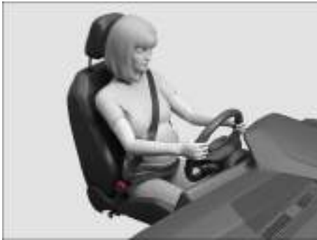
Fig. 28 Colocación correcta de la banda del cinturón en las mujeres embarazadas (representación esquemática).
