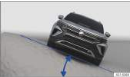
Fig. 96 Representación esquemática: ángulo de inclinación.
