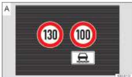
Fig. 20 En la pantalla del cuadro de instrumentos digital: indicaciones del sistema de detección de señales de tráfico con panel complementario (representación esquemática).
