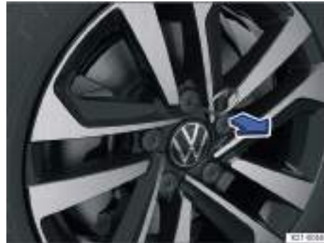
Fig. 188 Retirar las caperuzas de los tornillos de rueda.
