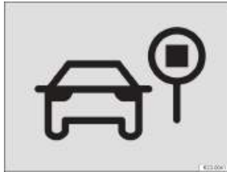
Fig. 19 En la pantalla del cuadro de instrumentos digital: símbolo del asistente de señales de tráfico.
