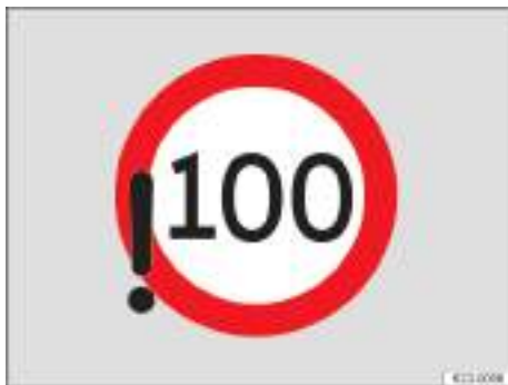
Fig. 23 En la pantalla del cuadro de instrumentos digital: detección de limitación de velocidad excedida (representación esquemática).
