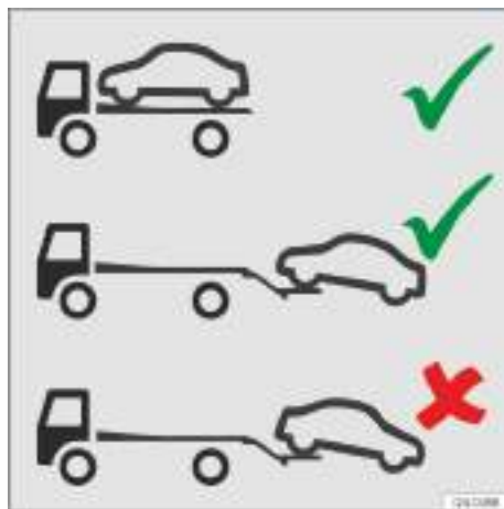
Fig. 160 Transportar con una grúa.
