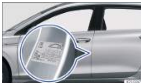
Fig. 181 En el pilar de la puerta del conductor: adhesivo de la presión de los neumáticos (o en la cara interior de la tapa del depósito de combustible).
