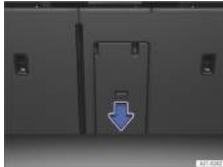
Fig. 137 En el maletero: parte trasera de la trampilla para cargas largas (representación esquemática).
