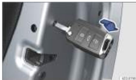
Fig. 52 En el frontal de la puerta trasera: bloqueo de emergencia del vehículo con el paletón de la llave o la llave de emergencia (variante 1).
