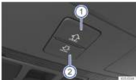
Fig. 84 En el revestimiento interior del techo: teclas para manejar la cortinilla parasol.
