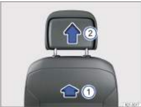
Fig. 67 Desmontaje de los apoyacabezas delanteros (representación esquemática).
