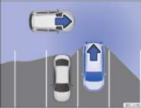
Fig. 121 Zona vigilada alrededor del vehículo que está desapareando (representación esquemática).
