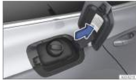
Fig. 138 En la cara interior de la tapa del depósito de combustible: adhesivo del combustible (representación esquemática).
