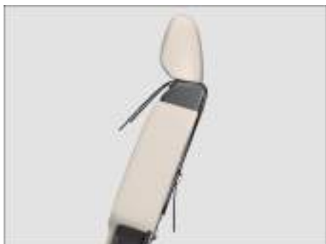
Fig. 40 En la parte posterior de los asientos traseros laterales: cinturón de fijación superior de fijación superior (Top Tether) enganchado.
