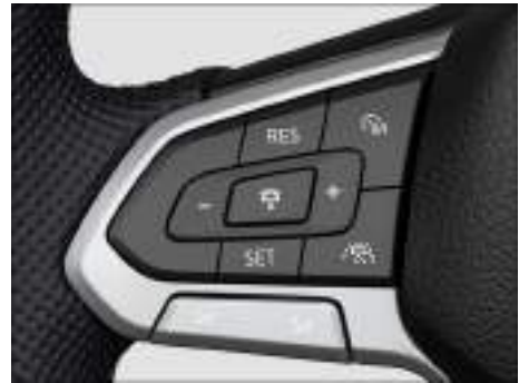
Fig. 111 Lado izquierdo del volante multifunción.
