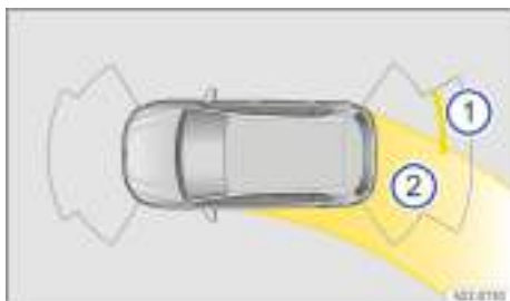
Fig. 117 Sistema de infotainment: visualización de la ayuda de aparcamiento con sensores traseros y delanteros (en función del equipamiento).
