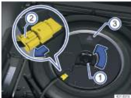
Fig. 186 En el maletero: desmontar el subwoofer (variante 2).
