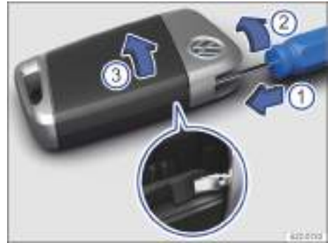
Fig. 45 Llave del vehículo: abrir la tapa del compartimento de la pila.
