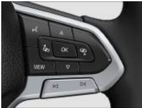
Fig. 12 Lado derecho del volante multifunción: manejo del Digital Cockpit (representación esquemática).
