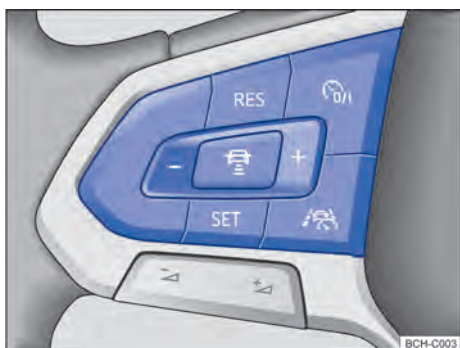
Fig. 97 Lado izquierdo del volante multifunción: teclas para mando del ACC. (variante 2)
