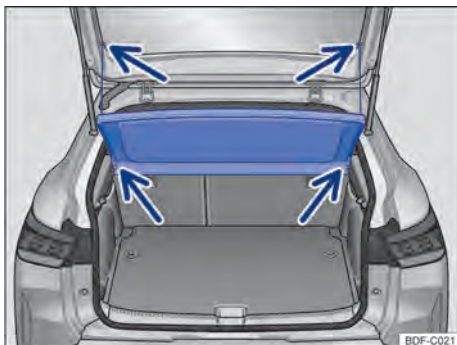
Fig. 122 En el maletero: desmontar y montar la bandeja trasera.
