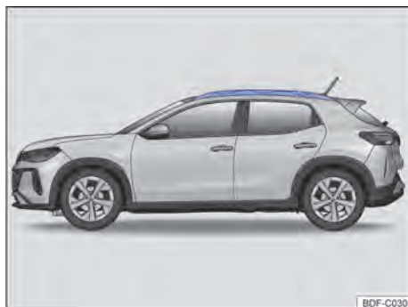
Fig. 124 Soportes longitudinales del maletero de techo (ambos lados).
