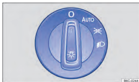
Fig. 69 Al lado del volante: interruptor de luces (una variante).
