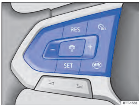
Fig. 96 Lado izquierdo del volante multifunción: teclas para mando del ACC. (variante 1)
