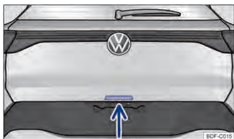
Fig. 57 En el capó del maletero: tecla para abrir el capó del maletero.
