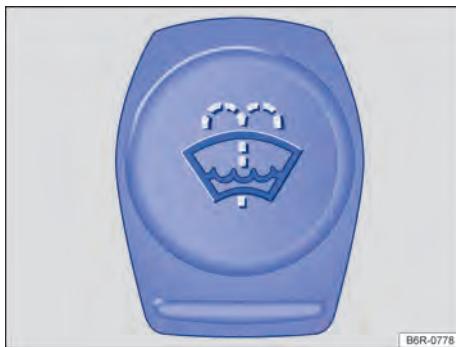
Fig. 147 En el compartimento del motor: tapón de cierre del depósito de agua de los lavacristales.
