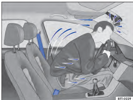
Fig. 23 El conductor sin cinturón de seguridad es lanzado hacia adelante.
