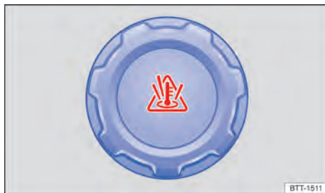
Fig. 151 En el compartimento del motor: tapa del depósito de expansión del líquido refrigerante del motor.
