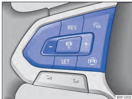
Fig. 92 Lado izquierdo del volante multifunción: teclas para comandar el GRA.
