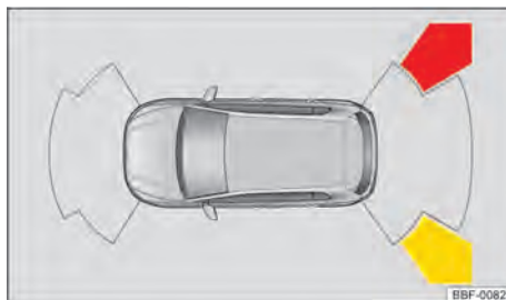
Fig. 105 Sistema de infotainment: exhibición del asistente de salida del aparcamiento.
