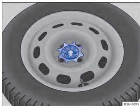
Fig. 158 En el maletero: asidero para fijación de la rueda de emergencia.
