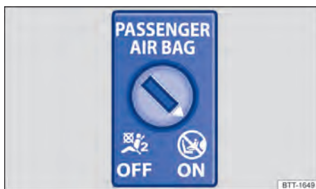
Fig. 34 En el panel de instrumentos en el lado del acompañante delantero: interruptor accionado por la llave para desconectar y conectar el airbag frontal del acompañante delantero.
