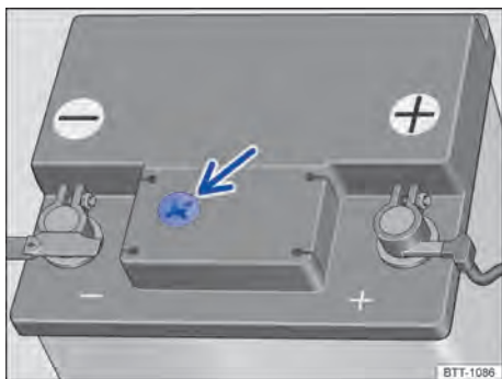
Fig. 153 En el compartimento del motor: ejemplo de posición del visor en el lado superior de la batería del vehículo.
