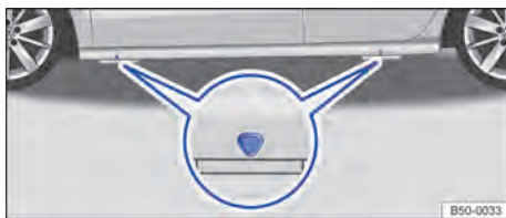
Fig. 161 Puntos de apoyo del gato.
