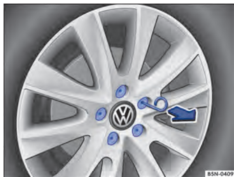
Fig. 163 Retirar las caperuzas de los tornillos de la rueda.
