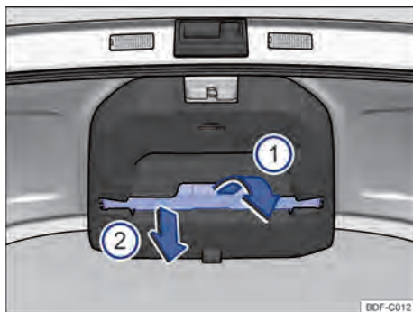
Fig. 43 En el portón trasero: soporte para el triángulo de seguridad.
