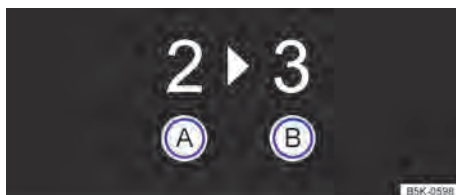
Fig. 82 En el instrumento combinado: indicador de cambio de marcha.
