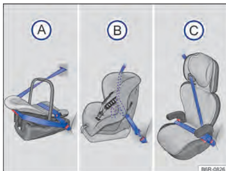
Fig. 38 Las ilustraciones A, B e C muestran la fijación del sistema de retención para niños solo con el cinturón de seguridad del vehículo.
