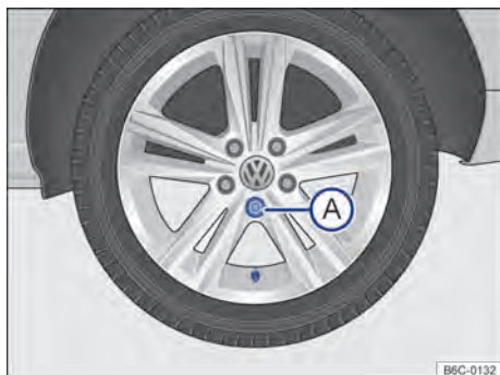
Fig. 164 Retire el tapacubos integral.
