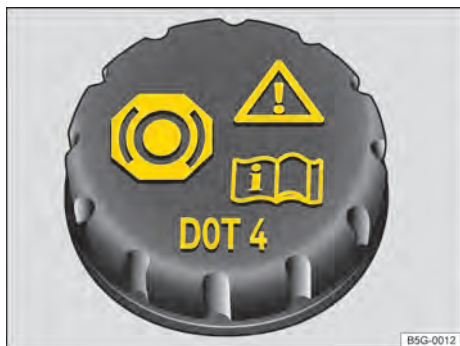
Fig. 152 En el compartimento del motor: tapón de cierre del depósito del líquido de frenos.
