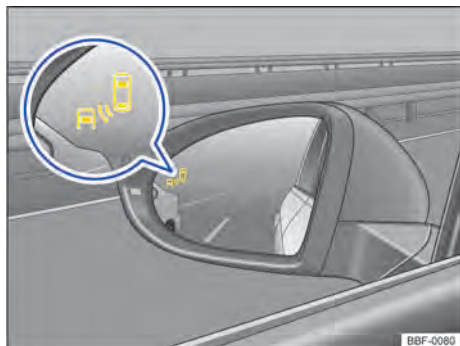
Fig. 100 En los retrovisores exteriores: indicador del detector de ángulo muerto.
