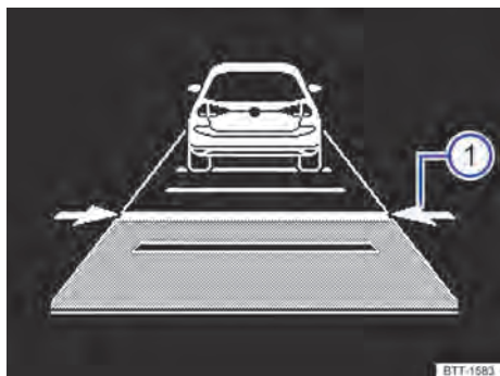
Fig. 98 En la pantalla del cuadro de instrumentos: ajustar la distancia (representación esquemática, el ACC regula).
