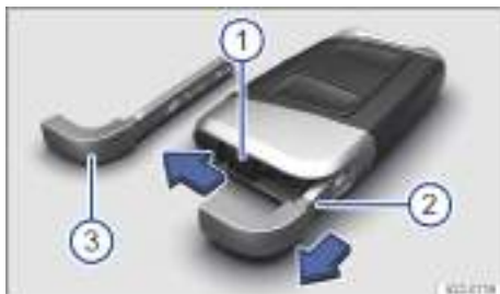
Fig. 43 Llave del vehículo: desbloqueo de la llave de emergencia (representación esquemática).
