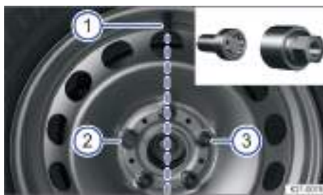
Fig. 193 Posición correcta del tornillo de rueda anti-robbo.
