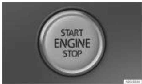
Fig. 91 En la parte inferior de la consola central: pulsador de encendido y arranque.
