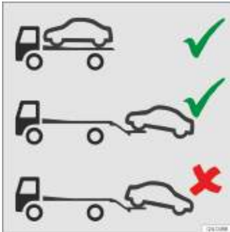
Fig. 153 Transportar con una grúa.
