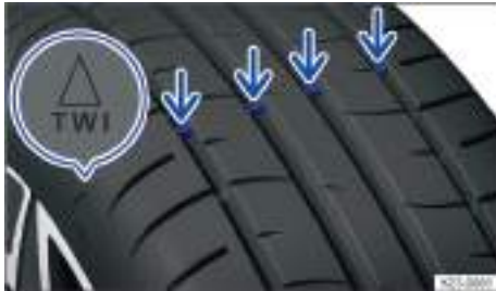
Fig. 180 En las acanaladuras del perfil: indicadores de desgaste.
