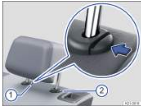
Fig. 69 Desmontaje de los apoyacabezas traseros (representación esquemática).
