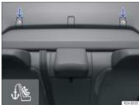
Fig. 37 En la bandeja situada detrás de los asientos traseros: anclajes Top Tether para el cinturón de fijación superior (Top Tether).
