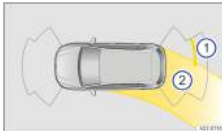
Fig. 120 Sistema de infotainment: visualización de la ayuda de aparcamiento con sensores traseros y delanteros (en función del equipamiento).
