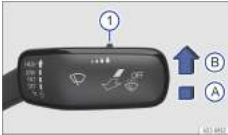
Fig. 82 En el lado derecho de la columna de dirección: palanca del limpiacristales.
