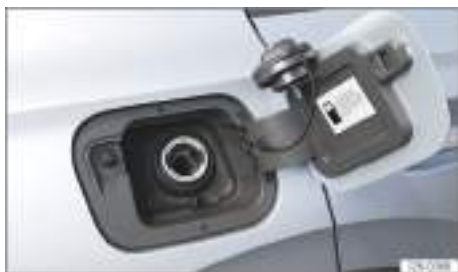
Fig. 138 Detrás de la tapa del depósito de combustible: tapón del depósito (representación esquemática).
