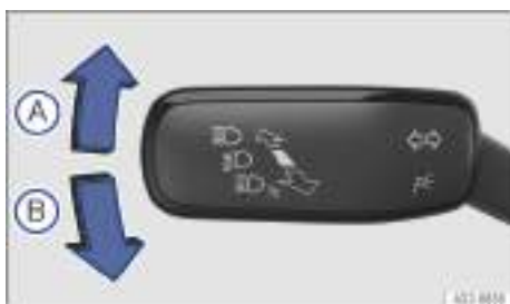
Fig. 79 En el lado izquierdo de la columna de dirección: palanca de los intermitentes y de la luz de carretera.
