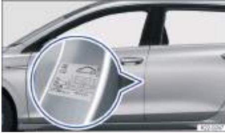
Fig. 177 En el pilar de la puerta del conductor: adhesivo de la presión de los neumáticos (o en la cara interior de la tapa del depósito de combustible).
