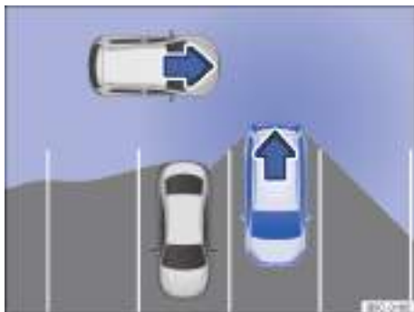
Fig. 122 Zona vigilada alrededor del vehículo que está desapareando (representación esquemática).
