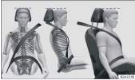
Fig. 25 Colocación correcta de la banda del cinturón y ajuste correcto del apoyacabezas (representación esquemática).
