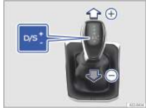
Fig. 96 En la consola central: palanca selectora en la posición Tiptronic.
