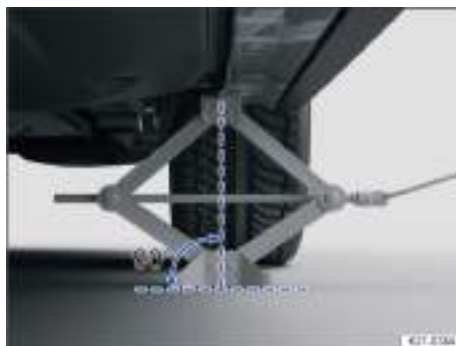
Fig. 191 En el lado izquierdo del vehículo, en la zona trasera: gato colocado (variante 2).
