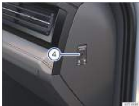
Fig. 8 Con la puerta del acompañante abierta (vehículos con el volante a la izquierda): conmutador de llave en el tablero de instrumentos (disposición simétrica en los vehículos con el volante a la derecha).
