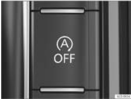
Fig. 93 En la parte inferior de la consola central o, en función del equipamiento, en el sistema de infotainment: tecla del sistema Start-Stop.
