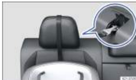
Fig. 38 En el respaldo del asiento trasero: colocación de la banda del cinturón de fijación superior (Top Tether) simple si los apoyacabezas no se pueden ajustar.
