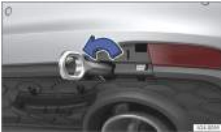
Fig. 161 En el lado derecho del paragolpes trasero: enroskar la argolla de remolque.
