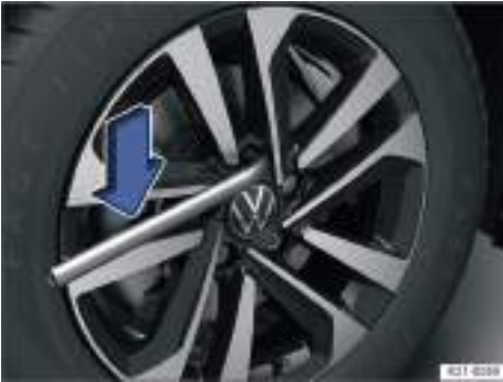
Fig. 185 Aflojar los tornillos de rueda.
