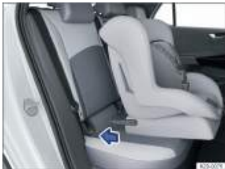
Fig. 36 Montaje de un asiento para niños con conectores (representación esquemática).
