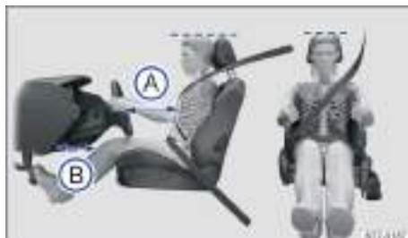
Fig. 22 Distancia correcta entre el conductor y el volante, colocación correcta de la banda del cinturón y ajuste correcto del apoyacabezas (representación esquemática).
