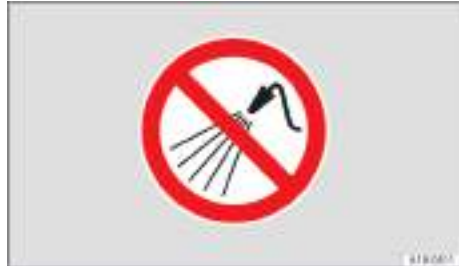
Fig. 201 En el vano delantero: no utilizar ningún equipo de limpieza de alta presión.
