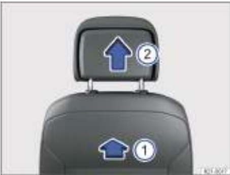
Fig. 68 Desmontaje de los apoyacabezas delanteros (representación esquemática).
