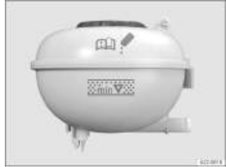
Fig. 172 En el vano delantero: marcas en el depósito de expansión del líquido refrigerante (representación esquemática).
