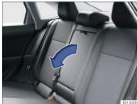
Fig. 72 En el respaldo de la plaza central del asiento: reposabrazos central trasero abatible.
