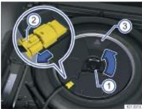
Fig. 181 Debajo del piso del maletero: desmontar el subwoofer.
