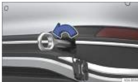
Fig. 159 En el lado derecho del paragolpes trasero: enroscar la argolla de remolque.
