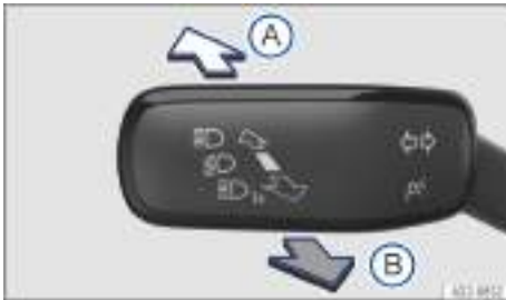
Fig. 78 En el lado izquierdo de la columna de dirección: palanca de los intermitentes y de la luz de carretera.
