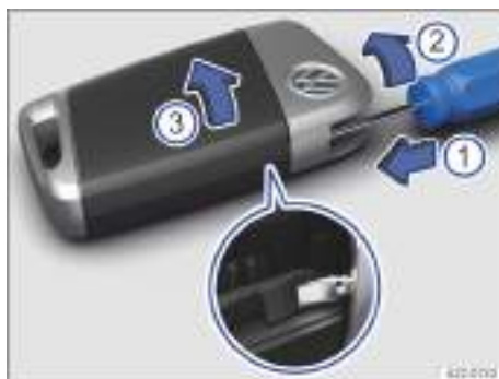
Fig. 45 Llave del vehículo: abrir la tapa del compartimento de la pila.
