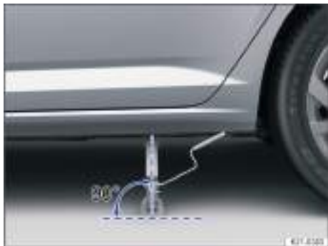
Fig. 188 Alineación correcta del gato (variante 1).
