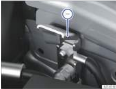
Fig. 151 En el vano delantero: toma para la ayuda de arranque, masa.
