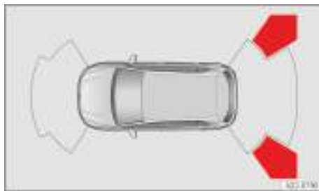
Fig. 123 Sistema de infotainment: visualización del asistente de salida del aparcamiento con sensores traseros y delanteros (en función del equipamiento).
