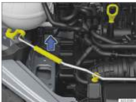
Fig. 163 En el vano delantero: varilla de sujeción del capó en su soporte (representación esquemática).
