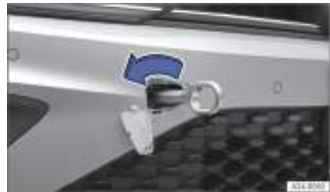
Fig. 156 En el lado derecho del paragolpes delantero: enroskar la argolla de remolque, variante 1.
