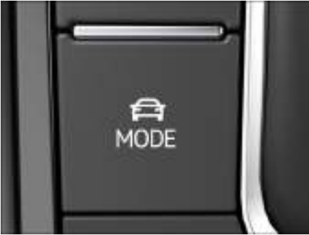
Fig. 100 En la consola central: tecla MODE para seleccionar los perfiles de conducción.
