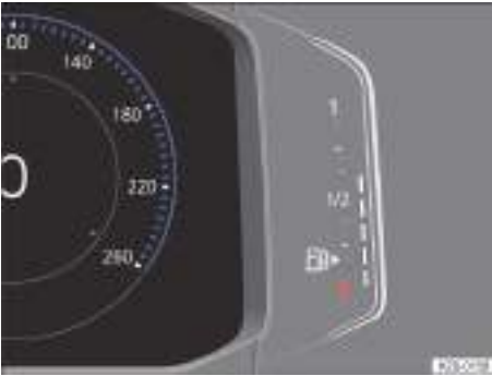
Fig. 13 En el Digital Cockpit Pro: indicador del nivel de combustible (representación esquemática).
