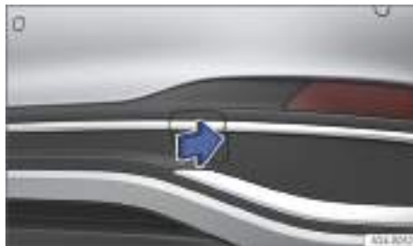
Fig. 158 En el lado derecho del paragolpes trasero: retirar la tapa.
