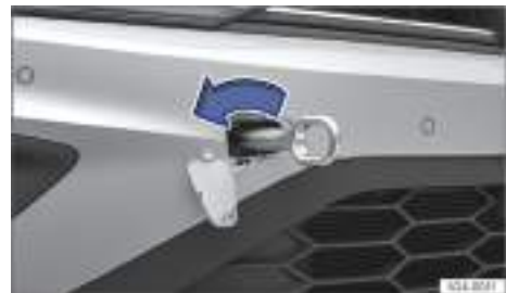
Fig. 157 En el lado derecho del paragolpes delantero: enroskar la argolla de remolque, variante 2.
