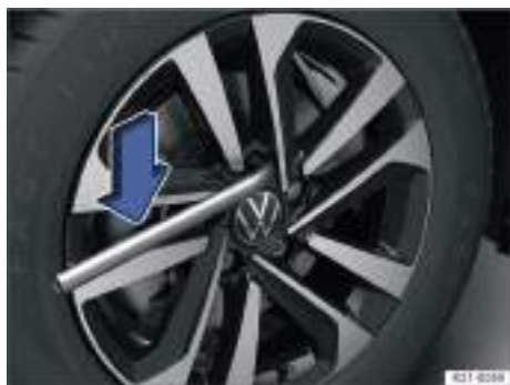
Fig. 192 Desenroscar los tornillos de rueda con la llave de rueda.
