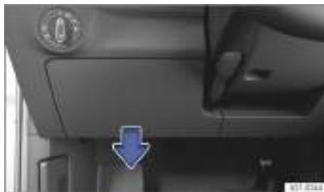
Fig. 147 En el lado izquierdo, junto al volante: tapa de la caja de fusibles del tablero de instrumentos.
