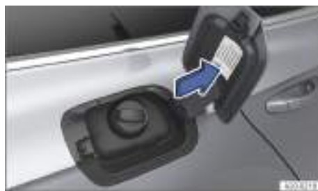
Fig. 134 En la cara interior de la tapa del depósito de combustible: adhesivo del combustible (representación esquemática).
