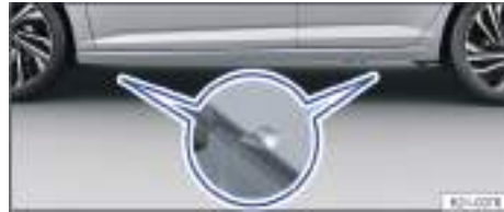
Fig. 186 En el larguero inferior: marcas para los puntos de apoyo del gato (variante 1).
