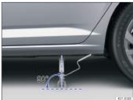
Fig. 190 Alineación correcta del gato (variante 2).
