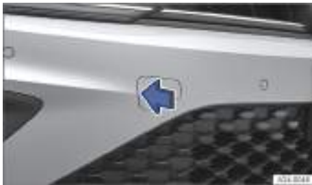
Fig. 154 En el lado derecho del paragolpes delantero: retirar la tapa, variante 1.
