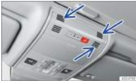
Fig. 54 En la consola del techo: sensores de la vigilancia del habitáculo (flechas).
