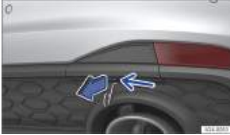
Fig. 160 En el lado derecho del paragolpes trasero: retirar la tapa.
