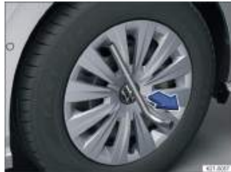
Fig. 183 Desmontar el tapacubos integral.
