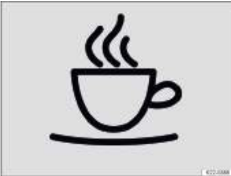
Fig. 21 En la pantalla del cuadro de instrumentos digital: símbolo del sistema de advertencia de cansancio.
