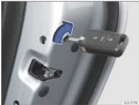
Fig. 52 En el frontal de la puerta trasera derecha: bloqueo de emergencia del vehículo con la llave de este (representación esquemática).
