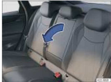
Fig. 124 En el respaldo de la plaza central del asiento: reposabrazos central trasero abatible (representación esquemática).
