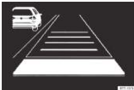
Fig. 109 En la pantalla del cuadro de instrumentos: vehículo detectado que circula más lentamente que el propio por el carril izquierdo (representación esquemática).
