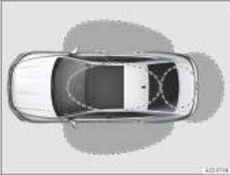
Fig. 47 Sistema "Keyless Access": radio de detección (representación esquemática).
