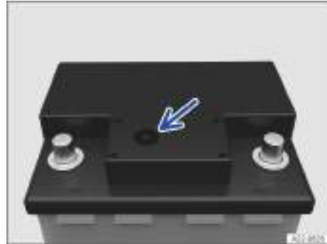
Fig. 174 En la parte superior de la batería de 12 voltios: mirilla (representación esquemática).
