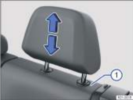
Fig. 67 Ajuste de los apoyacabezas traseros centrales (representación esquemática).
