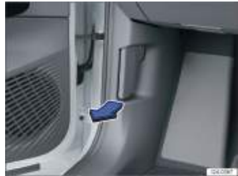
Fig. 162 En la zona reposapiés del lado del conductor: palanca de desbloqueo del capó delantero (representación esquemática).
