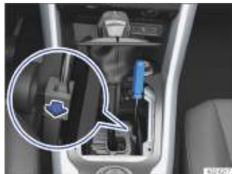
Fig. 99 En la consola central: realizar un desbloqueo de emergencia de la palanca selectora (variante 2).
