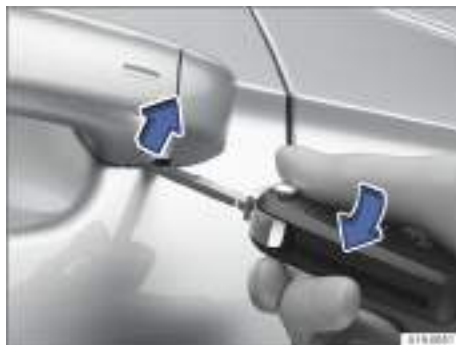
Fig. 50 Manilla de la puerta del conductor: desprender la caperuza haciendo palanca.
