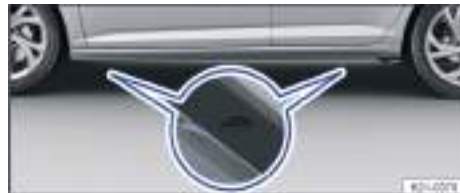
Fig. 187 En el larguero inferior: marcas para los puntos de apoyo del gato (variante 2).
