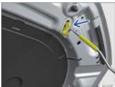
Fig. 164 En el capó delantero: alojamiento de la varilla de sujeción del capó (representación esquemática).
