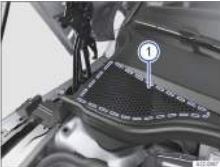
Fig. 202 Entre el vano delantero y el parabrisas: caja de aguas (representación esquemática).
