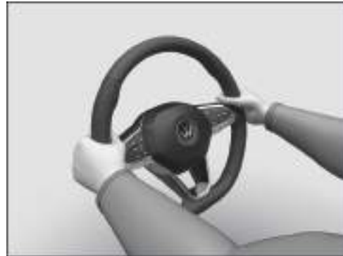
Fig. 60 En el volante: posición equivalente a las 9 y las 3 horas (representación esquemática).
