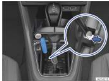
Fig. 98 En la consola central: realizar un desbloqueo de emergencia de la palanca selectora (variante 1).
