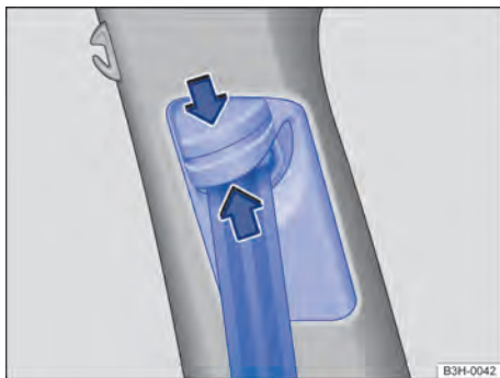
Fig. 32 Junto a los asientos delanteros: regulador de la altura del cinturón de seguridad.
