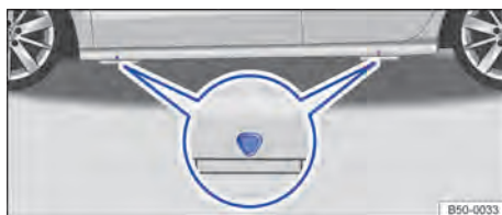
Fig. 168 Puntos de apoyo del gato.
