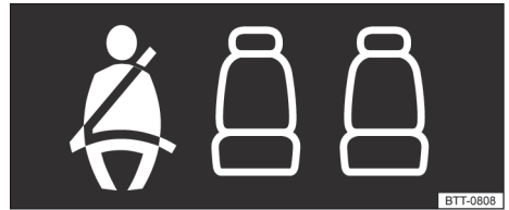
Fig. 22 Indicador de estatus del cinturón de seguridad para los asientos traseros en el display del instrumento combinado.
