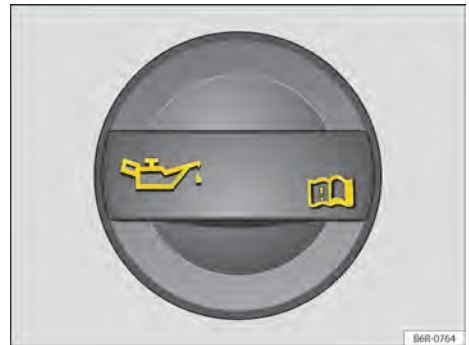
Fig. 154 En el compartimento del motor: tapón de la boca de llenado del aceite del motor.
