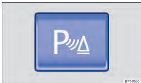
Fig. 105 En la consola central o en la pantalla de la radio: tecla de encender y apagar la ayuda de aparcamiento.
