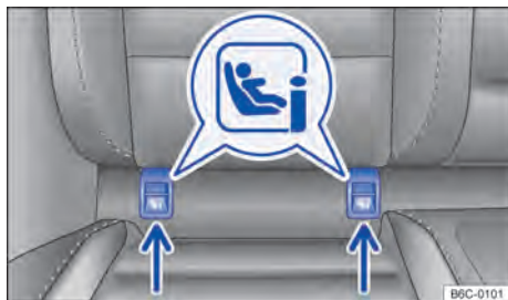
Fig. 42 En el asiento del vehículo: identificación de los puntos de anclaje inferiores de asientos para niños.
