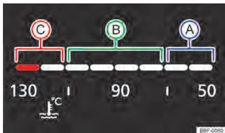
Fig. 13 Indicador de temperatura del líquido refrigerante del motor en el cuadro de instrumentos digital (variante 2): (A) área fría; (B) área normal; (C) área de advertencia.
