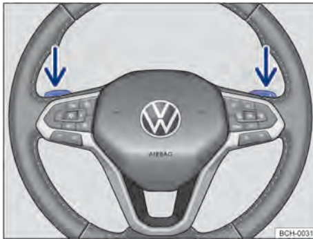
Fig. 92 Volante con selectores basculantes de Tiptronic.
