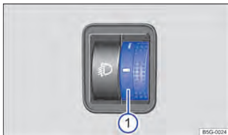
Fig. 72 Al lado del volante: regulador del alcance de las luces ①
