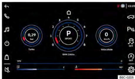
Fig. 15 En la pantalla de la radio: monitor de datos del vehículo.
