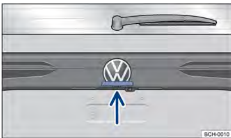
Fig. 59 En el capó del maletero: palpador para abrir el capó del maletero.
