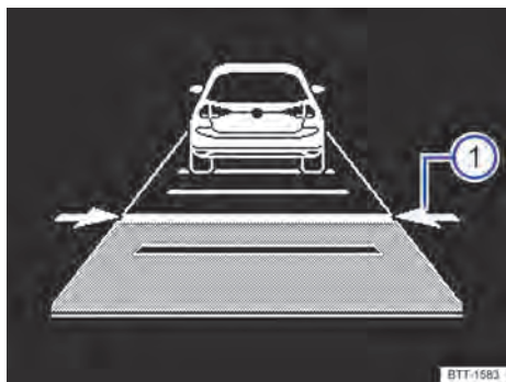
Fig. 102 En la pantalla del cuadro de instrumentos: ajustar la distancia (representación esquemática, el ACC regula).
