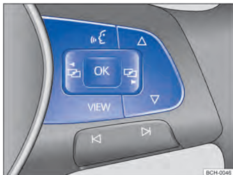
Fig. 17 Lado derecho del volante multifunción (variante 1): teclas para el mando de los menús y visualizaciones de información del instrumento combinado.
