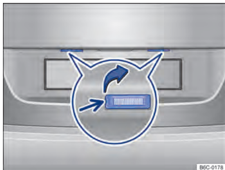
Fig. 138 En el capó del maletero: luz de matrícula.
