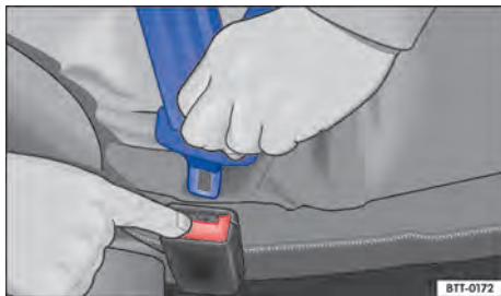
Fig. 29 Soltar la pestaña de encastre del cinturón de seguridad del cierre del cinturón.
