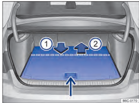
Fig. 126 En el maletero: regular la altura del piso variable del maletero.
