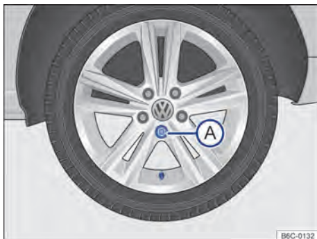
Fig. 170 Retire el tapacubos integral.
