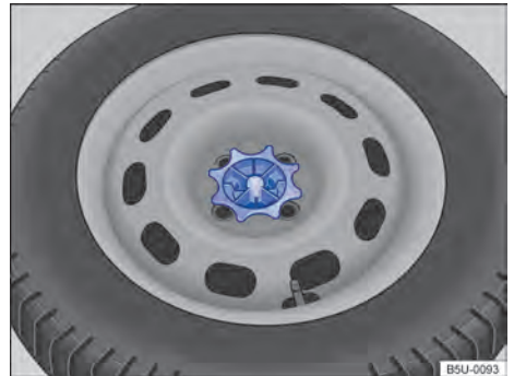
Fig. 163 En el maletero: asidero para fijación de la rueda de emergencia.
