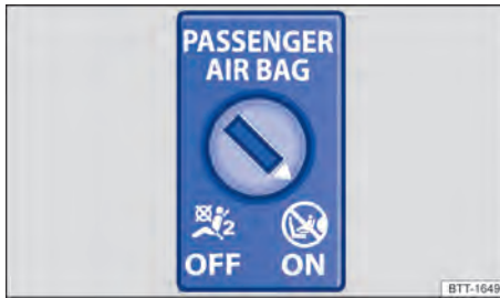
Fig. 36 En el panel de instrumentos en el lado del acompañante delantero: interruptor accionado por la llave para desconectar y conectar el airbag frontal del acompañante delantero.
