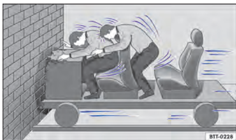
Fig. 24 Un vehículo con los ocupantes sin cinturones de seguridad choca contra el muro.
