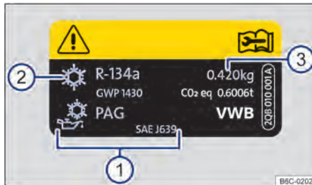
Fig. 176 Información del aire acondicionado - motor 1.0L TSI, motor 1.4L TSI y motor 1.6L.
