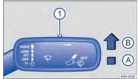
Fig. 74 A la derecha de la columna de dirección: palanca de los limpiaparabrisas.
