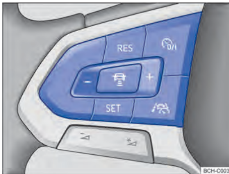
Fig. 101 Lado izquierdo del volante multifunción: teclas para mando del ACC. (variante 2)
