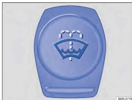
Fig. 163 En el compartimento del motor: tapón de cierre del depósito de agua de los lavacristales.
