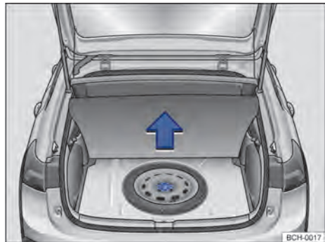
Fig. 143 En el maletero, por debajo del revestimiento del piso: rueda de emergencia y herramientas de a bordo.
