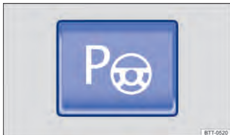
Fig. 115 En la consola central: tecla de encender el asistente de dirección de ayuda para aparcamiento.
