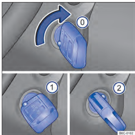
Fig. 87 Al lado del volante de la dirección, a la derecha: posiciones de la llave del vehículo en la cerradura de encendido.
