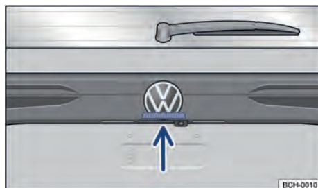
Fig. 57 En el capó del maletero: palpador para abrir e capó del maletero.
