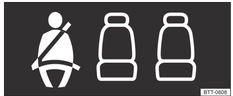
Fig. 20 Indicador de estatus del cinturón de seguridad para los asientos traseros en el display del instrumento combinado.
