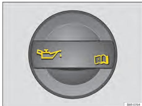
Fig. 166 En el compartimento del motor: tapón de la boca de llenado del aceite del motor.
