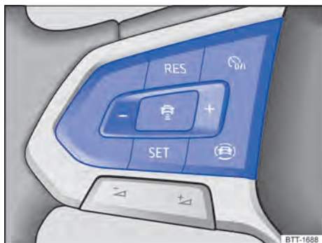
Fig. 104 Lado izquierdo del volante multifunción: teclas para mando del ACC. (variante 1)
