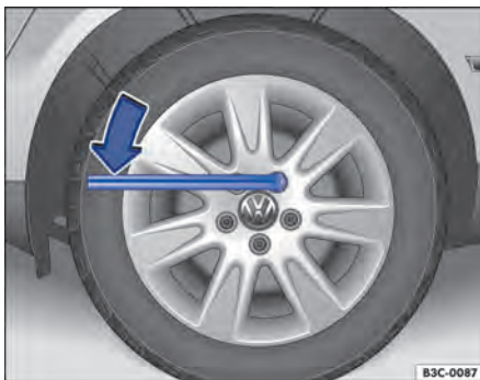
Fig. 177 Cambio de rueda: aflojar los tornillos de la rueda.
