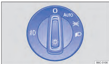
Fig. 70 Al lado del volante: interruptor de luces (una variante).
