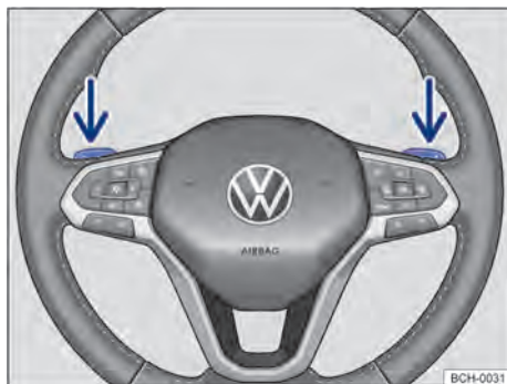
Fig. 94 Volante con selectores basculantes de Tiptronic.
