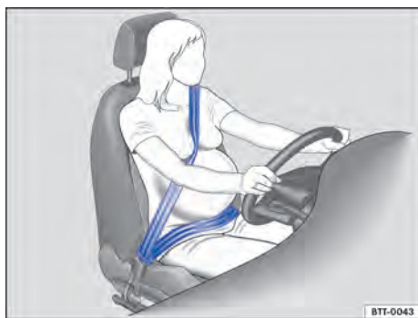
Fig. 29 Posición correcta de la banda del cinturón para mujeres embarazadas.
