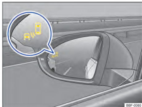
Fig. 110 En los retrovisores exteriores: indicador del detector de ángulo muerto.
