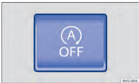
Fig. 90 En la parte superior de la consola central: tecla del sistema Start-Stop.
