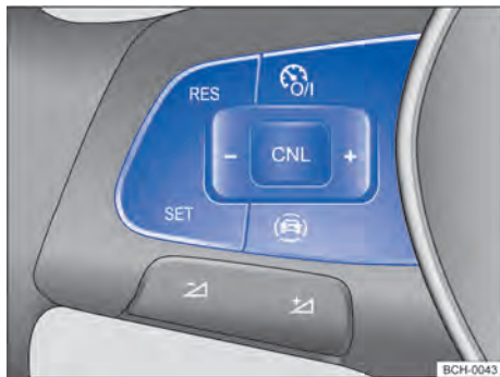
Fig. 97 Lado izquierdo del volante multifunción (variante 1): teclas para controlar el GRA
