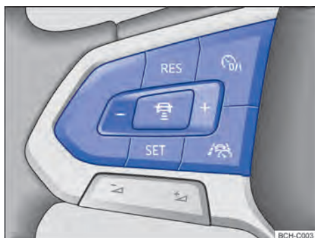
Fig. 105 Lado izquierdo del volante multifunción: teclas para mando del ACC. (variante 2)
