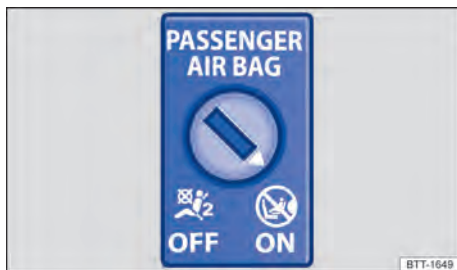
Fig. 34 En el panel de instrumentos en el lado del acompañante delantero: interruptor accionado por la llave para desconectar y conectar el airbag frontal del acompañante delantero.
