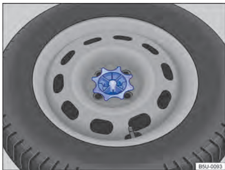
Fig. 175 En el maletero: asidero para fijación de la rueda de emergencia.
