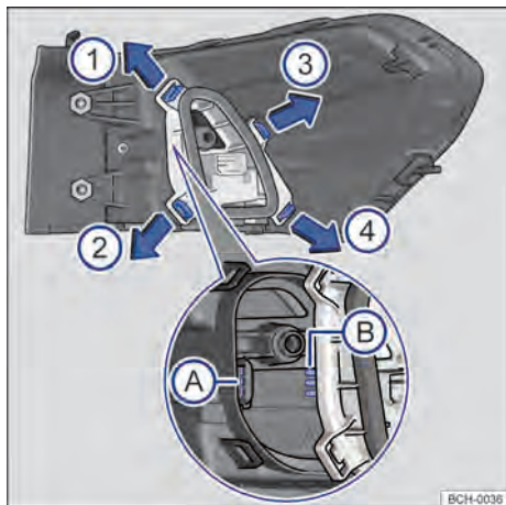
Fig. 150 Linterna trasera: desmontar el portalámparas.
