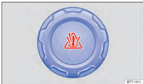
Fig. 168 En el compartimento del motor: tapa del depósito de expansión del líquido refrigerante del motor.
