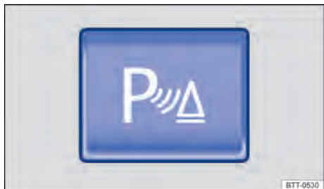
Fig. 98 En la consola central o en la pantalla de la radio: tecla de encender y apagar la ayuda de aparcamiento.
