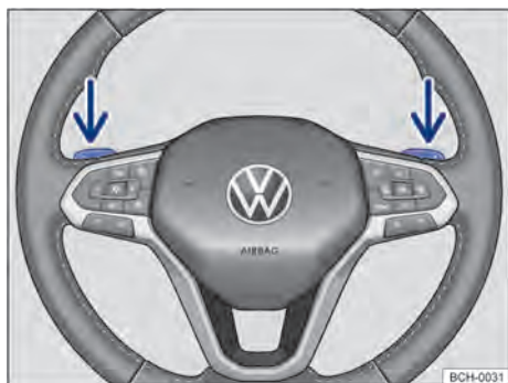
Fig. 94 Volante con selectores basculantes de Tiptronic.
