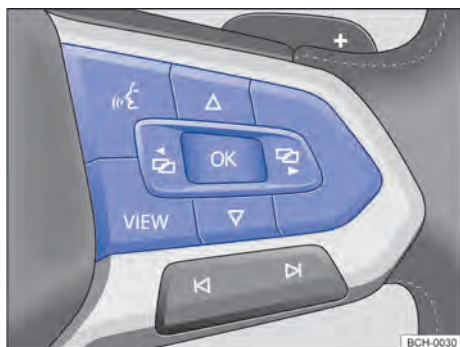
Fig. 20 Lado derecho del volante multifunción (variante 2): teclas para el mando de los menús y visualizaciones de información del instrumento combinado.
