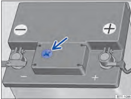
Fig. 158 En el compartimento del motor: ejemplo de posición del visor en el lado superior de la batería del vehículo.
