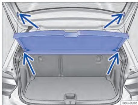
Fig. 118 En el maletero: desmontar y montar la bandeja trasera.
