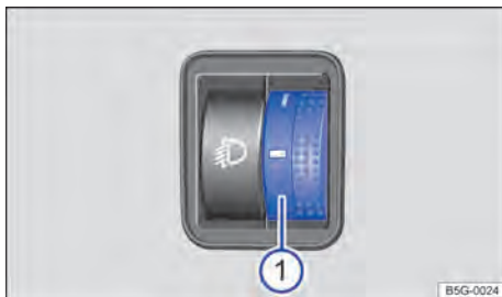
Fig. 72 Al lado del volante: regulador de alcance de las luces ①.
