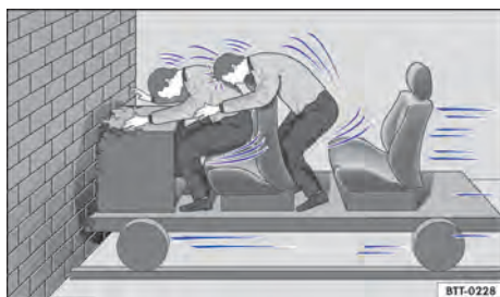
Fig. 26 Un vehículo con los ocupantes sin cinturones de seguridad choca contra el muro.
