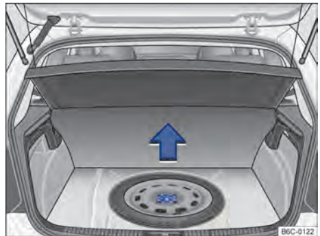
Fig. 126 En el maletero, por debajo del revestimiento del piso: rueda de emergencia y herramientas de a bordo.
