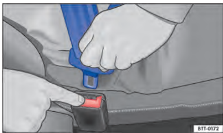
Fig. 31 Soltar la pestaña de encastre del cinturón de seguridad del cierre del cinturón.
