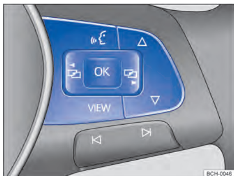
Fig. 19 Lado derecho del volante multifunción (variante 1): teclas para el mando de los menús y visualizaciones de información del instrumento combinado.
