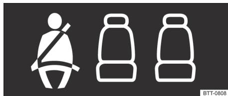
Fig. 24 Indicador de estatus del cinturón de seguridad para los asientos traseros en el display del instrumento combinado.
