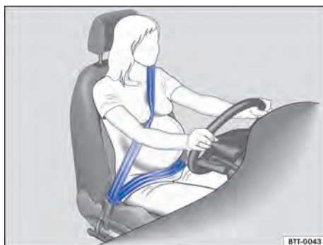
Fig. 33 Posición correcta de la banda del cinturón para mujeres embarazadas.
