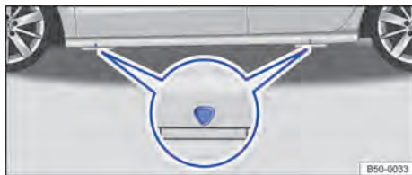
Fig. 167 Puntos de apoyo del gato.
