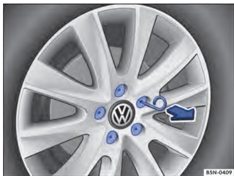
Fig. 165 Retirar las caperuzas de los tornillos de la rueda.
