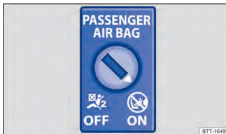
Fig. 38 En el panel de instrumentos en el lado del acompañante delantero: interruptor accionado por la llave para desconectar y conectar el airbag frontal del acompañante delantero.
