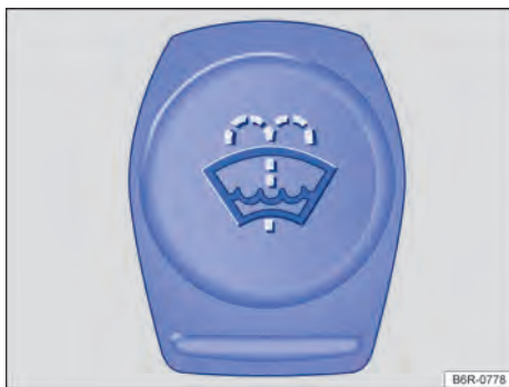
Fig. 151 En el compartimento del motor: tapón de cierre del depósito de agua de los lavacrystales.
