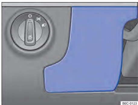
Fig. 141 Del lado del conductor en el panel de instrumentos: cubierta de la caja de fusibles.
