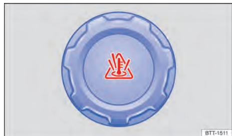
Fig. 175 En el compartimento del motor: tapa del depósito de expansión del líquido refrigerante del motor.
