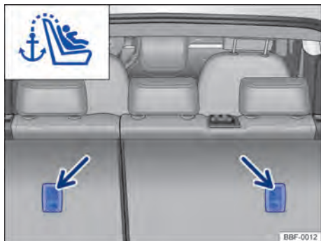
Fig. 41 Ojales de retención para el cinturón de fijación superior en el lado de atrás del asiento trasero.
