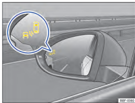
◀ Fig. 116 En los retrovisores exteriores: indicador del detector de ángulo muerto.
