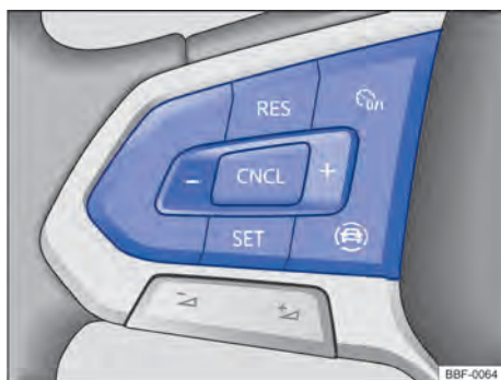
Fig. 104 Lado izquierdo del volante multifunción (variante 2): teclas para controlar el GRA.
