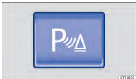
Fig. 118 En la consola central: tecla de encender y apagar la ayuda de aparcamiento.
