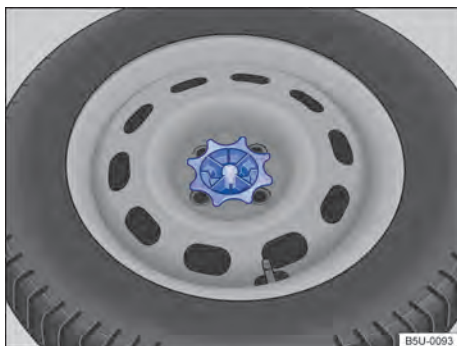
Fig. 182 En el maletero: asidero para fijación de la rueda de emergencia.
