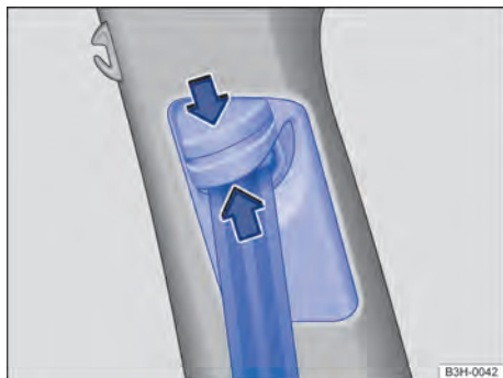
Fig. 30 Junto a los asientos delanteros: dispositivo-guía para ajuste de la altura del cinturón de seguridad.
