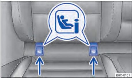
Fig. 40 En el asiento del vehículo: identificación de los puntos de anclaje inferiores de asientos para niños.
