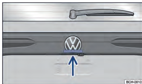
Fig. 56 En el capó del maletero: palpador para abrir e capó del maletero.
