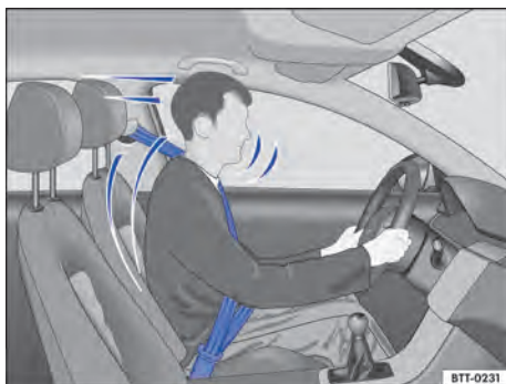
Fig. 25 Conductor protegido por el cinturón de seguridad correctamente colocado en una maniobra de frenado súbita.
