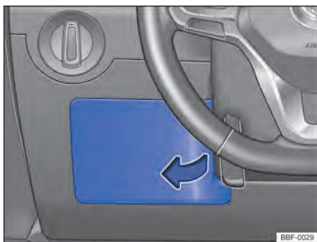
Fig. 158 Del lado del conductor en el panel de instrumentos: cubierta de la caja de fusibles.
