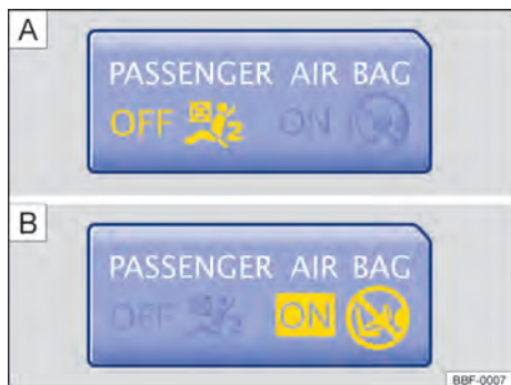
Fig. 31 En la parte superior de la consola central: luz de control para el airbag frontal del acompañante delantero apagada [A] o luz de control para el airbag frontal del acompañante delantero encendida [B].
