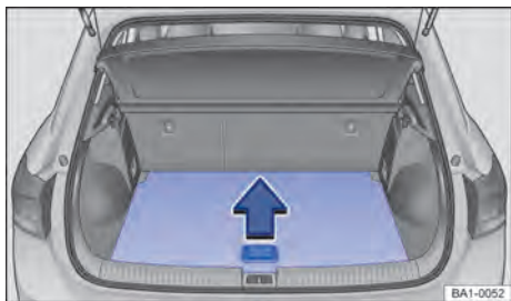
Fig. 145 En el maletero: levantar el piso del maletero.
