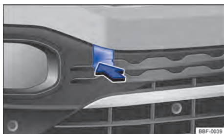
Fig. 165 En el parachoques delantero a la derecha: suelte y desmonte la cubierta.
