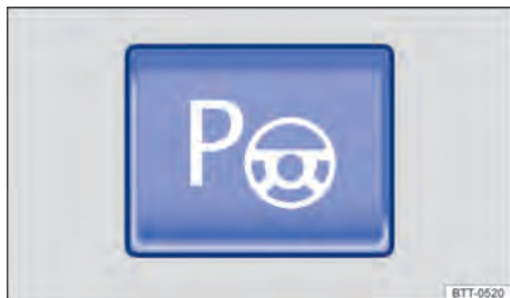
Fig. 121 En la consola central: tecla de encender el asistente de dirección de ayuda para aparcamiento.
