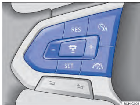
Fig. 111 Lado izquierdo del volante multifunción: teclas para mando del ACC. (variante 2)
