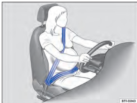
Fig. 29 Posición correcta de la banda del cinturón para mujeres embarazadas.
