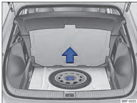
Fig. 150 En el maletero, por debajo del revestimiento del piso: rueda de emergencia y herramientas de a bordo.
