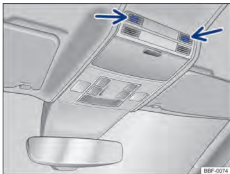
Fig. 55 En la consola del techo: sensores de vigilancia del habitáculo (flechas).
