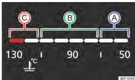
Fig. 13 Indicador de temperatura del líquido refrigerante del motor en el cuadro de instrumentos digital (variante 2): (A) área fría; (B) área normal; (C) área de advertencia.
