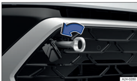
Fig. 162 En el lado derecho del paragolpes delantero: enroskar la argolla de remolque.
