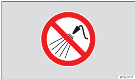
Fig. 196 En el vano delantero: no utilizar ningún equipo de limpieza de alta presión.
