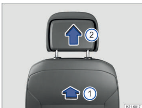
Fig. 68 Desmontaje de los apoyacabezas delanteros (representación esquemática).
