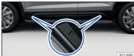
Fig. 190 En el larguero inferior: marcas para los puntos de apoyo del gato.
