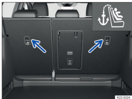
Fig. 40 En la parte posterior de los asientos traseros: anclajes Top Tether para el cinturón de fijación superior Top Tether (representación esquemática).
