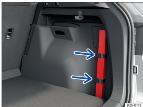
Fig. 42 En el lado derecho del maletero: soporte del triángulo de preseñalización.
