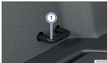
Fig. 134 En el maletero: argollas de amarre (representación esquemática).
