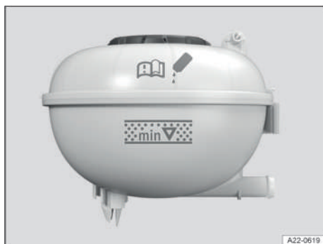
Fig. 176 En el vano delantero: marcas en el depósito de expansión del líquido refrigerante (representación esquemática).
