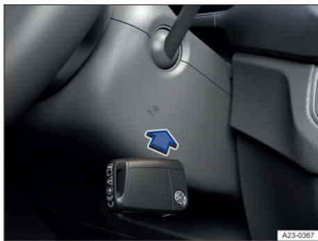
Fig. 89 En el lado derecho de la columna de dirección: función de arranque de emergencia en los vehículos con el sistema de cierre y arranque sin llave "Keyless Access" (representación esquemática).
