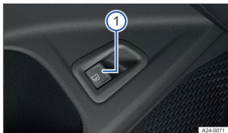
Fig. 144 En la puerta del conductor: tecla de desbloqueo de la tapa del depósito de combustible (representación esquemática).
