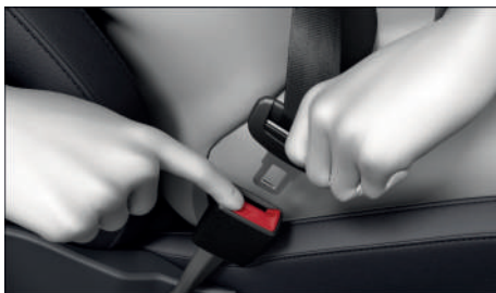
Fig. 27 Soltar la lengüeta del cierre del cinturón (representación esquemática).
