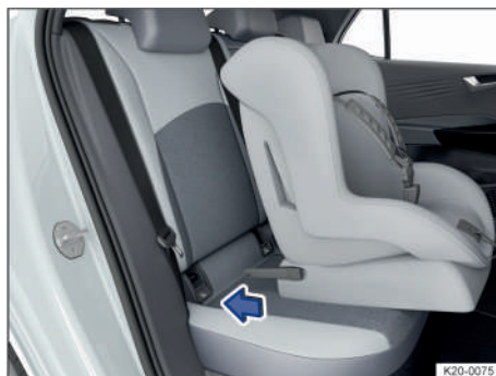
Fig. 39 Montaje de un asiento para niños con conectores (representación esquemática).
