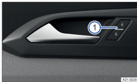
Fig. 50 En la puerta del conductor: tecla del cierre centralizado (representación esquemática).
