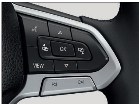
Fig. 10 Lado derecho del volante multifunción: manejo del Digital Cockpit Pro (representación esquemática).
