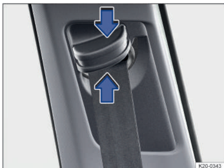
Fig. 30 Junto a los asientos delanteros: regulador de la altura del cinturón.
