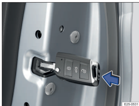
Fig. 53 En el frontal de la puerta trasera: bloqueo de emergencia del vehículo con el paletón de la llave o la llave de emergencia (representación esquemática).
