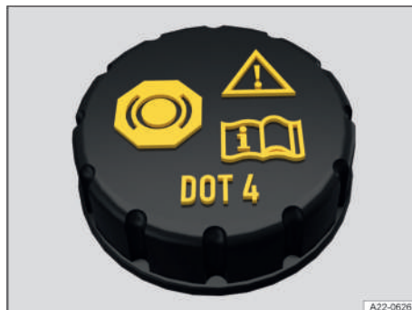
Fig. 177 En el vano delantero: tapa del depósito del líquido de frenos.
