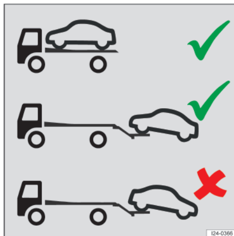
Fig. 160 Transportar con una grúa.
