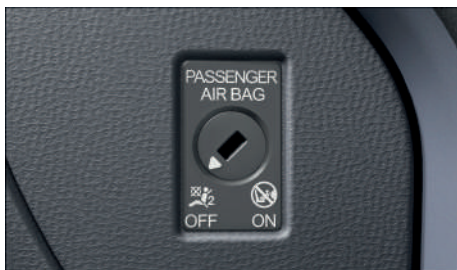
Fig. 32 En el tablero de instrumentos, en el lado del acompañante: conmutador de llave para desactivar y activar el airbag frontal del acompañante.
