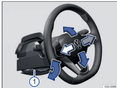
Fig. 60 Debajo del volante, en el guarnecido de la columna de dirección: palanca para el ajuste manual de la posición del volante (representación esquemática).
