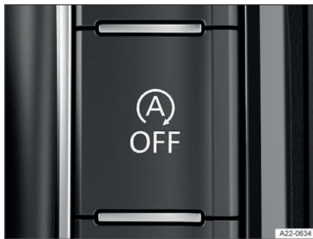
Fig. 90 En la parte inferior de la consola central o, en función del equipamiento, en el sistema de infotainment: tecla del sistema Start-Stop.
