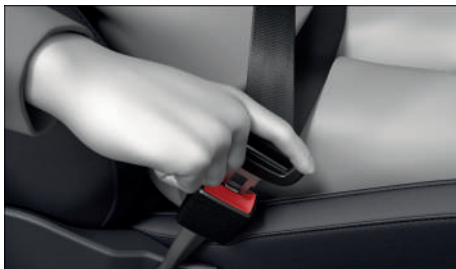
Fig. 26 Insertar la lengüeta del cinturón de seguridad en su cierre (representación esquemática).
