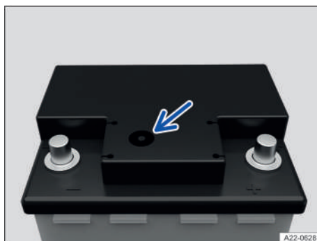
Fig. 178 En la parte superior de la batería de 12 voltios: mirilla (representación esquemática).
