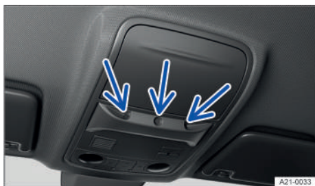
Fig. 55 En la consola del techo: sensores de la vigilancia del habitáculo (flechas).
