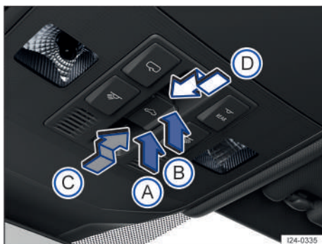
Fig. 59 En el revestimiento interior del techo: tecla del techo de cristal.
