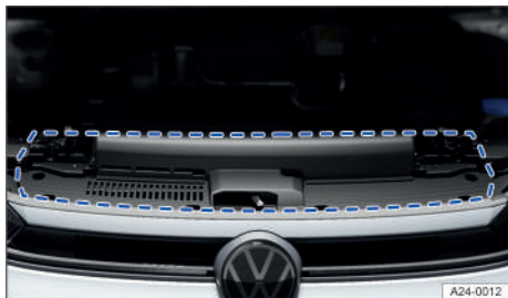
Fig. 171 En el vano delantero: zona para el adhesivo relativo al aceite del motor (representación esquemática).
