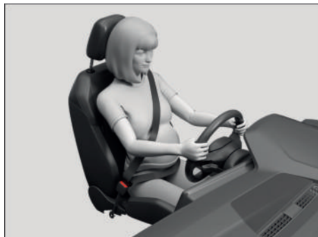
Fig. 29 Colocación correcta de la banda del cinturón en las mujeres embarazadas (representación esquemática).
