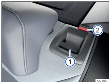
Fig. 65 En el respaldo del asiento trasero: tecla de desbloqueo.
