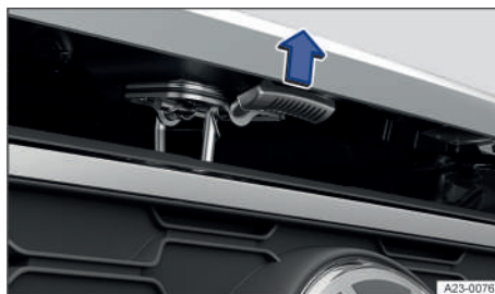
Fig. 166 Encima de la parrilla del radiador: palanca de accionamiento del capó delantero (representación esquemática).
