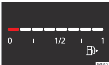
Fig. 14 En el Digital Cockpit: indicador del nivel de combustible (representación esquemática).
