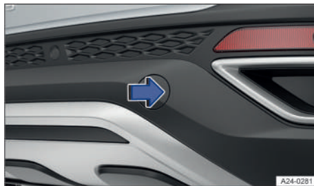
Fig. 163 En el lado derecho del paragolpes trasero: retirar la tapa.
