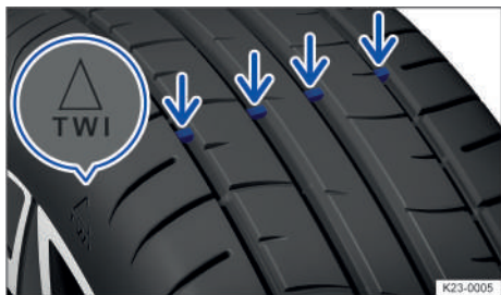
Fig. 184 En las acanaladuras del perfil: indicadores de desgaste.
