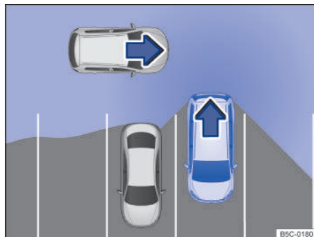
Fig. 121 Zona vigilada alrededor del vehículo que está desaparcando (representación esquemática).
