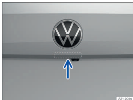
Fig. 56 En el portón trasero: pulsador para abrir el portón (representación esquemática).
