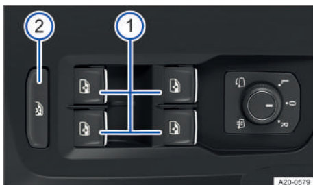
Fig. 58 En la puerta del conductor: teclas de los elevalunas.
