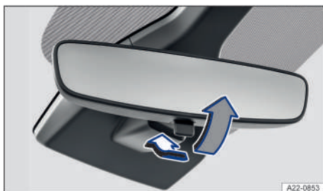
Fig. 81 En el parabrisas: retrovisor interior antideslumbrante manual.
