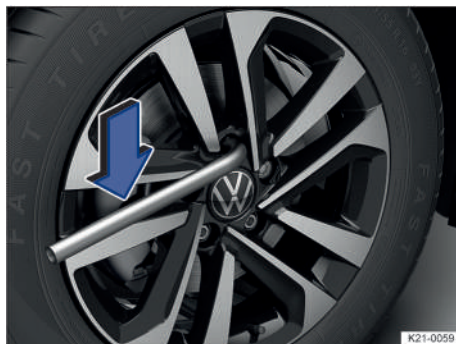
Fig. 189 Aflojar los tornillos de rueda.
