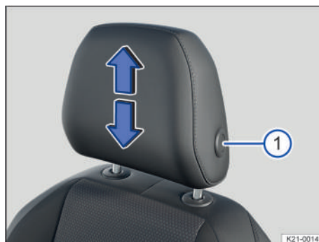
Fig. 66 Desmontaje de los apoyacabezas delanteros (representación esquemática).
