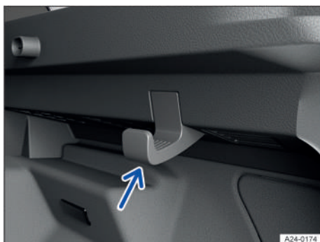
Fig. 135 En el maletero, a ambos lados: ganchos para bolsas.
