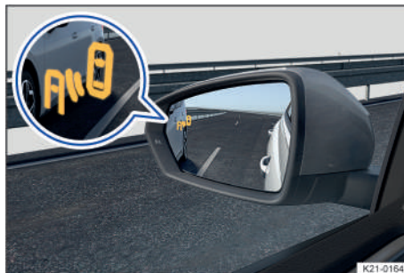
◀ Fig. 112 En los espejos de los retrovisores exteriores: indicación del detector de ángulo muerto.
