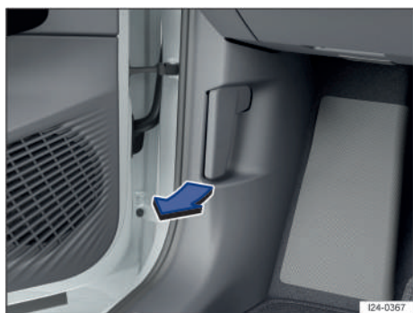
Fig. 165 En la zona reposapiés del lado del conductor: palanca de desbloqueo del capó delantero (representación esquemática).
