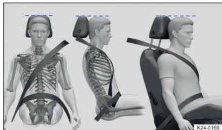
Fig. 28 Colocación correcta de la banda del cinturón y ajuste correcto del apoyacabezas (representación esquemática).
