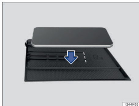
Fig. 128 En la consola central: estera permeable al aire para la función de carga inalámbrica (representación esquemática). La potencia de carga es de 15 W.
