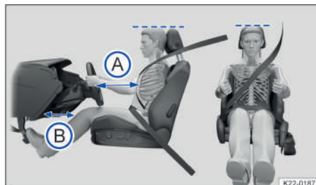
Fig. 25 Distancia correcta entre el conductor y el volante, colocación correcta de la banda del cinturón y ajuste correcto del apoyacabezas (representación esquemática).
