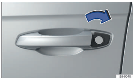
Fig. 52 Manilla de la puerta del conductor: realizar un cierre de emergencia.
