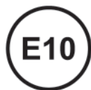
Fig. 140 Distintivo de gasolina con un 10 % de etanol.
