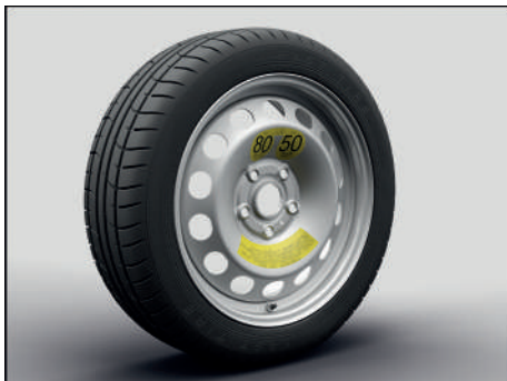
Fig. 179 Rueda de repuesto de tamaño reducido.
