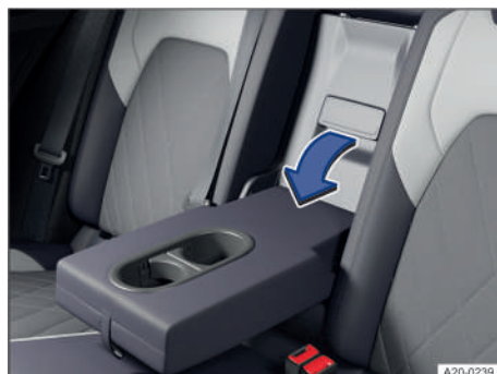
Fig. 136 En el respaldo del asiento trasero: trampilla para cargas largas (representación esquemática).
