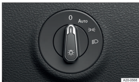
Fig. 73 Junto al volante: mando de las luces.
