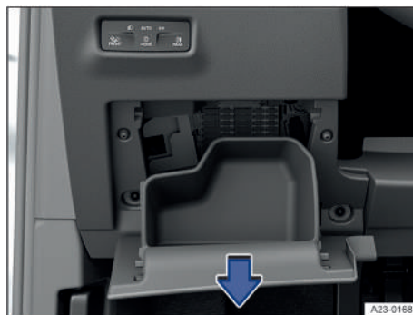
Fig. 157 Junto al volante, en el lado izquierdo: tapa de la caja de fusibles del tablero de instrumentos (vehículos con el volante a la izquierda).
