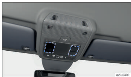
Fig. 79 En la consola del techo: luces de lectura táctiles.
