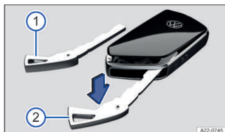
Fig. 43 Llave del vehículo: abrir la tapa del compartimento de la pila.
