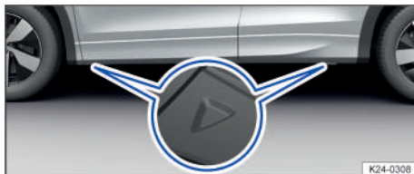
Fig. 189 En el larguero inferior: marcas para los puntos de alojamiento del gato.
