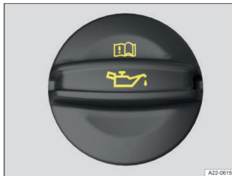
Fig. 171 En el vano delantero: tapa de la boca de llenado del aceite del motor (representación esquemática).
