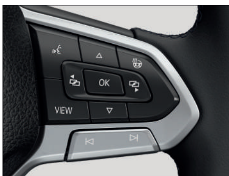
Fig. 9 Lado derecho del volante multifunción: manejo del Digital Cockpit Pro (representación esquemática).
