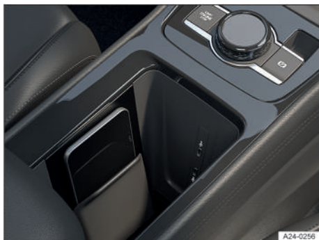
Fig. 133 En la consola central: portaobjetos con soporte para la función de carga inalámbrica (representación esquemática). La potencia de carga es de hasta 15 W.
