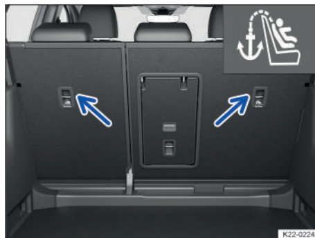
Fig. 33 En la parte posterior de los asientos traseros: anclajes Top Tether para el cinturón de fijación superior Top Tether (representación esquemática).
