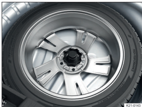
Fig. 186 Debajo del piso del maletero: ruedecilla para fijar la rueda de repuesto.
