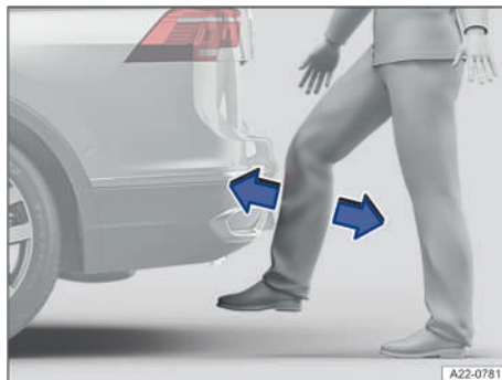
Fig. 55 Representación esquemática del portón trasero con cierre controlado por sensor (Easy Close).
