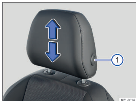
Fig. 65 Desmontaje de los apoyacabezas delanteros (representación esquemática).
