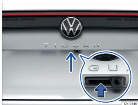
Fig. 51 En el portón trasero: pulsador para abrir el portón.
