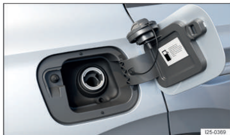
Fig. 148 Detrás de la tapa del depósito de combustible: tapón del depósito (representación esquemática).
