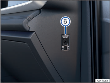
Fig. 7 Con la puerta del acompañante abierta (vehículos con el volante a la izquierda); conmutador de llave en el tablero de instrumentos (disposición simétrica en los vehículos con el volante a la derecha).
