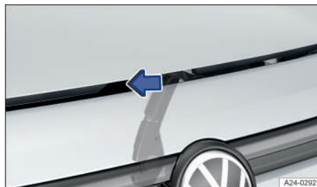
Fig. 166 Encima de la parrilla del radiador: palanca de accionamiento del capó delantero.
