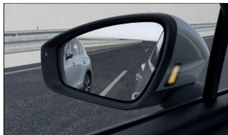
Fig. 114 En la carcasa de los retrovisores exteriores: indicaciones del Side Assist.
