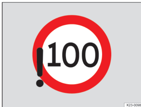
Fig. 16 En la pantalla del cuadro de instrumentos digital: detección de limitación de velocidad excedida (representación esquemática).
