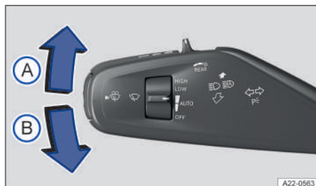
Fig. 73 En el lado izquierdo de la columna de dirección: palanca de los intermitentes, la luz de carretera y el limpiacristales.
