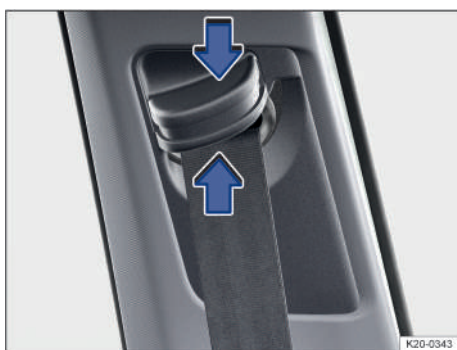
Fig. 23 Junto a los asientos delanteros: regulador de la altura del cinturón.
