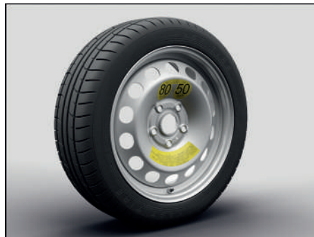
Fig. 177 Rueda de repuesto de tamaño reducido.
