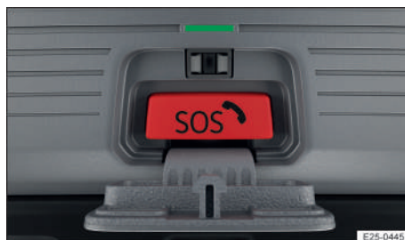
Fig. 40 En la consola del techo: tecla del sistema de llamada de emergencia eCall obligatorio por ley.
