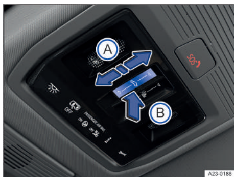
Fig. 57 En el revestimiento interior del techo: botón del techo de cristal.
