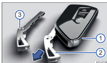
Fig. 42 Llave del vehículo: desbloqueo de la llave de emergencia (representación esquemática).
