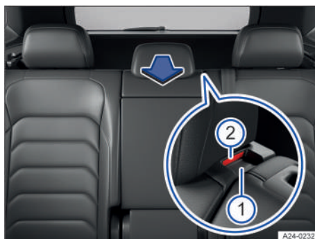
Fig. 142 En el respaldo del asiento trasero: apertura de la trampilla para cargas largas.
