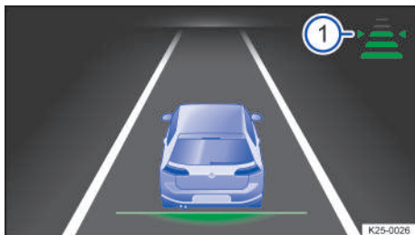
Fig. 109 En la pantalla del cuadro de instrumentos: distancia ajustada durante la regulación (representación esquemática).
