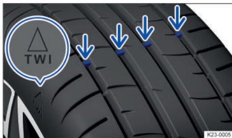
Fig. 182 En las acanaladuras del perfil: indicadores de desgaste.
