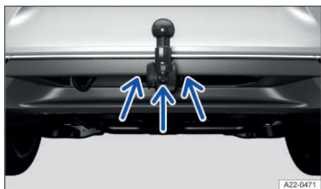
Fig. 143 En el dispositivo de remolque: argolla para fijar el cable de seguridad o el de ruptura (representación esquemática).
