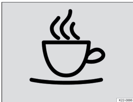
Fig. 12 En la pantalla del cuadro de instrumentos digital: símbolo del sistema de advertencia de cansancio.
