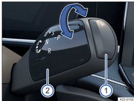
Fig. 91 En el lado derecho de la columna de dirección: selector de marchas del cambio automático.
