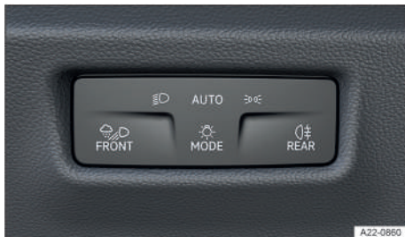
Fig. 74 Junto al volante: panel de mandos para conectar y desconectar el alumbrado exterior.
