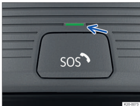
Fig. 36 En la consola del techo: tecla del Servicio de Llamada de emergencia (detrás de una tapa) y testigo de control.
