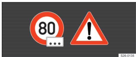
Fig. 15 En la pantalla del cuadro de instrumentos digital: indicaciones del sistema de detección de señales de tráfico con panel complementario detectado (representación esquemática).
