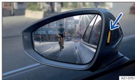
Fig. 116 En la carcasa del retrovisor exterior: indicación del sistema de advertencia de apertura de puertas (representación esquemática).
