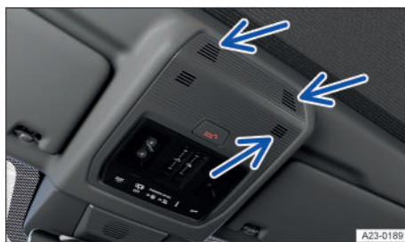
Fig. 50 En la consola del techo: sensores de la vigilancia del habitáculo (flechas).
