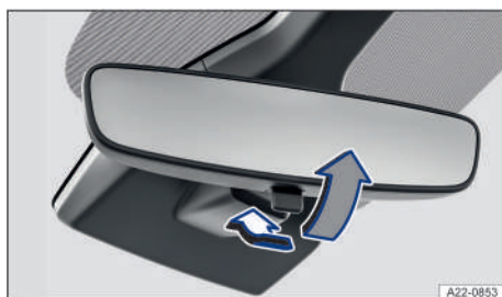
Fig. 83 En el parabrisas: retrovisor interior antideslumbrante manual.
