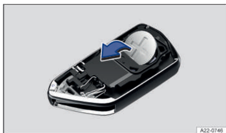
Fig. 44 Llave del vehículo: cambiar la pila de botón.
