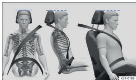
Fig. 21 Colocación correcta de la banda del cinturón y ajuste correcto del apoyacabezas (representación esquemática).
