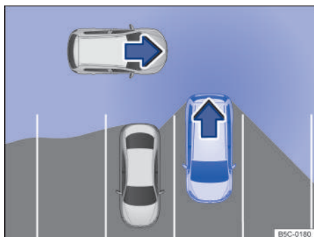
Fig. 128 Zona vigilada alrededor del vehículo que está desaparcando (representación esquemática).
