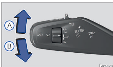
Fig. 78 En el lado izquierdo de la columna de dirección: palanca de los intermitentes, la luz de carretera y el limpiacristales.
