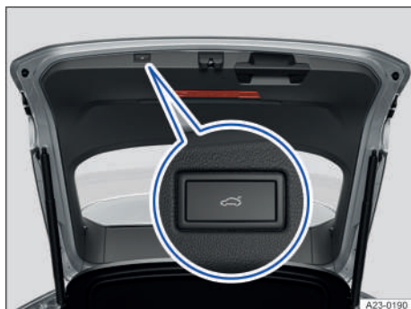
Fig. 53 En el portón trasero abierto: tecla para el cierre eléctrico del portón.
