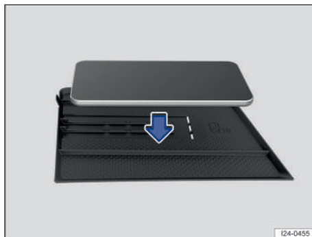
Fig. 126 En la consola central: estera permeable al aire para la función de carga inalámbrica (representación esquemática). La potencia de carga es de 15 W.
