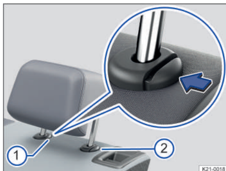
Fig. 69 Desmontaje de los apoyacabezas traseros (representación esquemática).
