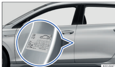
Fig. 176 En el pilar de la puerta del conductor: adhesivo de la presión de los neumáticos (o en la cara interior de la tapa del depósito de combustible).
