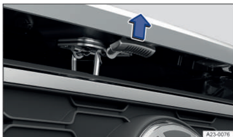
Fig. 161 Encima de la parrilla del radiador: palanca de accionamiento del capó delantero (representación esquemática).
