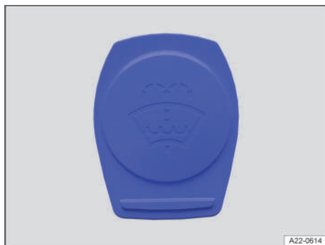
Fig. 165 En el vano delantero: tapa del depósito del líquido lavacrystales (representación esquemática).
