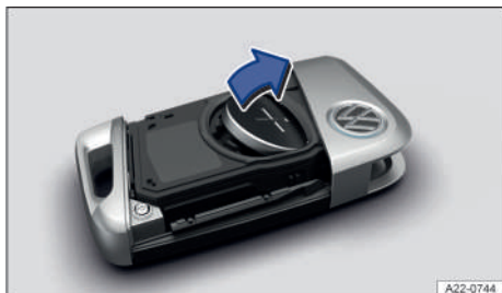
Fig. 46 Llave del vehículo: cambiar la pila de botón.
