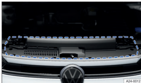
Fig. 166 En el vano delantero: zona para el adhesivo relativo al aceite del motor (representación esquemática).
