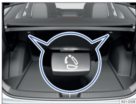
Fig. 64 En el maletero: palanca de desbloqueo desde el maletero.
