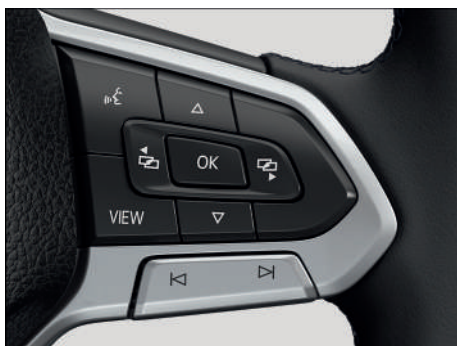
Fig. 12 Lado derecho del volante multifunción: manejo del Digital Cockpit (representación esquemática).
