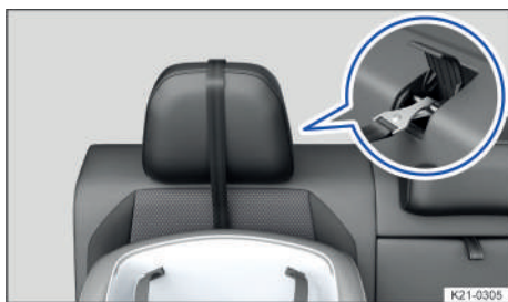
Fig. 38 En el respaldo del asiento trasero: colocación de la banda del cinturón de fijación superior (Top Tether) simple si los apoyacabezas no se pueden ajustar.
