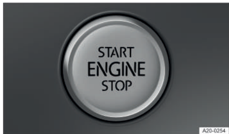
Fig. 90 En la parte inferior de la consola central: pulsador de encendido y arranque.
