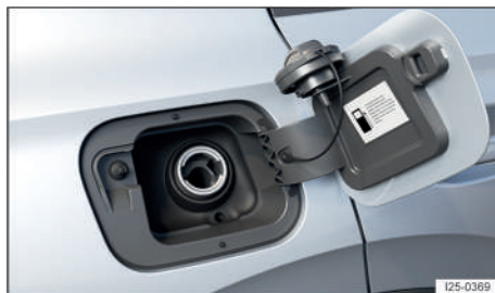
Fig. 136 Detrás de la tapa del depósito de combustible: tapón del depósito (representación esquemática).
