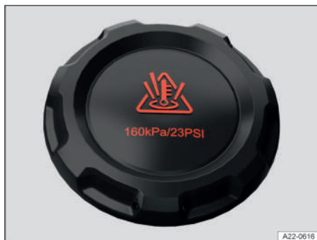
Fig. 170 En el vano delantero: tapa del depósito de expansión del líquido refrigerante (representación esquemática).
