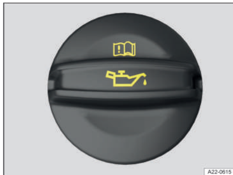
Fig. 168 En el vano delantero: tapa de la boca de llenado del aceite del motor (representación esquemática).
