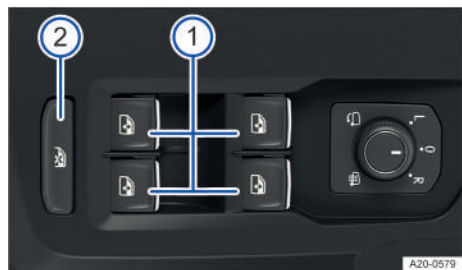
Fig. 57 En la puerta del conductor: teclas de los elevallunas.
