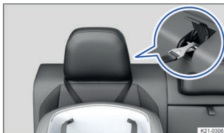
Fig. 39 En el respaldo del asiento trasero: colocación de la banda del cinturón de fijación superior (Top Tether) en forma de V si los apoyacabezas no se pueden ajustar.
