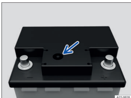
Fig. 173 En la parte superior de la batería de 12 voltios: mirilla (representación esquemática).
