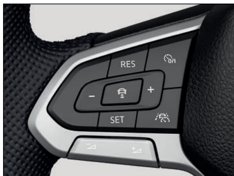
Fig. 113 Lado izquierdo del volante multifunción.
