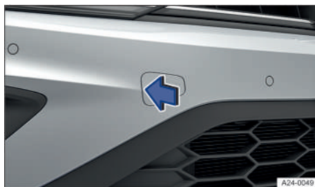
Fig. 153 En el lado derecho del paragolpes delantero: retirar la tapa, variante 2.
