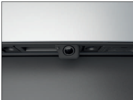
Fig. 205 En la parte trasera del vehículo: cámara de marcha atrás (representación esquemática).
