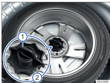
Fig. 181 Debajo del piso del maletero: ruedecilla para fijar la rueda de repuesto.
