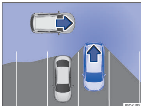
Fig. 120 Zona vigilada alrededor del vehículo que está desaparcando (representación esquemática).
