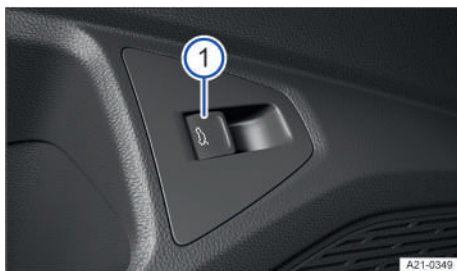
Fig. 55 En la puerta del conductor: tecla de desbloqueo del portón trasero.
