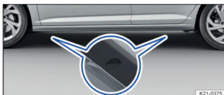
Fig. 186 En el larguero inferior: marcas para los puntos de apoyo del gato (variante 2).
