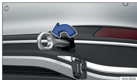
◀ Fig. 157 En el lado derecho del paragolpes trasero: enroscar la argolla de remolque.
