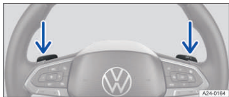
Fig. 95 Detrás del volante: levas de cambio para el Tiptronic (representación esquemática).
