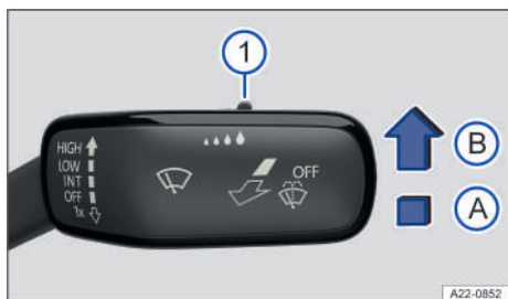
Fig. 82 En el lado derecho de la columna de dirección: palanca del limpiacrystal.
