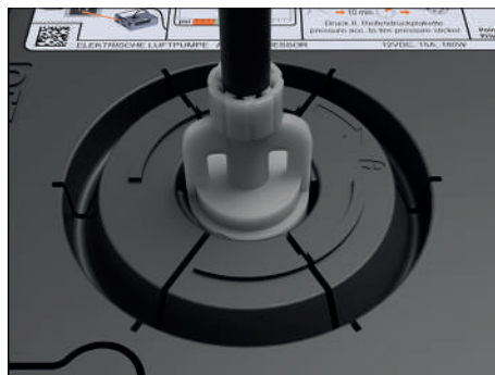
Fig. 195 Colocar el tubo de inflado de los neumáticos.
