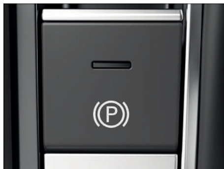
Fig. 115 En la consola central: tecla del freno de estacionamiento electrónico.
