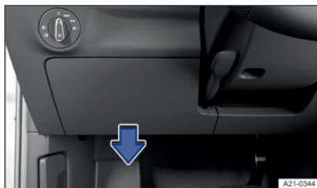
Fig. 145 En el lado izquierdo, junto al volante: tapa de la caja de fusibles del tablero de instrumentos.
