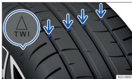
Fig. 179 En las acanaladuras del perfil: indicadores de desgaste.
