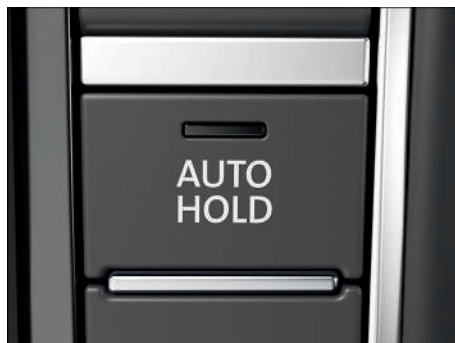
Fig. 116 En la consola central: tecla de la función Auto Hold.
