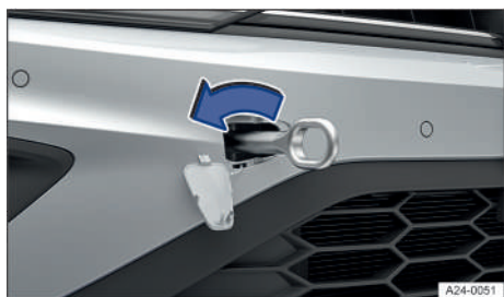
Fig. 155 En el lado derecho del paragolpes delantero: enroscar la argolla de remolque, variante 2.
