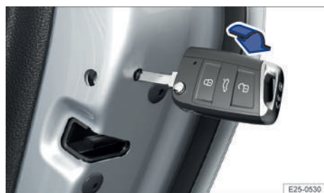
Fig. 52 En el frontal de la puerta trasera: bloqueo de emergencia del vehículo con el paletón de la llave o la llave de emergencia (variante 1).
