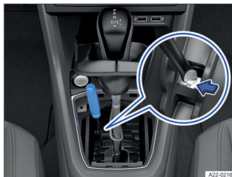
Fig. 96 En la consola central: realizar un desbloqueo de emergencia de la palanca selectora (variante 1).
