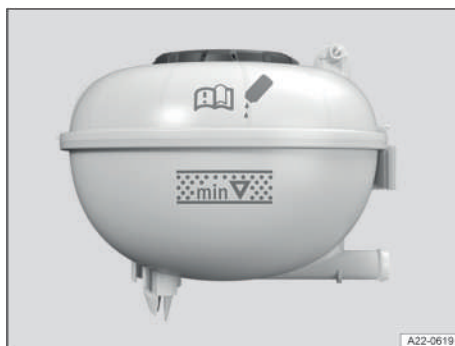
Fig. 171 En el vano delantero: marcas en el depósito de expansión del líquido refrigerante (representación esquemática).
