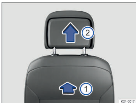
Fig. 68 Desmontaje de los apoyacabezas delanteros (representación esquemática).
