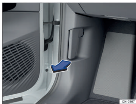
Fig. 160 En la zona reposapiés del lado del conductor: palanca de desbloqueo del capó delantero (representación esquemática).
