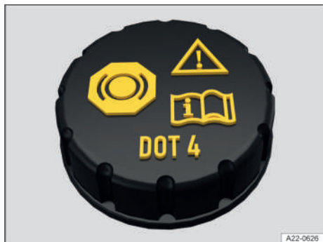
Fig. 172 En el vano delantero: tapa del depósito del líquido de frenos.
