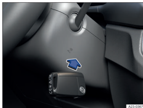
Fig. 91 En el lado derecho de la columna de dirección: función de arranque de emergencia en los vehículos con
