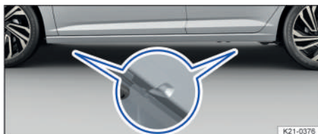
Fig. 185 En el larguero inferior: marcas para los puntos de apoyo del gato (variante 1).
