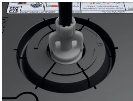
Fig. 198 Colocar el tubo de inflado de los neumáticos.
