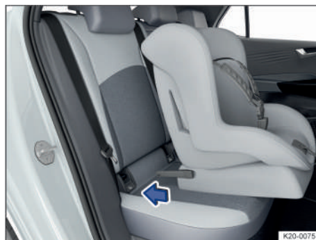
Fig. 36 Montaje de un asiento para niños con conectores (representación esquemática).
