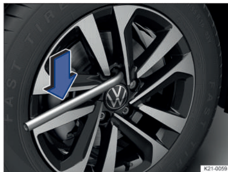
Fig. 191 Desenroscar los tornillos de rueda con la llave de rueda.
