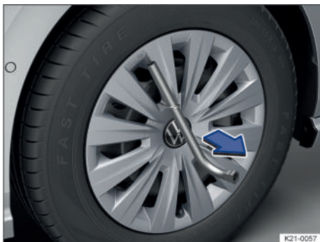
Fig. 182 Desmontar el tapacubos integral.
