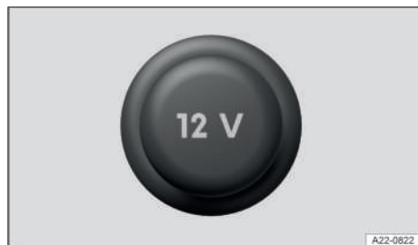
Fig. 125 En la parte inferior de la consola central: toma de corriente de 12 voltios con tapa extraíble (en función del equipamiento).
