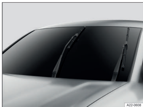
Fig. 140 Parabrisas: limpiacristales en la posición de servicio (representación esquemática).
