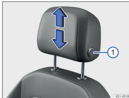
Fig. 66 Desmontaje de los apoyacabezas delanteros (representación esquemática).
