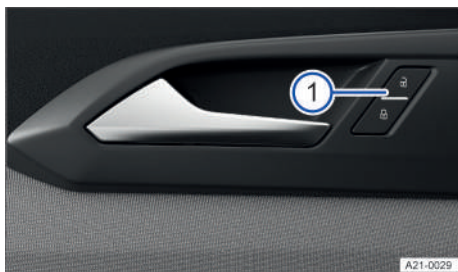
Fig. 49 En la puerta del conductor: tecla del cierre centralizado (representación esquemática).
