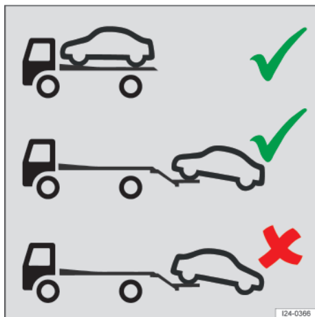
Fig. 151 Transportar con una grúa.
