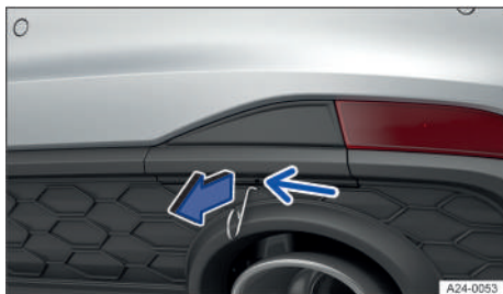
Fig. 158 En el lado derecho del paragolpes trasero: retirar la tapa.
