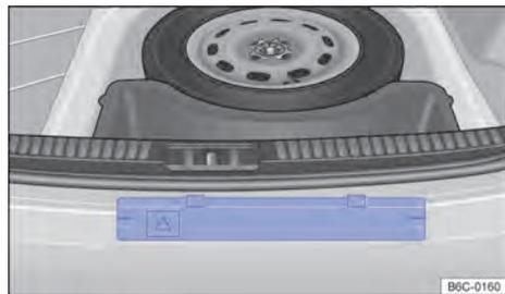
Fig. 47 En el maletero: soporte para el triángulo de seguridad.
