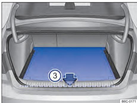
**Fig. 150** En el maletero: piso variable del maletero.
