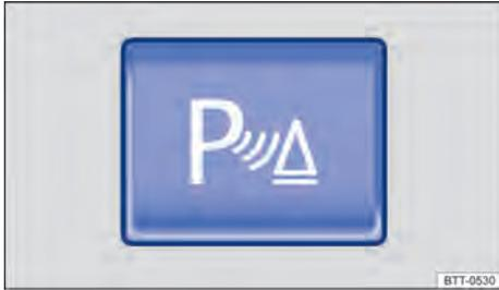
**Fig. 96** En la consola central: tecla de encender y apagar la ayuda de aparcamiento.
