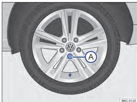
Fig. 197 Retire el tapacubos integral. ▶
