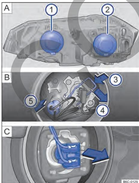
**Fig. 161** En el compartimiento del motor: ① faro alto y luz de posición y ② faro bajo.
