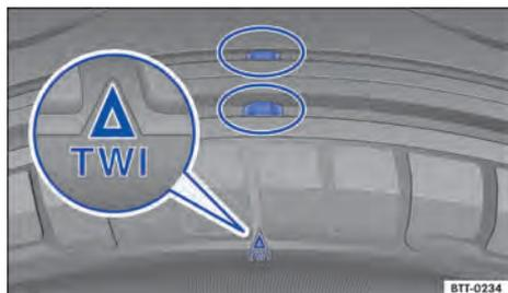
Fig. 194 Perfil del neumático: indicadores de desgaste.
