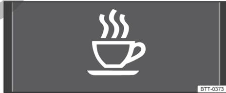
**Fig. 16** En el display del instrumento combinado: símbolo del sistema de detección del cansancio.
