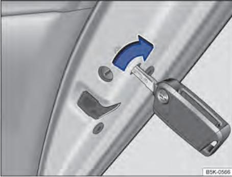
**Fig. 3** Cierre de emergencia del vehículo con la llave del vehículo (variante 1).
