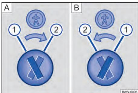
Fig. 1 Cierre de seguridad para niños: [A] puerta trasera izquierda, [B] puerta trasera derecha.
