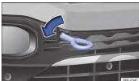
Fig. 215 En el parachoques delantero a la derecha: enrosque la argolla de remolque.
