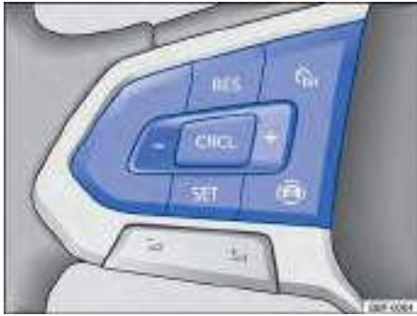
Fig. 105 Lado izquierdo del volante multifunción (variante 2): teclas para controlar el GRA.
