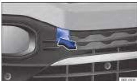
Fig. 214 En el parachoques delantero a la derecha: suelte y desmonte la cubierta.
