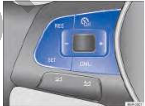
Fig. 104 Lado izquierdo del volante multifunción (variante 1): teclas para controlar el GRA.
