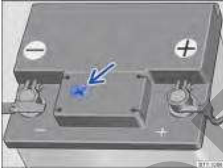
Fig. 225 En el compartimento del motor: ejemplo de posición del visor en el lado superior de la batería del vehículo.
