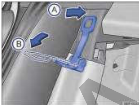
Fig. 65 Atrás del asiento trasero: palanca para regular la inclinación del respaldo
