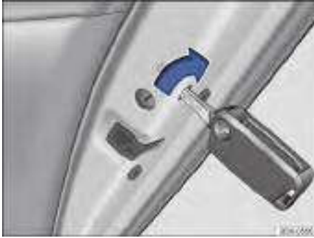
Fig. 55 Cierre de emergencia del vehículo con la llave del vehículo.
