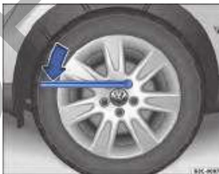
Fig. 233 Cambio de rueda: aflojar los tornillos de la rueda.
