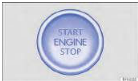
Fig. 92 En la parte inferior de la consola central: tecla de arranque para poner en marcha el motor
