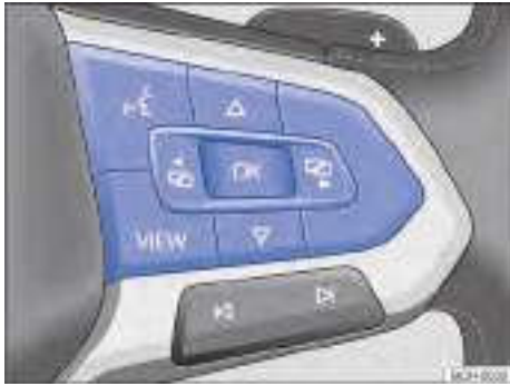
Fig. 18 Lado derecho del volante multifunción (variante 2): teclas para el mando de los menús y visualizaciones de información del instrumento combinado.
