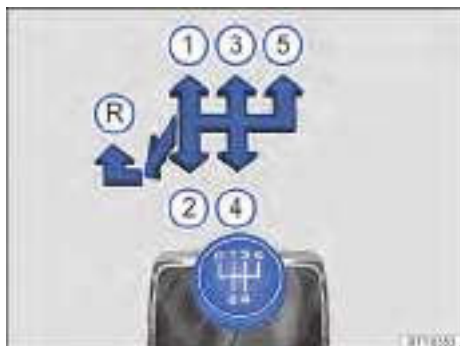
Fig. 95 Esquema de la transmisión manual de 5 marchas.
