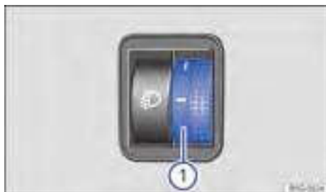
Fig. 75 Al lado del volante: conmutador de ajuste de alcance del faro.
