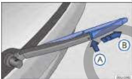
Fig. 200 Sustituir la escobilla del limpiapuneta.
