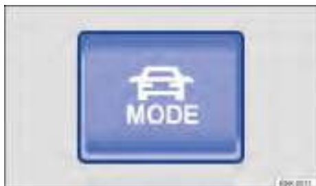
Fig. 101 En la parte superior de la consola central: tecla MODE de selección del perfil de conducción.
