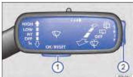
Fig. 16 En vehículos sin volante multifunción: tecla ① en la palanca de los limpiavidrios para confirmar los ítems de menú y llave ② para cambiar entre los menús.
