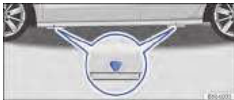
Fig. 235 Puntos de apoyo del gato.
