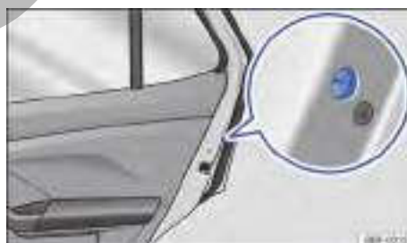
Fig. 54 En la puerta trasera: bloqueo de emergencia. ▶
