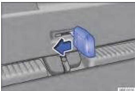
Fig. 59 En el maletero: desbloquear la tapa trasera.
