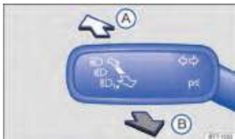
Fig. 73 A la izquierda en la columna de dirección: palanca de los indicadores de dirección y del farol alto.
