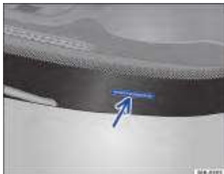
Fig. 243 En el parabrisas: número de identificación del vehículo.
