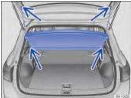
Fig. 189 En el maletero: desmontar y montar la bandeja trasera.
