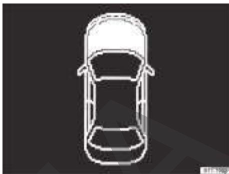
Fig. 218 En el display del instrumento combinado: tapa del compartimento del motor abierta o cerrada incorrectamente (representación esquemática).
