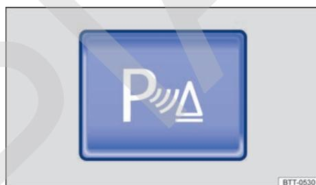
**Fig. 139** En la consola central: tecla para conectar y desconectar la ayuda de aparcamiento (en función del equipamiento).
