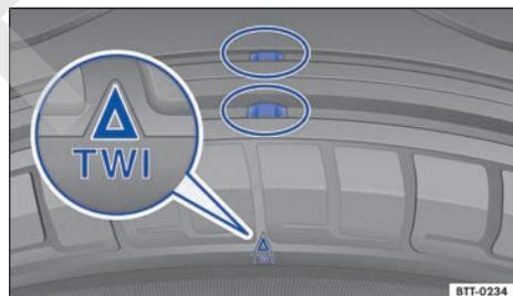
Fig. 209 Perfil del neumático: indicadores de desgaste.
