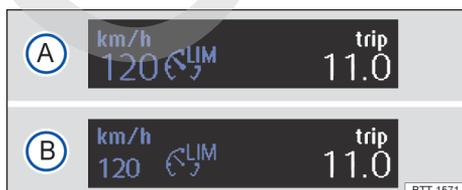
Fig. 128 En la pantalla del cuadro de instrumentos: indicaciones del estado del limitador de velocidad (representación esquemática).
