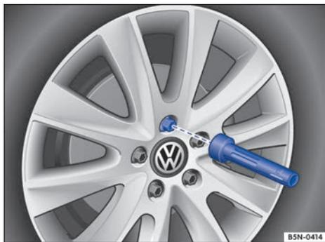
**Fig. 224** Cambio de rueda: desenroscar los tornillos de rueda con el mango del destornillador.
