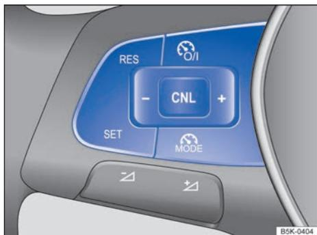
**Fig. 129** Lado izquierdo del volante multifunción: teclas para manejar el limitador de velocidad.
