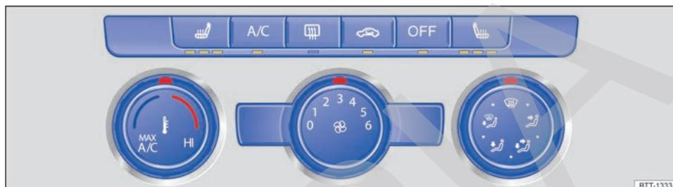
**Fig. 103** En la parte superior de la consola central: mandos del climatizador manual.
