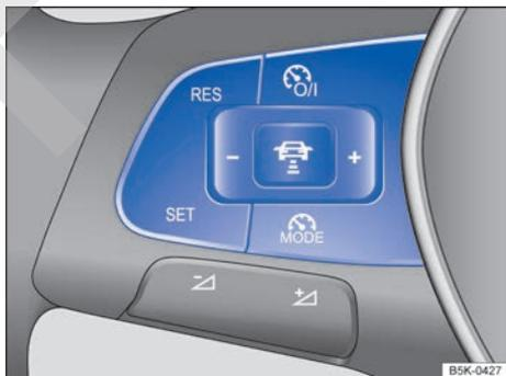
**Fig. 133** Lado izquierdo del volante multifunción: teclas para manejar el ACC.
