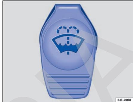
**Fig. 97** En el vano motor: tapa del depósito del líquido lavacristales.
