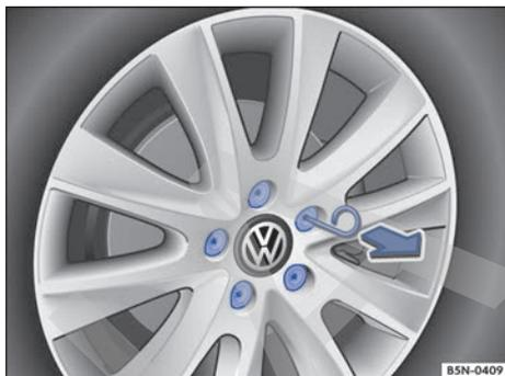
Fig. 215 Retirar las caperuzas de los tornillos de rueda.
