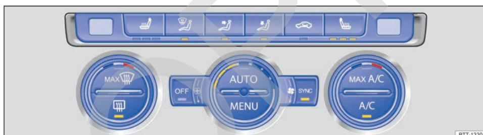
**Fig. 104** En la parte superior de la consola central: mandos del Climatronic.
