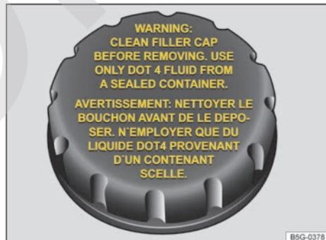
Fig. 199 En el vano motor: tapa del depósito del líquido de frenos (variante 2).
