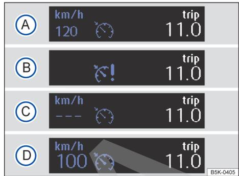
Fig. 126 En la pantalla del cuadro de instrumentos: indicaciones del estado del GRA (representación esquemática).
