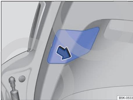
**Fig. 182** En el portón del maletero: retirar la tapa.
