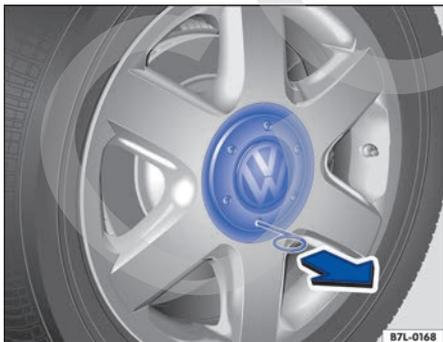
Fig. 212 Desmontar el tapacubos central tirando de él.
