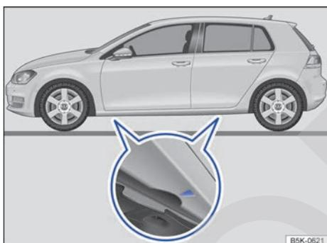
Fig. 220 Puntos de apoyo para el gato.
