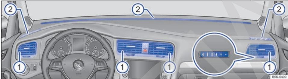
Fig. 105 En el tablero de instrumentos: difusores de aire.
