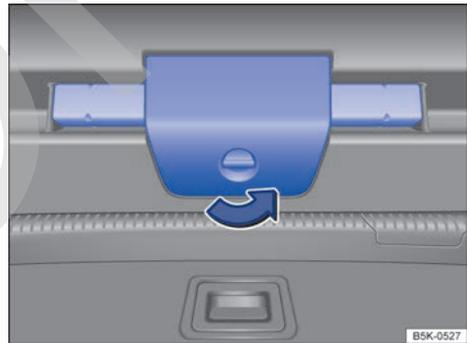
Fig. 71 En el portón del maletero: abrir el soporte del triángulo de preseñalización. ▶
