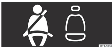
Fig. 26 Indicación del estado de los cinturones de seguridad de las plazas traseras en la pantalla del cuadro de instrumentos.
