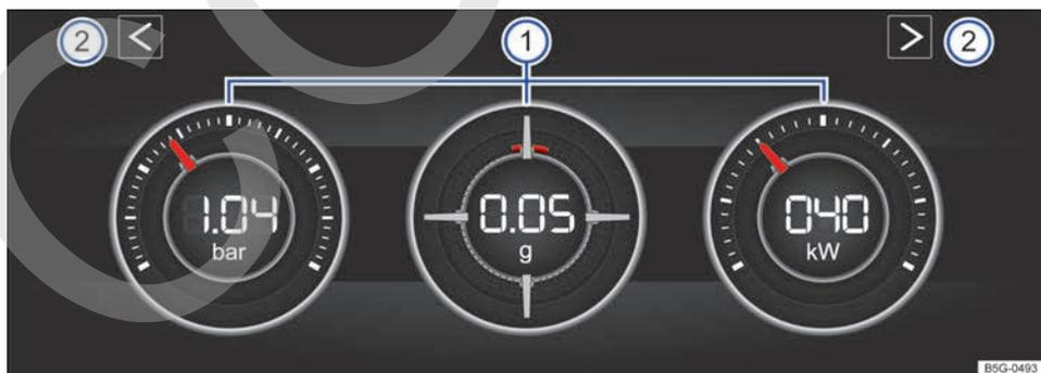
Fig. 21 En el sistema de infotainment: monitor de potencia (en función del equipamiento).
