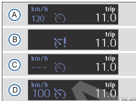
**Fig. 124** En la pantalla del cuadro de instrumentos: indicaciones del estado del GRA (representación esquemática).
