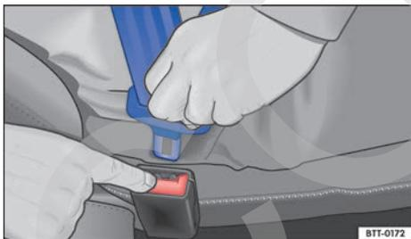
Fig. 33 Soltar la lengüeta del cinturón de seguridad de su cierre.
