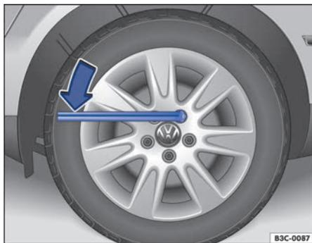
Fig. 216 Cambio de rueda: aflojar los tornillos de rueda.
