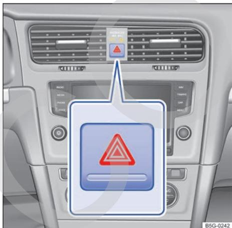
**Fig. 51** En la parte superior de la consola central: pulsador de los intermitentes de emergencia.
