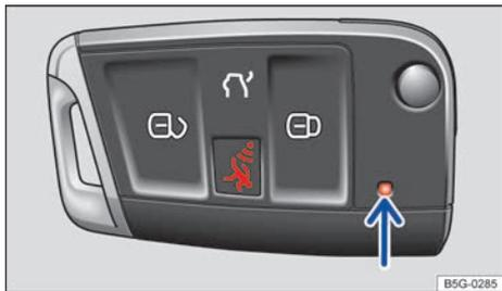
**Fig. 56** Testigo de control en la llave del vehículo con tecla de alarma.
