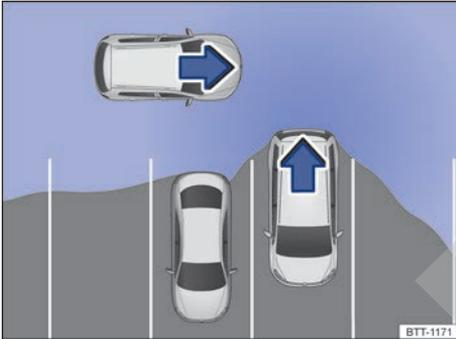
**Fig. 136** Representación esquemática del asistente de salida del aparcamiento: zona vigilada alrededor del vehículo que está desaparcando.
