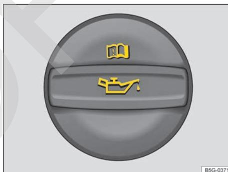
**Fig. 201** En el vano motor: tapa de la boca de llenado de aceite.
