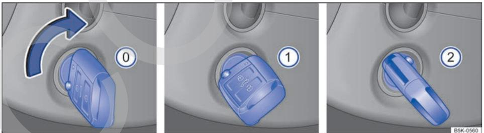
Fig. 111 Posiciones de la llave del vehículo en la cerradura de encendido.
