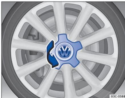
Fig. 213 Desmontar el tapacubos central girándolo.
