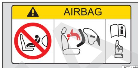
Fig. 45 Etiqueta adhesiva relativa al airbag en el pasador (representación esquemática).
