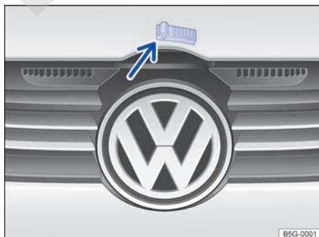
**Fig. 197** Palanca de desbloqueo para apertura del capó del motor por encima de la parrilla del radiador. ▶
