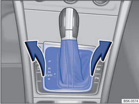
Fig. 120 Desmontar la cubierta de la corredera de la palanca selectora.
