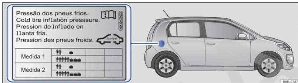
**Fig. 143** En la parte interior de la portezuela del depósito de combustible: etiqueta con la presión de los neumáticos.
