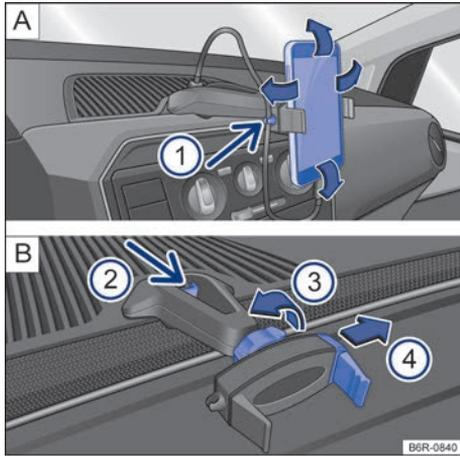
Fig. 152 En la consola central: soporte para teléfono celular y ajustes.
