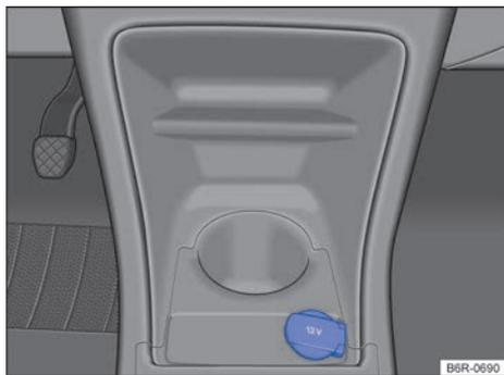
Fig. 102 En la consola central delantera: toma de corriente de 12 V.
