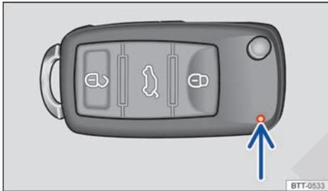
**Fig. 47** Luz de control de la llave del vehículo con comando remoto.
