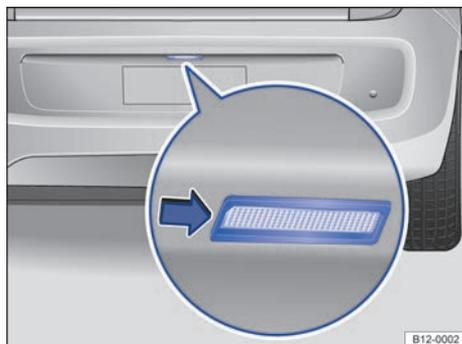
**Fig. 120** En el parachoques trasero: desmontar la luz de la placa de licencia.
