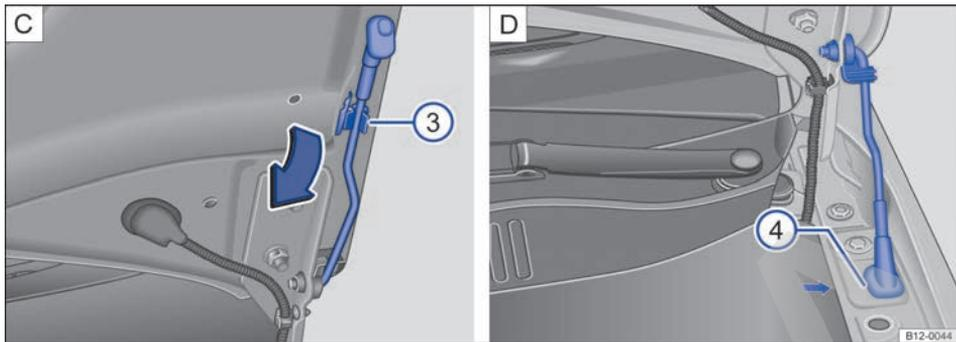
**Fig. 132** C: varilla de sujeción de la tapa del compartimento del motor. D: tapa del motor protegida con la varilla de sujeción de la tapa.
