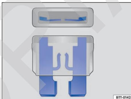
Fig. 126 Representación de un fusible quemado.
