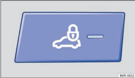
Fig. 49 Luz de control en el panel de instrumentos indica el cierre centralizado activado y/o la vigilancia del habitáculo apagada.
