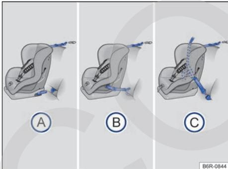
Fig. 16 En el asiento trasero: las figuras (A) y (B) muestran el principio de fijación del sistema de retención infantil en los ojales de retención inferiores y con el cinturón de fijación superior. La figura (C) muestra la fijación del sistema de retención infantil con el cinturón de seguridad del vehículo y con el cinturón de fijación superior.
