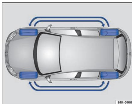
Fig. 142 Esquema para cambio de las ruedas. ▶
