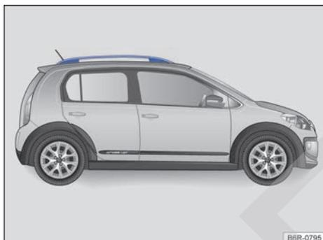
**Fig. 108** Soportes longitudinales del portaequipajes de techo (ambos lados).
