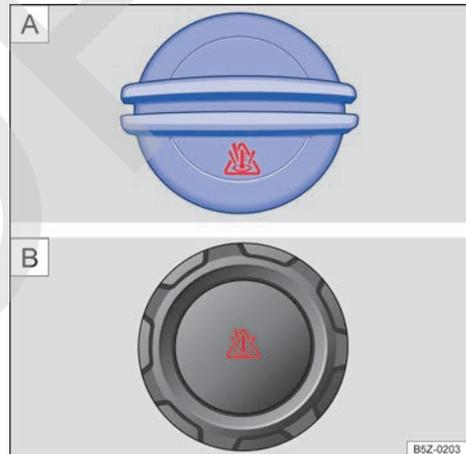
Fig. 137 En el compartimento del motor: **A** tapa del depósito de expansión del líquido de refrigeración del motor o **B** tapa del depósito del expansión del líquido de refrigeración del motor
