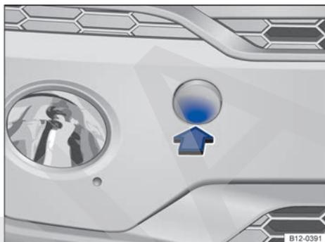
Fig. 129 En el parachoques delantero a la derecha: suelte y desmonte la cubierta.
