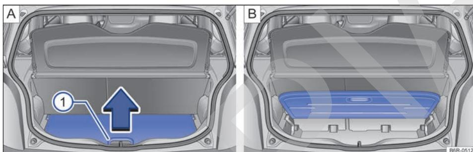
Fig. 104 A: piso variable del maletero rebatido hacia arriba. B: piso variable del maletero abierto.
