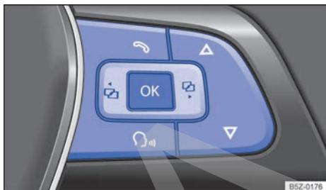
**Fig. 44** Lado derecho del volante multifunción: teclas de comando.
