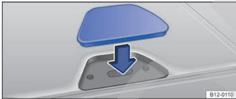
Fig. 153 En la consola central: cerrar la abertura del soporte para teléfono celular.
