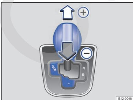
Con transmisión automatizada, las marchas se pueden aumentar o reducir manualmente con el Tiptronic. Al cambiar al modo Tiptronic, se mantiene la marcha actual en uso. Esto vale hasta que el sistema no ejecute un cambio de marcha automáticamente debido a la situación de conducción actual.
