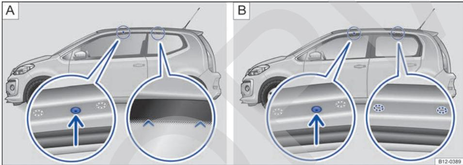
**Fig. 107** Vehículos sin portaequipajes de techo: **A** Puntos de fijación de los soportes de base del portaequipajes de techo (ambos lados) - vehículos 2 puertas. **B** Puntos de fijación de los soportes de base del portaequipajes de techo (ambos lados) - vehículos 4 puertas.
