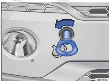
Fig. 130 En el parachoques delantero a la derecha: enrosque la argolla de remolque.
