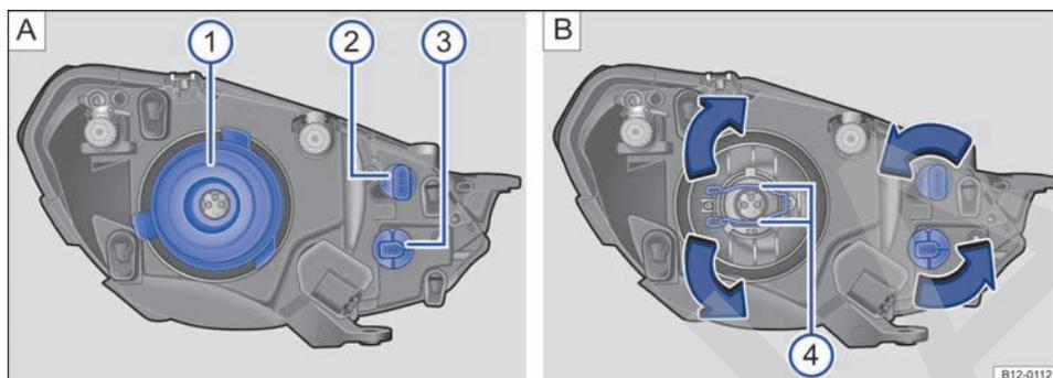
**Fig. 115** En el compartimento del motor: vista trasera del farol delantero izquierdo con cubierta de goma: ① farol bajo y farol alto, ② luz de posición y/o luz de conducción diurna, ③ indicadores de dirección y bloqueo de protección ④.
