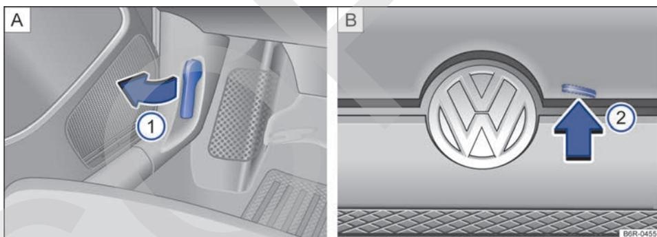
**Fig. 131** A: palanca de desbloqueo en el área de los pies del lado del conductor. B: palanca de desbloqueo en la parte interna de la tapa del compartimento del motor.
