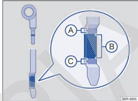
Fig. 134 Varilla de medición del aceite con marca de nivel de aceite del motor.
