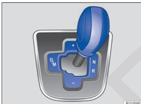
Fig. 87 Palanca selectora de la transmisión automatizada.
