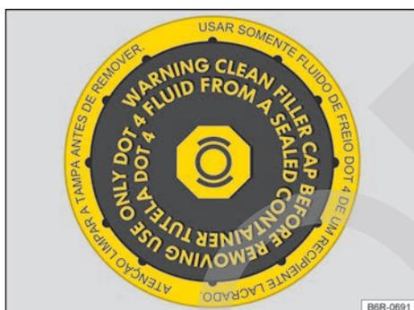
**Fig. 138** En el compartimento del motor: tapón de cierre del depósito del líquido de frenos (variante 1).
