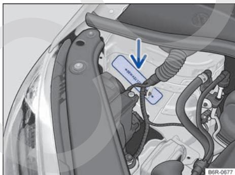
**Fig. 156** En el compartimento del motor: número de bastidor.
