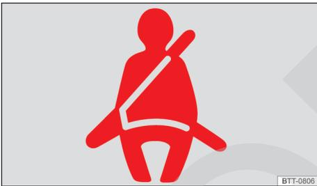
Fig. 3 Luz de advertencia en el instrumento combinado.
