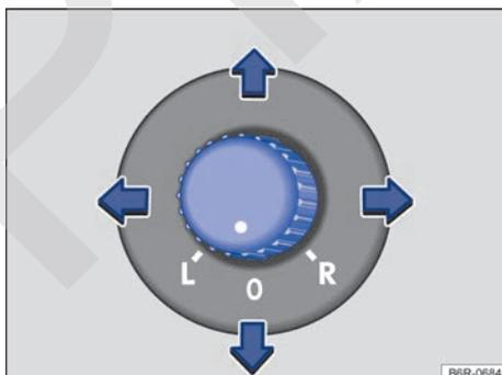
**Fig. 76** En la puerta del conductor: mando giratorio de ajuste de los espejos retrovisores eléctricos.
