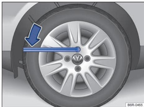
Fig. 150 Cambio de rueda: aflojar los tornillos de la rueda.
