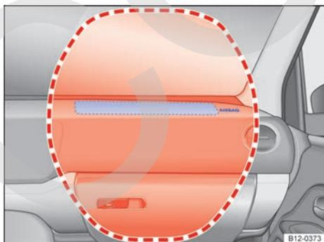
**Fig. 15** Ubicación y radio de expansión del airbag frontal del acompañante.
