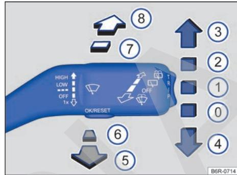
Fig. 71 Manejo de los limpiaparabrisas / lavaparabrisas y del limpiavetana / lavaluneta.
