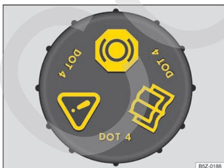
**Fig. 139** En el compartimento del motor: tapón de cierre del depósito del líquido de frenos (variante 2).
