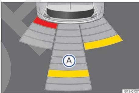
Fig. 92 Presentación del display del control de distancia de estacionamiento en el aparato de navegación portátil (no disponible en algunas versiones).
