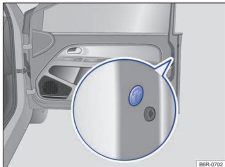
Fig. 56 En la parte delantera de la puerta del acompañante: bloqueo de emergencia, cubierto por un burlete de goma.
