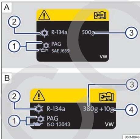
Fig. 158 (A): Información del aire acondicionado - motor MPI. (B) Información del aire acondicionado - motor TSI.
