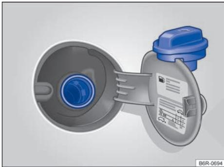
**Fig. 109** Portezuela del depósito de combustible abierta con el tapón de cierre del depósito de combustible colgado.
