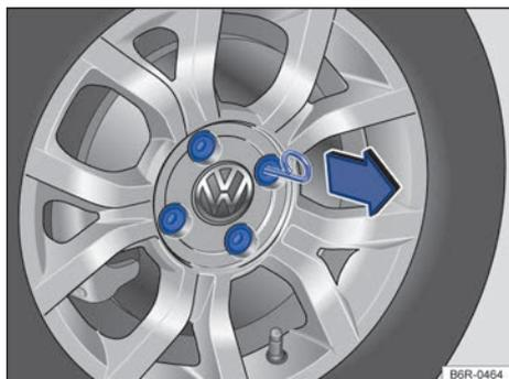
Fig. 149 Retirar las caperuzas de los tornillos de rueda.
