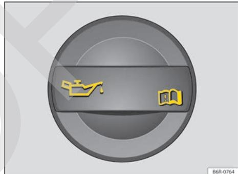
Fig. 135 En el compartimento del motor: tapón de la boca de llenado del aceite del motor.
