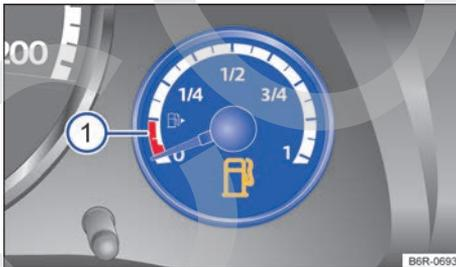
Fig. 40 En el instrumento combinado: indicador del nivel de combustible (variante 2).
