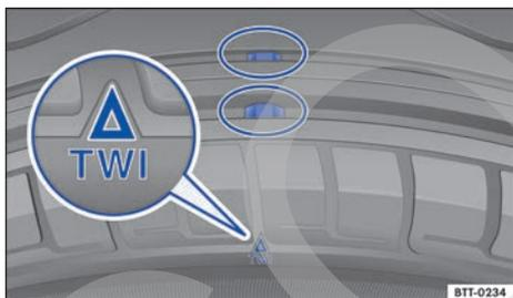
Fig. 144 Perfil del neumático: indicadores de desgaste.
