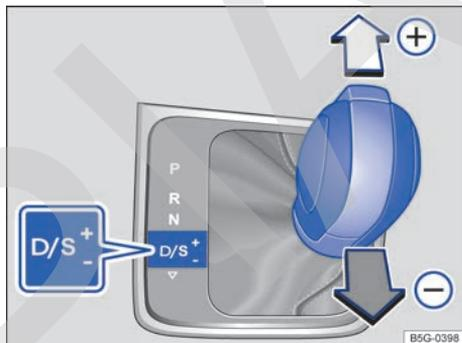
Fig. 108 Palanca selectora en la posición Tiptronic (vehículos con el volante a la izquierda).
