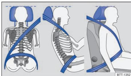
Fig. 34 Colocación correcta de la banda del cinturón y ajuste correcto del apoyacabezas.
