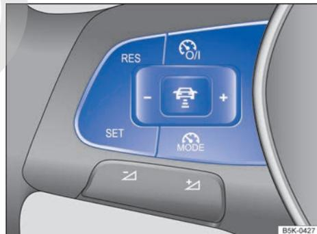
**Fig. 121** Lado izquierdo del volante multifunción: teclas para manejar el ACC.
