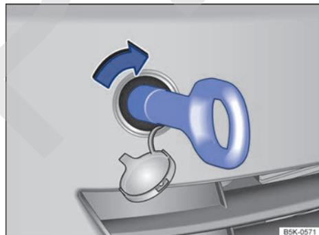
Fig. 186 En el lado derecho del paragolpes delantero: enroscar la argolla de remolque.
