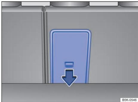
**Fig. 158** En el maletero: apertura de la trampilla para cargas largas.
