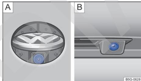
Fig. 220 En la parte trasera del vehículo: cámara del asistente de marcha atrás [A] en el emblema de Volkswagen o [B] en la luz de matrícula (representación esquemática).
