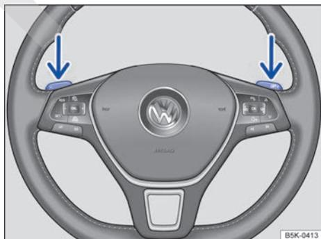
Fig. 109 Volante con levas de cambio para el Tiptronic.
