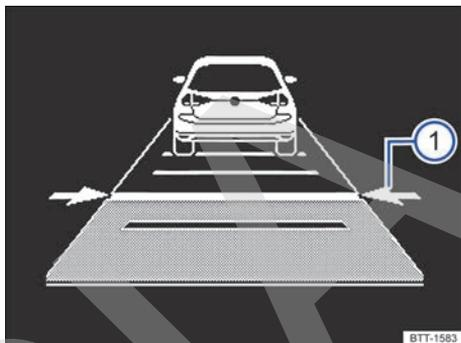
Fig. 122 En la pantalla del cuadro de instrumentos: ajustar la distancia (representación esquemática, el ACC regula).
