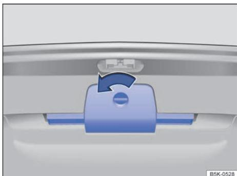
**Fig. 52** En el portón del maletero: soporte del triángulo de preseñalización.
