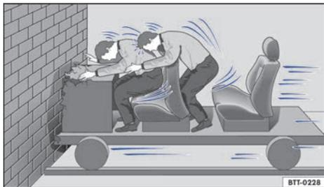
**Fig. 28** El vehículo choca contra el muro. Los ocupantes no llevan colocado el cinturón de seguridad.
