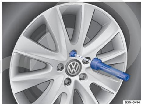
**Fig. 215** Cambio de rueda: desenroscar los tornillos de rueda con el mango del destornillador.
