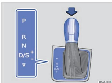
**Fig. 107** Vehículo con el volante a la izquierda: palanca selectora del cambio automático con tecla de bloqueo (flecha).
