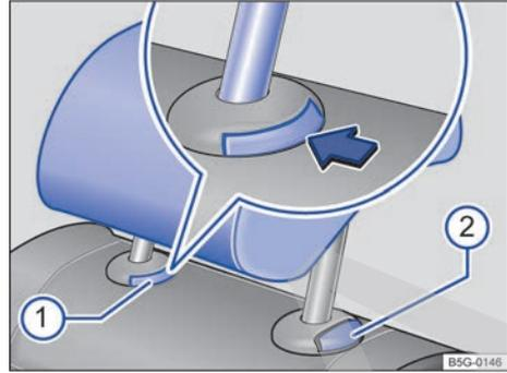
**Fig. 76** Desmontaje de los apoyacabezas traseros.
