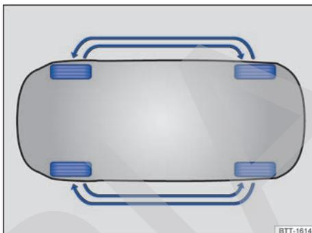
**Fig. 199** Representación esquemática: esquema para el intercambio de las ruedas.
