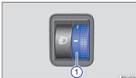
**Fig. 83** Junto al volante: regulador del alcance de las luces ①.
