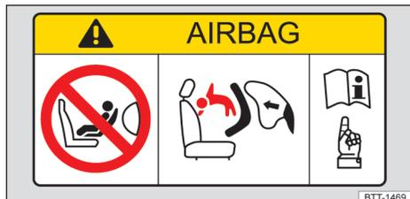
Fig. 46 Etiqueta adhesiva relativa al airbag en el parasol (representación esquemática).
