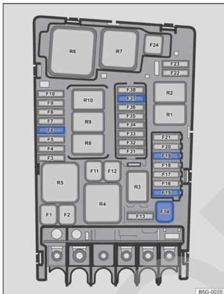
**Fig. 178** En el vano motor: posiciones de los fusibles.
