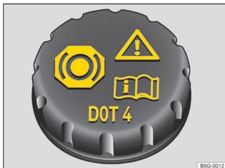
Fig. 195 En el vano motor: tapa del depósito del líquido de frenos (variante 1).
