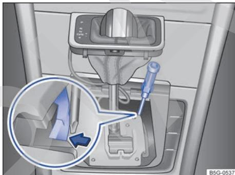
Fig. 110 Debajo de la cubierta de la corredera de la palanca selectora: desbloqueo de emergencia (variante 1).
