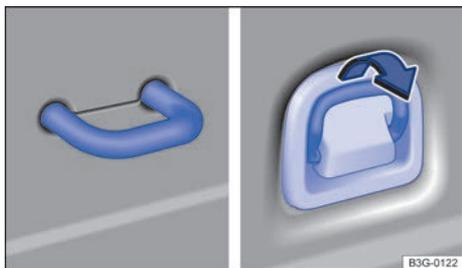
Fig. 153 En el maletero: argollas de amarre fija y desplegable.
