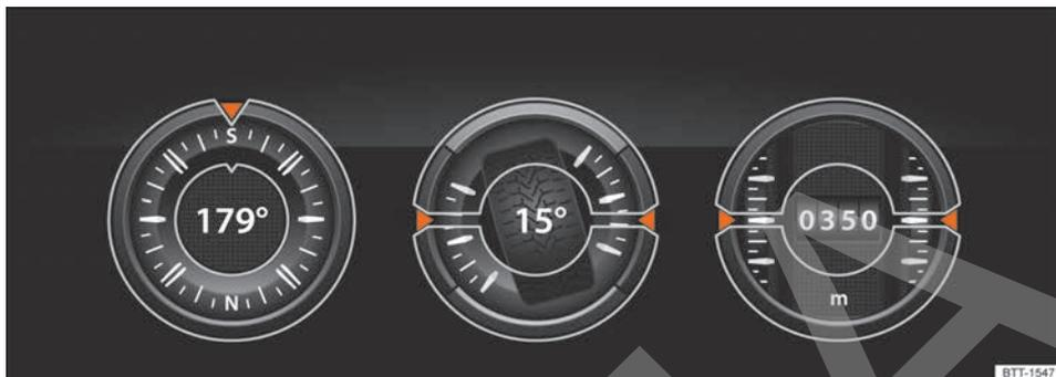
Fig. 113 En el sistema de infotainment: indicador Offroad.
