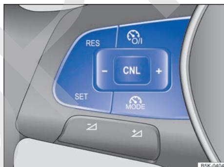
Fig. 115 Lado izquierdo del volante multifunción: teclas para manejar el GRA.
