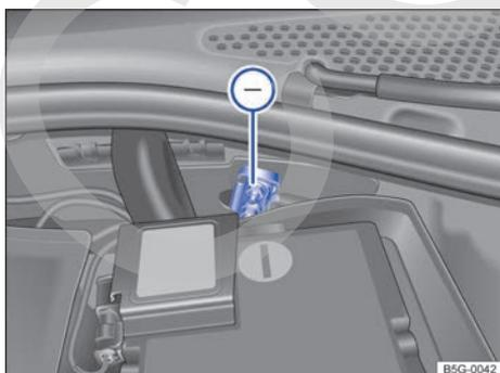
**Fig. 181** En el vano motor: toma para la ayuda de arranque (terminal de masa).
