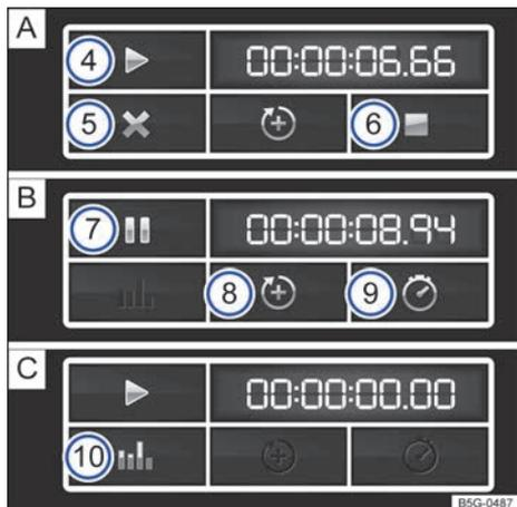
**Fig. 23** Botones de función del sistema de infotainment: cronometraje en caso de una vuelta [A] detenida, [B] en curso y [C] finalizada.
