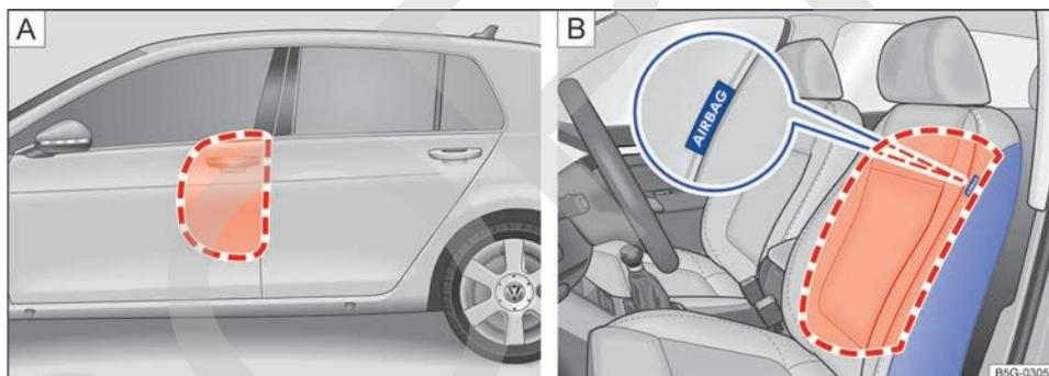
Fig. 41 [A] En el lado izquierdo del vehículo: zonas de despliegue del airbag lateral. [B] Lateral del asiento del conductor y del acompañante: ubicación y zona de despliegue del airbag lateral.
