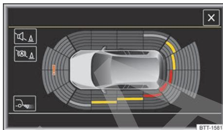
Fig. 126 Visualización en el sistema de infotainment: modo de pantalla completa. Las zonas detectadas dependen del equipamiento.
