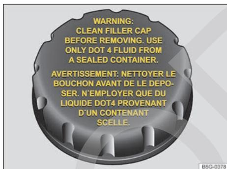
Fig. 196 En el vano motor: tapa del depósito del líquido de frenos (variante 2).
