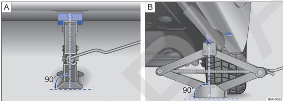
Fig. 214 Gato colocado en el lado izquierdo del vehículo, en la zona trasera.
