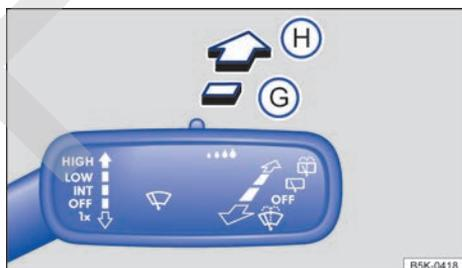
**Fig. 87** En el lado derecho de la columna de dirección: manejo del limpialuneta.
