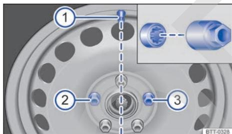
Fig. 210 Cambio de rueda: válvula del neumático ① y lugar de montaje del tornillo de rueda antirrobo ② o ③.
