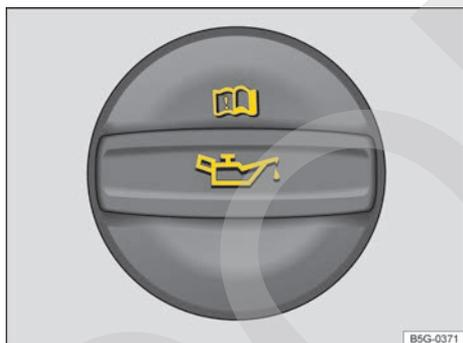
Fig. 192 En el vano motor: tapa de la boca de llenado de aceite del motor (representación esquemática).
