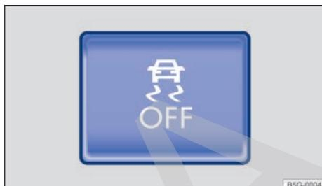
**Fig. 133** En la consola central: tecla para desconectar y conectar manualmente el ASR.
