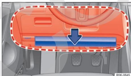
**Fig. 44** En el lado del conductor: zona de despliegue del airbag para las rodillas.
