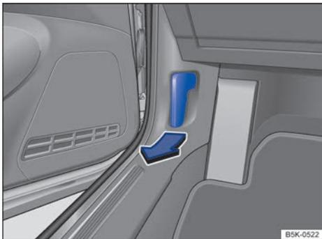
**Fig. 187** En la zona reposapiés del lado del conductor: palanca de desbloqueo del capó del motor.
