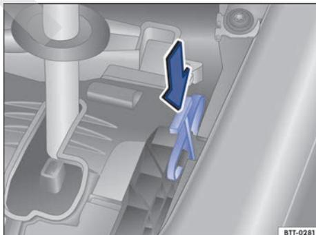
Fig. 111 Debajo de la cubierta de la corredera de la palanca selectora: desbloqueo de emergencia (variante 2).
