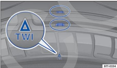
Fig. 202 Perfil del neumático: indicadores de desgaste.
