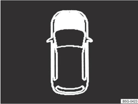
**Fig. 189** En la pantalla del cuadro de instrumentos: capó del motor abierto o no cerrado correctamente (representación esquemática).
