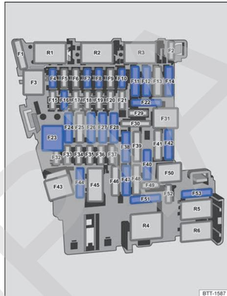
Fig. 176 En el tablero de instrumentos: asignación de fusibles.
