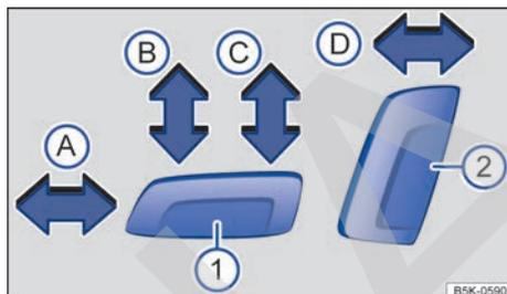
Fig. 70 Mandos en el asiento delantero izquierdo: ajuste longitudinal del asiento, ajuste de la altura y de la inclinación de la banqueta, y ajuste del respaldo.
