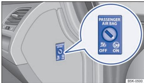
**Fig. 40** En el tablero de instrumentos del lado del acompañante: conmutador de llave para activar y desactivar el airbag frontal del acompañante.
