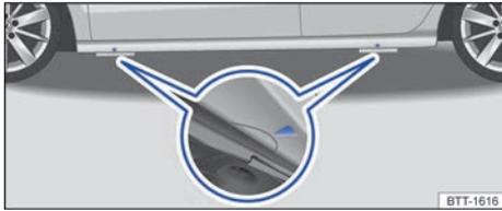
Fig. 213 Puntos de apoyo para el gato.
