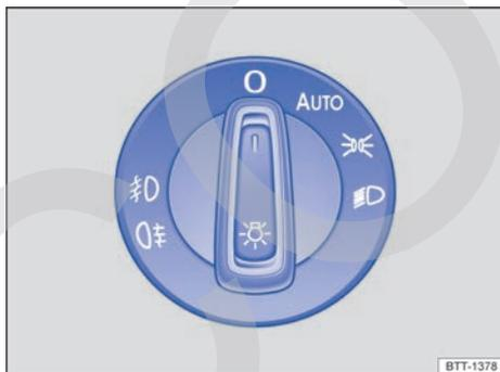
**Fig. 80** Junto al volante: mando de las luces (una variante).
