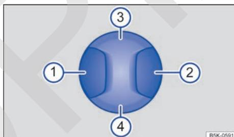
Fig. 71 Mando en el asiento delantero izquierdo: ajuste del apoyo lumbar.
