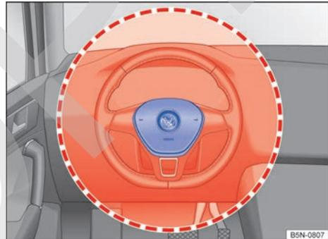
Fig. 38 Ubicación y zona de despliegue del airbag frontal del conductor.
