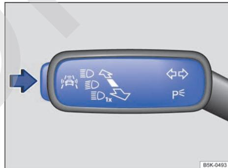
**Fig. 20** En la palanca de los intermitentes y de la luz de carretera, en el lado izquierdo de la columna de dirección: tecla de los sistemas de asistencia al conductor.
