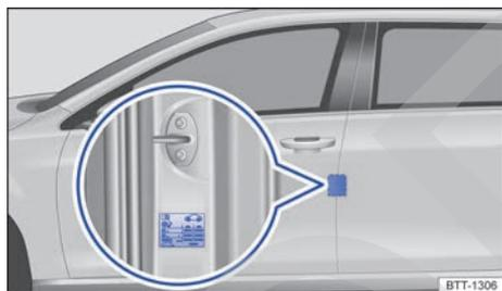
Fig. 201 En el pilar de la puerta del conductor: adhesivo de la presión de los neumáticos (o en la cara interior de la tapa del depósito de combustible).
