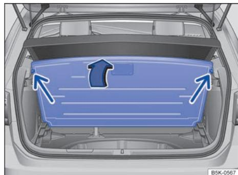
**Fig. 161** En el maletero: piso del maletero levantado.
