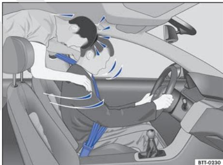
**Fig. 30** El ocupante del asiento trasero sin el cinturón de seguridad colocado sale lanzado hacia delante topando contra el conductor, que sí lo lleva colocado.
