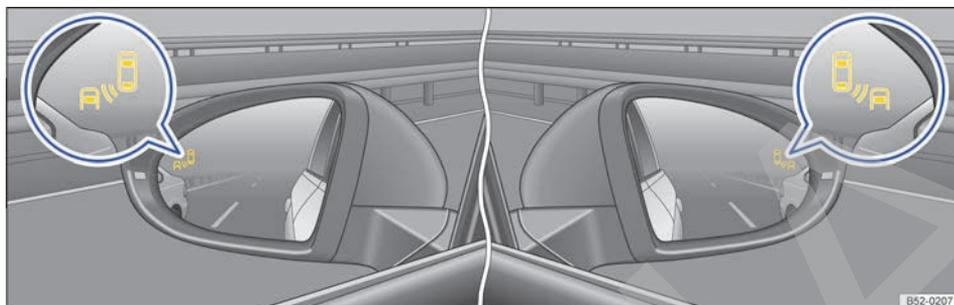
Fig. 123 En los retrovisores exteriores: indicación del detector de ángulo muerto.
