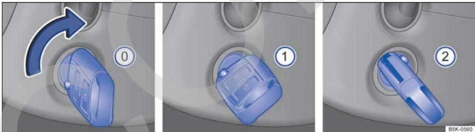
Fig. 101 Junto al volante, en el lado derecho: posiciones de la llave del vehículo en la cerradura de encendido.
