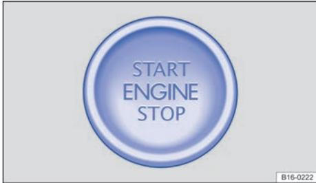
**Fig. 102** En la parte inferior de la consola central: pulsador de encendido y arranque para poner el motor en marcha.
