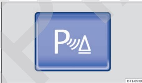
**Fig. 125** En la consola central: tecla para conectar y desconectar la ayuda de aparcamiento (en función del equipamiento).
