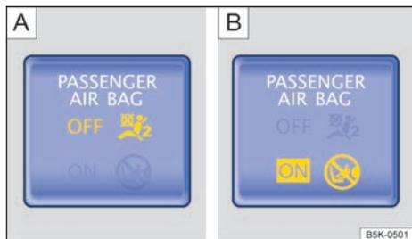
**Fig. 37** En la parte superior de la consola central: testigo de control de la desactivación del airbag frontal del acompañante [A] y de la activación del airbag frontal del acompañante [B].
