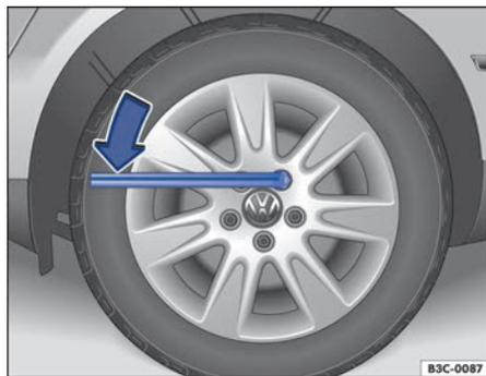
Fig. 209 Cambio de rueda: aflojar los tornillos de rueda.
