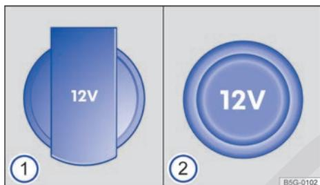
**Fig. 146** Toma de corriente de 12 voltios con tapa plegable ①, toma de corriente de 12 voltios con tapa extraíble ②.
