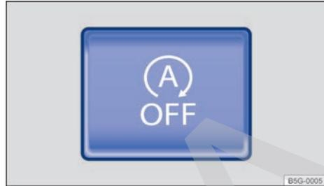
**Fig. 104** En la parte inferior de la consola central: tecla del sistema Start-Stop.
