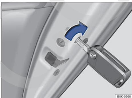
**Fig. 60** En el frontal de la puerta trasera derecha: bloqueo de emergencia del vehículo con la llave de este.
