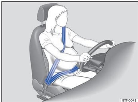
**Fig. 35** Colocación correcta de la banda del cinturón en el caso de mujeres embarazadas.
