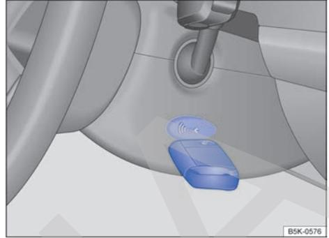
**Fig. 103** En el lado derecho de la columna de dirección: función de arranque de emergencia en vehículos con el sistema de cierre y arranque sin llave Keyless Access.
