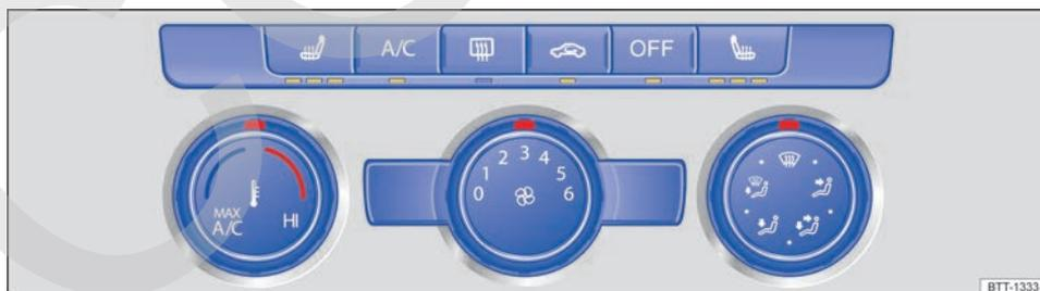
**Fig. 93** En la parte superior de la consola central: mandos del climatizador manual.
