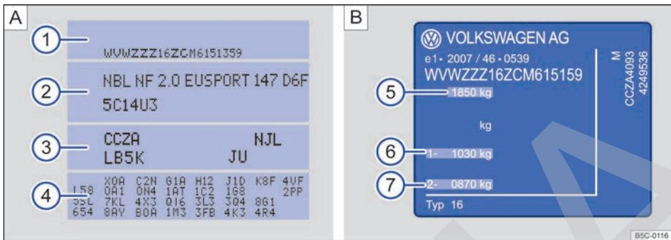
Fig. 221 Adhesivo portadatos [A] y placa de modelo [B].
