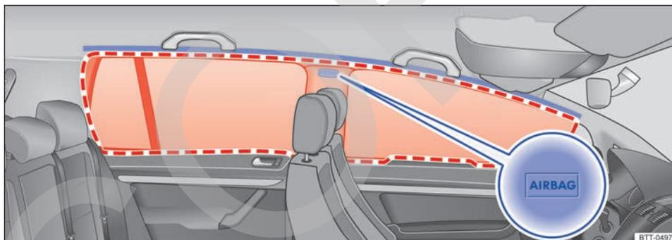
Fig. 42 En el lado izquierdo del vehículo: ubicación y zona de despliegue del airbag para la cabeza.
