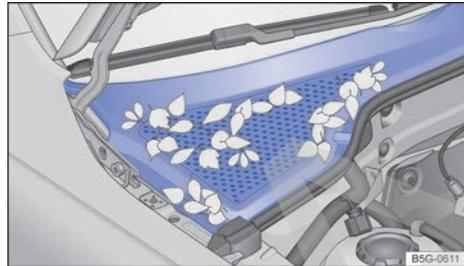
Fig. 219 Entre el vano motor y el parabrisas: caja de aguas (representación esquemática).
