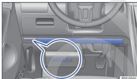
**Fig. 43** En el lado del conductor: ubicación del airbag para las rodillas.
