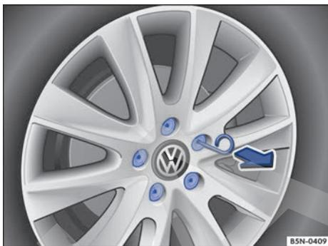
**Fig. 208** Retirar las caperuzas de los tornillos de rueda.
