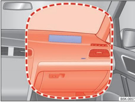
**Fig. 39** Ubicación y zona de despliegue del airbag frontal del acompañante.
