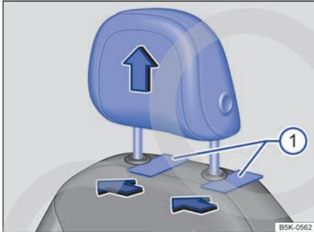
**Fig. 75** Desmontaje de los apoyacabezas delanteros.
