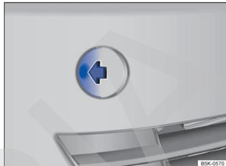
Fig. 185 En el lado derecho del paragolpes delantero: retirar la tapa.
