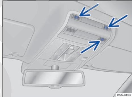
**Fig. 63** En la consola del techo: sensores de la vigilancia del habitáculo (flechas).
