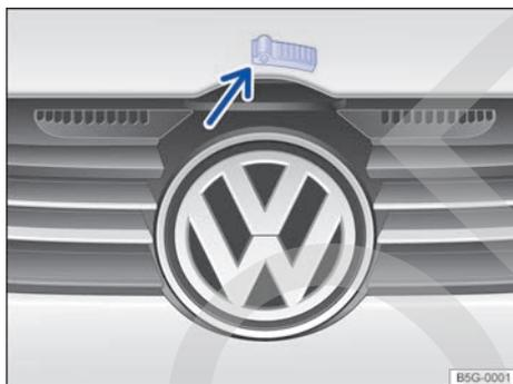
**Fig. 188** Encima de la parrilla del radiador: palanca de apertura del capó del motor.
