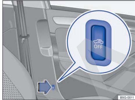
**Fig. 62** Junto al asiento del conductor: tecla para desconectar la vigilancia del habitáculo y el sistema antirremolcado (en función del equipamiento).
