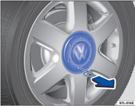
Fig. 205 Desmontar el tapacubos central tirando de él.
