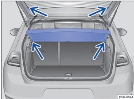
**Fig. 149** En el maletero: desmontar y montar la cubierta.
