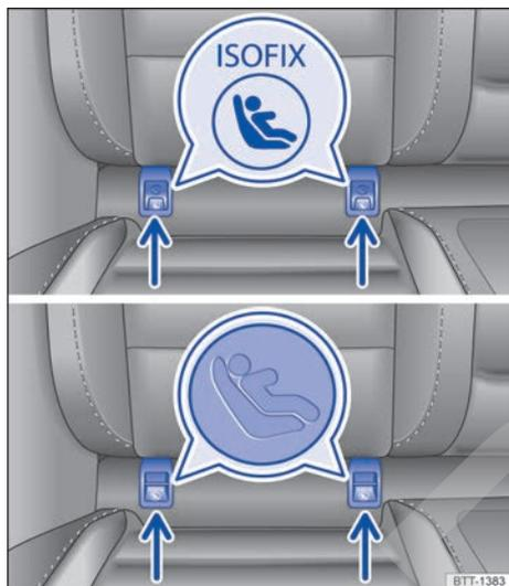
Fig. 48 En el asiento del vehículo: tipos de señalización de los puntos de anclaje ISOFIX para los asientos para niños.
