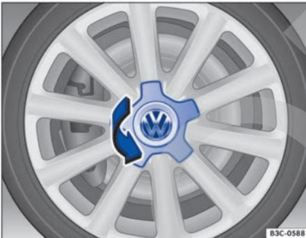
Fig. 206 Desmontar el tapacubos central girándolo.
