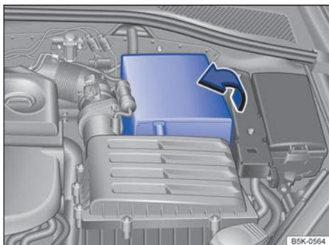
Fig. 197 En el vano motor: abrir la cubierta de la batería de 12 voltios.
