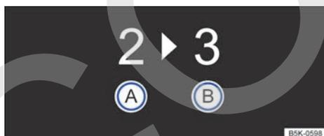
Fig. 98 En la pantalla del cuadro de instrumentos: recomendación de marcha.
