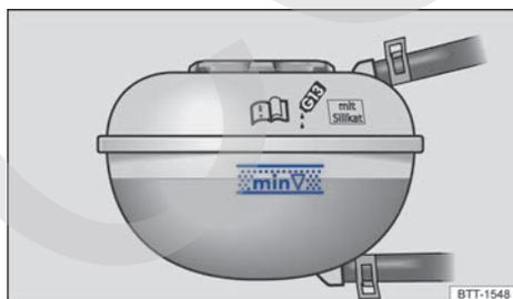
Fig. 193 En el vano motor: marcas en el depósito de expansión del líquido refrigerante del motor (representación esquemática).
