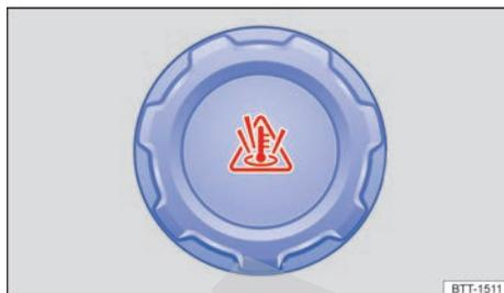
Fig. 194 En el vano motor: tapa del depósito de expansión del líquido refrigerante del motor (representación esquemática).
