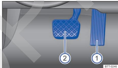
Fig. 97 En la zona reposapiés: pedales en vehículos con cambio de doble embrague.
