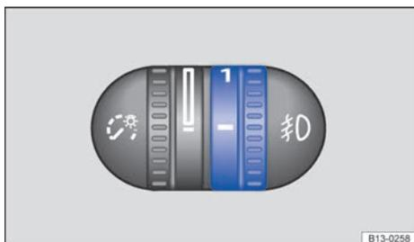
**Fig. 84** Junto al volante: regulador del alcance de las luces.
