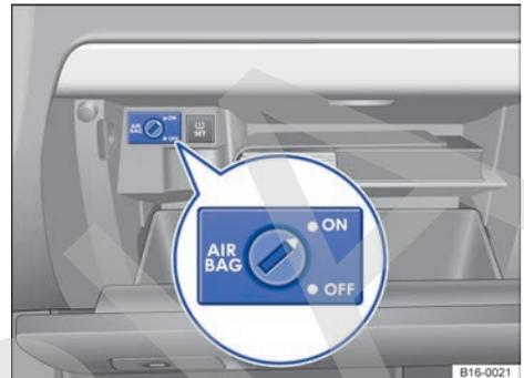
**Fig. 33** En la guantera: conmutador de llave para activar y desactivar el airbag frontal del acompañante.
