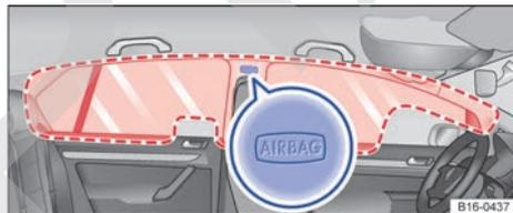
**Fig. 36** En el lado izquierdo del vehículo: ubicación y zona de despliegue del airbag para la cabeza.
