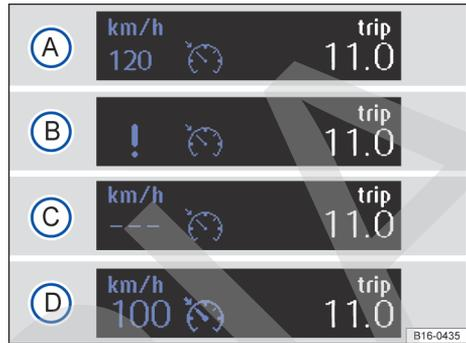
Fig. 116 En la pantalla del cuadro de instrumentos: indicaciones del estado del GRA.
