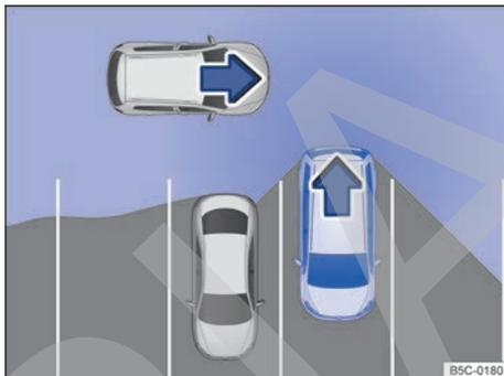
**Fig. 131** Asistente de salida del aparcamiento: zona vigilada alrededor del vehículo que está desaharcando (representación esquemática).
