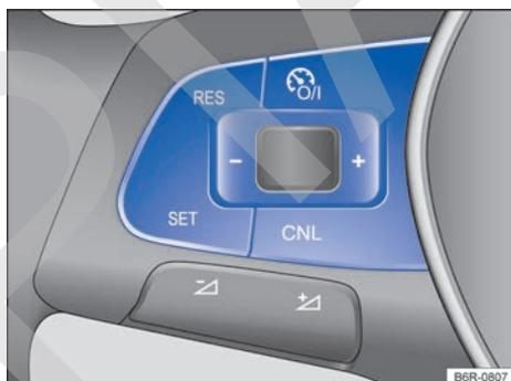
Fig. 118 Lado izquierdo del volante multifunción: teclas para manejar el GRA.
