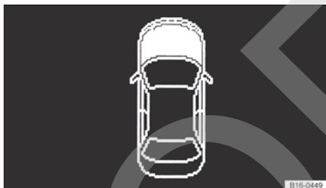
Fig. 196 En la pantalla del cuadro de instrumentos: capó del motor abierto o no cerrado correctamente (variante 1).
