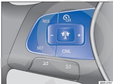
**Fig. 122** Lado izquierdo del volante multifunción: teclas para manejar el ACC.
