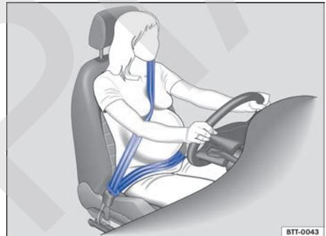
Fig. 28 Colocación correcta de la banda del cinturón en el caso de mujeres embarazadas.
