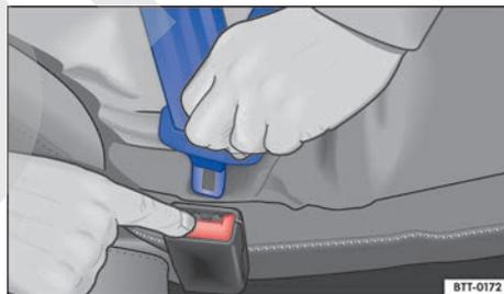
Fig. 26 Soltar la lengüeta del cierre del cinturón.
