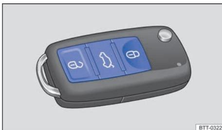
Fig. 47 Llave del vehículo: cierre centralizado.
