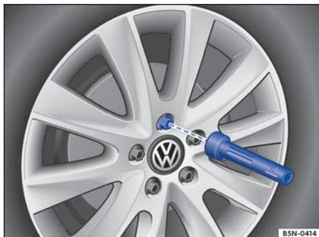
**Fig. 223** Cambio de rueda: desenroscar los tornillos de rueda con el mango del destornillador.
