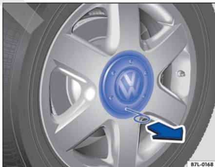
Fig. 213 Desmontar el tapacubos central tirando de él.
