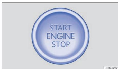
Fig. 105 En la parte inferior de la consola central: pulsador de encendido y arranque para poner el motor en marcha. ▶
