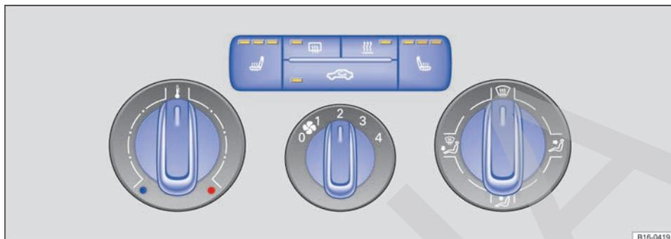
Fig. 97 En la parte superior de la consola central: mandos del sistema de calefacción y ventilación.
