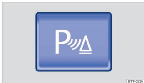
**Fig. 134** En la consola central: tecla para conectar y desconectar el ParkPilot (en función del equipamiento).
