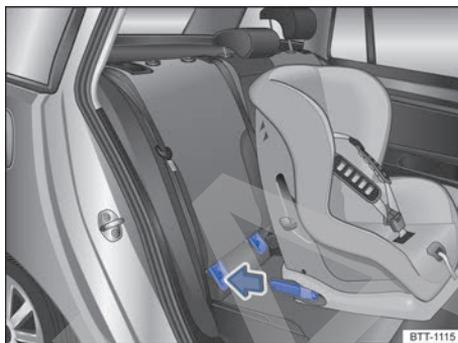
**Fig. 40** Montaje de un asiento para niños ISOFIX con conectores (representación esquemática).
