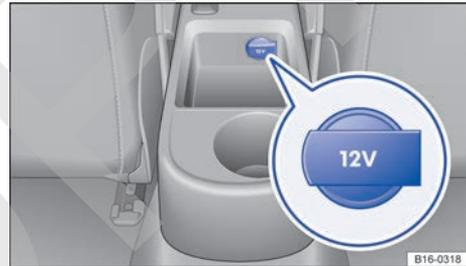
Fig. 159 Toma de corriente de 12 voltios en la consola central: variante 1.
