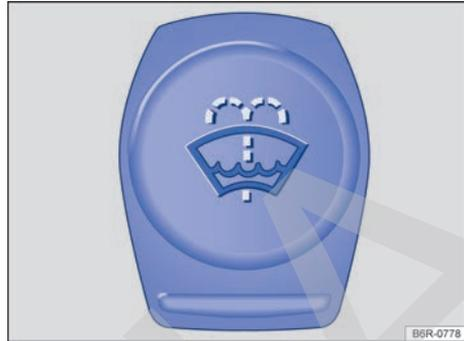
**Fig. 198** En el vano motor: tapa del depósito del líquido lavacrystalales (representación esquemática).
