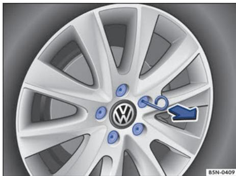
**Fig. 216** Retirar las caperuzas de los tornillos de rueda.
