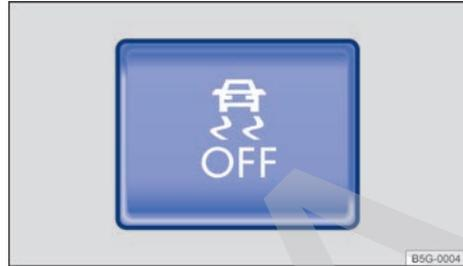
**Fig. 143** En la parte inferior de la consola central: tecla para desconectar y conectar manualmente el ASR (en función del modelo).
