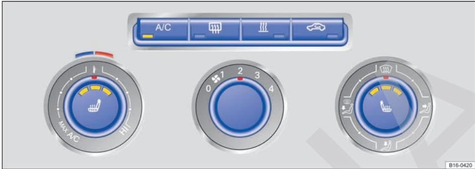
Fig. 94 En la parte superior de la consola central: mandos del climatizador manual (variante 1).
