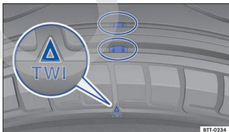
Fig. 210 Perfil del neumático: indicadores de desgaste.
