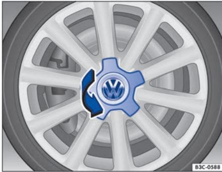
Fig. 214 Desmontar el tapacubos central girándolo.
