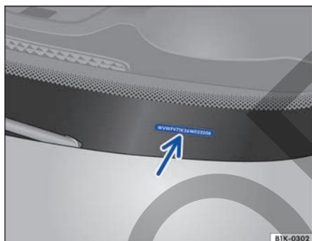
Fig. 248 En el parabrisas: número de identificación del vehículo.
