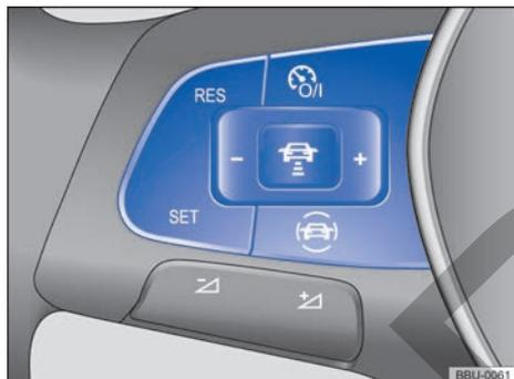
Fig. 128 Lado izquierdo del volante multifunción: teclas para manejar el ACC.
