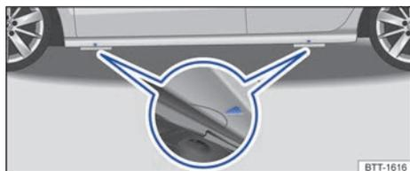
Fig. 239 Puntos de apoyo para el gato.
