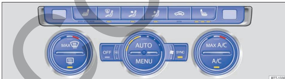
Fig. 102 En la parte superior de la consola central: mandos del Climatronic.
