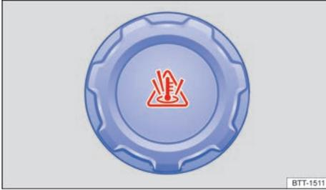
**Fig. 220** En el vano motor: tapa del depósito de expansión del líquido refrigerante del motor (representación esquemática).
