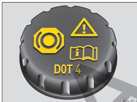
Fig. 221 En el vano motor: tapa del depósito del líquido de frenos (variante 1).
