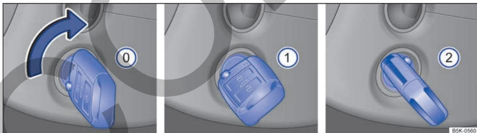
Fig. 108 Junto al volante, en el lado derecho: posiciones de la llave del vehículo en la cerradura de encendido.
