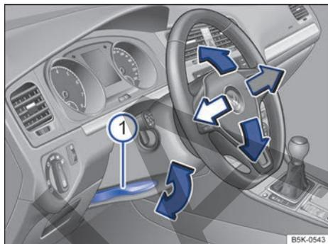
**Fig. 73** Debajo del volante, en el garnecido de la columna de dirección: palanca para el ajuste manual de la posición del volante.
