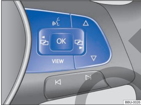
**Fig. 22** Lado derecho del volante multifunción: teclas para utilizar los menús y las indicaciones informativas del cuadro de instrumentos.
