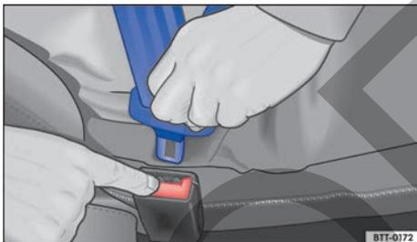
Fig. 37 Soltar la lengüeta del cinturón de seguridad de su cierre.
