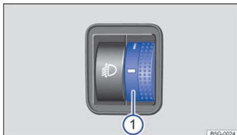
**Fig. 90** Junto al volante: regulador del alcance de las luces ①.
