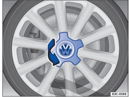
Fig. 232 Desmontar el tapacubos central girándolo.
