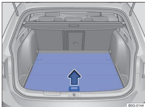
**Fig. 183** En el maletero: abrir el piso del maletero.
