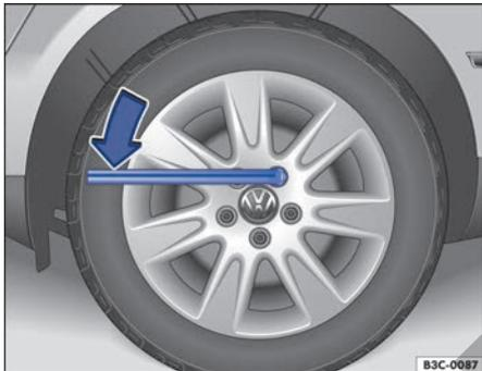
Fig. 235 Cambio de rueda: aflojar los tornillos de la rueda.
