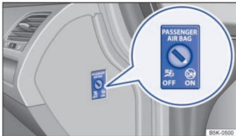
Fig. 44 En el tablero de instrumentos del lado del acompañante: conmutador de llave para activar y desactivar el airbag frontal del acompañante.
