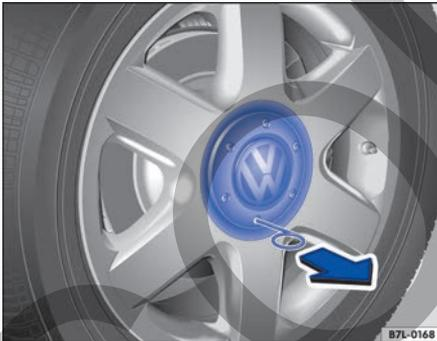
Fig. 231 Desmontar el tapacubos central tirando de él.
