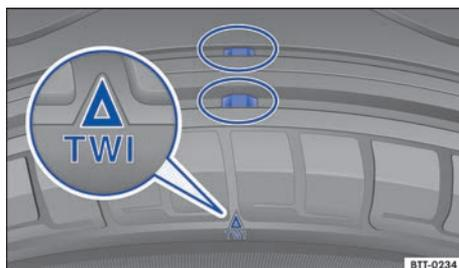
Fig. 228 Perfil del neumático: indicadores de desgaste.
