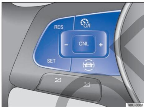
Fig. 124 Lado izquierdo del volante multifunción: teclas para manejar el GRA.
