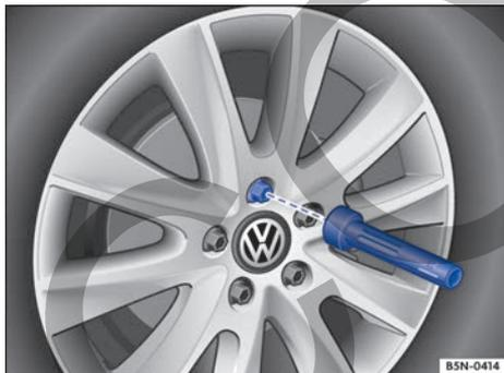
Fig. 241 Cambio de rueda: desenroscar los tornillos de rueda con el mango del destornillador.
