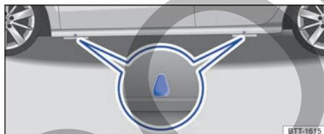
Fig. 237 Puntos de apoyo para el gato.
