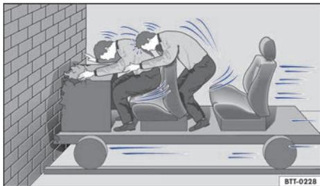
**Fig. 32** El vehículo choca contra el muro. Los ocupantes no llevan colocado el cinturón de seguridad.
