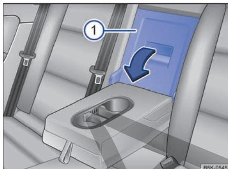
**Fig. 175** En el respaldo del asiento trasero: apertura de la trampilla para cargas largas.
