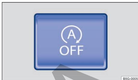
**Fig. 111** En la parte inferior de la consola central: tecla del sistema Start-Stop.
