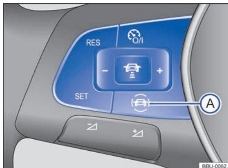
Fig. 23 Lado izquierdo del volante multifunción: tecla de los sistemas de asistencia al conductor...
