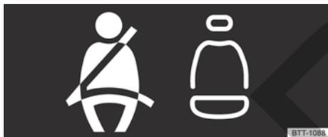
**Fig. 30** Indicación del estado de los cinturones de seguridad de las plazas traseras en la pantalla del cuadro de instrumentos.
