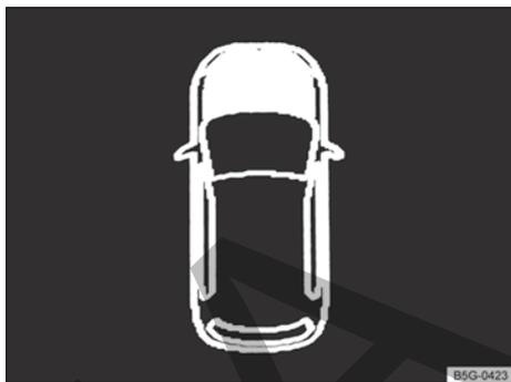
Fig. 215 En la pantalla del cuadro de instrumentos: capó del motor abierto o no cerrado correctamente (representación esquemática).
