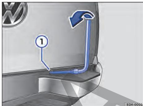
Fig. 189 Controlar el cable elevador con el malacate.
