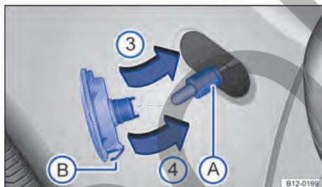
Fig. 149 Luz de giro lateral: sustituir la lámpara.
