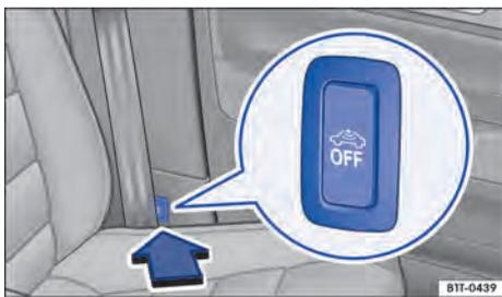
**Fig. 50** Junto al asiento del conductor: tecla para desconectar la vigilancia del habitáculo y el sistema antirremolcado.
