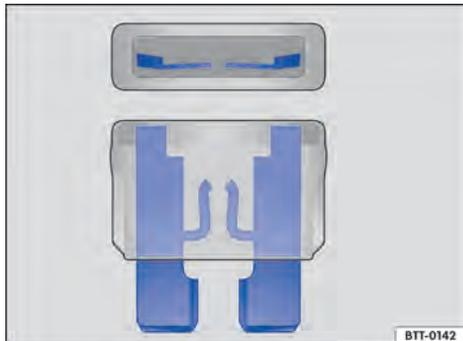
Fig. 156 Representación de un fusible fundido.
