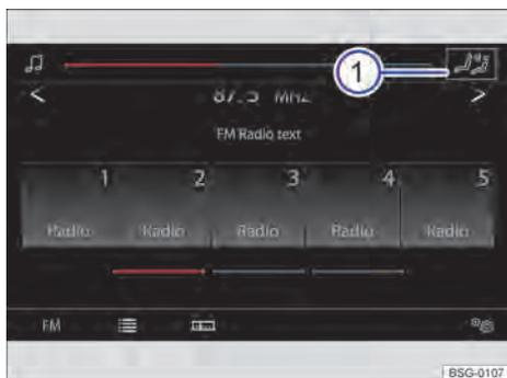
**Fig. 119** Visualización en la pantalla de la consola central: botón de función para acceder a la amplificación digital de la voz.
