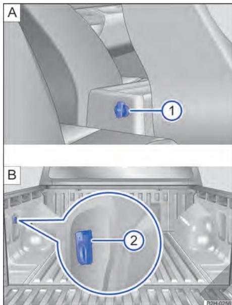
Fig. 118 Tomas de corriente de 12 voltios traseras
