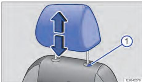
Fig. 63 Apoyacabezas delantero: ajustar (variante 2).
