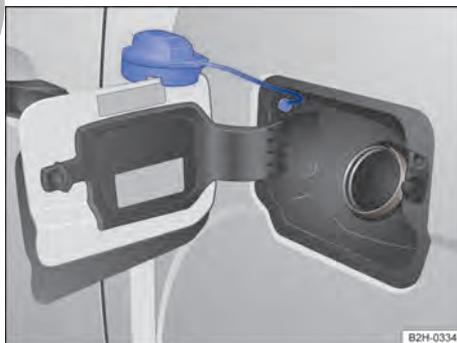
Fig. 133 En el lado izquierdo del vehículo: tapa del tanque de combustible con el tapón abierto.
