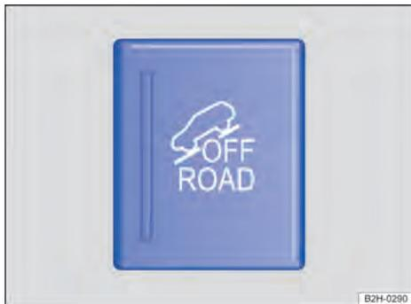
**Fig. 99** En la consola central: tecla para conectar y desconectar manualmente la función fuera de carretera.
