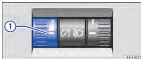
**Fig. 75** Junto al volante: regulador de la iluminación de los instrumentos y los mandos ①.
