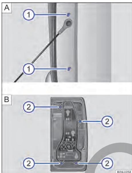
**Fig. 146** **A** En el lateral de la superficie de carga: desmontar el grupo óptico trasero. **B** Soltar el portalámparas.
