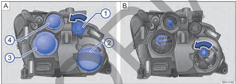
**Fig. 142** En el compartimento del motor: tapas del faro izquierdo. ① Luz de giro, ② luz alta y luz de conducción diurna, ③ luz baja, ④ luz de posición.
