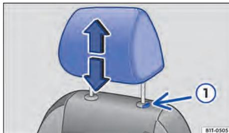
**Fig. 67** Apoyacabezas delantero: desmontar (variante 2).
