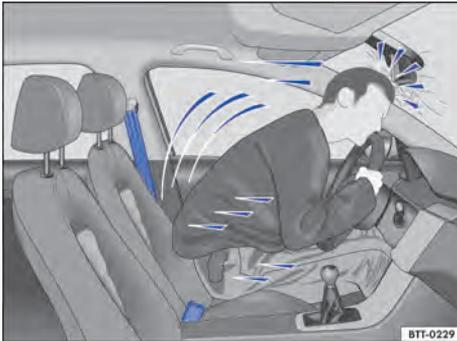
Fig. 21 El conductor sin el cinturón de seguridad colocado sale lanzado hacia delante.
