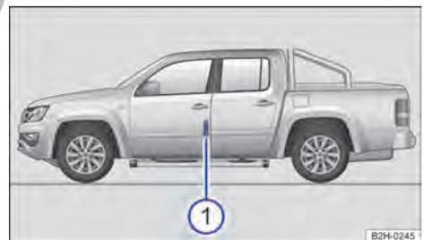
Fig. 181 En la puerta del conductor: adhesivo de la presión de los neumáticos.
