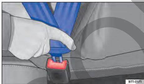
Fig. 24 Insertar la lengüeta del cinturón en su cierre.
