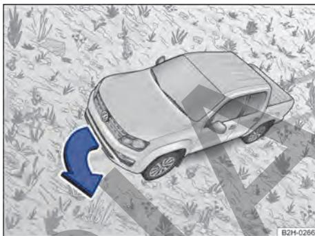
Fig. 104 Representación esquemática: girar hacia la línea de caída.
