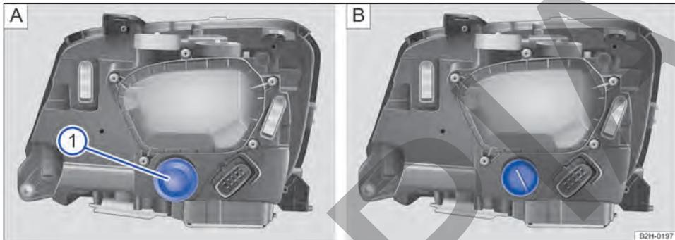
**Fig. 143** En el compartimento del motor: tapa del faro derecho de xenón: ① luz de giro.
