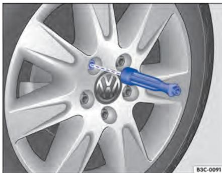
Fig. 202 Cambio de rueda: desenrosca los tornillos de rueda con el mango del destornillador.
