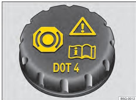
**Fig. 175** En el compartimento del motor: tapa del depósito del líquido de frenos.
