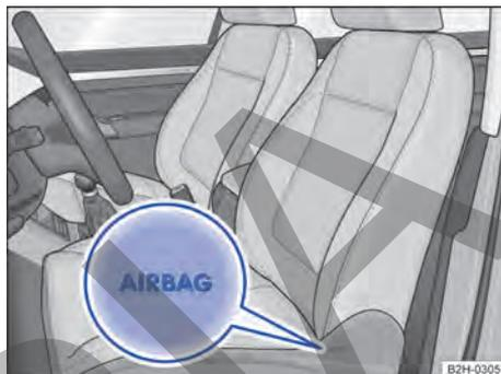
Fig. 37 Lateral de un asiento delantero: ubicación del airbag lateral para la cabeza y el tórax.
