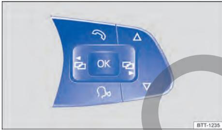
**Fig. 16** En el volante multifunción: teclas para utilizar los menús del cuadro de instrumentos.
