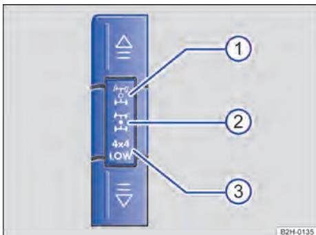
**Fig. 100** En la consola central: teclas y símbolos para conectar y desconectar la tracción total.
