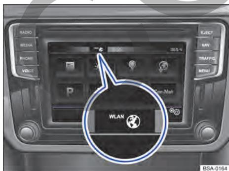
**Fig. 120** En la barra de estado superior del sistema de infotainment: símbolos de Car-Net.
