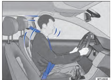
Fig. 23 Los conductores que lleven el cinturón de seguridad colocado correctamente no saldrán lanzados en caso de un frenazo.
