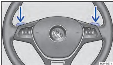
**Fig. 96** Volante con palancas de cambio para el Tiptronic.
