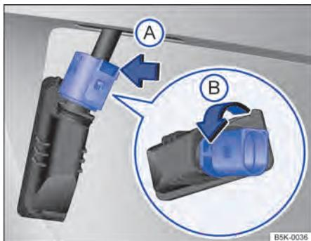
Fig. 151 Luz de la patente: desmontaje del portalámparas.
