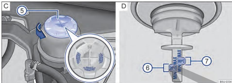
**Fig. 88** En el vano del motor (variante 2): [C] Tanque del fluido de la dirección hidráulica. [D] Marcas para controlar el nivel del líquido de la dirección asistida.
