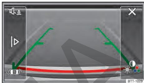
**Fig. 96** Exhibición en display de la cámara de marcha atrás encendida (representación esquemática).
