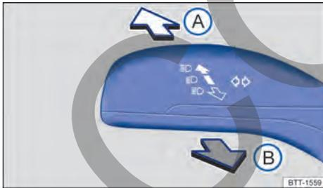
**Fig. 66** A la izquierda en la columna de dirección: palanca de los indicadores de dirección y del farol alto.
