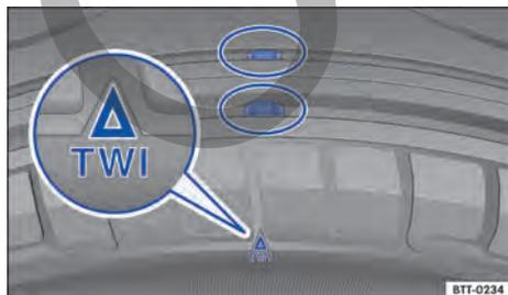
**Fig. 215** Perfil del neumático: indicadores de desgaste.
