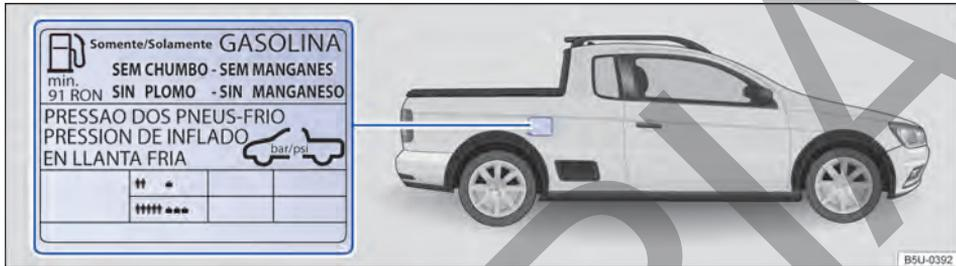
Fig. 214 En la parte interior de la portezuela del depósito de combustible: etiqueta con la presión de los neumáticos.
