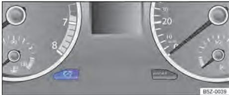
**Fig. 67** En el panel de instrumentos: tecla de regulación de la iluminación de los instrumentos y de los interruptores.
