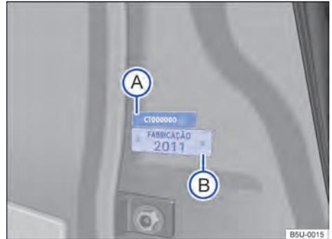
Fig. 229 En la columna de la puerta delantera derecha: etiqueta con el número de identificación del vehículo parcial (VIS) (A) y la etiqueta del año de fabricación (B).
