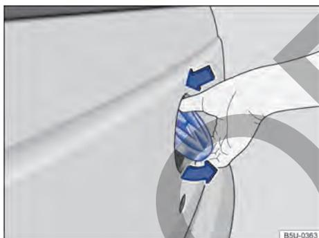
Fig. 47 Abrir la tapa del compartimento de carga.
