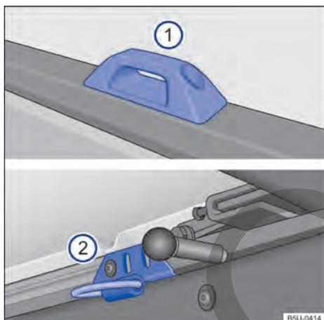
**Fig. 166** En el compartimento de carga: soportes fijos ① para vehículos sin capota marítima y ② para vehículos con capota marítima.
