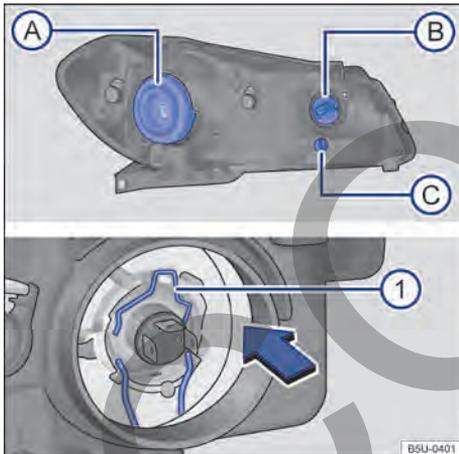
**Fig. 181** En el compartimento del motor: vista trasera del farol delantero con cubierta de goma (lado izquierdo de la ilustración): (A) farol bajo / alto (B) indicadores de dirección y (C) luz de posición. Vista trasera del farol delantero sin cubierta de goma (lado derecho de la ilustración): (1) resorte de bloqueo de la lámpara incandescente del farol bajo/farol alto.
