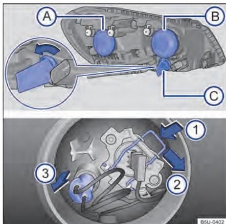
**Fig. 183** En el compartimento del motor: vista trasera del farol delantero con cubierta de goma (lado izquierdo de la ilustración) - **A** farol bajo **B** farol alto y luz de posición y **C** indicador de dirección. Vista trasera del farol delantero sin cubierta de goma (lado derecho de la ilustración): **1** resorte de bloqueo de la lámpara incandescente del farol y **2** luz de posición.
