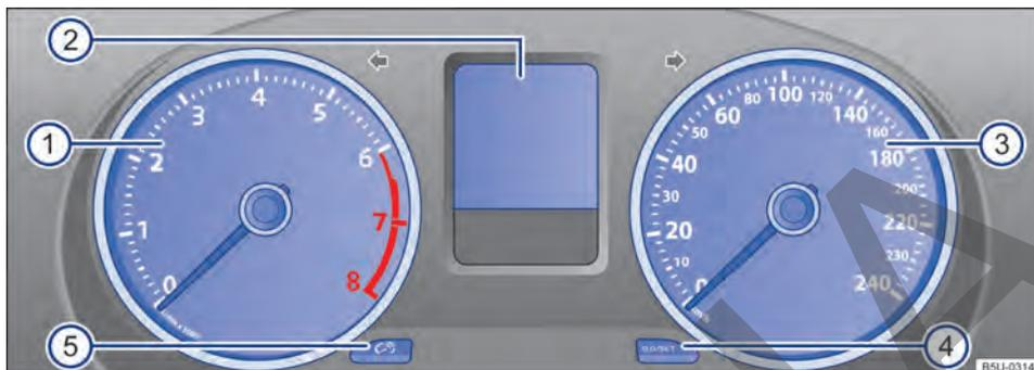
Fig. 10 Instrumento combinado en el panel de instrumentos (variante 1).
