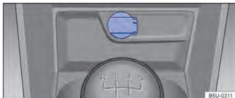
Fig. 114 En la consola central delantera: toma de corriente de 12 V.
