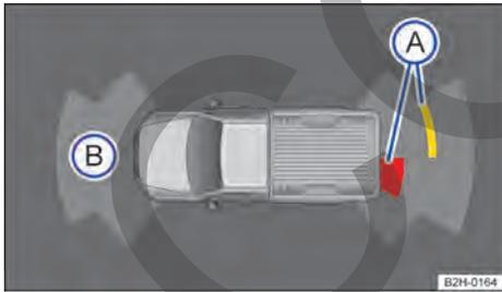
**Fig. 94** Presentación del display del control de distancia de estacionamiento (display a color): (A) obstáculo reconocido en el segmento. (B) zona registrada delante del vehículo.
