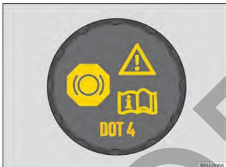
**Fig. 209** En el compartimento del motor: tapón de cierre del depósito del líquido de frenos.
