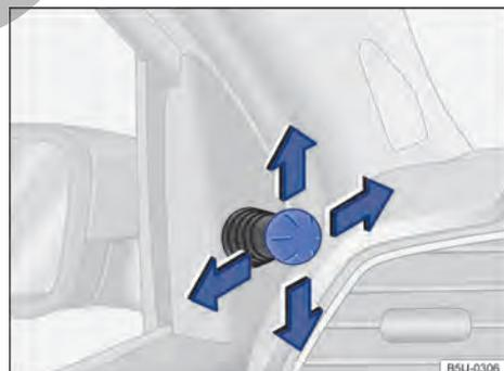
**Fig. 73** En las puertas delanteras: interruptor de ajuste de los espejos retrovisores externos mecánicos. ▶
