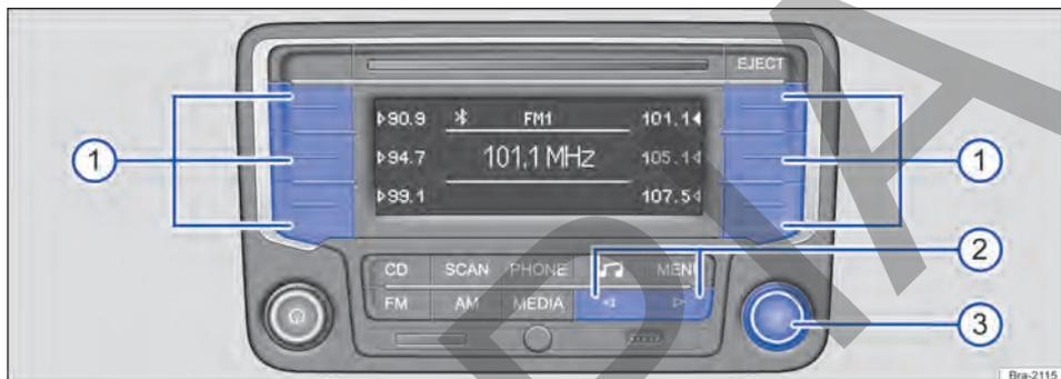
**Fig. 128** Cambio de emisora por medio de las teclas de función o de las teclas del equipo.
