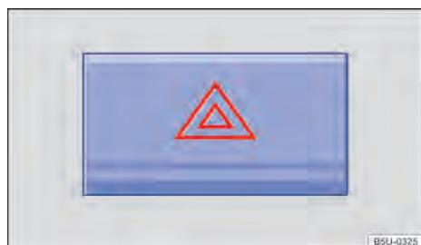
Fig. 40 En la parte superior de la consola central: interruptor de las luces de advertencia.
