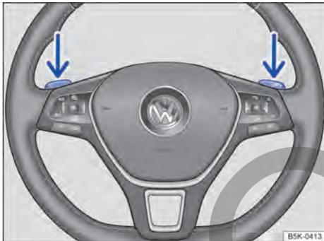
Fig. 83 Volante con selectores basculantes de Tiptronic.
