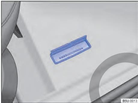
**Fig. 191** Delante del asiento del acompañante delantero: número de identificación del vehículo (número del chasis) en el piso, delante del asiento del acompañante delantero.
