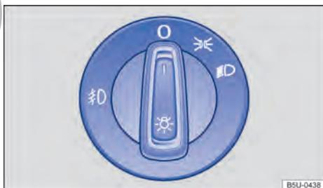
**Fig. 61** Al lado del volante: interruptor de luces.
