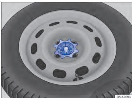
**Fig. 180** En el maletero: manivela para fijación de la rueda de emergencia.
