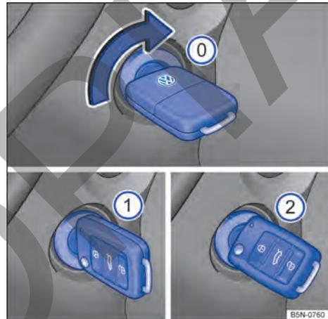
Fig. 78 Al lado del volante de la dirección, a la derecha: posiciones de la llave del vehículo en la cerradura de encendido.
