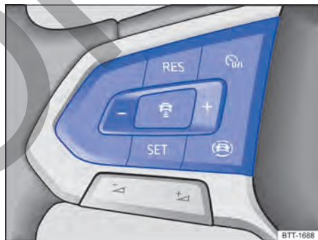
Fig. 100 Lado izquierdo del volante multifunción: teclas para comandar el ACC.
