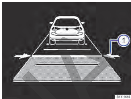
Fig. 101 En el display del instrumento combinado: ajustar la distancia (representación esquemática, el ACC regula).
