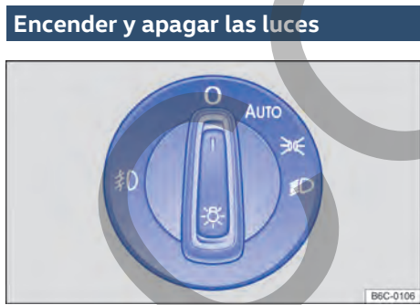
Fig. 69 Al lado del volante: interruptor de luces (una variante).
