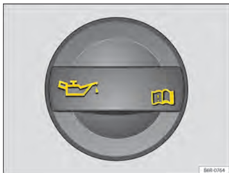
Fig. 181 En el compartimento del motor: tapón de la boca de llenado del aceite del motor.
