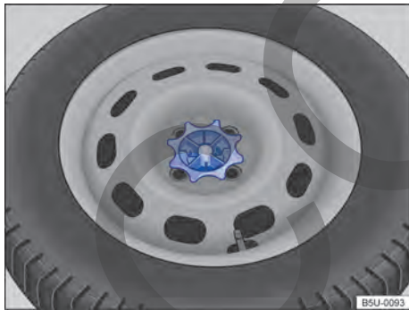
Fig. 191 En el maletero: manivela para fijación de la rueda de emergencia.
