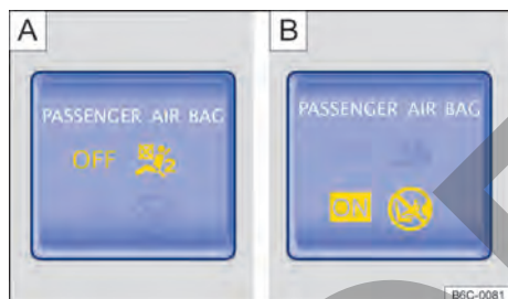
Fig. 32 En la parte superior de la consola central: luz de control para el airbag frontal del acompañante delantero apagada [A] o luz de control para el airbag frontal del acompañante delantero encendida [B].
