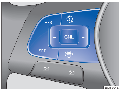
Fig. 95 Lado izquierdo del volante multifunción (variante 1): teclas para controlar el limitador de velocidad.
