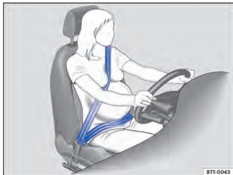
Fig. 30 Posición correcta de la banda del cinturón de seguridad para mujeres embarazadas.
