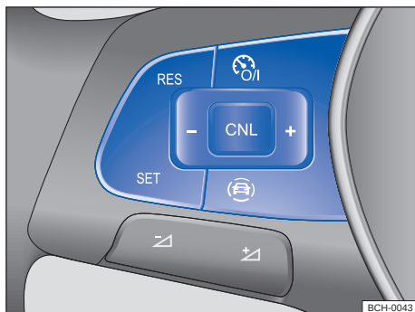
Fig. 93 Lado izquierdo del volante multifunción (variante 1): teclas para controlar el GRA
