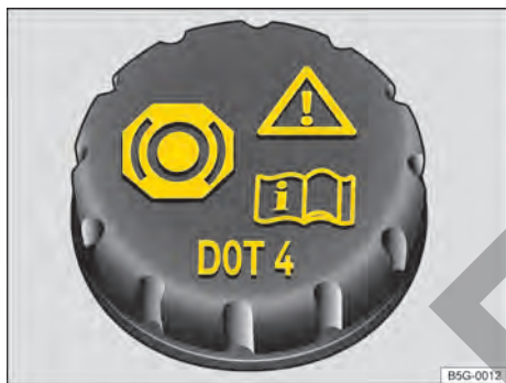
Fig. 184 En el compartimento del motor: tapón de cierre del depósito del líquido de frenos.
