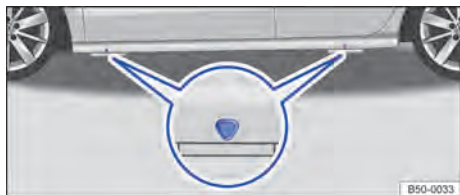
Fig. 194 Puntos de apoyo del gato.
