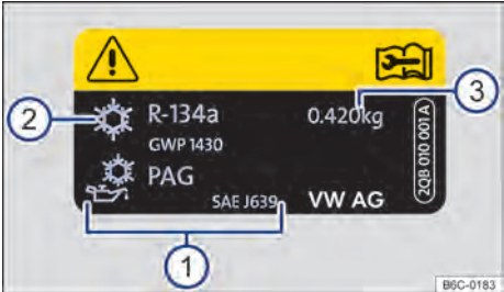
Fig. 202 Información del aire acondicionado
