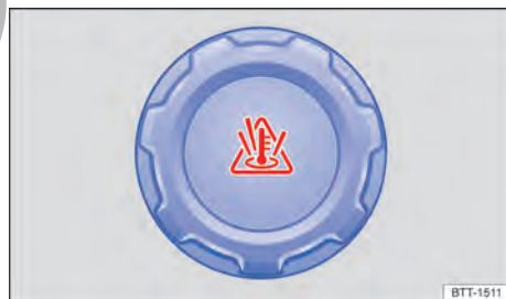
Fig. 183 En el compartimento del motor: tapa del depósito de expansión del líquido refrigerante del motor.
