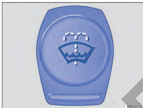
Fig. 179 En el compartimento del motor: tapón de cierre del depósito de agua de los lavavidrios.
