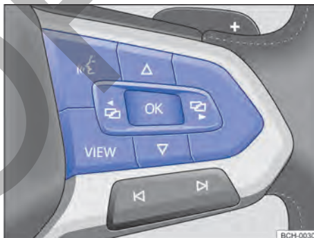
Fig. 17 Lado derecho del volante multifunción (variante 2): teclas para el mando de los menús y visualizaciones de información del instrumento combinado.
