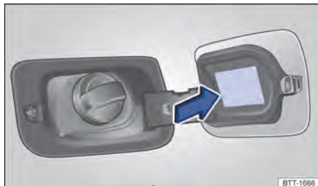
Fig. 189 En la parte interior de la portezuela del depósito de combustible: etiqueta con la presión de los neumáticos.
