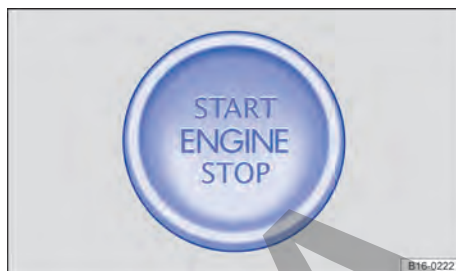
Fig. 86 En la parte inferior de la consola central: tecla de arranque para poner en marcha el motor
