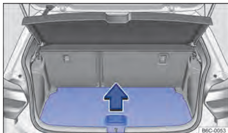
Fig. 149 En el maletero: levantar el piso del maletero.
