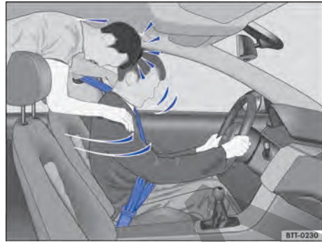
Fig. 27 El pasajero sin cinturón de seguridad en el asiento trasero es lanzado hacia adelante sobre el conductor con cinturón de seguridad.
