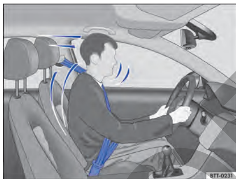
Fig. 28 Conductor protegido por el cinturón de seguridad correctamente colocado en una maniobra de frenado súbita.
