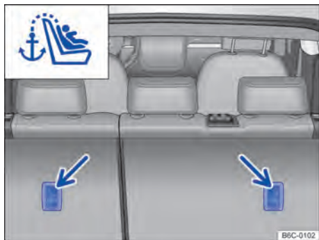
Fig. 43 Ojales de retención para el cinturón de fijación superior en el lado de atrás del asiento trasero.
