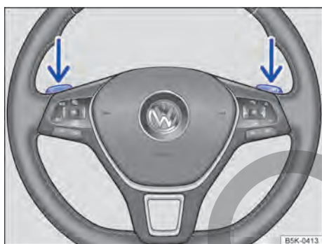
Fig. 92 Volante con selectores basculantes de Tiptronic.
