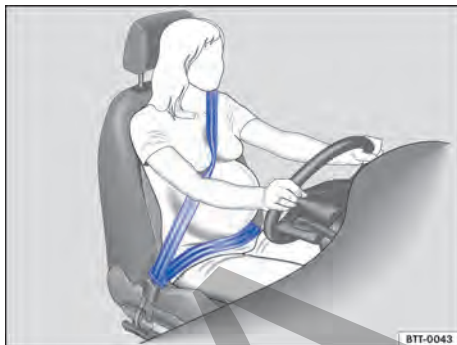
Fig. 32 Posición correcta de la banda del cinturón para mujeres embarazadas.
