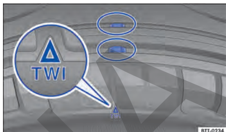
Fig. 194 Perfil del neumático: indicadores de desgaste.
