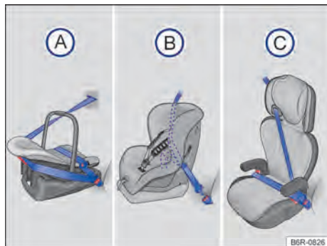
Fig. 36 Las ilustraciones (A), (B) y (C) muestran la fijación del sistema de retención infantil solo con el cinturón de seguridad del vehículo.
