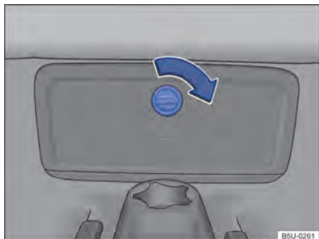
Fig. 177 En el piso del asiento trasero: acceso a la caja de fijación de las herramientas de a bordo.
