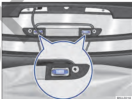
Fig. 193 Linterna de freno elevada: remover la lámpara incandescente de iluminación del compartimento de carga.
