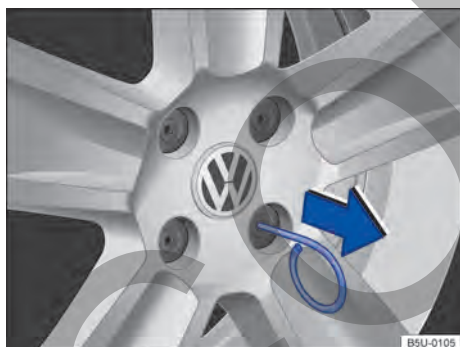
Fig. 219 Retirar las caperzas de los tornillos de rueda.
