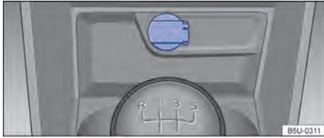
Fig. 114 En la consola central delantera: toma de corriente de 12 V.
