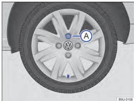
Fig. 224 Cambio de rueda: secuencia de desmontaje de los tornillos de la rueda.
