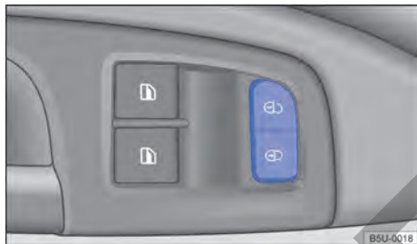
Fig. 42 En la puerta del conductor: tecla del cierre centralizado.
