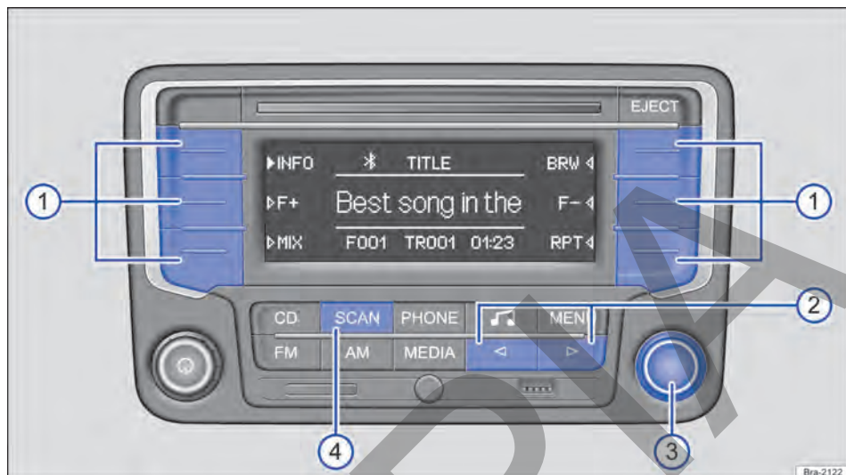
Fig. 160 Ejemplo de visualización en el modo Media: seleccionar los modos de reproducción.
