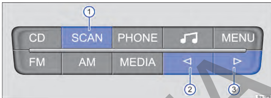
Fig. 152 Iniciar y finalizar la reproducción automática (SCAN).
