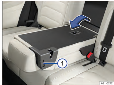
Fig. 198 En el respaldo del asiento trasero: apertura de la trampilla para cargas largas.
