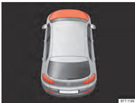
Fig. 236 En la pantalla del cuadro de instrumentos: capó delantero abierto o no cerrado correctamente (representación esquemática).
