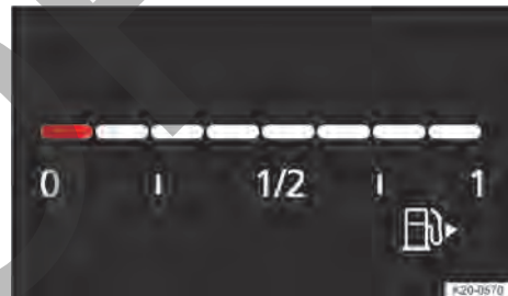
Fig. 19 Indicador del nivel de combustible en el cuadro de instrumentos digital, versión Basic (representación esquemática). <
