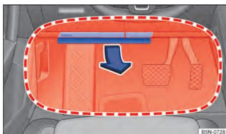
Fig. 45 En el lado del conductor: zona de despliegue del airbag para las rodillas.
