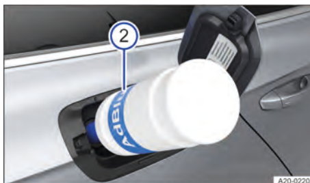
Fig. 209 Detrás de la tapa del depósito de combustible: repostar AdBlue con una botella de recarga (representación esquemática).
