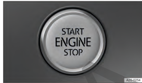
Fig. 127 En la parte inferior de la consola central: pulsador de encendido y arranque para poner el motor en marcha.
