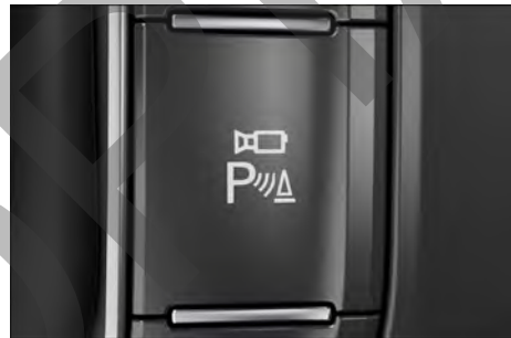
Fig. 170 En la consola central: tecla para conectar y desconectar el sistema de visión periférica.
