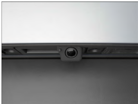
Fig. 267 En la parte trasera del vehículo: cámara de marcha atrás en la manilla con pulsador (representación esquemática).
