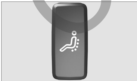
Fig. 102 En la parte inferior del asiento del conductor: tecla de la función de masaje.
