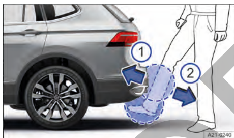
Fig. 74 Portón del maletero con cierre controlado por sensor (Easy Close).
