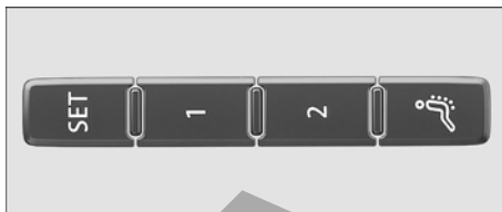
Fig. 100 En el lateral exterior del asiento del conductor: teclas de memoria.
