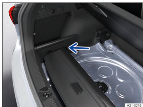
Fig. 188 Debajo del piso del maletero: guardar la cubierta del maletero.
