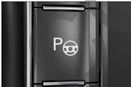
Fig. 167 En la consola central: tecla para conectar el sistema de aparcamiento asistido.
