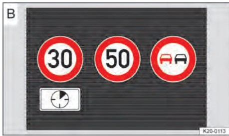
Fig. 26 En la pantalla del cuadro de instrumentos: ejemplos de visualización de señales de tráfico.
