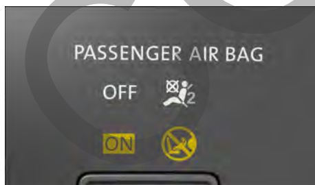
Fig. 36 En la consola central: testigo de control de la activación del airbag frontal del acompañante.
