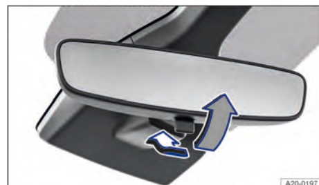
Fig. 113 En el parabrisas: retrovisor interior antideslumbrante manual.
