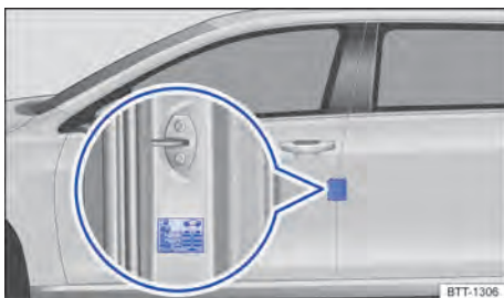
Fig. 249 En el pilar de la puerta del conductor: adhesivo de la presión de los neumáticos (o en la cara interior de la tapa del depósito de combustible).
