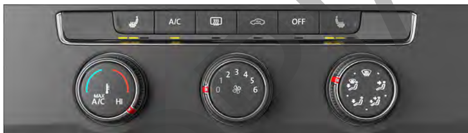
Fig. 117 En la parte superior de la consola central: panel de mandos del climatizador manual.
