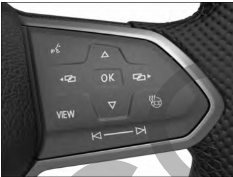
Fig. 12 Lado derecho del volante multifunción: teclas para utilizar los menús y las indicaciones informativas del cuadro de instrumentos (variante 2).
