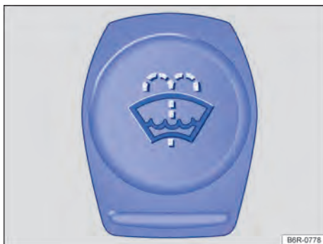
Fig. 237 En el vano motor: tapa del depósito del líquido lavacristales.
