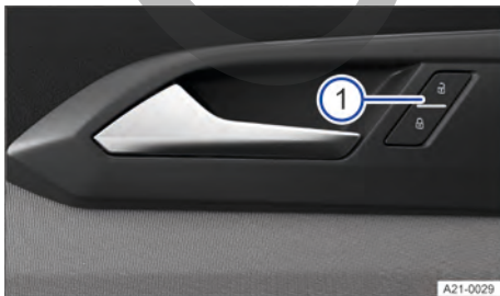
Fig. 63 En la puerta del conductor: tecla del cierre centralizado (representación esquemática).
