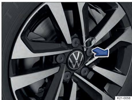
Fig. 254 Retirar las caperuzas de los tornillos de rueda.
