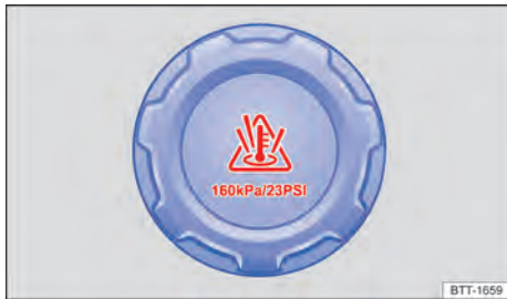
Fig. 242 En el vano motor: tapa del depósito de expansión del líquido refrigerante del motor (representación esquemática).
