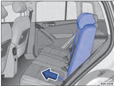
Fig. 88 Asiento trasero: abatir y levantar el respaldo.
