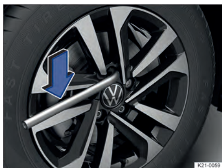
Fig. 255 Cambio de rueda: aflojar los tornillos de rueda.
