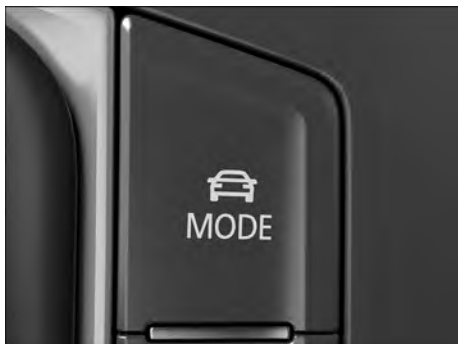
Fig. 135 En la consola central: tecla MODE para seleccionar los perfiles de conducción.
