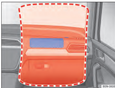
Fig. 38 Ubicación y zona de despliegue del airbag frontal del acompañante.
