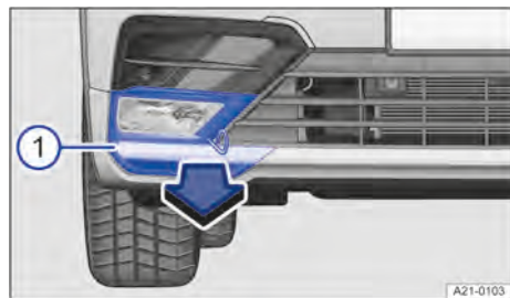
Fig. 216 En el lado derecho del paragolpes delantero R-Line: desmontar la cubierta del faro antiniebla.
