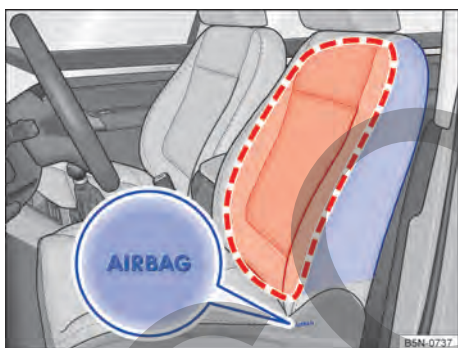
Fig. 41 Lateral de un asiento delantero: ubicación y zona de despliegue del airbag lateral.
