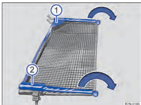
Fig. 193 Desplegar la red de separación.
