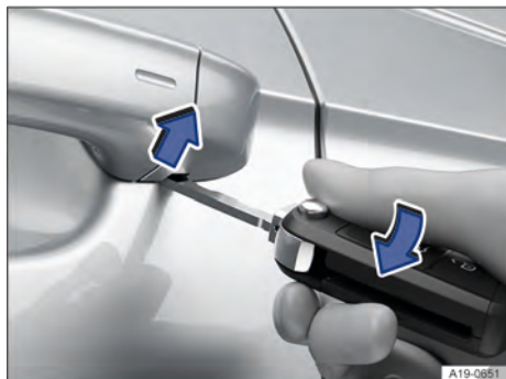
Fig. 65 Manilla de la puerta del conductor: desprender la caperuza haciendo palanca.
