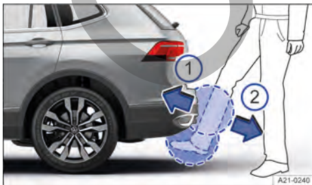
Fig. 73 Portón del maletero con apertura controlada por sensor (Easy Open).
