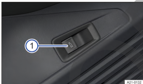
Fig. 71 En la puerta del conductor: tecla de desbloqueo del portón del maletero.
