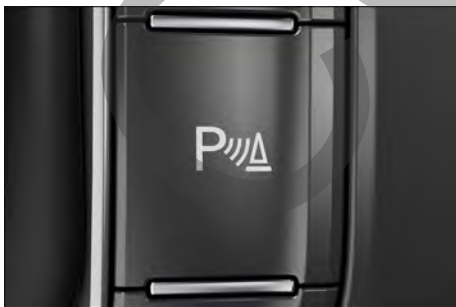
Fig. 162 En la consola central: tecla para conectar y desconectar la ayuda de aparcamiento.
