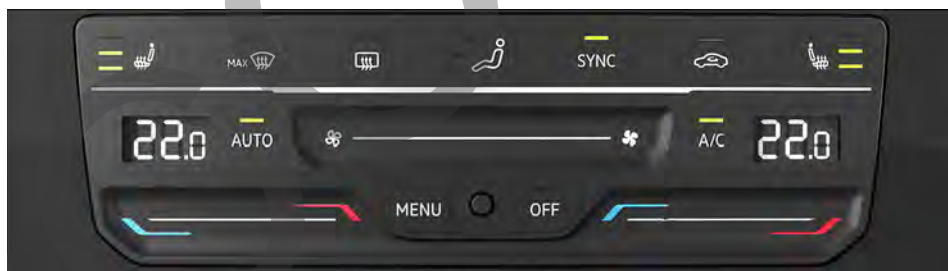
Fig. 118 En la parte superior de la consola central: panel de mandos del Climatronic.
