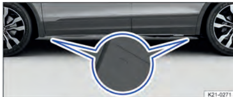
Fig. 260 Puntos de apoyo para el gato (representación esquemática).
