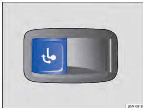
Fig. 200 En el lado derecho del maletero: tecla para desbloquear el enganche para remolque.
