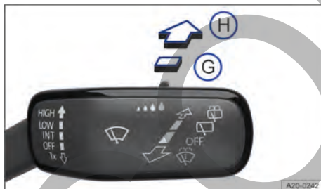
Fig. 110 En el lado derecho de la columna de dirección: manejo del limpiacristales.
