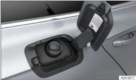
Fig. 207 Detrás de la tapa del depósito de combustible: tapón del depósito (representación esquemática).
