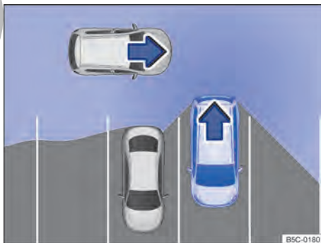
Fig. 174 Representación esquemática del asistente de salida del aparcamiento: zona vigilada alrededor del vehículo que está desapareando.
