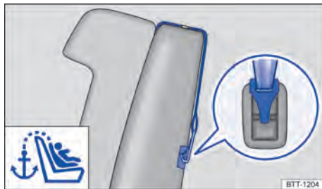
Fig. 50 En la parte posterior de la segunda fila de asientos: argollas de sujeción para el cinturón de fijación superior.
