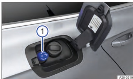
Fig. 208 Detrás de la tapa del depósito de combustible: tapón del depósito de AdBlue (representación esquemática).
