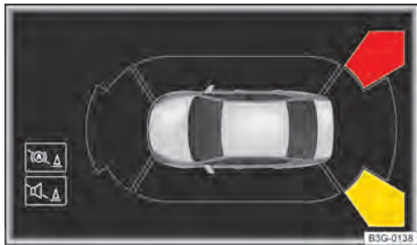
Fig. 175 En el sistema de infotainment: visualización del asistente de salida del aparcamiento.
