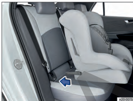
Fig. 49 Representación esquemática: montaje de un asiento para niños con conectores.
