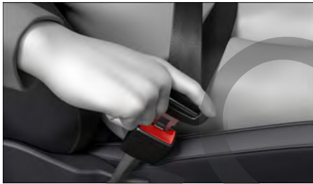
Fig. 30 Insertar la lengüeta del cinturón de seguridad en su cierre.
