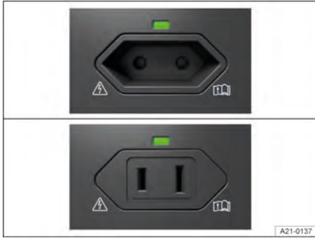
Fig. 180 En el lado izquierdo del maletero: toma de corriente de 230, 115 o 100 voltios.
