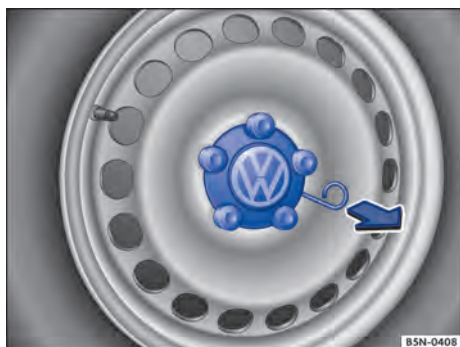
Fig. 252 Desmontar el tapacubos central tirando de él.
