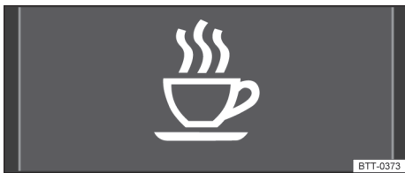
Fig. 24 En la pantalla del cuadro de instrumentos: símbolo de detección del cansancio.
