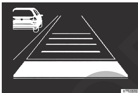
Fig. 146 En la pantalla del cuadro de instrumentos: vehículo detectado que circula más lentamente que el propio por el carril izquierdo (representación esquemática).
