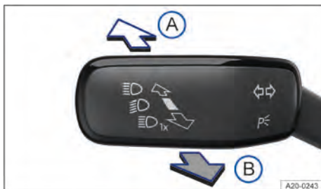
Fig. 105 En el lado izquierdo de la columna de dirección: palanca de los intermitentes y de la luz de carretera.
