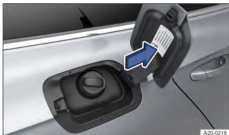
Fig. 202 En la cara interior de la tapa del depósito de combustible: adhesivo del combustible (representación esquemática).
