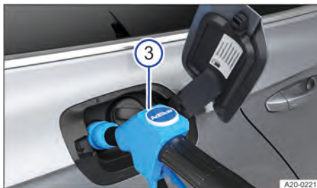
Fig. 210 Detrás de la tapa del depósito de combustible: repostar AdBlue con la pistola de un surtidor (representación esquemática).
