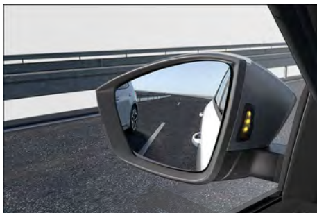
Fig. 158 En la carcasa de los retrovisores exteriores: indicaciones ópticas del asistente de cambio de carril.
