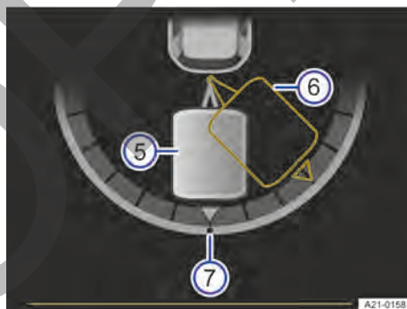
Fig. 173 En la pantalla del cuadro de instrumentos: ajustar el ángulo del conjunto vehículo tractor y remolque.
