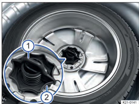
Fig. 259 En el maletero: ruedecilla para fijar la rueda de repuesto.
