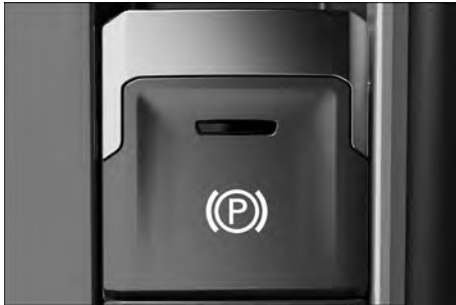
Fig. 159 En la consola central: tecla del freno de estacionamiento electrónico.
