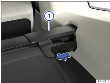
Fig. 187 En el maletero: desmontar la cubierta del maletero.
