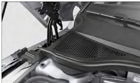
Fig. 266 Entre el vano motor y el parabrisas: caja de aguas (representación esquemática).
