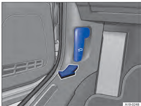
Fig. 234 En la zona reposapiés del lado del conductor: palanca de desbloqueo del capó delantero (representación esquemática).
