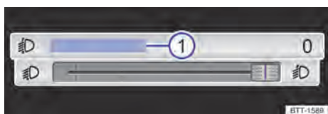
Fig. 108 En el sistema de infotainment: regulador táctil para la regulación del alcance de las luces.
