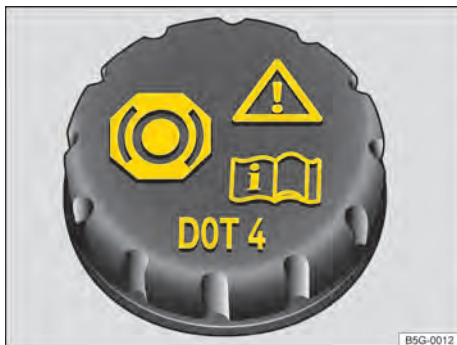
Fig. 244 En el vano motor: tapa del depósito del líquido de frenos.
