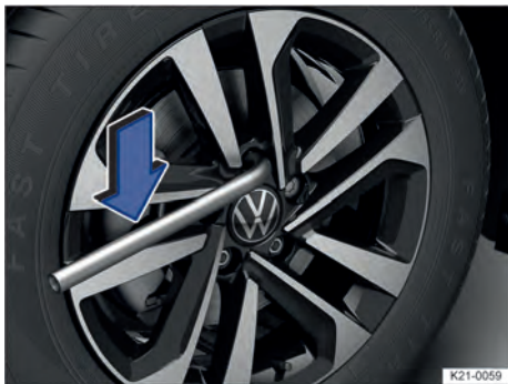
Fig. 263 Cambio de rueda: desenroscar los tornillos de rueda con la llave de rueda.
