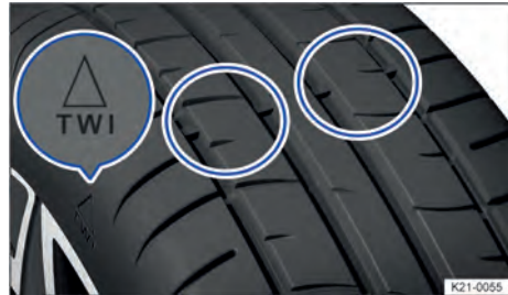
Fig. 250 Perfil del neumático: indicadores de desgaste.
