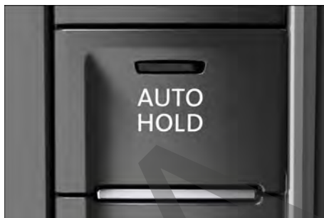
Fig. 160 En la consola central: tecla de la función Auto-Hold.
