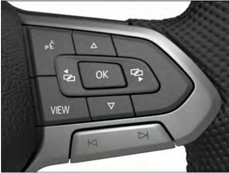
Fig. 11 Lado derecho del volante multifunción: teclas para utilizar los menús y las indicaciones informativas del cuadro de instrumentos (variante 1).
