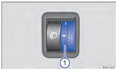
Fig. 107 Junto al volante: regulador del alcance de las luces ①.
