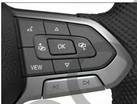
Fig. 13 Lado derecho del volante multifunción: teclas para utilizar los menús y las indicaciones informativas del cuadro de instrumentos (variante 1).
