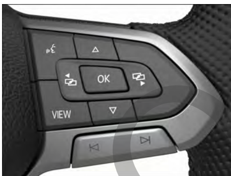
Fig. 10 Lado derecho del volante multifunción: teclas para utilizar los menús y las indicaciones informativas del cuadro de instrumentos (variante 1).
