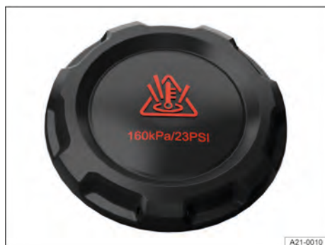
Fig. 175 En el vano motor: tapa del depósito de expansión del líquido refrigerante del motor (representación esquemática).
