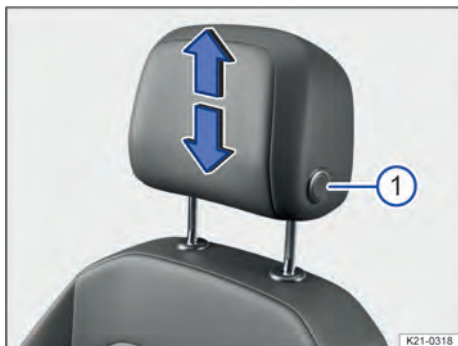
Fig. 72 Representación esquemática: ajuste de los apoyacabezas delanteros.
