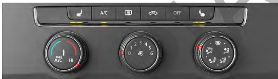
Fig. 92 En la parte superior de la consola central: panel de mandos del climatizador manual.
