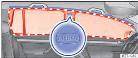
Fig. 38 En el lado izquierdo del vehículo: ubicación y zona de despliegue del airbag para la cabeza.
