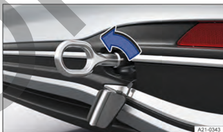
Fig. 162 En el lado derecho del paragolpes trasero: enrosca la argolla de remolque, variante 1.
