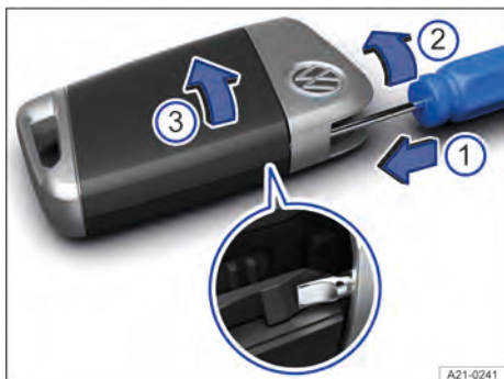
Fig. 52 Llave del vehículo: abrir la tapa del compartimento de la pila.
