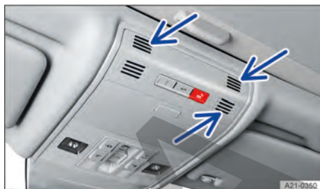
Fig. 60 En la consola del techo: sensores de la vigilancia del habitáculo (flechas).
