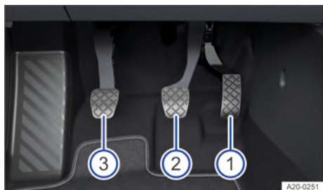
Fig. 94 En la zona reposapiés: pedales en los vehículos con cambio manual.
