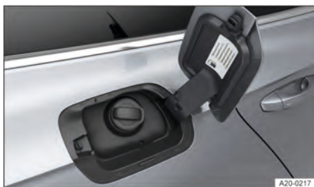
Fig. 144 Detrás de la tapa del depósito de combustible: tapón del depósito (representación esquemática).
