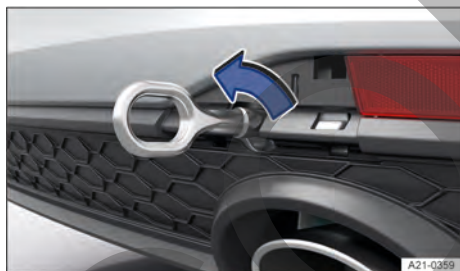
Fig. 164 En el lado derecho del paragolpes trasero: enrosca la argolla de remolque, variante 2.
