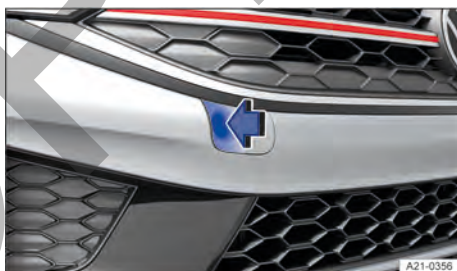
Fig. 158 En el lado derecho del paragolpes delantero: retirar la tapa, variante 2.
