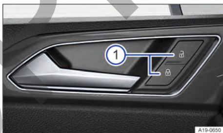
Fig. 56 En la puerta del conductor: tecla del cierre centralizado.
