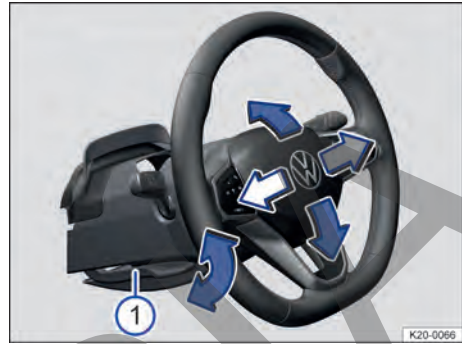
Fig. 65 Debajo del volante, en el guardacaja de la columna de dirección: palanca para el ajuste manual de la posición del volante (representación esquemática).
