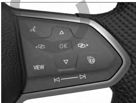
Fig. 11 Lado derecho del volante multifunción: teclas para utilizar los menús y las indicaciones informativas del cuadro de instrumentos (variante 2).
