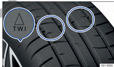
Fig. 182 Perfil del neumático: indicadores de desgaste.
