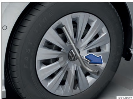
Fig. 185 Desmontar el tapacubos integral.
