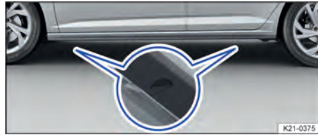
Fig. 192 Puntos de apoyo para el gato (variante 2).
