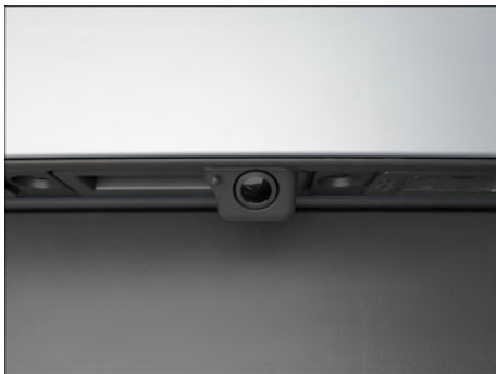
Fig. 199 En la parte trasera del vehículo: cámara de marcha atrás en la manilla con pulsador (representación esquemática).
