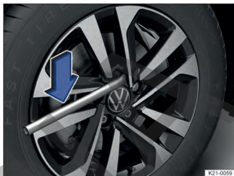
Fig. 187 Cambio de rueda: aflojar los tornillos de rueda.
