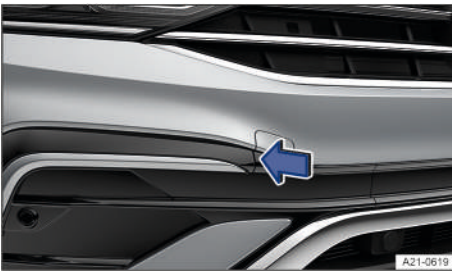
Fig. 240 En el lado derecho del paragolpes delantero: retirar la tapa.
