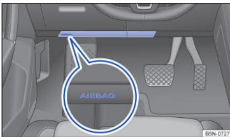
Fig. 50 En el lado del conductor: ubicación del airbag para las rodillas (en función del equipamiento).
