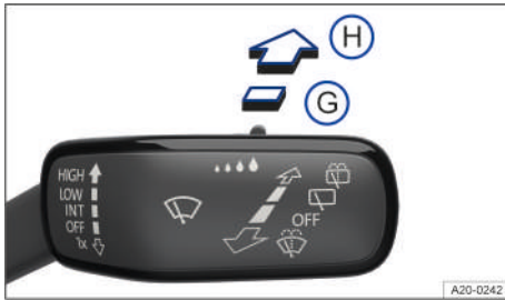
Fig. 120 En el lado derecho de la columna de dirección: manejo del limpiaventa.
