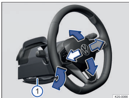
Fig. 85 Debajo del volante, en el guarnecido de la columna de dirección: palanca para el ajuste manual de la posición del volante (representación esquemática).
