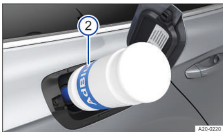
Fig. 223 Detrás de la tapa del depósito de combustible: repostar AdBlue con una botella de recarga (representación esquemática).
