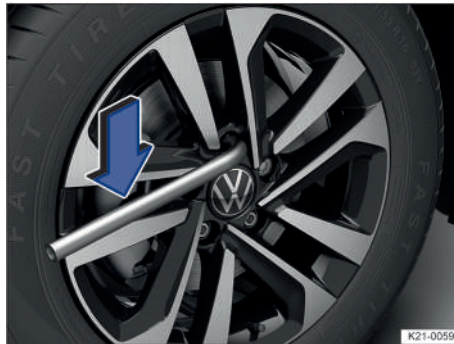
Fig. 271 Cambio de rueda: desenroscar los tornillos de rueda con la llave de rueda.
