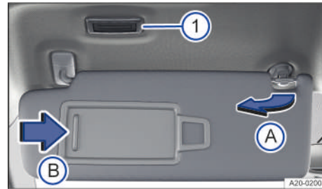
Fig. 125 En el revestimiento interior de la parte delantera del techo: parasol.
