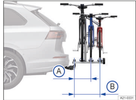
Fig. 214 Representación esquemática del voladizo máximo de la carga en un portabicicletas para dos o tres bicicletas.
