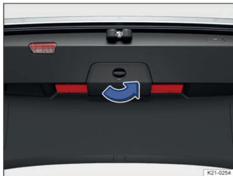
Fig. 58 En el portón trasero: soporte del triángulo de preseñalización.
