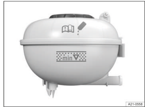
Fig. 254 En el vano motor: marcas en el depósito de expansión del líquido refrigerante del motor (representación esquemática).
