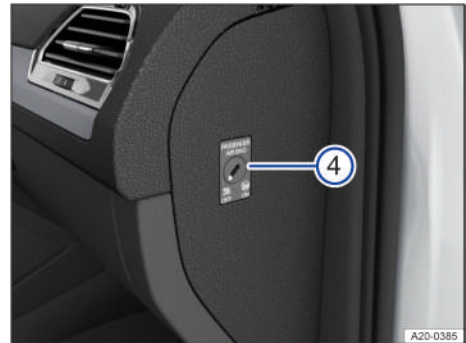
Fig. 9 Con la puerta del acompañante abierta (vehículos con el volante a la izquierda): conmutador de llave en el tablero de instrumentos (disposición simétrica en los vehículos con el volante a la derecha).
