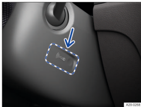
Fig. 138 En el lado derecho de la columna de dirección: función de arranque de emergencia en los vehículos con el sistema de cierre y arranque sin llave "Keyless Access".
