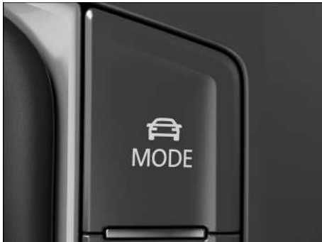
Fig. 148 En la consola central: tecla MODE para seleccionar los perfiles de conducción.
