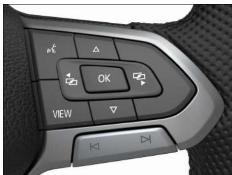
Fig. 11 Lado derecho del volante multifunción: manejo del cuadro de instrumentos digital Pro (variante 1).
