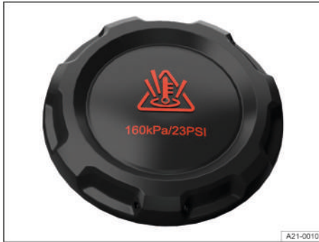
Fig. 253 En el vano motor: tapa del depósito de expansión del líquido refrigerante del motor (representación esquemática).
