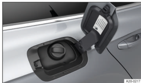
Fig. 221 Detrás de la tapa del depósito de combustible: tapón del depósito (representación esquemática).
