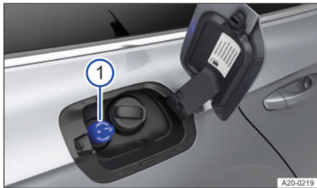
Fig. 222 Detrás de la tapa del depósito de combustible: tapón del depósito de AdBlue (representación esquemática).
