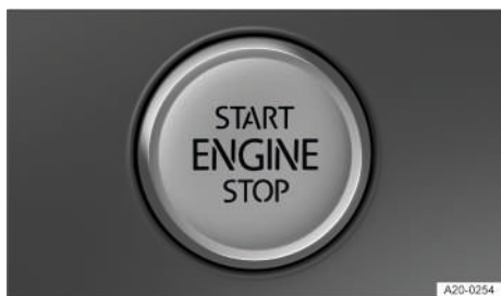
Fig. 137 En la parte inferior de la consola central: pulsador de encendido y arranque para poner el motor en marcha.
