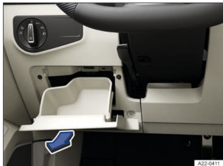
Fig. 233 Junto al volante, en el lado izquierdo: tapa de la caja de fusibles del tablero de instrumentos (vehículos con el volante a la izquierda).
