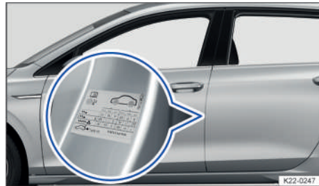
Fig. 258 En el pilar de la puerta del conductor: adhesivo de la presión de los neumáticos (o en la cara interior de la tapa del depósito de combustible).
