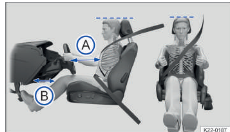
Fig. 34 Representación esquemática: distancia correcta entre el conductor y el volante, colocación correcta de la banda del cinturón y ajuste correcto del apoyacabezas.
