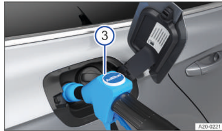
Fig. 224 Detrás de la tapa del depósito de combustible: repostar AdBlue con la pistola de un surtidor (representación esquemática).
