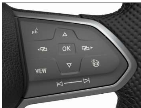
Fig. 12 Lado derecho del volante multifunción: manejo del cuadro de instrumentos digital Pro (variante 2).
