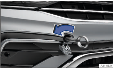
Fig. 241 En el lado derecho del paragolpes delantero: enrosca la argolla de remolque.
