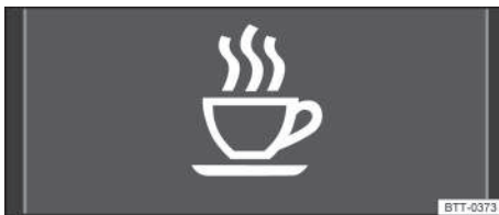
Fig. 30 En la pantalla del cuadro de instrumentos: símbolo de detección del cansancio.
