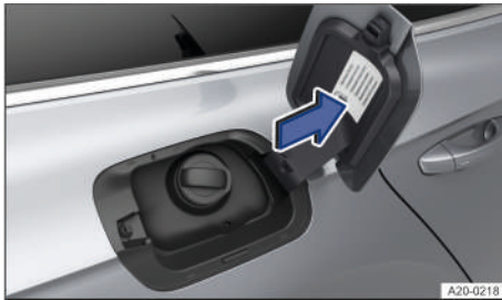
Fig. 215 En la cara interior de la tapa del depósito de combustible: adhesivo del combustible (representación esquemática).
