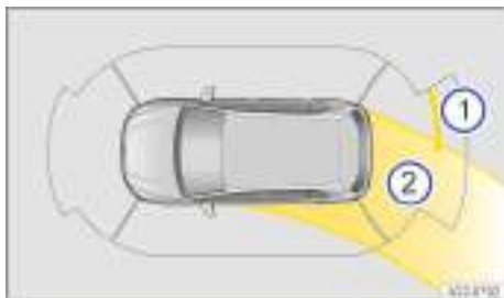
Fig. 176 Sistema de infotainment: visualización de la ayuda de aparcamiento (representación esquemática).
