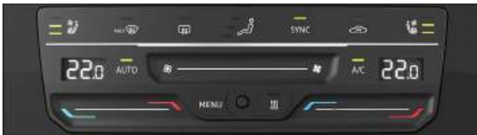
Fig. 130 En la parte superior de la consola central: panel de mandos del Climatronic (variante 1).
