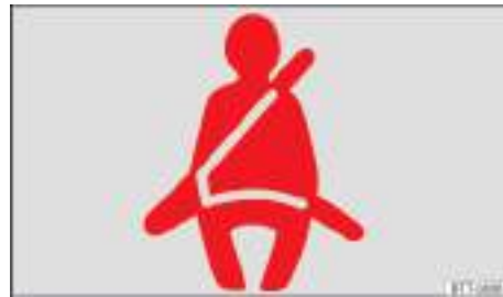
Fig. 35 En la pantalla del cuadro de instrumentos: testigo de advertencia del recordatorio de abrocharse el cinturón de seguridad.
