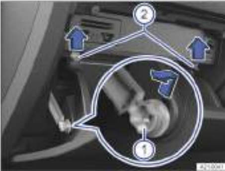
Fig. 240 En el lado del acompañante: tapa de la caja de fusibles del tablero de instrumentos (vehículos con el volante a la derecha).
