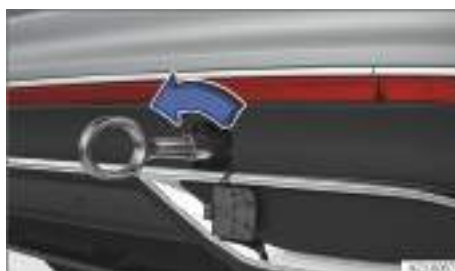
Fig. 250 En el lado derecho del paragolpes trasero: enroscar la argolla de remolque, variante 1.
