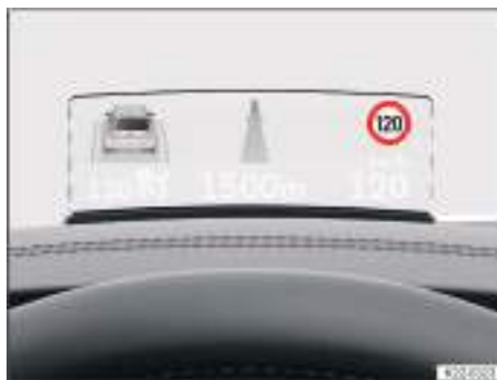
Fig. 28 En el tablero de instrumentos, encima del volante: Head-up-Display (representación esquemática).
