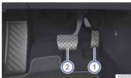
Fig. 137 En la zona reposapiés: pedales en los vehículos con cambio automático.
