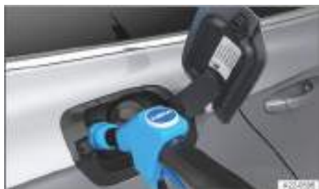
Fig. 230 Detrás de la tapa del depósito de combustible: repostar AdBlue con la pistola de un surtidor (representación esquemática).
