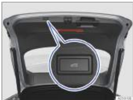
Fig. 79 En el portón trasero abierto: tecla para el cierre eléctrico del portón.
