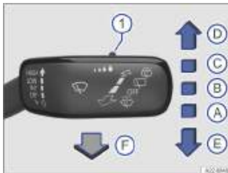
Fig. 121 En el lado derecho de la columna de dirección: manejo del limpiaparabrisas.
