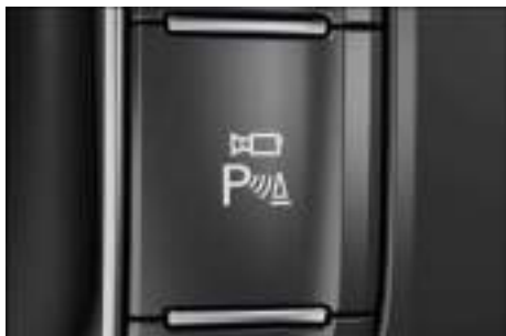
Fig. 181 En la consola central: tecla para conectar y desconectar el sistema de visión periférica.
