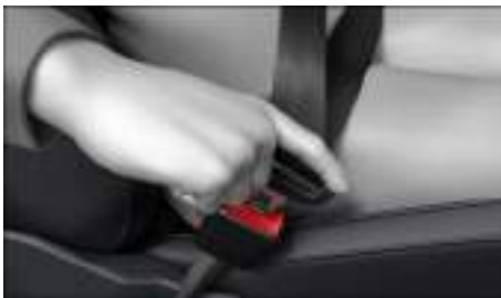
Fig. 36 Insertar la lengüeta del cinturón de seguridad en su cierre (representación esquemática).
