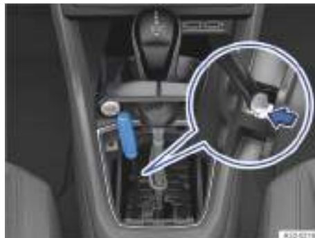
Fig. 146 En la consola central: realizar un desbloqueo de emergencia de la palanca selectora (variante 1).
