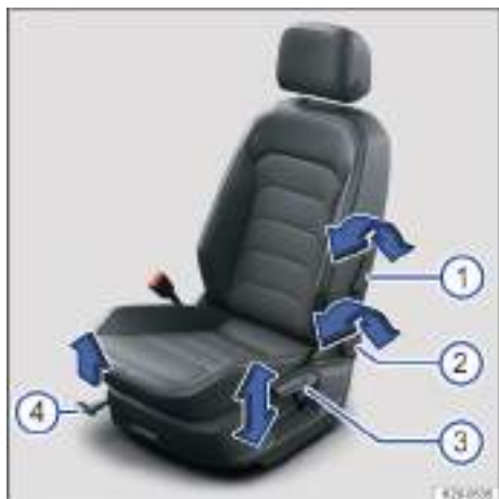
Fig. 87 En el asiento del conductor: mandos (variante 1).
