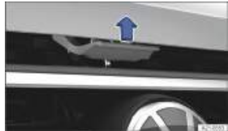
Fig. 252 En la zona reposapiés del lado del conductor: palanca de desbloqueo del capó delantero (representación esquemática).
