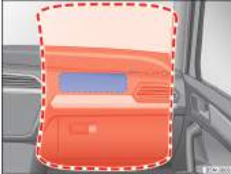
Fig. 42 En el lado del acompañante: ubicación y zona de despliegue del airbag frontal del acompañante.
