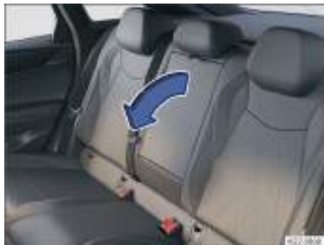
Fig. 192 En el respaldo de la plaza central del asiento: reposabrazos central trasero abatible (representación esquemática).
