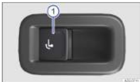
Fig. 217 En el lado derecho del maletero: tecla para desbloquear el enganche para remolque.
