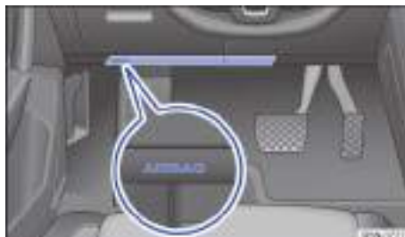
Fig. 50 En el lado del conductor: ubicación del airbag para las rodillas (en función del equipamiento).
