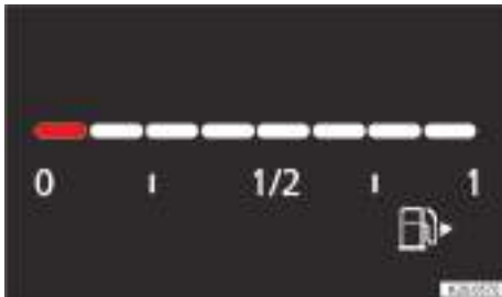
Fig. 23 En el cuadro de instrumentos digital Basic: indicador del nivel de combustible (representación esquemática).
