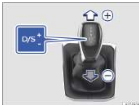
Fig. 144 En la consola central: palanca selectora en la posición Tiptronic.
