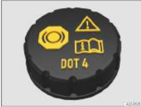
Fig. 261 En el vano motor: tapa del depósito del líquido de frenos.
