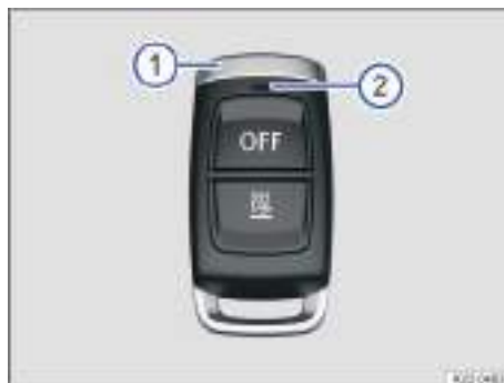
Fig. 133 Mando a distancia por radiofrecuencia de la calefacción independiente
