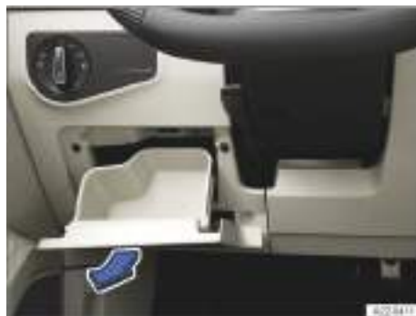
Fig. 239 Junto al volante, en el lado izquierdo: tapa de la caja de fusibles del tablero de instrumentos (vehículos con el volante a la izquierda).
