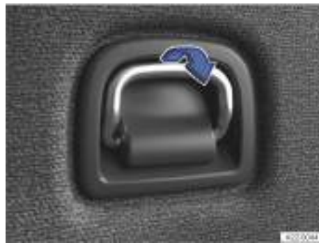
Fig. 211 En el maletero: argolla de amarre desplegable (representación esquemática).
