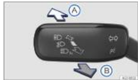
Fig. 116 En el lado izquierdo de la columna de dirección: palanca de los intermitentes y de la luz de carretera.
