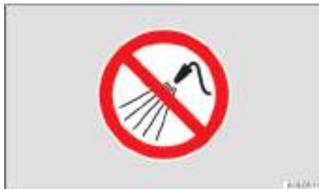
Fig. 286 Letrero de advertencia: no utilizar equipos de limpieza de alta presión en la zona indicada.
