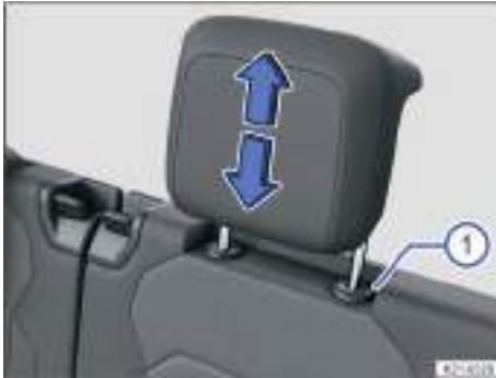
Fig. 104 Desmontaje de los apoyacabezas de la segunda fila (representación esquemática).
