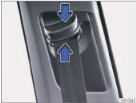
Fig. 40 Junto a los asientos delanteros: regulador de la altura del cinturón.
