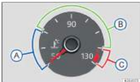
Fig. 27 En el cuadro de instrumentos analógico: indicador de temperatura del líquido refrigerante del motor (representación esquemática).
