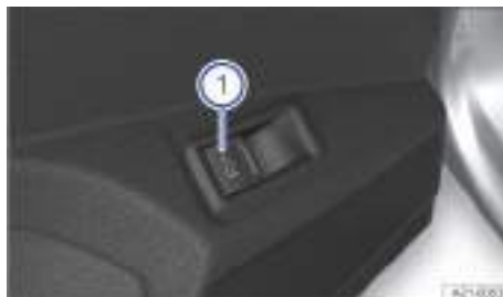
Fig. 71 En la puerta del conductor: tecla para la apertura eléctrica del portón trasero (representación esquemática).
