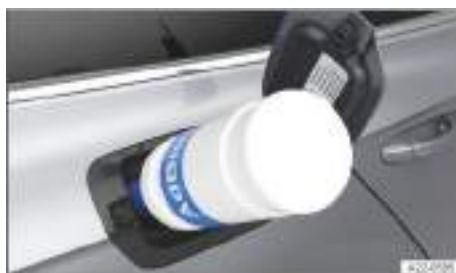
Fig. 229 Detrás de la tapa del depósito de combustible: repostar AdBlue con una botella de recarga (representación esquemática).
