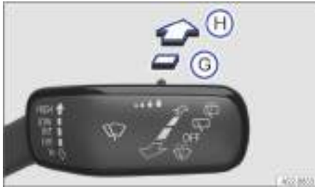
Fig. 122 En el lado derecho de la columna de dirección: manejo del limpiaventa.
