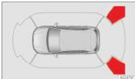
Fig. 190 Sistema de infotainment: visualización del asistente de salida del aparcamiento (representación esquemática).
