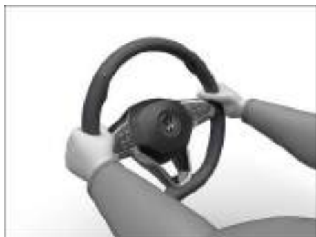
Fig. 86 En el volante: posición equivalente a las 9 y las 3 horas (representación esquemática).
