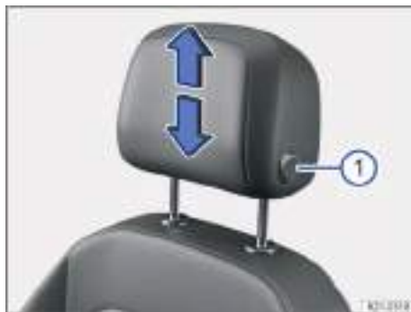
Fig. 99 Desmontaje de los apoyacabezas delanteros (representación esquemática).
