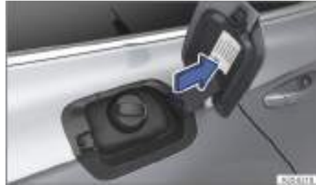
Fig. 221 En la cara interior de la tapa del depósito de combustible: adhesivo del combustible (representación esquemática).
