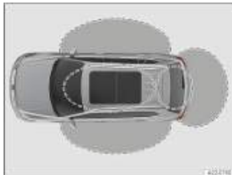
Fig. 68 Sistema "Keyless Access": zonas de proximidad.
