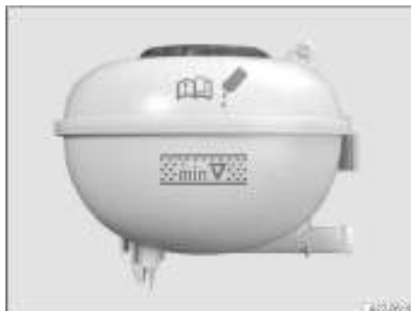
Fig. 260 En el vano motor: marcas en el depósito de expansión del líquido refrigerante del motor (representación esquemática).
