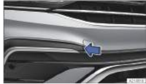
Fig. 246 En el lado derecho del paragolpes delantero: retirar la tapa.
