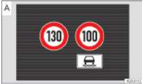
Fig. 31 En la pantalla del cuadro de instrumentos: indicaciones del sistema de detección de señales de tráfico (representación esquemática).
