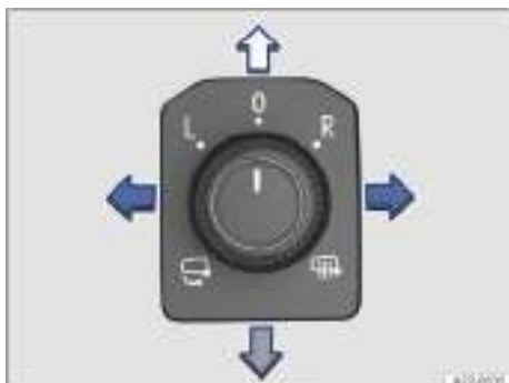
Fig. 126 En la puerta del conductor: mando giratorio de los retrovisores exteriores.
