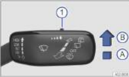
Fig. 123 En el lado derecho de la columna de dirección: palanca del limpiacristales.
