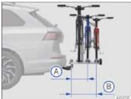
Fig. 220 Representación esquemática del voladizo máximo de la carga en un portabicicletas para dos o tres bicicletas.
