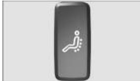
Fig. 112 En el lateral del asiento del conductor: tecla para la función de masaje.
