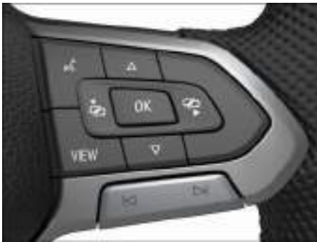
Fig. 19 Lado derecho del volante multifunción: manejo del cuadro de instrumentos analógico (variante 1).
