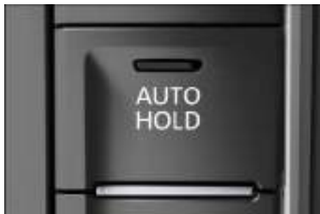
Fig. 175 En la consola central: tecla de la función Auto Hold.
