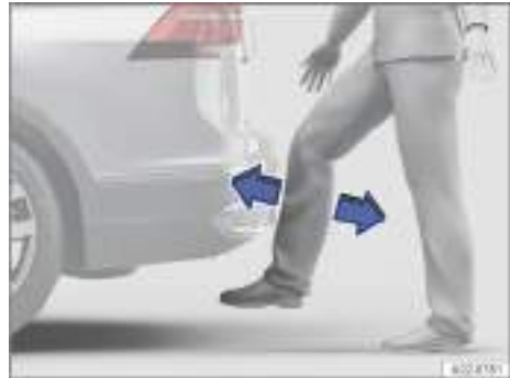
Fig. 81 Representación esquemática del portón trasero con cierre controlado por sensor (Easy Close).
