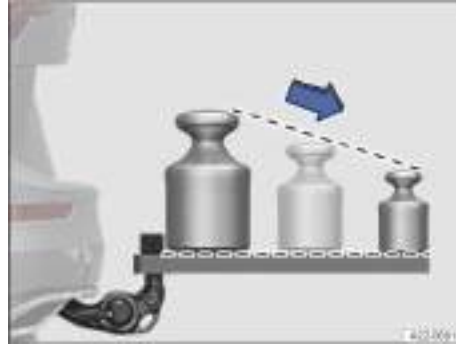
Fig. 219 Reparto recomendado del peso en el sistema portante trasero.
