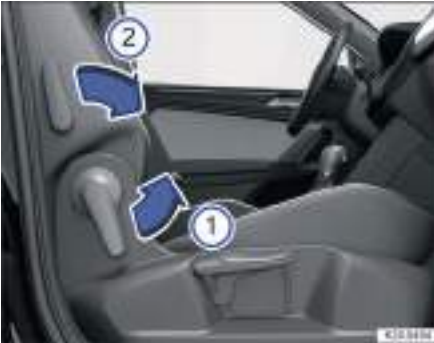
Fig. 92 Asiento del acompañante: abatir el respaldo hacia delante.
