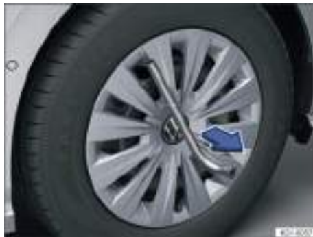
Fig. 273 Desmontar el tapacubos integral.
