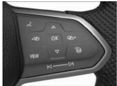
Fig. 16 Lado derecho del volante multifunción: manejo del cuadro de instrumentos digital Basic (variante 2).
