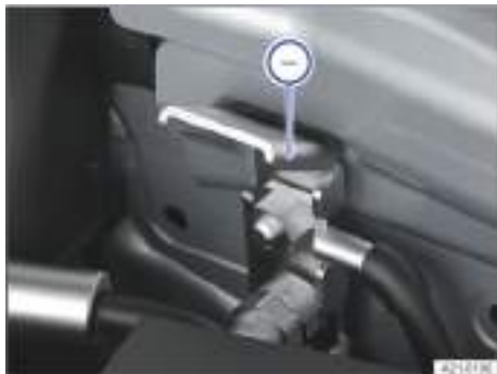
Fig. 244 En el vano motor: toma para la ayuda de arranque, masa.
