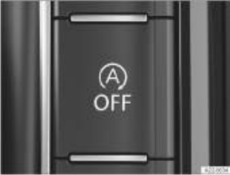
Fig. 141 En la parte inferior de la consola central o, en función del equipamiento, en el sistema de infotainment: tecla del sistema Start-Stop.
