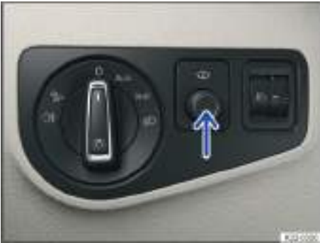
Fig. 29 Junto al volante: regulador del Head-up-Display (flecha).
