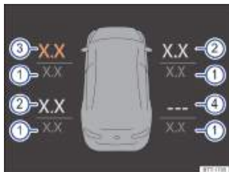
Fig. 269 Visualización en la pantalla del cuadro de instrumentos o del sistema de infotainment: presiones actuales de los neumáticos (representación esquemática).
