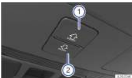
Fig. 128 En el revestimiento interior del techo: teclas para manejar la cortinilla parasol.
