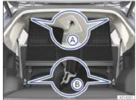
Fig. 209 En el maletero: montaje de la red de separación detrás del asiento trasero.
