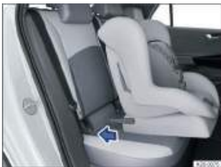
Fig. 55 Montaje de un asiento para niños con conectores (representación esquemática).
