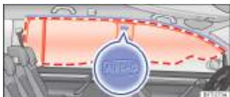
Fig. 48 A ambos lados de los vehículos de 5 plazas: ubicación y zona de despliegue del airbag para la cabeza.
