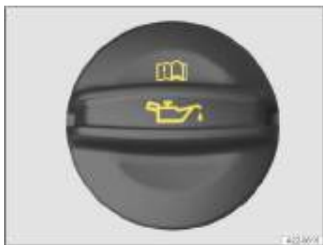
Fig. 257 En el vano motor: tapa de la boca de llenado de aceite del motor (representación esquemática).
