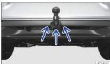
Fig. 216 En el dispositivo de remolque: argolla para fijar el cable de seguridad o el de ruptura (representación esquemática).
