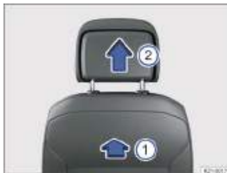
Fig. 103 Desmontaje de los apoyacabezas delanteros (representación esquemática).
