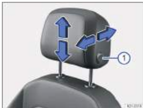
Fig. 102 Ajuste de los apoyacabezas delanteros con posibilidad de ajuste longitudinal (representación esquemática).
