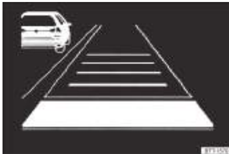
Fig. 164 En la pantalla del cuadro de instrumentos: vehículo detectado que circula más lentamente que el propio por el carril izquierdo (representación esquemática).
