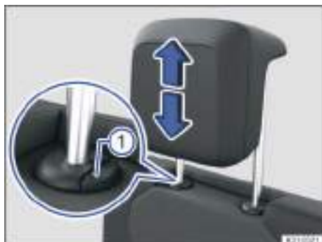
Fig. 101 Ajuste de los apoyacabezas de la tercera fila de asientos (representación esquemática).
