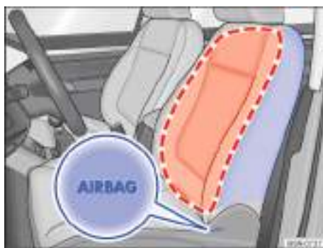
Fig. 46 En el lateral de ambos asientos delanteros: ubicación y zona de despliegue del airbag lateral.
