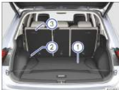
Fig. 212 En el maletero: red para equipajes enganchada a ras del piso.
