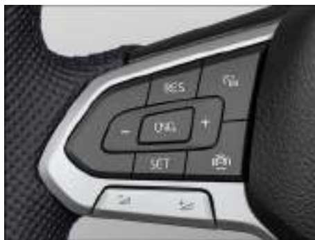
Fig. 162 Lado izquierdo del volante multifunción (variante 1).
