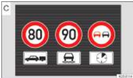
Fig. 33 En la pantalla del cuadro de instrumentos: indicaciones del sistema de detección de señales de tráfico (representación esquemática).
