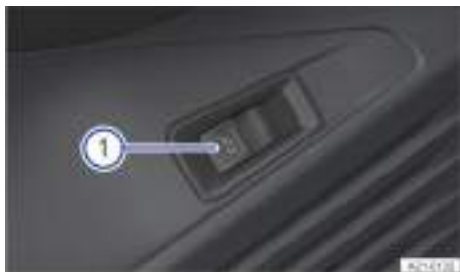
Fig. 78 En la puerta del conductor: tecla del portón trasero.
