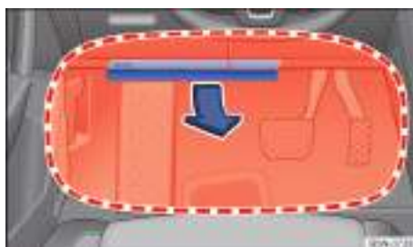
Fig. 51 En el lado del conductor: zona de despliegue del airbag para las rodillas (en función del equipamiento).
