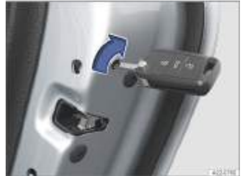
Fig. 73 En el frontal de la puerta trasera derecha: bloqueo de emergencia del vehículo con la llave de este (representación esquemática).
