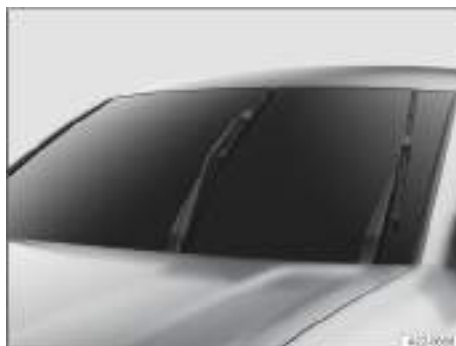
Fig. 233 Limpiacristales en posición de servicio (representación esquemática).
