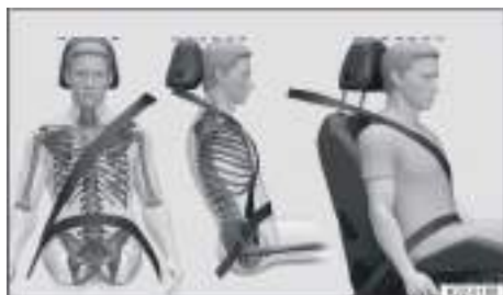
Fig. 38 Colocación correcta de la banda del cinturón y ajuste correcto del apoyacabezas (representación esquemática).
