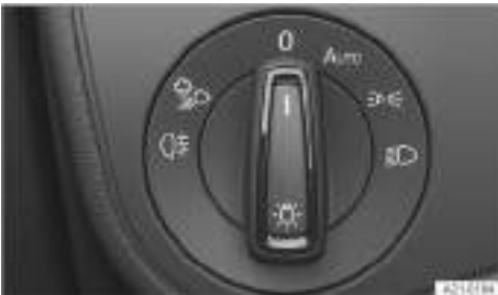
Fig. 114 Junto al volante: mando de las luces (una variante).
