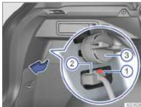
Fig. 236 Lateral del maletero: desmontar el grupo óptico trasero.
