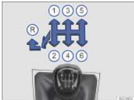
Fig. 142 Esquema de las marchas de un cambio manual de 6 marchas.
