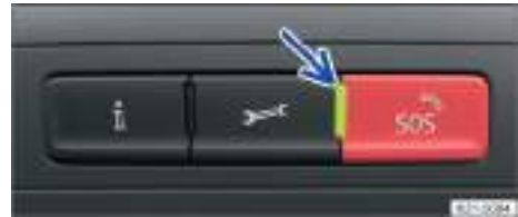
Fig. 59 En la consola del techo: mando para los servicios de voz y testigo de control.
