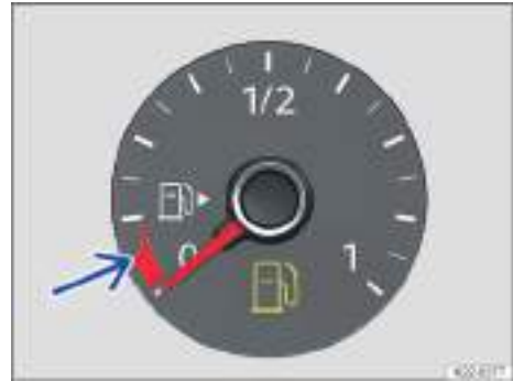
Fig. 24 En el cuadro de instrumentos analógico: indicador del nivel de combustible (representación esquemática).
