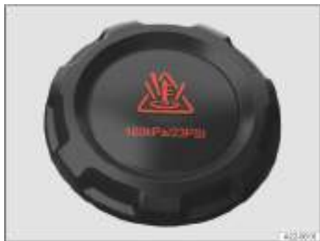
Fig. 259 En el vano motor: tapa del depósito de expansión del líquido refrigerante del motor (representación esquemática).
