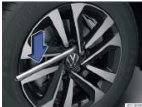
Fig. 275 Aflojar los tornillos de rueda.
