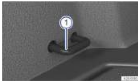
Fig. 210 En el maletero: argollas de amarre (representación esquemática).
