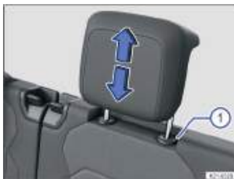
Fig. 100 Ajuste de los apoyacabezas de la segunda fila de asientos (representación esquemática).
