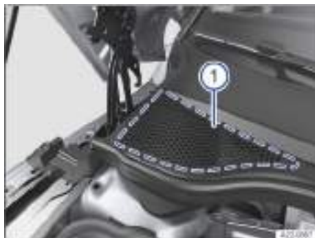
Fig. 287 Entre el vano motor y el parabrisas: caja de aguas (representación esquemática).
