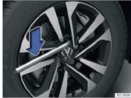
Fig. 279 Desenrosca los tornillos de rueda con la llave de rueda.
