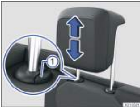
Fig. 105 Desmontaje de los apoyacabezas de la tercera fila (representación esquemática).
