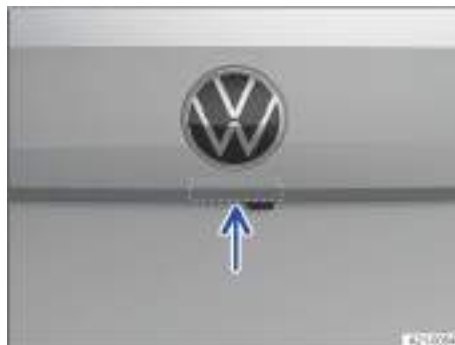
Fig. 76 En el portón trasero: pulsador para abrir el portón (representación esquemática).
