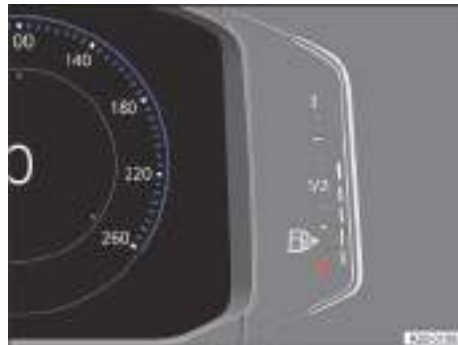
Fig. 22 En el cuadro de instrumentos digital Pro: indicador del nivel de combustible (representación esquemática).
