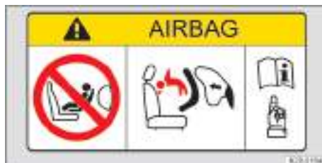
Fig. 53 En el parasol: etiqueta adhesiva relativa al airbag (representación esquemática).
