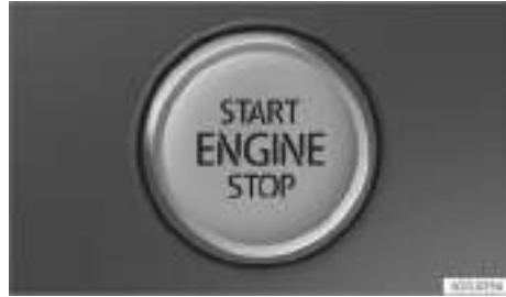
Fig. 139 En la parte inferior de la consola central: pulsador de encendido y arranque.
