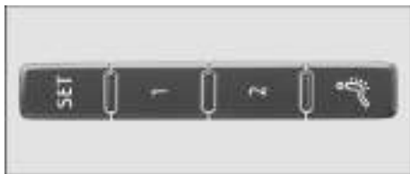
Fig. 111 En el lateral exterior del asiento del conductor: teclas de memoria.
