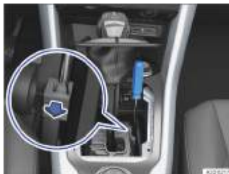
Fig. 147 En la consola central: realizar un desbloqueo de emergencia de la palanca selectora (variante 2).
