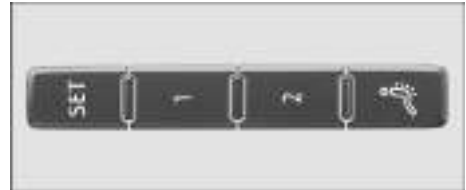
Fig. 110 En el lateral exterior del asiento del conductor: teclas de memoria.
