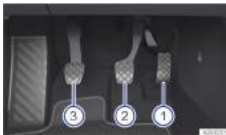
Fig. 136 En la zona reposapiés: pedales en los vehículos con cambio manual.
