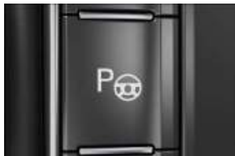
Fig. 183 En la consola central: tecla del Park Assist (en función del equipamiento).
