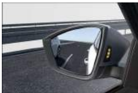
Fig. 173 En las carcasas de los retrovisores exteriores: indicaciones del Side Assist.
