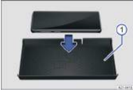
Fig. 197 En la consola central: portaobjetos de la función de carga inalámbrica (representación esquemática).
