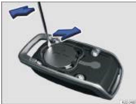
Fig. 135 Sustituir la pila de botón del mando a distancia por radiofrecuencia.
