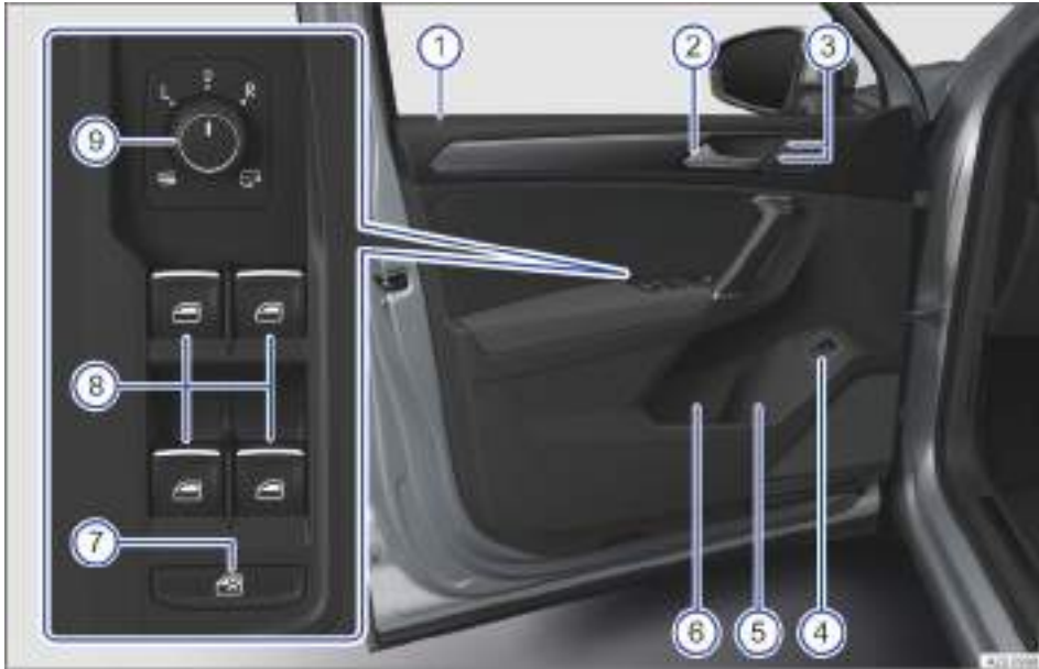
Fig. 3 Puerta del conductor (vehículos con el volante a la izquierda): mandos (la disposición es simétrica en los vehículos con el volante a la derecha).
