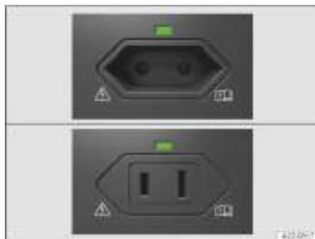
Fig. 196 En el lado izquierdo del maletero: toma de corriente de 230, 115 o 100 voltios (en función del equipamiento).
