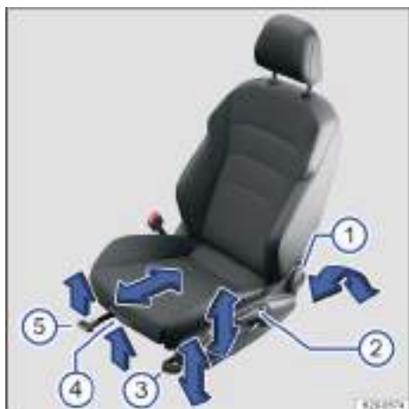
Fig. 88 En el asiento del conductor: mandos (variante 2).
