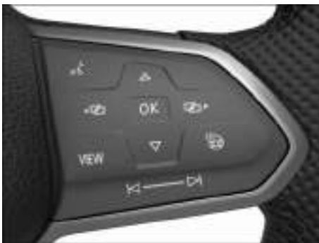
Fig. 20 Lado derecho del volante multifunción: manejo del cuadro de instrumentos analógico (variante 2).
