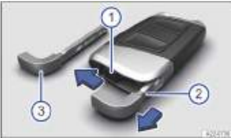
Fig. 62 Llave del vehículo: desbloqueo de la llave de emergencia (representación esquemática).
