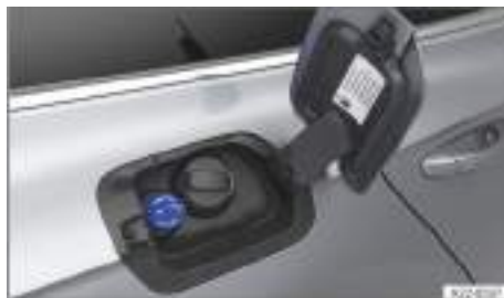
Fig. 228 Detrás de la tapa del depósito de combustible: tapón del depósito de AdBlue (representación esquemática).
