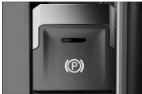
Fig. 174 En la consola central: tecla del freno de estacionamiento electrónico.
