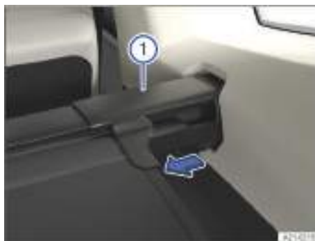
Fig. 203 En el maletero: desmontar la cubierta del maletero.
