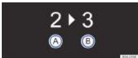
Fig. 155 En la pantalla del cuadro de instrumentos: recomendación de marcha.
