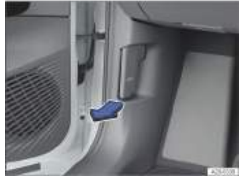
Fig. 252 En la zona reposapiés del lado del conductor: palanca de desbloqueo del capó delantero (representación esquemática).
