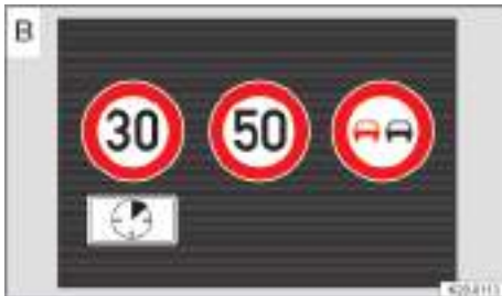
Fig. 32 En la pantalla del cuadro de instrumentos: indicaciones del sistema de detección de señales de tráfico (representación esquemática).
