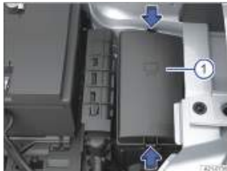
Fig. 237 En el vano motor: caja de fusibles.
