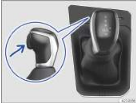
Fig. 143 En la consola central: palanca selectora del cambio automático (representación esquemática).
