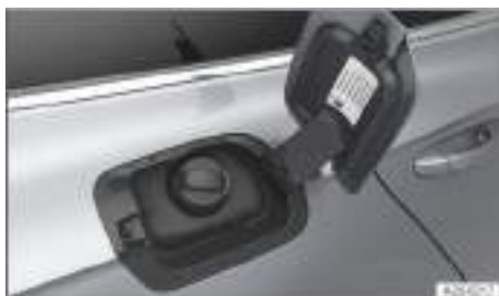
Fig. 227 Detrás de la tapa del depósito de combustible: tapón del depósito (representación esquemática).
