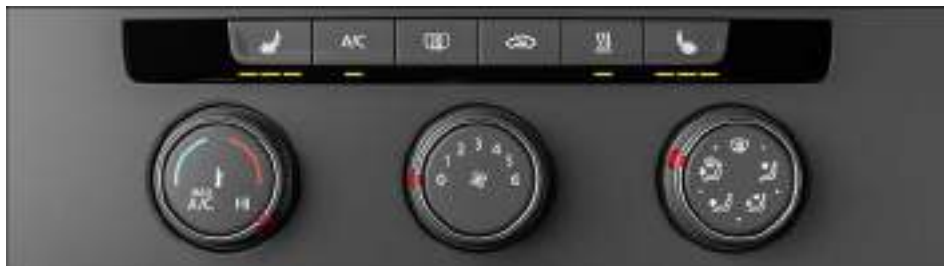
Fig. 132 En la parte superior de la consola central: panel de mandos del climatizador manual.
