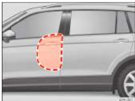
Fig. 47 En el habitáculo, a ambos lados del vehículo: zona de despliegue del airbag lateral delantero.
