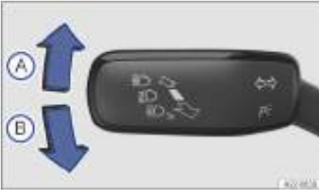
Fig. 118 En el lado izquierdo de la columna de dirección: palanca de los intermitentes y de la luz de carretera.
