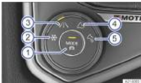
Fig. 149 En la consola central: mando giratorio del 4MOTION Active Control.
