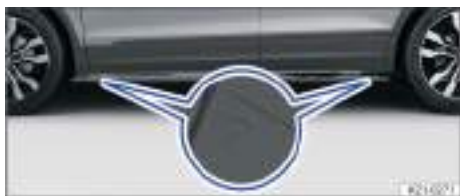
Fig. 276 En el larguero inferior: marcas para los puntos de alojamiento del gato.
