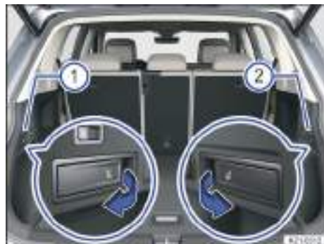
Fig. 96 En el maletero: palancas de desbloqueo a distancia de la parte izquierda ① y la parte derecha ② del respaldo del asiento trasero.
