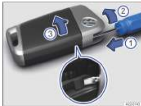
Fig. 64 Llave del vehículo: abrir la tapa del compartimento de la pila.
