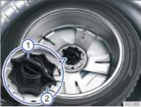
Fig. 272 Debajo del piso del maletero: ruedecilla para fijar la rueda de repuesto.
