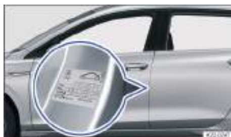
Fig. 264 En el pilar de la puerta del conductor: adhesivo de la presión de los neumáticos (o en la cara interior de la tapa del depósito de combustible).
