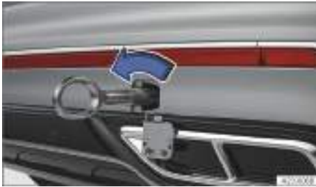
Fig. 251 En el lado derecho del paragolpes trasero: enroscar la argolla de remolque, variante 2.
