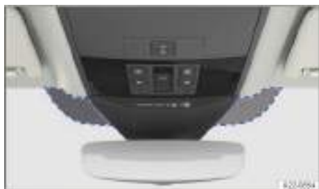
Fig. 129 Junto a la base del retrovisor: ventana de comunicación (representación esquemática).
