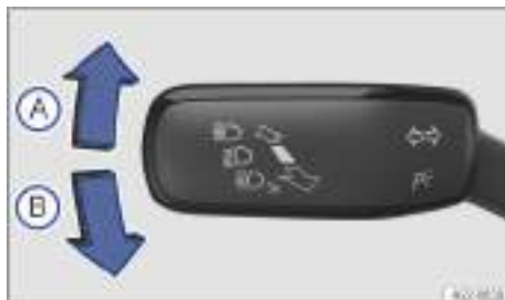
Fig. 113 En el lado izquierdo de la columna de dirección: palanca de los intermitentes y de la luz de carretera.
