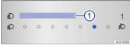
Fig. 120 En el sistema de infotainment: regulador táctil para la regulación del alcance de las luces.
