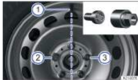
Fig. 280 Posición correcta del tornillo de rueda anti-robbo.
