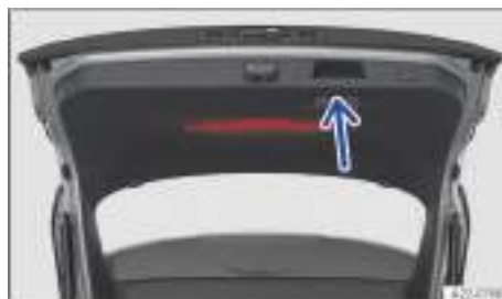
Fig. 77 En el portón trasero abierto: asidero para cerrar el portón (representación esquemática).
