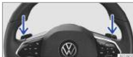
Fig. 145 Detrás del volante: levas de cambio para el Tiptronic.
