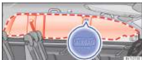
Fig. 49 A ambos lados de los vehículos de 7 plazas: ubicación y zona de despliegue del airbag para la cabeza.
