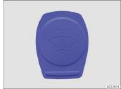
Fig. 254 En el vano motor: tapa del depósito del líquido lavacristales (representación esquemática).
