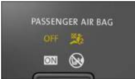
Fig. 45 En la consola central: testigo de control de la desactivación del airbag frontal del acompañante (en función del país).
