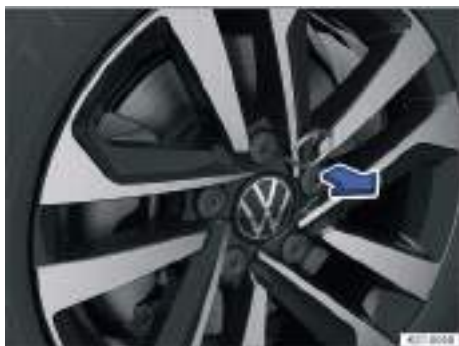
Fig. 274 Retirar las caperuzas de los tornillos de rueda.
