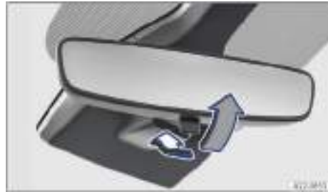
Fig. 125 En el parabrisas: retrovisor interior antideslumbrante manual.
