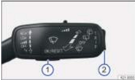
Fig. 13 En el lado derecho de la columna de dirección: teclas de la palanca del limpiacristales.
