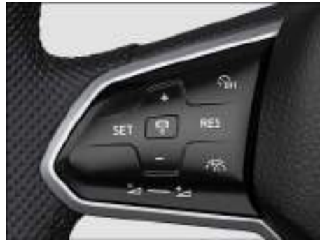
Fig. 161 Lado izquierdo del volante multifunción (variante 2).
