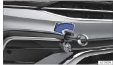
Fig. 247 En el lado derecho del paragolpes delantero: enroskar la argolla de remolque.
