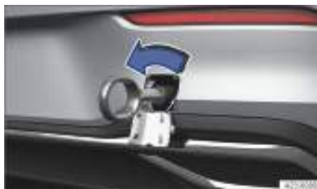
Fig. 249 En el lado derecho del paragolpes trasero: retirar la tapa, variante 2.
