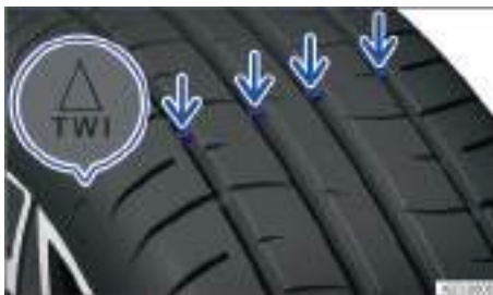
Fig. 268 En las acanaladuras del perfil: indicadores de desgaste.
