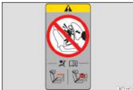
Fig. 54 En el pilar B: etiqueta adhesiva relativa al airbag (representación esquemática).
