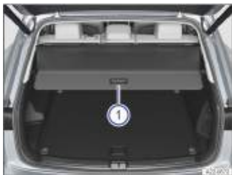
Fig. 202 En el maletero: abrir la cubierta del maletero (representación esquemática).
