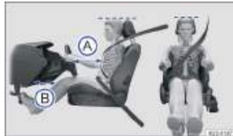
Fig. 34 Distancia correcta entre el conductor y el volante, colocación correcta de la banda del cinturón y ajuste correcto del apoyacabezas (representación esquemática).
