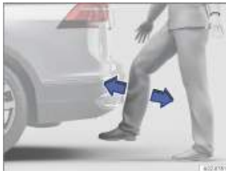
Fig. 80 Representación esquemática del portón trasero con apertura controlada por sensor (Easy Open).
