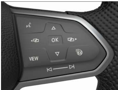
Fig. 14 Lado derecho del volante multifunción: manejo del cuadro de instrumentos digital Basic (variante 2).
