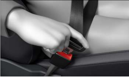
Fig. 26 Insertar la lengüeta del cinturón de seguridad en su cierre (representación esquemática).
