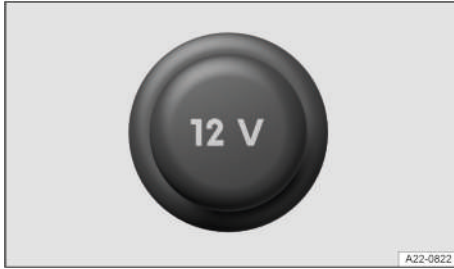
Fig. 136 En la parte delantera de la consola central: toma de corriente de 12 voltios con tapa extraíble (representación esquemática).
