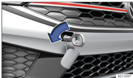
Fig. 165 En el lado derecho del paragolpes delantero: enroscar la argolla de remolque, variante 2.
