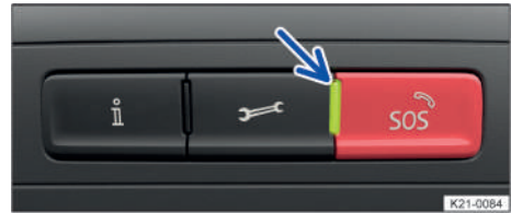
Fig. 47 En la consola del techo: mando para los servicios de voz y testigo de control.
