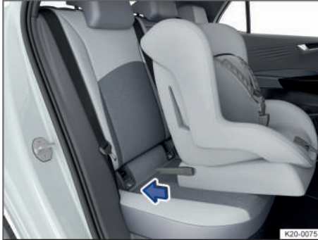
Fig. 42 Montaje de un asiento para niños con conectores (representación esquemática).
