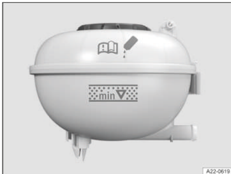
Fig. 180 En el vano motor: marcas en el depósito de expansión del líquido refrigerante del motor (representación esquemática).
