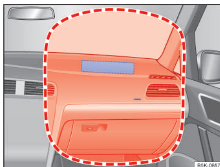
Fig. 32 En el lado del acompañante: ubicación y zona de despliegue del airbag frontal del acompañante.
