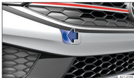
Fig. 163 En el lado derecho del paragolpes delantero: retirar la tapa, variante 2.
