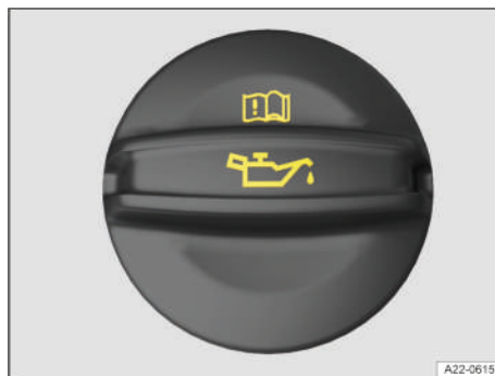
Fig. 177 En el vano motor: tapa de la boca de llenado de aceite del motor (representación esquemática).
