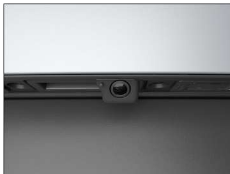
Fig. 206 En la parte trasera del vehículo: cámara de marcha atrás en la manilla con pulsador (representación esquemática).
