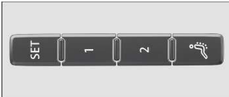
Fig. 80 En el lateral exterior del asiento del conductor: teclas de memoria.
