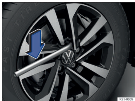
Fig. 194 Aflojar los tornillos de rueda.
