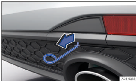
Fig. 168 En el lado derecho del paragolpes trasero: retirar la tapa.
