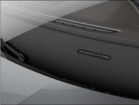
Fig. 244 En el parabrisas: número de identificación del vehículo.
