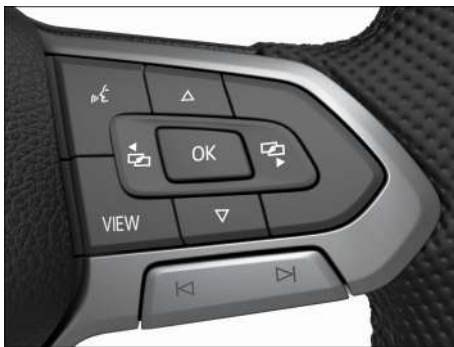
Fig. 13 Lado derecho del volante multifunción: manejo del cuadro de instrumentos digital Basic (variante 1).
