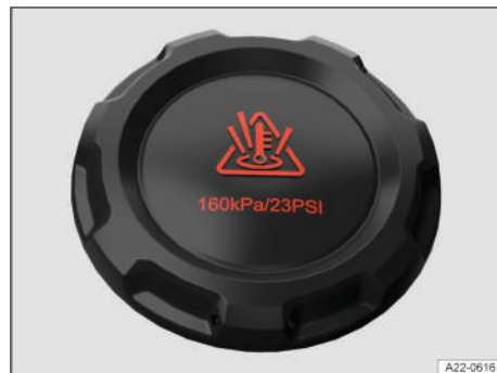
Fig. 179 En el vano motor: tapa del depósito de expansión del líquido refrigerante del motor (representación esquemática).
