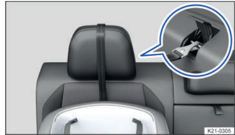
Fig. 44 En el respaldo del asiento trasero: colocación de la banda del cinturón de fijación superior (Top Tether) simple si los apoyacabezas no se pueden ajustar.
