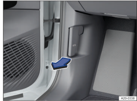
Fig. 170 En la zona reposapiés del lado del conductor: palanca de desbloqueo del capó delantero (representación esquemática).
