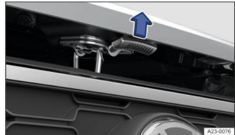
Fig. 171 Encima de la parrilla del radiador: palanca de accionamiento del capó delantero (representación esquemática).
