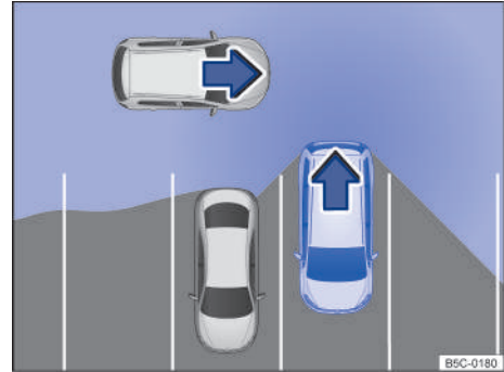
Fig. 131 Zona vigilada alrededor del vehículo que está desaparcando (representación esquemática).
