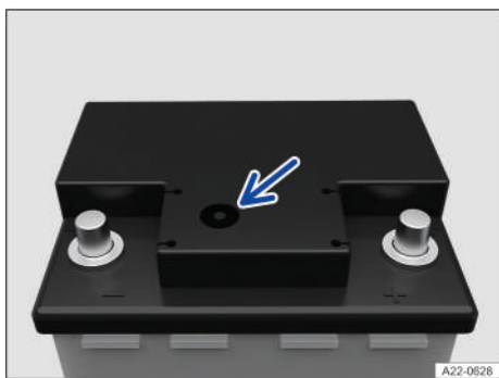
Fig. 182 En la parte superior de la batería de 12 voltios: mirilla (representación esquemática).
