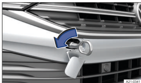
Fig. 164 En el lado derecho del paragolpes delantero: enroscar la argolla de remolque, variante 1.
