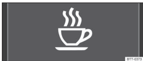
Fig. 23 En la pantalla del cuadro de instrumentos: símbolo de detección del cansancio.
