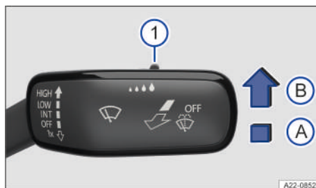
Fig. 88 En el lado derecho de la columna de dirección: palanca del limpiacristales.
