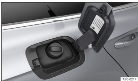
Fig. 148 Detrás de la tapa del depósito de combustible: tapón del depósito (representación esquemática).
