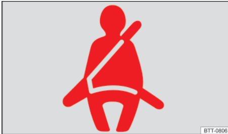
Fig. 25 En la pantalla del cuadro de instrumentos: testigo de advertencia del recordatorio de abrocharse el cinturón de seguridad.
