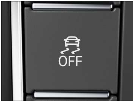
Fig. 133 En la consola central: tecla para conectar y desconectar manualmente el ASR o el ESC Sport (en función del equipamiento).
