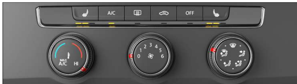
Fig. 94 En la parte superior de la consola central: panel de mandos del climatizador manual.
