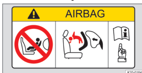
Fig. 40 En el parasol: etiqueta adhesiva relativa al airbag (representación esquemática).
