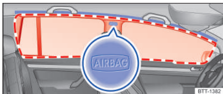
Fig. 38 A ambos lados del vehículo: ubicación y zona de despliegue del airbag para la cabeza.
