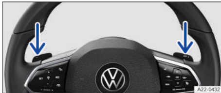
Fig. 104 Detrás del volante: levas de cambio para el Tiptronic.
