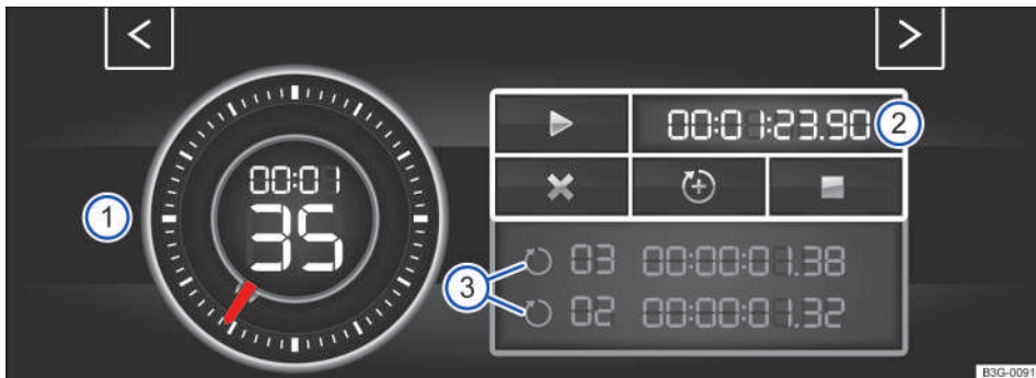
Fig. 19 En la pantalla del sistema de infotainment: cronómetro, botones de función y tiempos de las vueltas.
