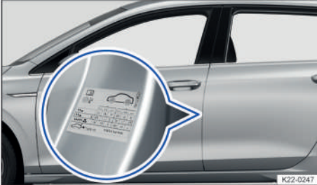
Fig. 184 En el pilar de la puerta del conductor: adhesivo de la presión de los neumáticos (o en la cara interior de la tapa del depósito de combustible).
