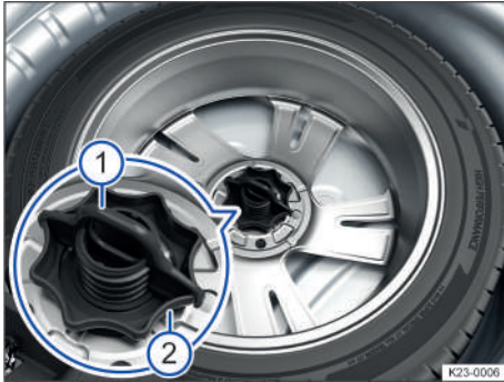
Fig. 190 Debajo del piso del maletero: ruedecilla para fijar la rueda de repuesto.
