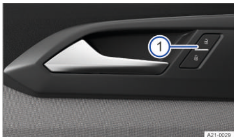
Fig. 56 En la puerta del conductor: tecla del cierre centralizado (representación esquemática).
