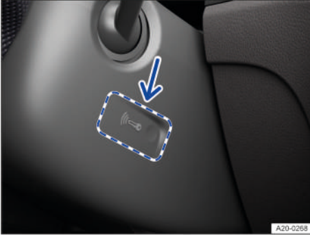
Fig. 99 En el lado derecho de la columna de dirección: función de arranque de emergencia en los vehículos con el sistema de cierre y arranque sin llave "Keyless Access".
