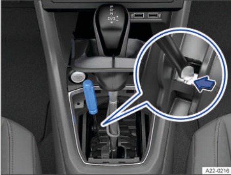
Fig. 105 En la consola central: realizar un desbloqueo de emergencia de la palanca selectora (variante 1).
