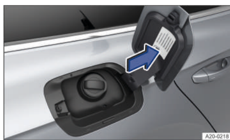
Fig. 144 En la cara interior de la tapa del depósito de combustible: adhesivo del combustible (representación esquemática).
