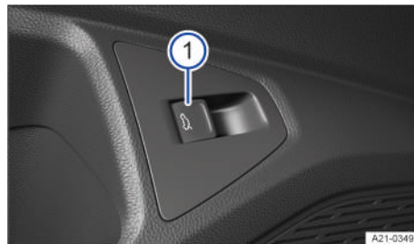
Fig. 61 En la puerta del conductor: tecla de desbloqueo del portón trasero.
