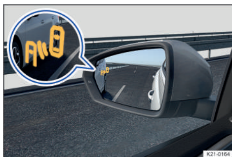
Fig. 125 En los espejos de los retrovisores exteriores: indicación del detector de ángulo muerto.
