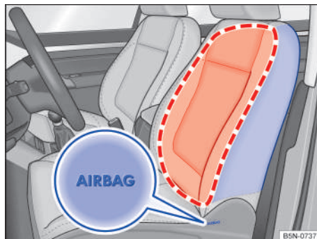
Fig. 36 En el lateral de ambos asientos delanteros: ubicación y zona de despliegue del airbag lateral.
