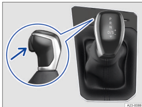
Fig. 102 En la consola central: palanca selectora del cambio automático (representación esquemática).
