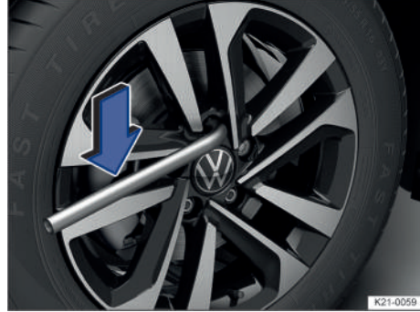
Fig. 201 Desenroscar los tornillos de rueda con la llave de rueda.
