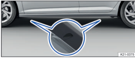
Fig. 196 En el larguero inferior: marcas para los puntos de apoyo del gato (variante 2).
