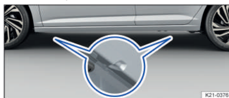
Fig. 195 En el larguero inferior: marcas para los puntos de apoyo del gato (variante 1).
