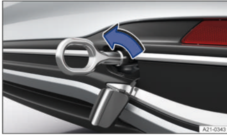
Fig. 167 En el lado derecho del paragolpes trasero: enroscar la argolla de remolque.
