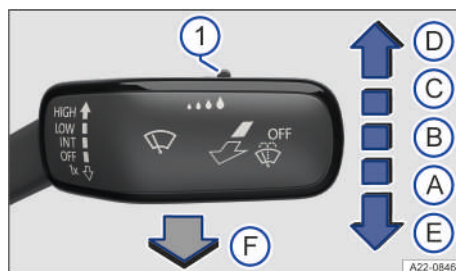
Fig. 87 En el lado derecho de la columna de dirección: manejo del limpiaparabrisas.
