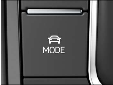
Fig. 107 En la consola central: tecla MODE para seleccionar los perfiles de conducción.
