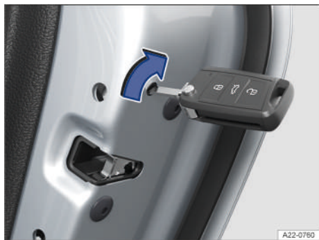
Fig. 58 En el frontal de la puerta trasera derecha: bloqueo de emergencia del vehículo con la llave de este (representación esquemática).
