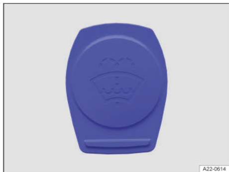
Fig. 174 En el vano motor: tapa del depósito del líquido lavacrystales (representación esquemática).
