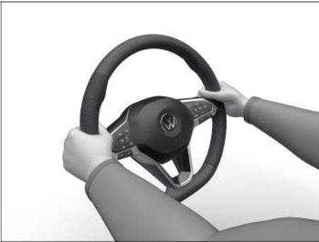
Fig. 66 En el volante: posición equivalente a las 9 y las 3 horas (representación esquemática).
