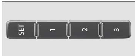
Fig. 79 En el lateral exterior del asiento del conductor: teclas de memoria.
