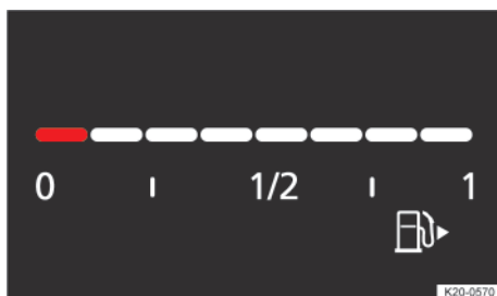
Fig. 16 En el cuadro de instrumentos digital Basic: indicador del nivel de combustible (representación esquemática).
