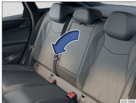
Fig. 134 En el respaldo de la plaza central del asiento: reposabrazos central trasero abatible (representación esquemática).
