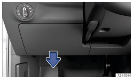
Fig. 156 En el lado izquierdo, junto al volante: tapa de la caja de fusibles del tablero de instrumentos.
