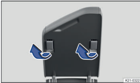
Fig. 77 Parte inferior del reposabrazos central delantero: apoyo de plástico del reposabrazos.
