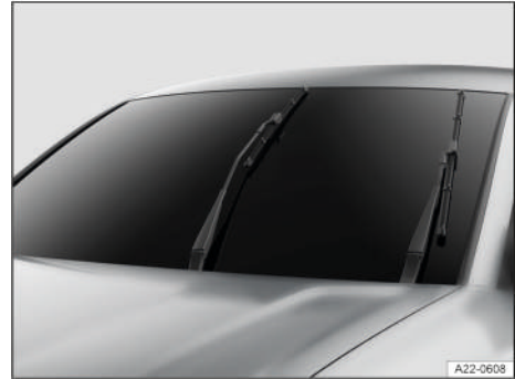
Fig. 151 Limpiacristales en posición de servicio (representación esquemática).
