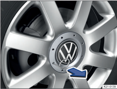
Fig. 191 Desmontar el tapacubos central tirando de él.
