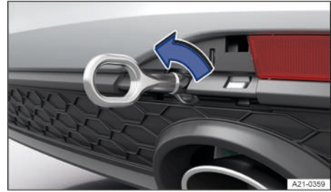
Fig. 169 En el lado derecho del paragolpes trasero: enroscar la argolla de remolque.
