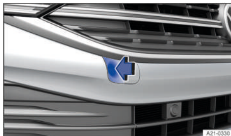
Fig. 162 En el lado derecho del paragolpes delantero: retirar la tapa, variante 1.
