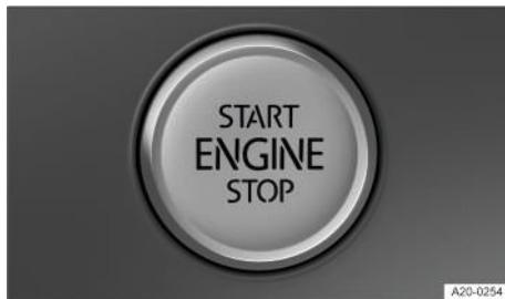
Fig. 98 En la parte inferior de la consola central: pulsador de encendido y arranque.
