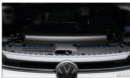
Fig. 175 En la zona marcada: ubicación del adhesivo con la norma y la viscosidad del aceite del motor (representación esquemática).
