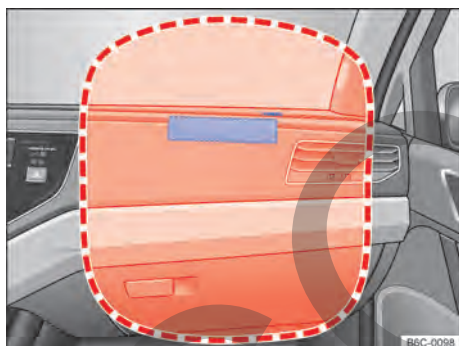
Fig. 36 Ubicación y radio de expansión del airbag frontal del acompañante.
