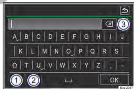
Fig. 110 Representación del principio: máscara de inserción con teclado de display.
