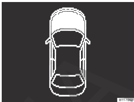
Fig. 182 En el display del instrumento combinado: tapa del compartimento del motor abierta o cerrada incorrectamente (representación esquemática).
