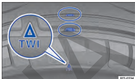
Fig. 194 Perfil del neumático: indicadores de desgaste.
