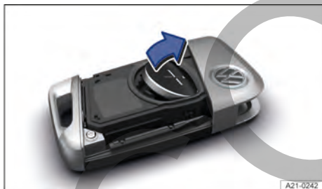
Fig. 53 Llave del vehículo: cambiar la pila de botón.
