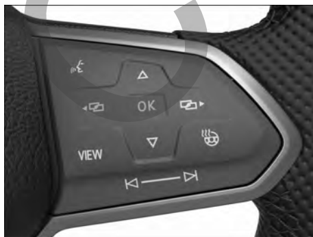
Fig. 11 Lado derecho del volante multifunción: teclas para utilizar los menús y las indicaciones informativas del cuadro de instrumentos (variante 2).
