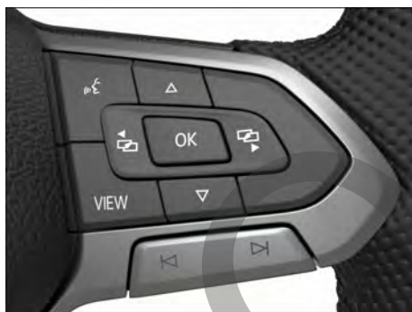
Fig. 10 Lado derecho del volante multifunción: teclas para utilizar los menús y las indicaciones informativas del cuadro de instrumentos (variante 1).
