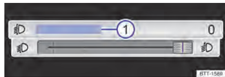
Fig. 85 En el sistema de infotainment: regulador táctil para la regulación del alcance de las luces.
