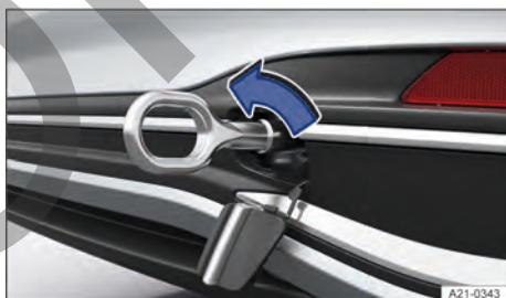
Fig. 162 En el lado derecho del paragolpes trasero: enrosca la argolla de remolque, variante 1.
