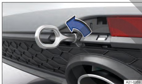
Fig. 164 En el lado derecho del paragolpes trasero: enroskar la argolla de remolque, variante 2.
