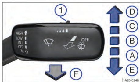
Fig. 86 En el lado derecho de la columna de dirección: manejo del limpiaparabrisas.
