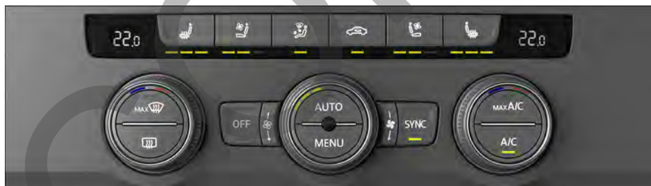
Fig. 93 En la parte superior de la consola central: panel de mandos del Climatronic.
