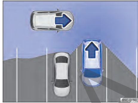
Fig. 131 Representación esquemática del asistente de salida del aparcamiento: zona vigilada alrededor del vehículo que está desapareando.
