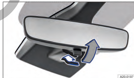
Fig. 89 En el parabrisas: retrovisor interior antideslumbrante manual.
