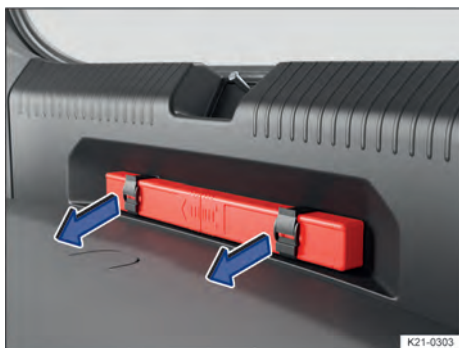
Fig. 46 Debajo del umbral de carga: soporte del triángulo de preseñalización.
