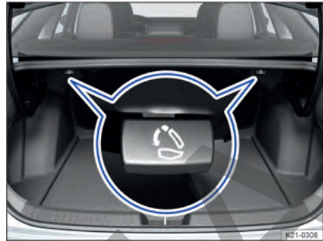
Fig. 70 En el maletero: palanca de desbloqueo desde el maletero.
