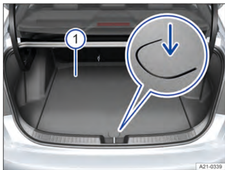
Fig. 140 En el maletero: abrir el piso del maletero.
