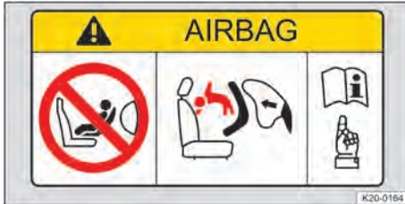
Fig. 40 Representación esquemática: etiqueta adhesiva relativa al airbag en el parasol.
