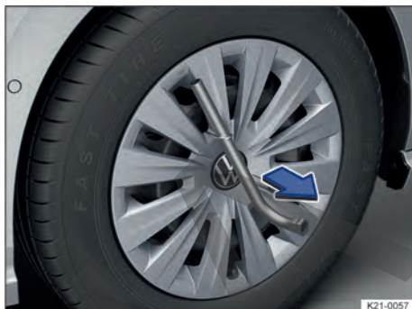
Fig. 185 Desmontar el tapacubos integral.
