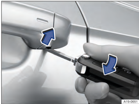
Fig. 57 Manilla de la puerta del conductor: desprender la caperuza haciendo palanca.
