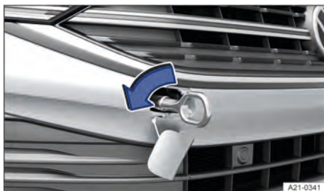
Fig. 159 En el lado derecho del paragolpes delantero: enrosca la argolla de remolque, variante 1.
