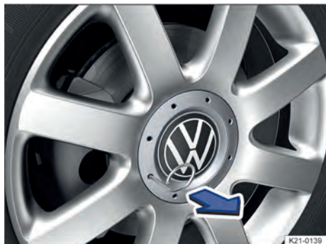
Fig. 184 Desmontar el tapacubos central tirando de él.
