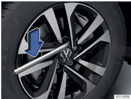
Fig. 197 Cambio de rueda: desenroscar los tornillos de rueda con la llave de rueda.
