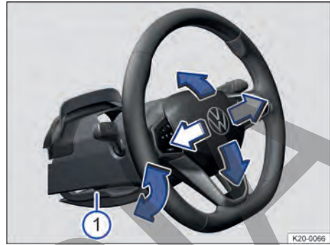
Fig. 65 Debajo del volante, en el guardac遨 de la columna de dirección: palanca para el ajuste manual de la posición del volante (representación esquemática).
