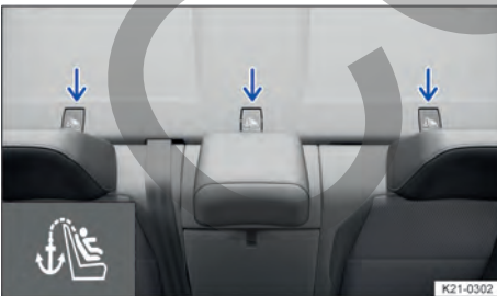
Fig. 43 En la bandeja situada detrás del asiento trasero: anclajes Top Tether para el cinturón de fijación superior (Top Tether).
