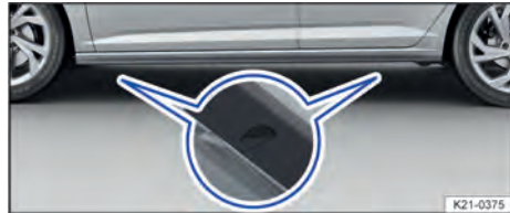
Fig. 192 Puntos de apoyo para el gato (variante 2).
