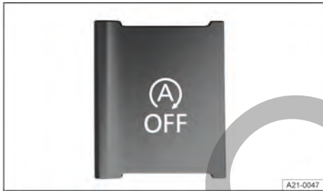
Fig. 102 En la parte inferior de la consola central: tecla del sistema Start-Stop.
