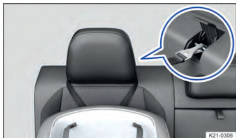
Fig. 45 En el respaldo del asiento trasero: colocación de la banda del cinturón de fijación superior (Top Tether) en forma de V si los apoyacabezas no se pueden ajustar.
