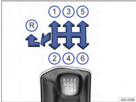
Fig. 103 Esquema de las marchas de un cambio manual de 6 marchas. En función del equipamiento, el vehículo puede estar equipado con un cambio manual de 5 marchas.
