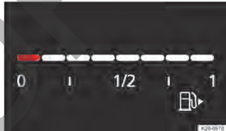
Fig. 16 Indicador del nivel de combustible en el cuadro de instrumentos digital, versión Basic (representación esquemática).
