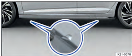
Fig. 191 Puntos de apoyo para el gato (variante 1).
