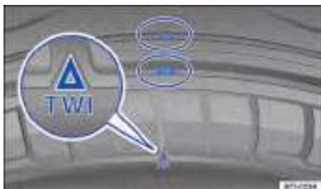
Fig. 194 Perfil del neumático: indicadores de desgaste.
