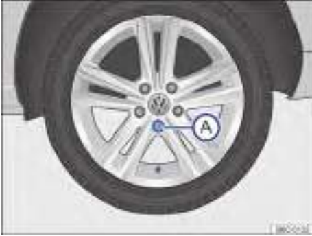
Fig. 202 Cambio de rueda: secuencia de desmontaje de los tornillos de la rueda.
