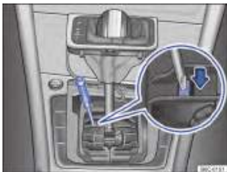
Fig. 93 Desmontar la cubierta de la palanca selectora y desbloquear el bloqueo de la palanca selectora de emergencia.
