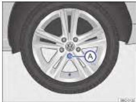
Fig. 197 Retire el tapacubos integral. ▶
