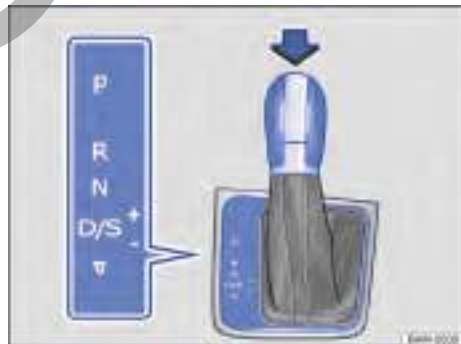
Fig. 90 Palanca selectora de la transmisión automática con tecla de bloqueo (flecha).
