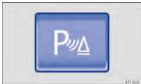
Fig. 96 En la consola central: tecla de encender y apagar la ayuda de aparcamiento.
