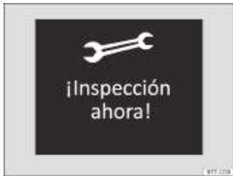
Fig. 17 En el display del instrumento combinado: ejemplo de indicación para un evento de servicio próximo a vencer (representación esquemática).
