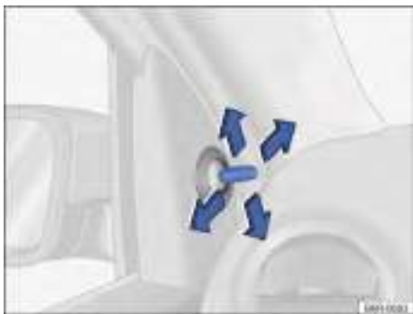
Fig. 77 En las puertas delanteras: mando de ajuste de los espejos retrovisores externos mecánicos.
