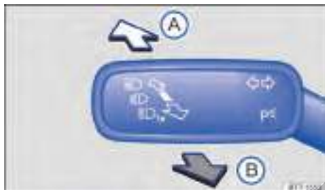
Fig. 71 A la izquierda en la columna de dirección: palanca de los indicadores de dirección y del farol alto.
