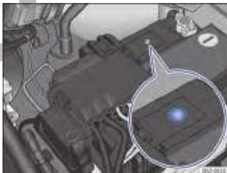
Fig. 205 En el compartimento del motor: ejemplo de posición del visor en el lado superior de la batería del vehículo.
