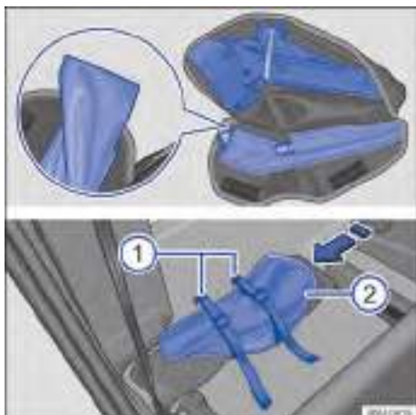
Fig. 169 Atrás del respaldo del asiento del pasajero: ② bolsas de herramientas de a bordo y ① cintas de fijación de la bolsa de las herramientas de a bordo.
