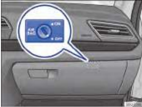
Fig. 35 En la guantera: interruptor desaccionado por la llave para apagar y encender el airbag frontal del pasajero.
