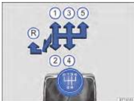
Fig. 86 Esquema de la transmisión manual de 5 marchas.
