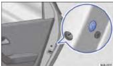
Fig. 44 En la parte delantera de la puerta derecha: bloqueo de emergencia, cubierto por una junta de goma.
