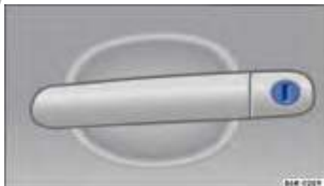
Fig. 43 Manilla de la puerta del conductor con bombín de cierre.
