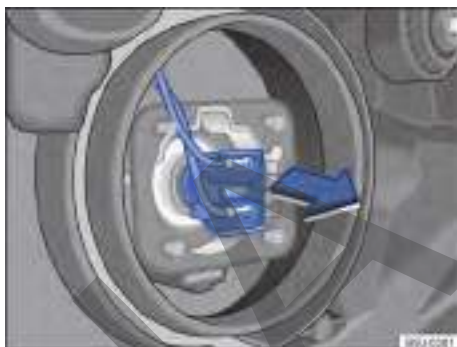
Fig. 178 Acceso a la bombilla del farol bajo.
