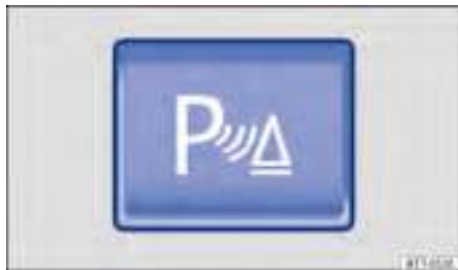
Fig. 92 En la parte superior de la consola central: pulsador para activar y desactivar el control de distancia de aparcamiento (Park Pilot).
