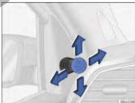
Fig. 73 En las puertas delanteras: interruptor de ajuste de los espejos retrovisores externos mecánicos. ▶
