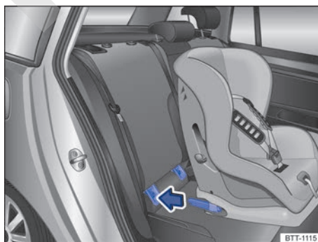
Fig. 101 Representación esquemática: montaje de un asiento para niños ISOFIX con conectores.
