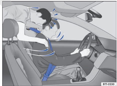
Fig. 80 El ocupante del asiento trasero sin el cinturón de seguridad colocado sale lanzado hacia delante topando contra el conductor, que sí lo lleva colocado.
