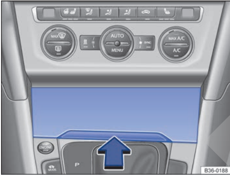
Fig. 168 En la parte delantera de la consola central: abrir el cenicero.
