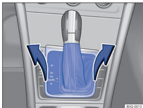
Fig. 286 Desmontar la cubierta de la correa de la palanca selectora.
