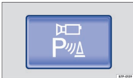
Fig. 216 En la parte superior de la consola central: tecla para conectar manualmente el sistema de visión periférica.
