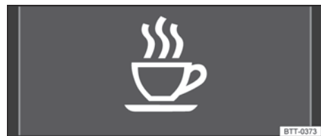
Fig. 243 En la pantalla del cuadro de instrumentos: símbolo de detección del cansancio.
