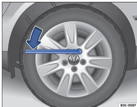
Fig. 293 Cambio de rueda: aflojar los tornillos de rueda.
