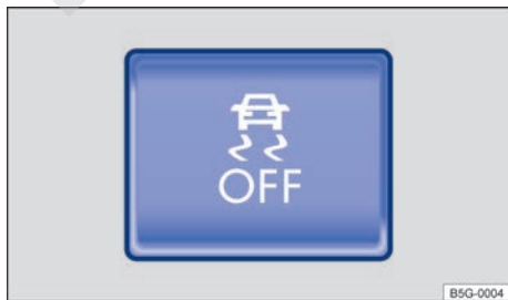
Fig. 187 En la parte inferior de la consola central: tecla para desconectar y conectar manualmente el ASR, el ASR junto con el ESC, o el ESC Sport.
