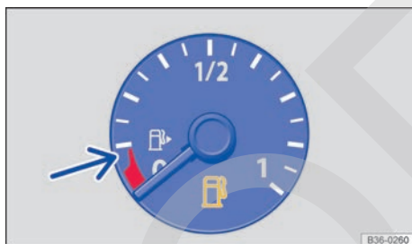
Fig. 252 En el cuadro de instrumentos: indicador del nivel de gasolina o gasóleo.
