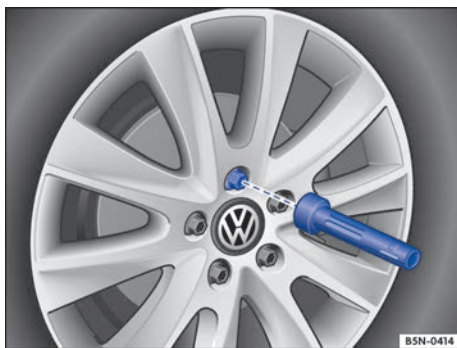
Fig. 299 Cambio de rueda: desenroscar los tornillos de rueda con el mango del destornillador.
