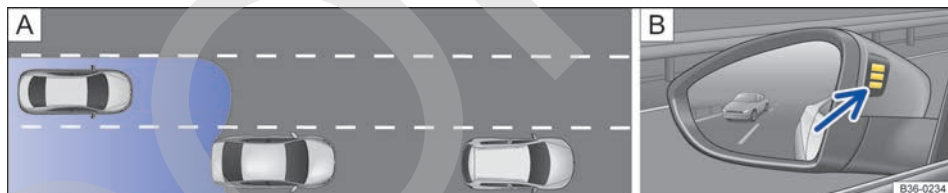
Fig. 238 A) Situación en un adelantamiento con tráfico en la parte trasera. B) Indicador óptico en el retrovisor exterior izquierdo.
