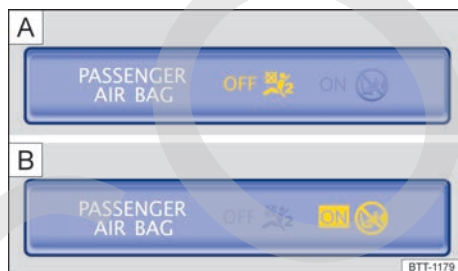
Fig. 87 En la parte superior de la consola central: testigo de control de la desactivación del airbag frontal del acompañante A ) y de la activación del airbag frontal del acompañante B ).
