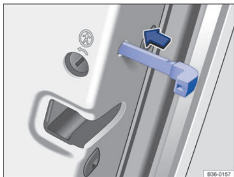
Fig. 283 En el frontal de la puerta trasera derecha: bloqueo de emergencia del vehículo con la llave de emergencia.
