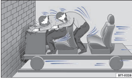
Fig. 78 El vehículo choca contra el muro. Los ocupantes no llevan colocado el cinturón de seguridad.
