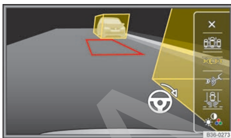
Fig. 204 Visualización en la pantalla del asistente de marcha atrás: modo 2 conectado.
