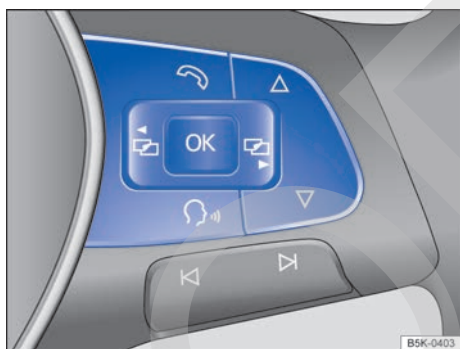
Fig. 27 Lado derecho del volante multifunción: teclas para utilizar los menús y las indicaciones informativas del cuadro de instrumentos.
