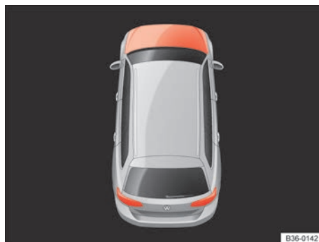
Fig. 257 Representación esquemática en la pantalla del cuadro de instrumentos: capó del motor abierto o no cerrado correctamente.
