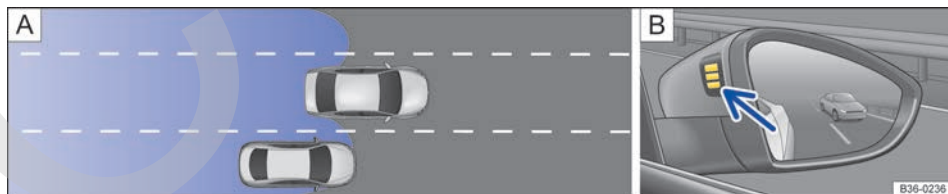
Fig. 239 A) Situación en un adelantamiento e incorporación posterior al carril derecho. B) Indicador óptico en el retrovisor exterior derecho.
