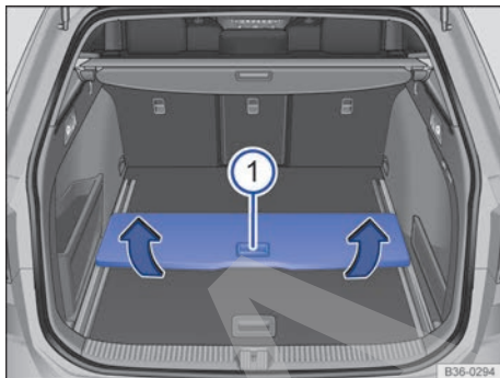
Fig. 148 En el maletero: desmontar el piso desplazable del maletero.
