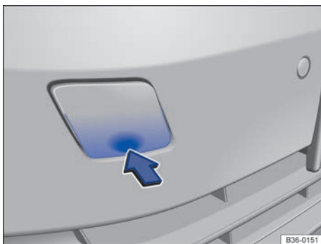
Fig. 317 En el lado derecho del paragolpes delantero: retirar la tapa.
