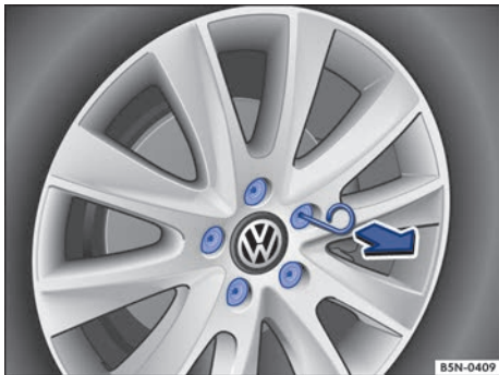
Fig. 292 Quitar los capuchones de los tornillos de rueda.
