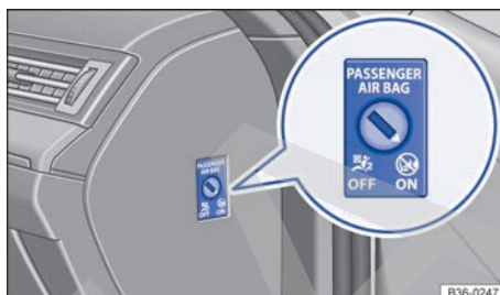
Fig. 90 En el tablero de instrumentos del lado del acompañante: conmutador de llave para activar y desactivar el airbag frontal del acompañante.
