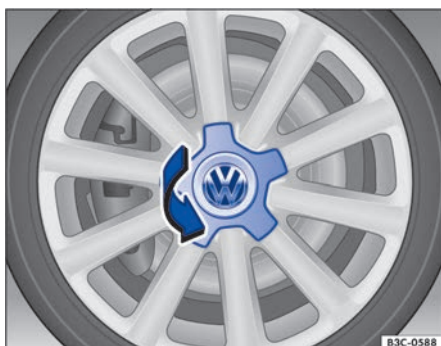
Fig. 290 Desenroscar el tapacubos central.
