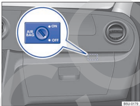
Fig. 64 En la guantera: interruptor desactivado por la llave para apagar y encender el airbag frontal del pasajero.
