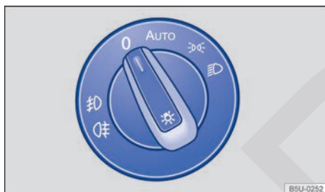
Fig. 68 En el panel: interruptor giratorio de las luces.
