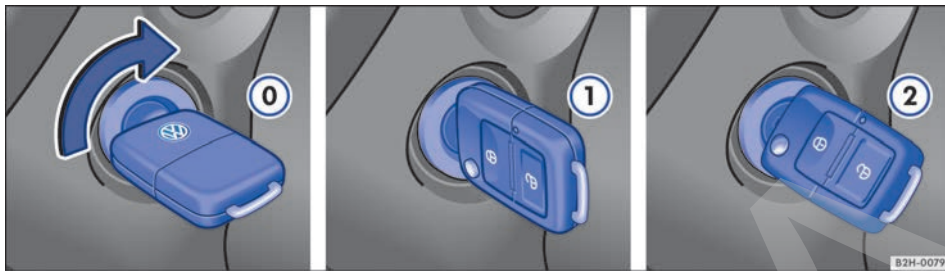
Fig. 109 Al lado del volante, a la derecha: posiciones de la llave del vehículo en el cilindro del encendido.
