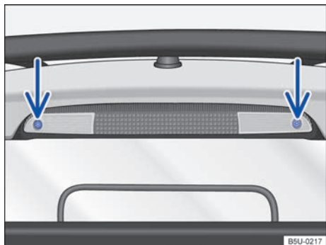
Fig. 199 En el compartimento de carga: remover la linterna de freno elevada.
