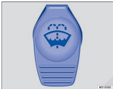
Fig. 76 En el compartimento del motor: tapa del tanque de agua de los lavaparabrisas.
