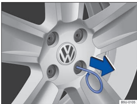
Fig. 165 Retirar los capuchones de los tornillos de la rueda.
