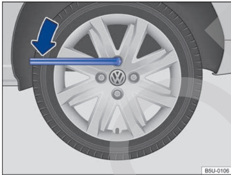
Fig. 169 Cambio de rueda: aflojar los tornillos de la rueda.
