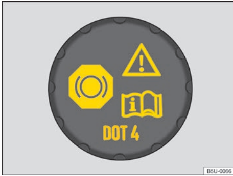
Fig. 115 En el compartimento del motor: tapa del depósito de líquido de freno.
