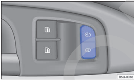
Fig. 29 En la puerta del conductor: teclas del cierre centralizado.
