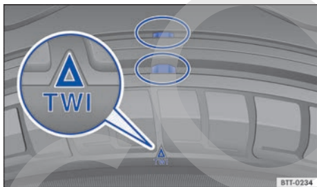
Fig. 145 Perfil del neumático: indicador de desgaste.
