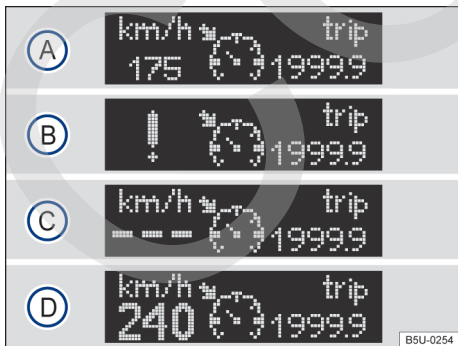
Fig. 122 En el display del panel de instrumentos: indicadores de estado del GRA.
