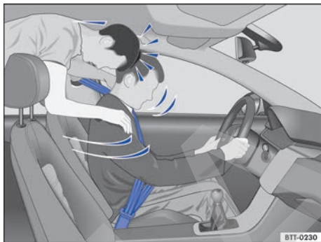
Fig. 53 El pasajero sin cinturón de seguridad en el asiento trasero es lanzado hacia adelante sobre el conductor con cinturón.
