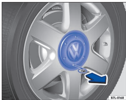
Fig. 181 Desmontar el tapacubos central tirando de él.
