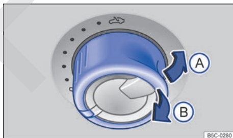
Fig. 63 En el revestimiento interior del techo: mando para abrir y cerrar el techo de cristal, así como para ajustar la posición deflectora del mismo.
