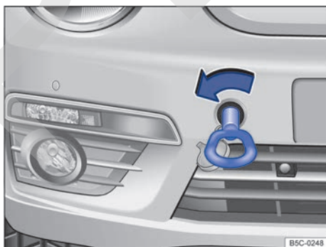
Fig. 161 En el lado derecho del paragolpes delantero: enroskar la argolla de remolque.
