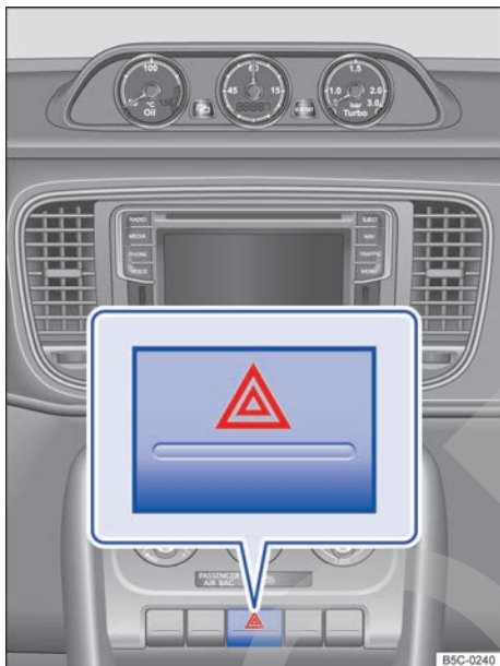
Fig. 25 En la parte superior de la consola central: pulsador de los intermitentes de emergencia.
