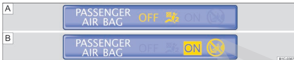
Fig. 13 Testigo de control en la parte superior de la consola central: A) Airbag frontal del acompañante desactivado; B) Airbag frontal del acompañante activado.
