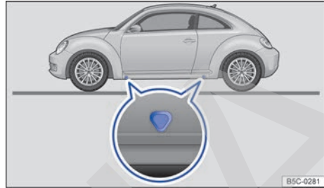
Fig. 188 Puntos de apoyo para el gato.
