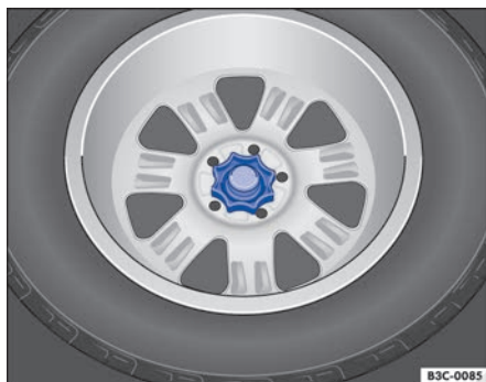
Fig. 179 En el maletero: ruedecilla para fijar la rueda de repuesto.
