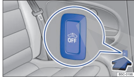
Fig. 52 Junto al asiento del conductor: tecla para desconectar la vigilancia del habitáculo y el sistema antirremolcado.
