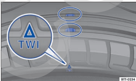
Fig. 178 Perfil del neumático: indicadores de desgaste.
