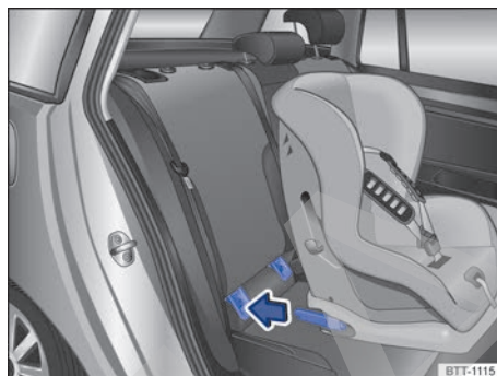
Fig. 23 Representación esquemática: montaje de un asiento para niños ISOFIX con conectores.
