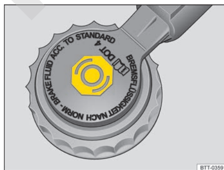
Fig. 171 En el vano motor: tapa del depósito del líquido de frenos.
