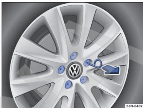
Fig. 185 Quitar los capuchones de los tornillos de rueda.
