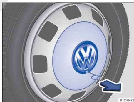
Fig. 184 Desmontar el tapacubos integral (variante 2)
