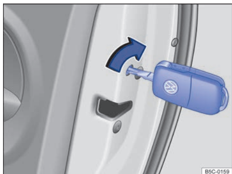
Fig. 56 En el frontal de la puerta del acompañante: bloqueo de emergencia de la puerta del acompañante con la llave del vehículo.
