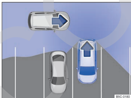
Fig. 109 Representación esquemática del asistente de salida del aparcamiento: zona vigilada alrededor del vehículo que está desapareando.
