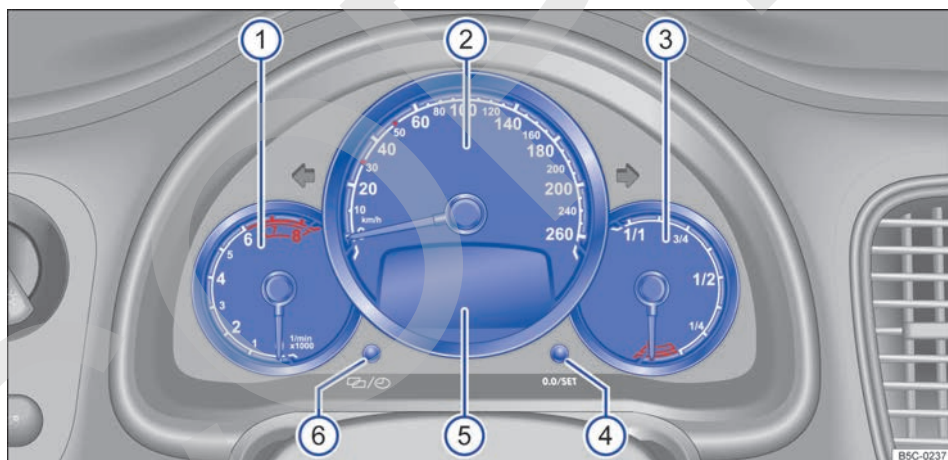
Fig. 40 Cuadro de instrumentos en el tablero de instrumentos.
