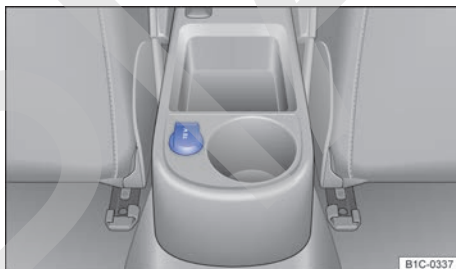
Fig. 131 Toma de corriente de 12 voltios en la parte trasera de la consola central.
