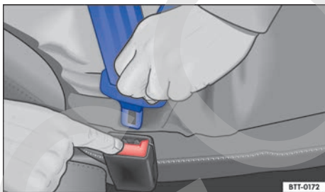
Fig. 10 Soltar la lengüeta del cierre del cinturón.
