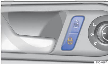
Fig. 49 En la puerta del conductor: tecla del cierre centralizado.
