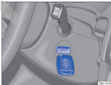
Fig. 96 En la columna de dirección: función de arranque de emergencia en vehículos con el sistema Keyless Access.
