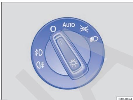
Fig. 75 Junto al volante: representación de un tipo de mando de luces.
