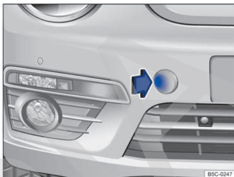
Fig. 160 En el lado derecho del paragolpes delantero: retirar la tapa.
