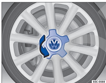
Fig. 182 Desmontar el tapacubos central girándolo.
