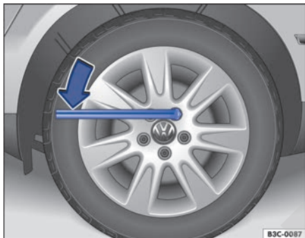
Fig. 236 Cambio de rueda: aflojar los tornillos de rueda.
