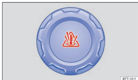
Fig. 221 En el vano motor: tapa del depósito de expansión del líquido refrigerante del motor (representación esquemática).
