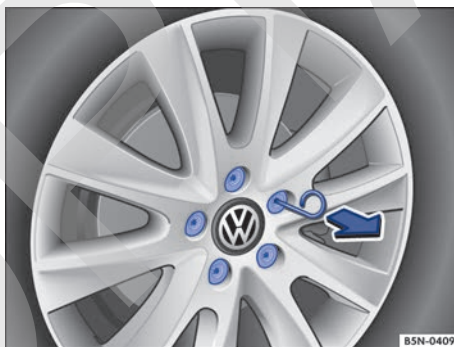
Fig. 235 Retirar las caperuzas de los tornillos de rueda.
