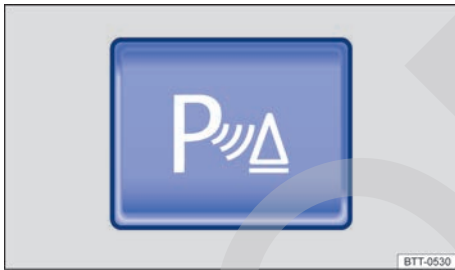
Fig. 133 En la consola central: tecla para conectar y desconectar la ayuda de aparcamiento (en función del equipamiento).
