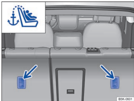
Fig. 54 Argollas de sujeción en la parte posterior del asiento trasero para fijar el cinturón de fijación superior.
