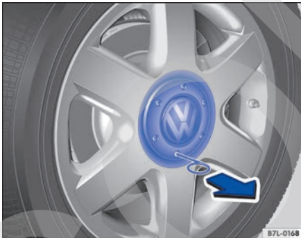
Fig. 232 Desmontar el tapacubos central tirando de él.
