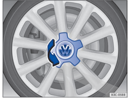
Fig. 233 Desmontar el tapacubos central girándolo.
