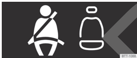
Fig. 29 Indicación del estado de los cinturones de seguridad de las plazas traseras en la pantalla del cuadro de instrumentos.
