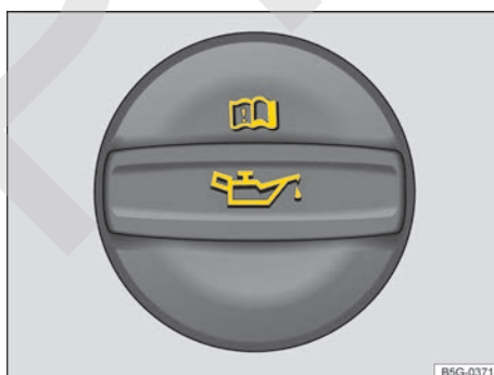
Fig. 219 En el vano motor: tapa de la boca de llenado de aceite del motor (representación esquemática).
