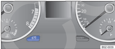
Fig. 64 En el panel de instrumentos: tecla de regulación de la iluminación de los instrumentos y de los interruptores.
