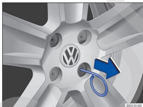
Fig. 140 Retirar las caperuzas de los tornillos de rueda.
