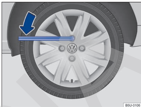
Fig. 142 Cambio de rueda: aflojar los tornillos de la rueda.
