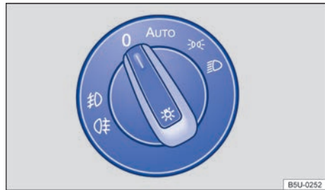
Fig. 63 En el panel: conmutador de las luces.
