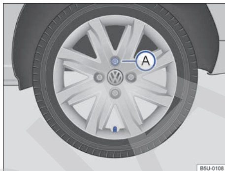
Fig. 141 Retirar la superllanta.
