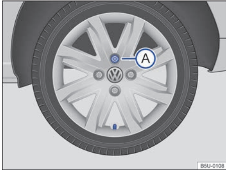
Fig. 144 Cambio de rueda: secuencia de desmontaje de los tornillos de la rueda.
