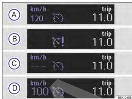
Fig. 101 En el display del instrumento combinado: indicadores del estado del GRA (representación esquemática).
