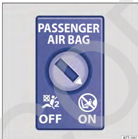
Fig. 39 En el panel de instrumentos en el lado del acompañante delantero: interruptor accionado por la llave para desconectar y conectar el airbag frontal del acompañante delantero.
