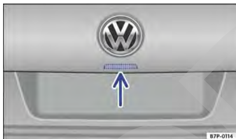
Fig. 61 En la tapa trasera: botón para abrir la tapa trasera.
