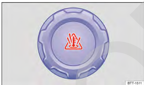
Fig. 152 En el compartimento del motor: tapa del depósito de expansión del líquido refrigerante del motor.
