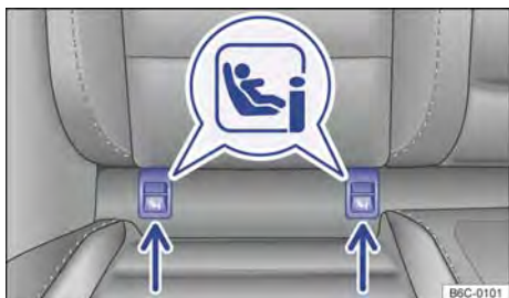
Fig. 44 En el asiento del vehículo: identificación de los puntos de anclaje inferiores de asientos para niños.
