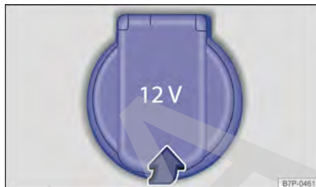
Fig. 113 En la consola central delantera: toma de corriente de 12 V.
