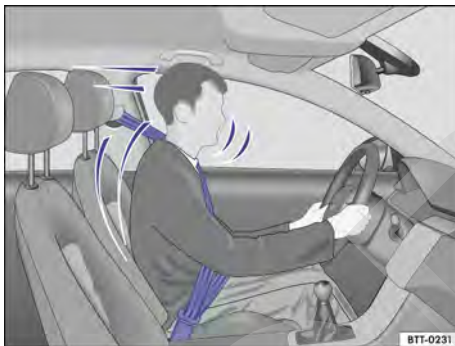
Fig. 30 Conductor protegido por el cinturón de seguridad correctamente colocado en una maniobra de frenado súbita.
