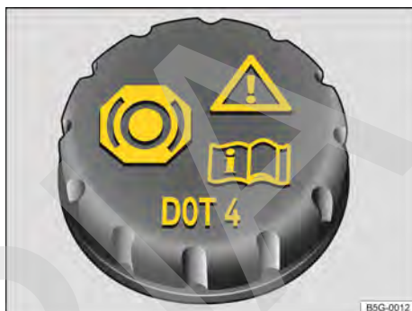
Fig. 153 En el compartimento del motor: tapón de cierre del depósito del líquido de frenos.
