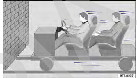
Fig. 26 Un vehículo con los ocupantes sin cinturones de seguridad está camino a chocar contra un muro.
