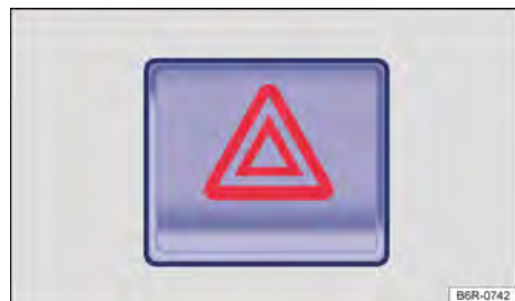
Fig. 48 En la parte superior de la consola central: interruptor de las luces de advertencia.
