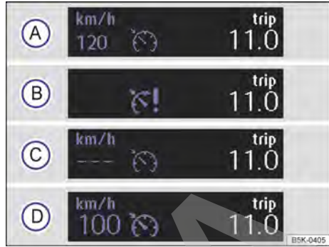
Fig. 99 En el display del instrumento combinado: indicadores del estado del GRA (representación esquemática).
