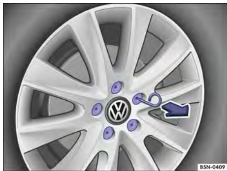
Fig. 163 Retirar las capcerzas de los tornillos de la rueda.
