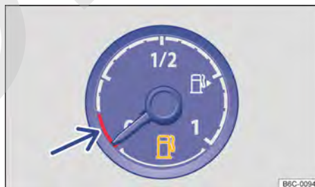
Fig. 14 En el instrumento combinado analógico: indicador del nivel de combustible (variante 2).
