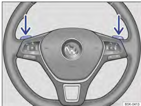
Fig. 96 Volante con selectores basculantes de Tiptronic.
