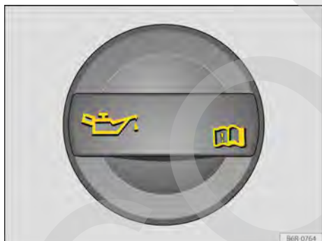
Fig. 150 En el compartimento del motor: tapón de la boca de llenado del aceite del motor.
