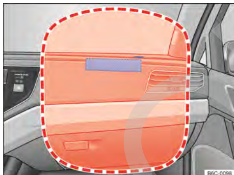
Fig. 38 Ubicación y radio de expansión del airbag frontal del acompañante.
