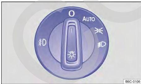
Fig. 74 Al lado del volante: interruptor de luces (una variante).
