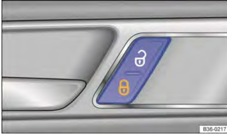
Fig. 53 En la puerta del conductor: tecla del cierre centralizado.
