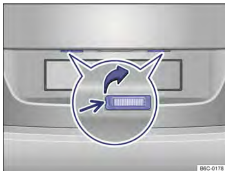
Fig. 135 En el parachoques trasero: luz de la placa de licencia.
