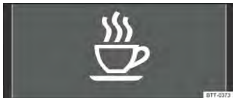
Fig. 12 En el display del instrumento combinado: símbolo del sistema de reconocimiento de cansancio.
