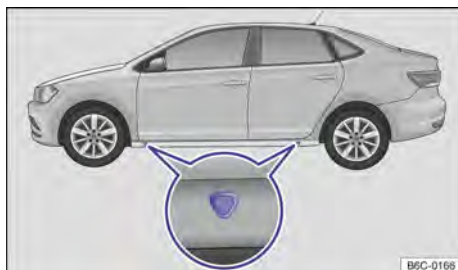
Fig. 166 Puntos de apoyo del gato.
