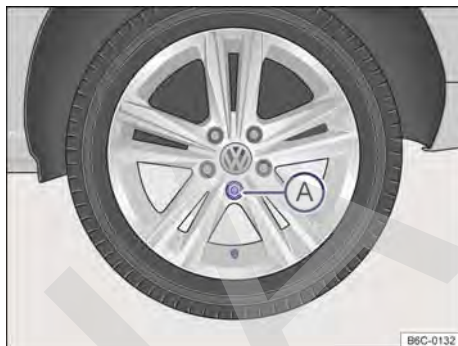
Fig. 162 Retire el tapacubos integral.
