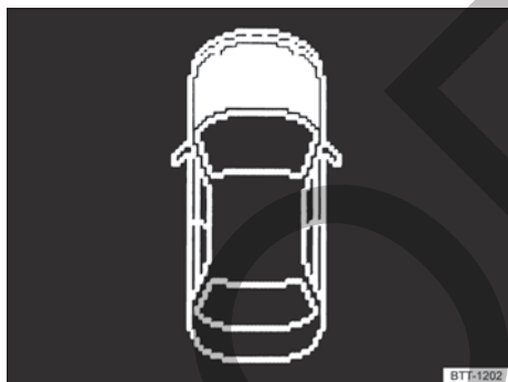
Fig. 158 En la pantalla del cuadro de instrumentos: capó del motor abierto o mal cerrado.
