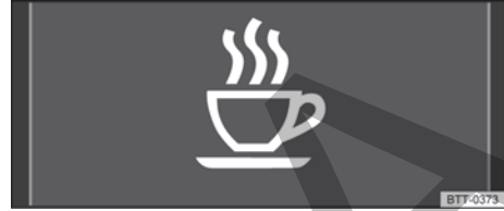
Fig. 17 En la pantalla del cuadro de instrumentos: símbolo de detección del cansancio.
