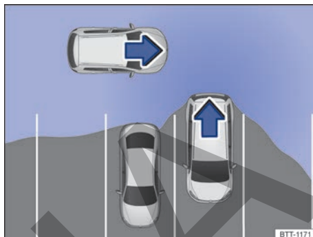
Fig. 127 Representación esquemática del asistente de salida del aparcamiento: zona vigilada alrededor del vehículo que está desapareando.
