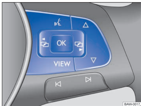
Fig. 20 Lado derecho del volante multifunción: teclas para utilizar los menús y las indicaciones informativas del cuadro de instrumentos.
