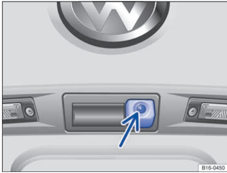
Fig. 188 En la parte trasera del vehículo: cámara del asistente de marcha atrás.
